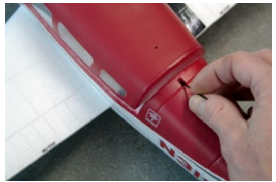
Sowas nennt man Gadget: mit Druck auf die Antenne löst sich der Riegelverschluss für die Kabinenhaubenarretierung
