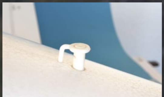
Ein großzügig dimensionierter Kunststoffzapfen, geführt in einem oberen Stützring, stellt die stabile Schleppkupplung dar
