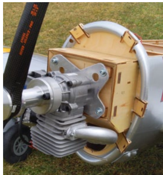
Der ZG-45 mit selbstgefertigtem Krümmer und innenliegendem Schalldämpfer
