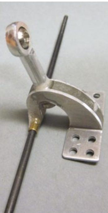
Zwei zusammengeklebte Ruderscharniere bilden die Grundlage für das Haubenscharnier
