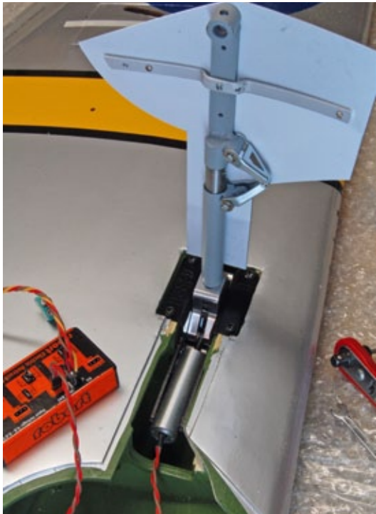
Ein Alubügel bringt die Fahrwerkabdeckung aus Kunststoff in Form
