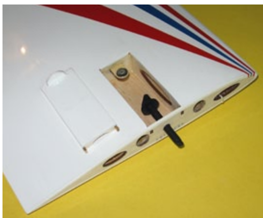
Zur Befestigung der Tragflächen wird eine Kunststoffschraube in den Rumpf eingedreht. Die Abdeckung hält durch einen starken Magneten
