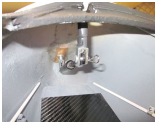
Passt und funktioniert: Neue Dämpferbefestigung am Haubenscharnier
