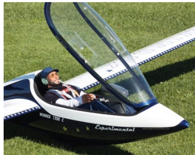
Charakteristisch für die Windex ist das vorne befestigte Haubenscharnier
