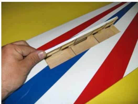
Die Drehbremsklappen werden über Schubanlenkungen aus der Flügeloberseite herausgedreht
