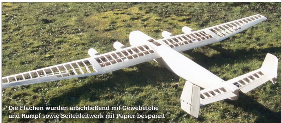
Die Flächen wurden anschließend mit Gewebefolie und Rumpf sowie Seitenleitwerk mit Papier bespannt
