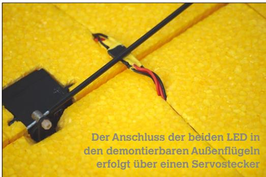
Der Anschluss der beiden LED in den demontierbaren Außenflügeln erfolgt über einen Servostecker
