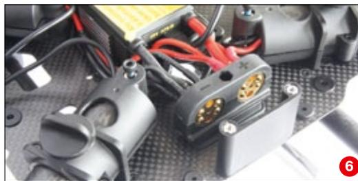
Wesentliche Aufgabe der Power Control Unit (PCU) ist die Stromversorgung aller Verbraucher. Gesteuert beziehungsweise kontrolliert wird auch sie über die APS-M (5). Praktisch ist der den Belastungen entsprechend massiv ausgelegte Stromverteiler, an dem sogar Platz für zwei weitere Motoranschlüsse vorhanden ist (6). In die Akku-Halteplatte und dem Gegenstück am Frame sind Goldkontakte fertig eingesetzt und stellen die Verbindung vom LiPo zur PCU her (7)
