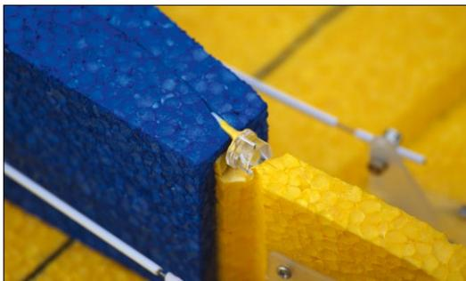
Die Heckleuchte an der REDAQ 180 wird zwar etwas vom Seitenruder abgedeckt, ist im Flug aber trotzdem gut zu erkennen
