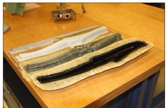
Basis zahlreicher Bauteile, hier der Gondelträger, ist zunächst eine CNC-gefräste Urform, von der ein Negativ erstellt wird
