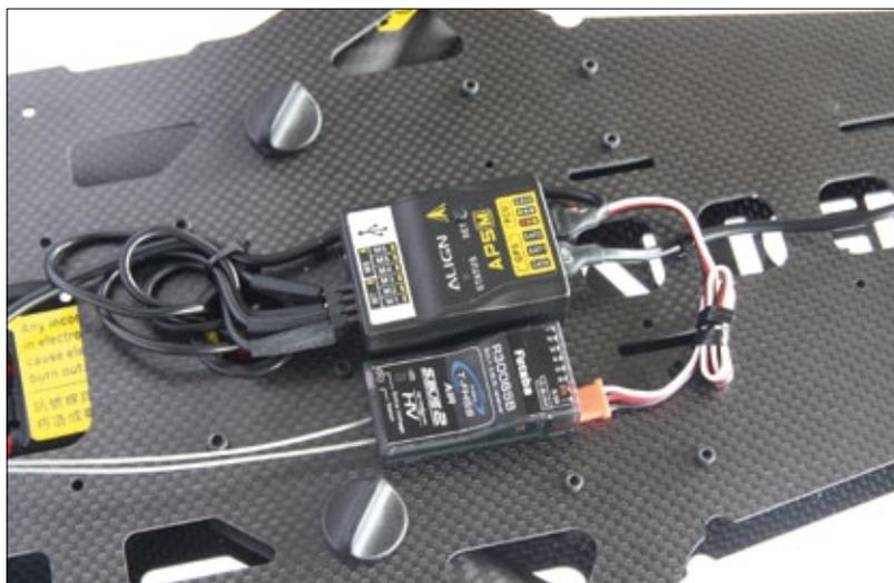
zurück und kann von dort aus im Kreis um den Punkt fliegen. Höhe und Distanz bleiben steuerbar, Gieren übernimmt die APS-M, sodass die Nase des Kopters beim Kreisfliegen immer auf den Punkt ausgerichtet bleibt. Ein ideales Feature für Kameraflüge.
