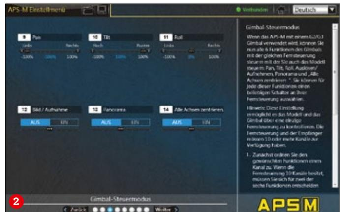
Die APS-M kann wahlweise über eine PC-Software oder eine App eingestellt werden. In diesem Menü sind die korrekten Steuereingaben und Schalterbelegungen einzustellen (1). Bei Verwendung eines Gimbals kann die Einstellung ebenfalls über die Software vorgenommen werden (2)
