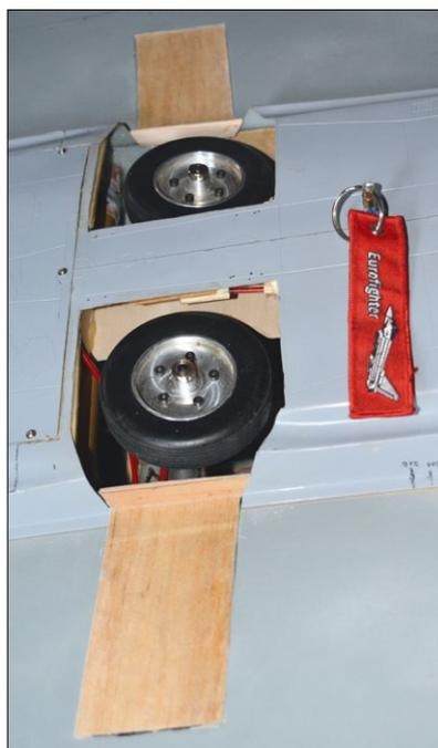
In mehreren Schritten folgte die Einpassung der Lado-Fahrwerke. Um ein exaktes Ein- und Ausfahren zu garantieren, wurden Kulisse und Klappen immer mit eingepasst
