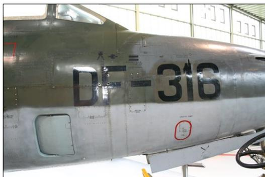
Am Vorderrumpf war beidseitig die taktische Kennung aufgebracht. Unterhalb der Kennung ist die Luftpfeinlaufklappe für Zusatz-Triebwerksluft
