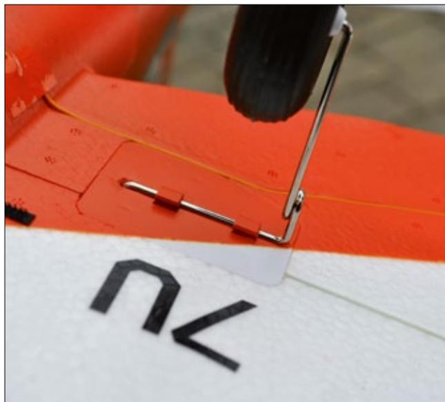
Das Hauptfahrwerk wird in vorgesehene Plastikflaschen eingesteckt und kann jederzeit demontiert werden
