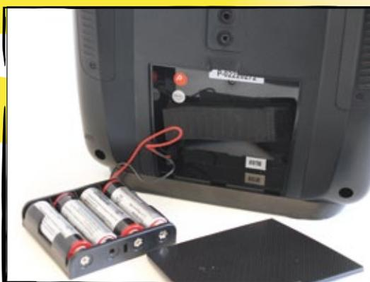
Bei der Wahl des Senderakkus hat man freie Hand. Entweder man füllt den Batterieschlitten oder greift auf NiXX- oder LiXX-Zellen zurück
