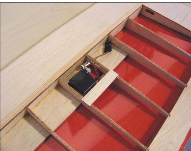
Die Störklappenservos werden vor dem Bespannen der Unterseite eingebaut und auf Funktion geprüft
