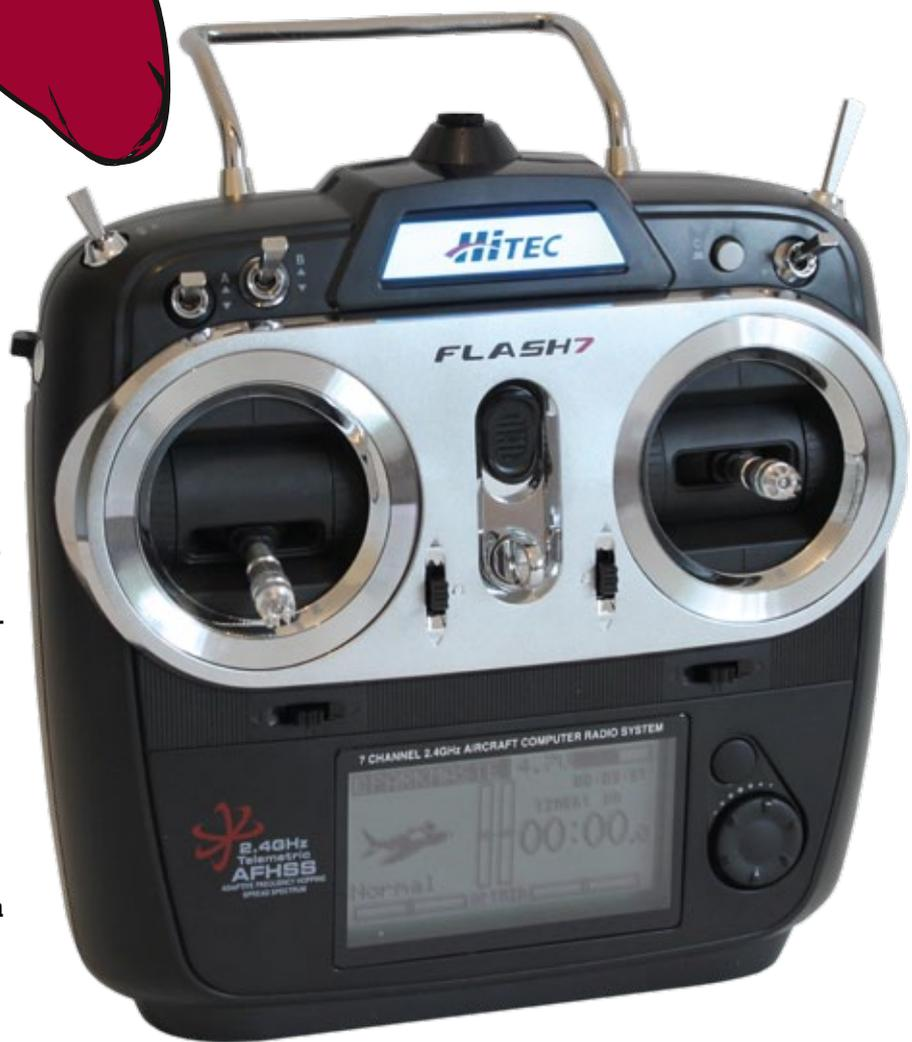
Sämtliche Bedienelemente, ein einfacher Schalter, ein Taster und drei Zweiwege- sowie ein Dreiwegeschalter, sind gut erreichbar platziert und können frei belegt werden
