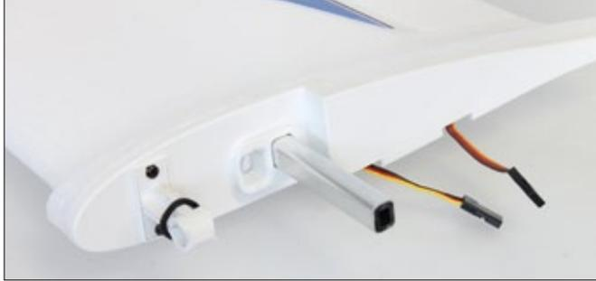
Die Aluminium-ummantelten CFK-Holmrohre stehen so weit über, dass Sie in die jeweils gegenüberliegende Tragfläche greifen
