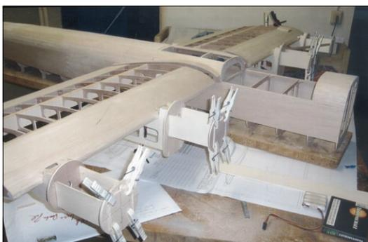
In den beiden inneren Gondeln sind später auch die Einziehfahrwerke zu installieren. Bis zu diesem Bauschritt ist der Rumpf noch immer auf dem Baubrett, was die Maßhaltigkeit garantiert
