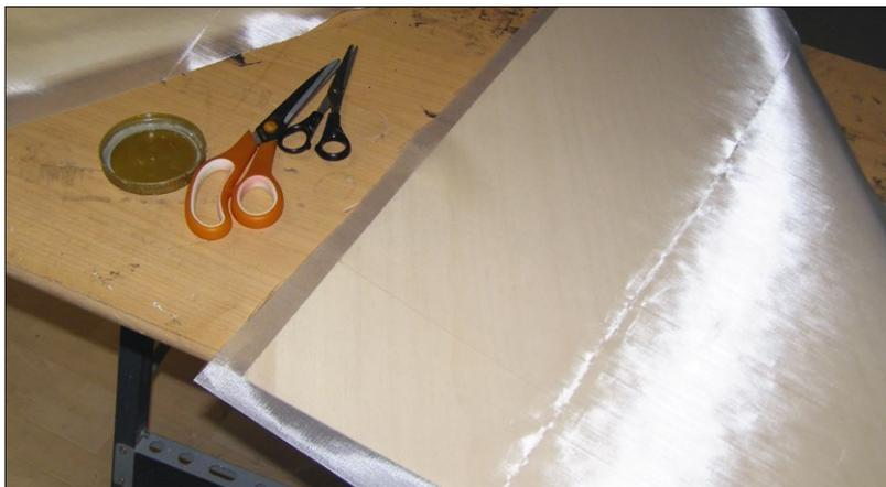
Zwecks eines optimalen Oberflächenfinishs ist die Abachi-Fläche mit GFK-Gewebe belegt worden
