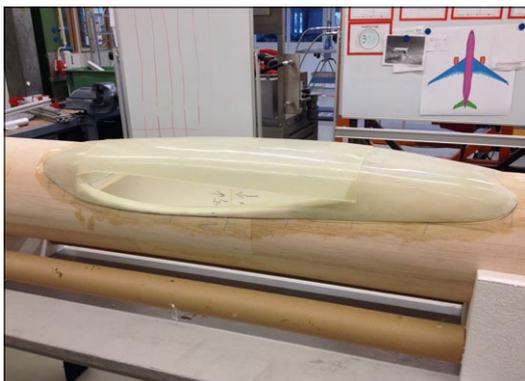
Weitgehend angepasster Belly Fairing aus GFK. Unter dem Wulst verschwinden später in Schächten die Fahrwerksräder
