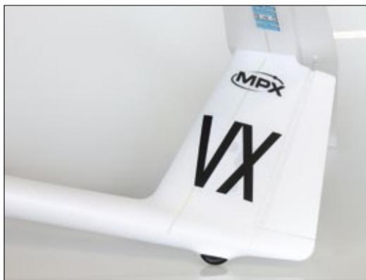
Das Höhenleitwerk wird einfach mit zwei Schrauben am Rumpf befestigt und schon ist der Heron einsatzbereit. Unter den großen Aufklebern verstecken sich die Leitwerksservos
