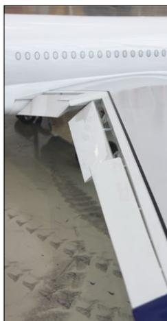
Die beiden inneren Klappen dienen der Verwölbung und zum Landen
