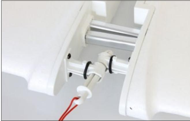
Ein Kunststoff-Splint wird von vorne durch den Rumpf geschoben und sichert somit die Tragflächen
