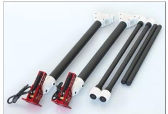
Eine hohe Vorfertigung, wie hier bei den schwenkbaren Landekufen, kennzeichnet den M480L. Alle CFK-Teile sind matt und verursachen keine Reflexionen, die bei Kameraflügen stören könnten
