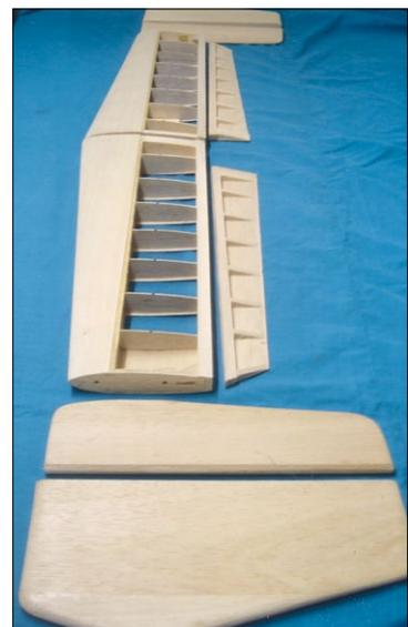
Zuerst werden beide Höhenleitwerkshälften in V-Stellung verleimt und eingepasst, dann kommen die Seitenleitwerke an die Reihe
