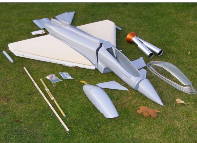
Von Grumania Jets ausgelieferte Teile des Modells, hier noch mit Styro-Abachi-Fläche, die heute durch eine GFK-Variante ersetzt ist
