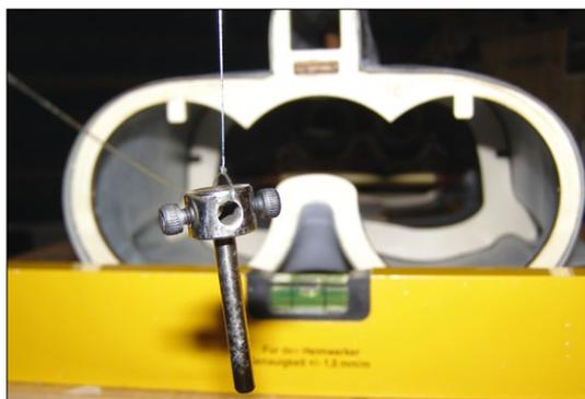
Mit Pendel und Wasserwaage lässt sich das demontierbare Seitenleitwerk perfekt einmessen und einbauen
