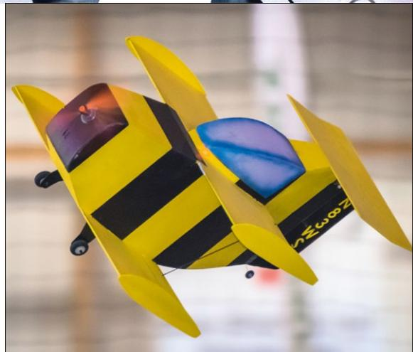
Spannweite, Streckung – was ist das, und wozu soll es gut sein? Egal, das mantragende Original dieser Bumble Bee fliegt trotzdem, genauso wie dieser 500 Millimeter spannende Nachbau mit seinen 300 Gramm Abfluggewicht. Gebaut nach einem Bauplan aus der französischen Fachzeitschrift RC Pilot, Mai-Ausgabe 2012.
