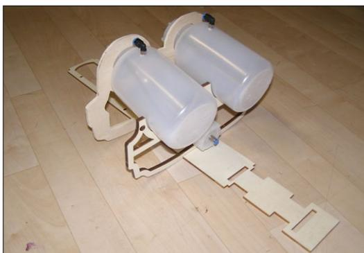
Das Eigenbau-Tanksystem besteht aus zwei Ein-Liter-Weithals-Laborflaschen und Festo-Anschlüssen
