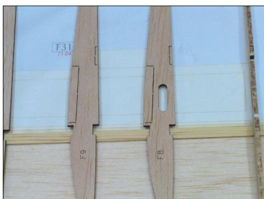
Diese Rippen des Innenflügels müssen für den Einbau der Störklappen noch ausgebrochen werden. Das sollte man aber erst dann machen, wenn die Rippen mit dem oberen Holm verklebt sind. Sonst brechen die feinen Stege zwischen dem Holmausschnitt und der Lücke für den Störklappenkasten weg
