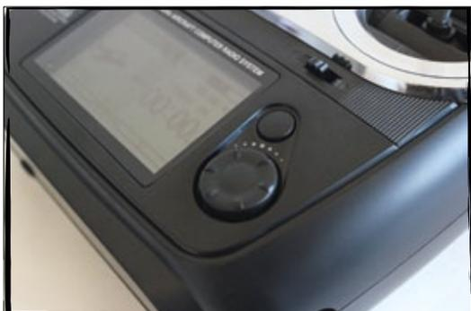
Die Menüführung erfolgt über einen 3D-Button sowie einen weiteren Schalter
