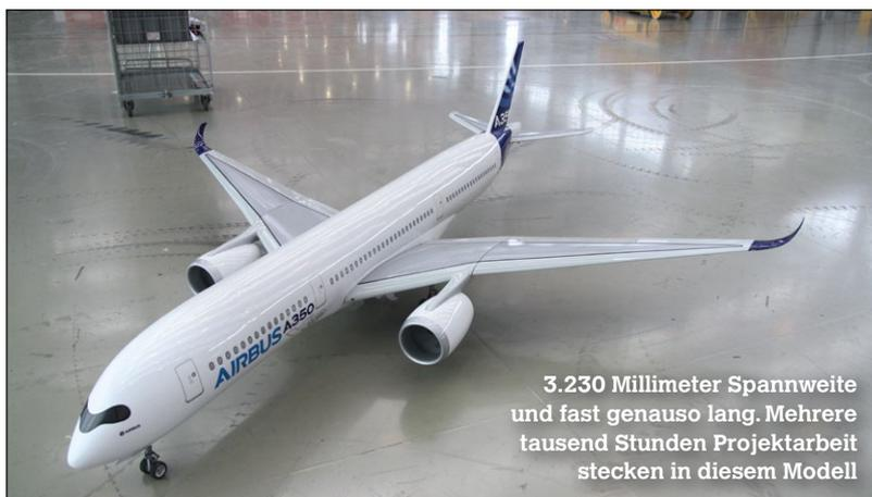
3.230 Millimeter Spannweite und fast genauso lang. Mehrere tausend Stunden Projektarbeit stecken in diesem Modell
