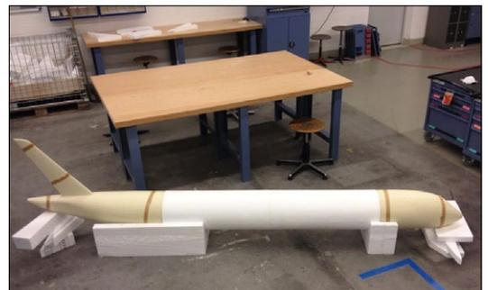
Während die mittlere Rumpfschnecke aus Styro geschnitten und beplankt wurde, entstanden Bug und Heck im Positiv-Negativ-Positiv-Verfahren
