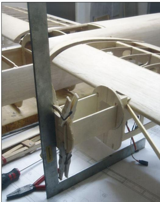
Ist der Flügel mit vorgesehendem Anstellwinkel montiert, können Motorträger und -spant exakt winklig montiert werden
