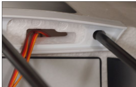
Zwei CFK-Rohre besorgen die Flächensteckung. Für die Servoanschlüsse liegen dem RR-Set ausreichend lange Verlängerungskabel bei
