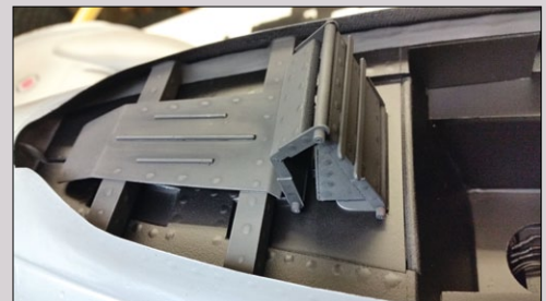
Die Kabinenhaube lässt sich über einen simplen, jedoch effektiven und Platz-sparenden Klappenmechanismus anheben
