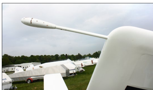
Der tropfenförmige Gewichtsausgleich an der Leitwerksflosse
