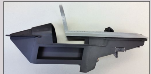
Die Kabinenhaube lässt sich über einen simplen, jedoch effektiven und Platz-sparenden Klappenmechanismus anheben
