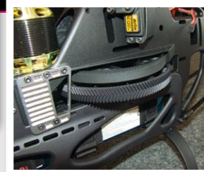
Das pfeilverzahnte Hauptgetriebe. Darüber der Zahnriemen, der mit dem Vorgelege des Heckantriebs verbunden ist
