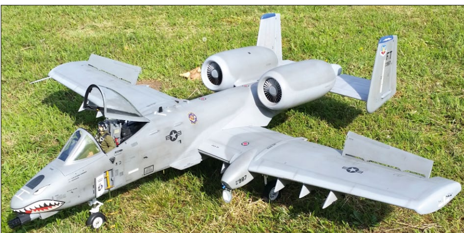
A-10 in Parkposition mit gesetzten Klappen, geöffneter Cockpithaube und ausgefahrener Leiter. Mehr an Funktion geht kaum
