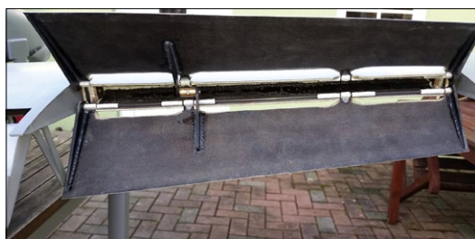
Elektrisch zu öffnende Spaltklappe wie im Original. Sie lässt sich aber nur beim Taxiing nutzen
