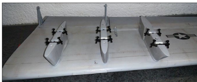
Fertig konfektionierte Waffenträger vor und nach dem Einbau
