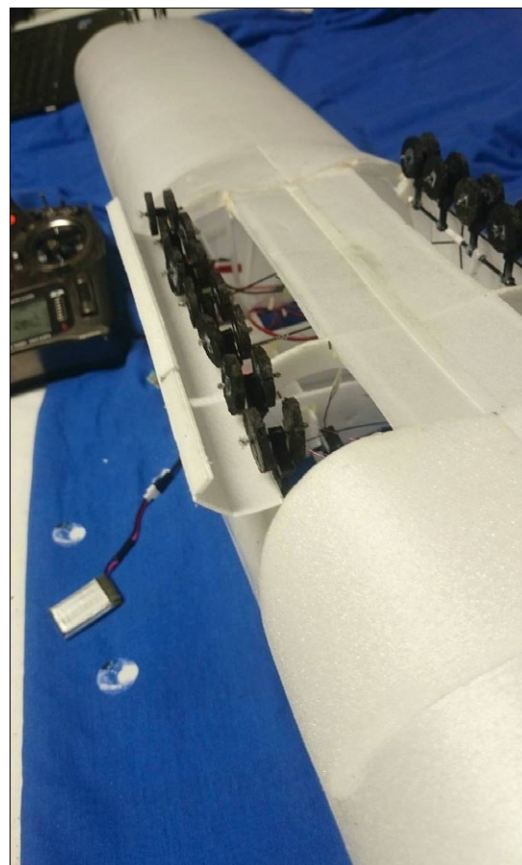
Das Einziehfahrwerk besteht aus 16 Achsen und 32 Rädern – eine Fleißarbeit für den Erbauer
