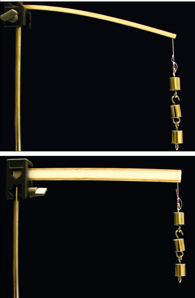
Abbildung 4: Ein dünner Tragflächenholm biegt sich bei gleicher Last viel stärker als ein dicker – und das bei etwa gleicher Masse
