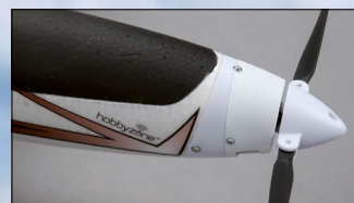
Klapppropeller und starker 370er Brushless-Motor
