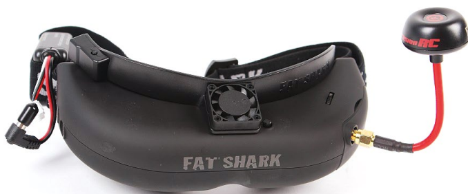
Bei der Fatshark-Brille ist das Empfängermodul in der Brille eingebaut. Eine praktische Lösung
