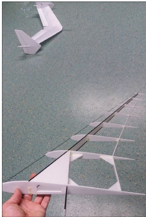
Die unbeplankte rechte Tragfläche. Ein Kohlefaser-Flachstab sorgt für Stabilität
