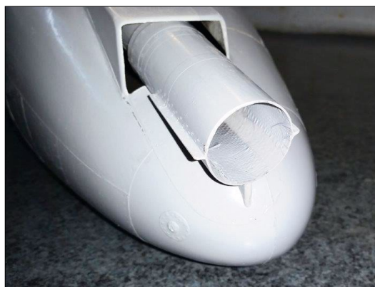
Bug mit Verkleidung der Gattling-Kanone. Nieten und Pfalz gleichen dem Original im Detail
