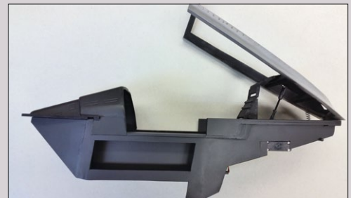
In der Seitenansicht ist Servo-gesteuerte Öffnungsmechanik des Cockpiteinsatzes gut zu erkennen
