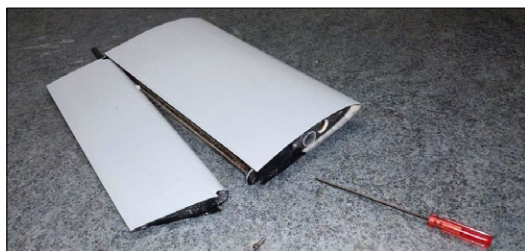
Höhenruder mit offener Anlenkung und Steckung. Zu beachten ist die einfache und robuste Konstruktion
