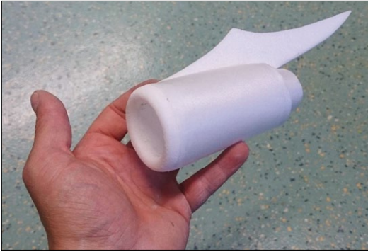
Die sechs Triebwerksgondeln sind mit 28-mm-Impellern ausgestattet. Diese stammen ursprünglich aus der Micro Sabre von Hobbico
