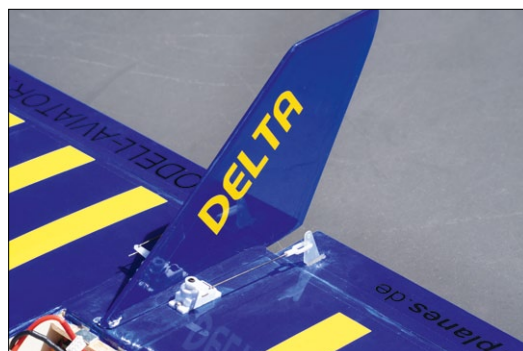
Seitenleitwerk und spielfreie Anlenkung der Ruder
