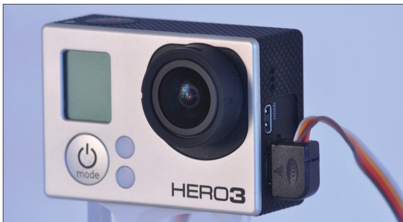
Die GoPro3 mit angeschlossenem Liveout-Kabel. Eine hervorragende Kamera nicht nur für FPV und Modellflug – sie wird nur dich eine Hero4 getoppt
