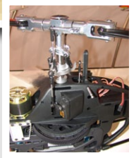
Das Ganzmetall-Hauptrotor-System des Logo 700 mit perfekt im Chassis angeordneten Taumelscheiben-Servos
