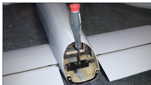
Die Höhenruderanlenkung-Verbindung ist eine sehr einfache und robuste Konstruktion. Das Höhenruderservo ist sehr leicht zu erreichen
