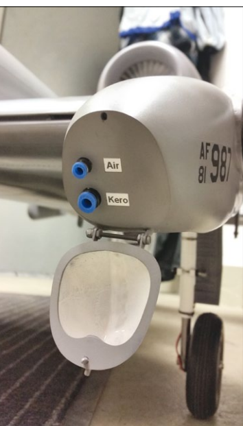
Anschlüsse für Luft und Kerosin in der Klappe der Hauptfahrwerks gondel
