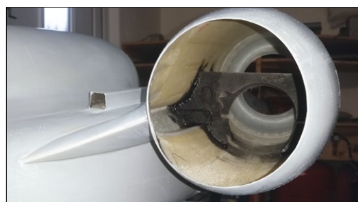
Triebwerksgondel und Turbinenhalterung für Turbinen bis 5 Kilogramm Schub oder Impeller
