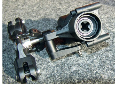
Genial realisiert: Beim Heckrotor wird die Steifigkeit des Alu-Heckrohrs in die Kunststoff-Konstruktion mit einbezogen. Es umschließt die beiden eingangsseitig sitzenden, in Kunststoff-Aufnahmen fixierten Kugellager, wodurch das Ganze enorm stabil wird und extrem kurz baut
