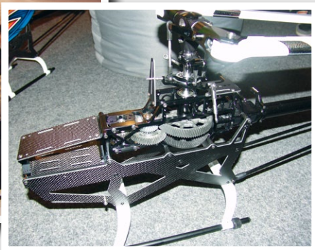
Geliebt ist das markante, zweistufige Getriebe, das in einem Metall-Chassis-Rahmen untergebracht ist. Unterbau und Frontbereich aus CFK wurden neu gestaltet
