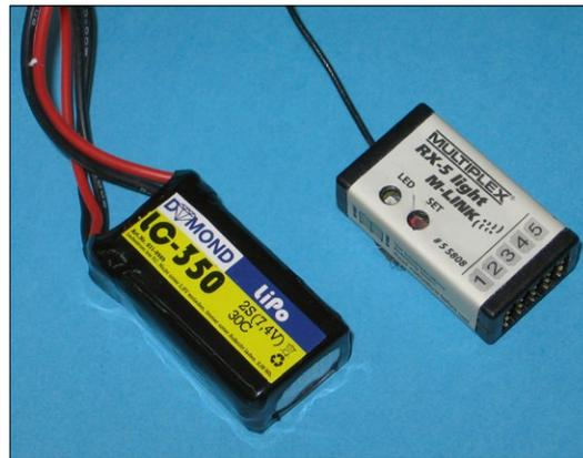
Ein 2s-LiPo mit 350 Milliamperestunden und ein Empfänger mit mindestens vier Kanälen werden zur Fertigstellung benötigt
