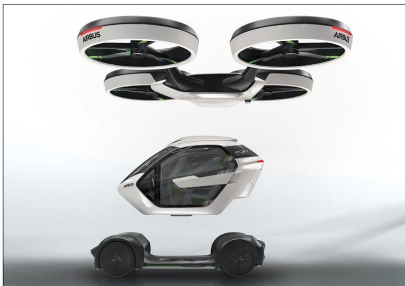
Pop.Up basiert auf einem modularen System, bei dem die Passagier-Kapsel die konstante Größe ist. Sie wird je nach Verkehrssituation gefahren oder geflogen
