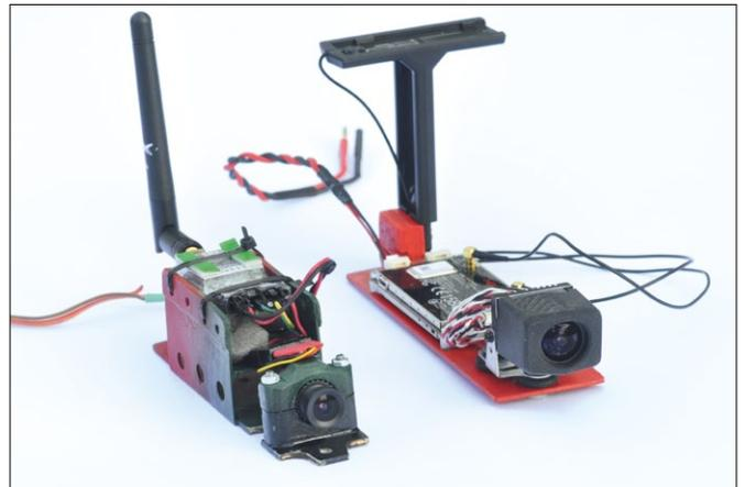
Links eine analoge FPV-Anlage mit OSD, nicht sehr platzsparend installiert, rechts die digitale FPV-Anlage Prosight
