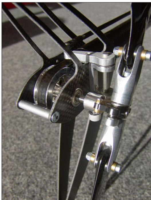
Die Schubstange ist oberhalb des 25er-Heckrohrs geführt. An den Heckrotor-Blatthaltern sind Propeller-Momentgewichte berücksichtigt
