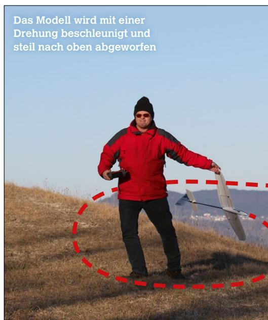
Das Modell wird mit einer Drehung beschleunigt und steil nach oben abgeworfen
