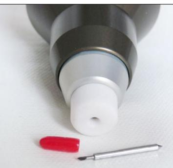
Die Schneidspitze am linken Ende sollte einen 60 Grad Anschlag haben, um sie mit den meisten Oracover oder ähnlichen Folien nutzen zu können. Die kegelig zulaufende rechte Seite wird vom Magneten in der Halterung angezogen, um das Messer frei rotieren zu lassen, damit es den Kurven folgen kann
