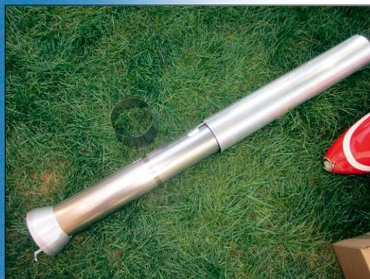
Das Schubrohr kommt von Turbodiddi und ist extra für die Futura angefertigt worden
