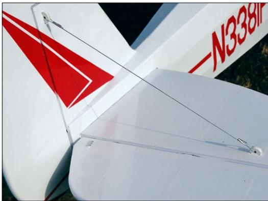
Wie bei der Großen: Die Leitwerke sind mit Stahllitze abgespannt
