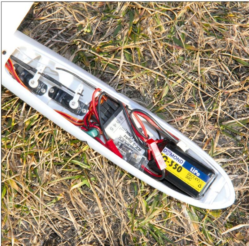
Verwendet man den von Staufenbiel zum Modell angebotenen 2s-LiPo-Akku, ist keinerlei Trimmblei notwendig und es bleibt ausreichend Platz für Empfänger und Spannungsregler
