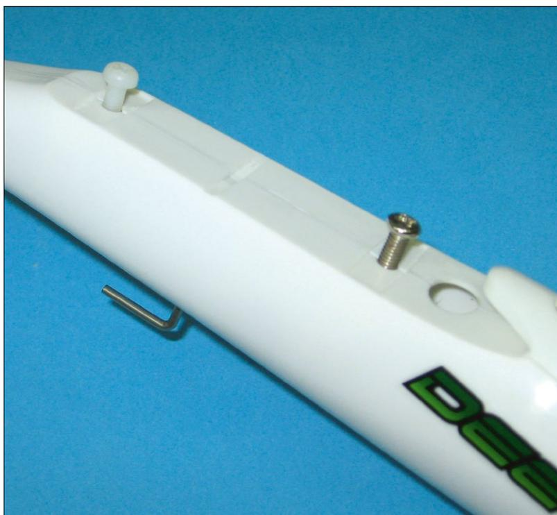
Die Flächenaufnahme ist fertig und passgenau erstellt. Bemerkenswert ist der eingebaute Hochstarthaken. Dadurch lässt sich der DEE-L-GEE mit einem RES-Hochstartgummi in thermikverdächtige Höhen bringen
