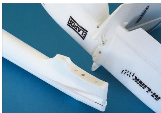
Arretierungsstifte und eine Nylonschraube fixieren die Leitwerke sicher auf dem Rumpf
