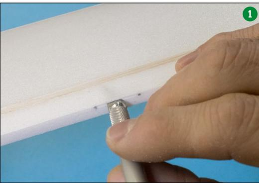
1 Legen Sie fest, an welchen Stellen die Scharniere sinnvollerweise eingesetzt werden sollen. Für „normale“ Parkflyer genügen zwei bis maximal drei pro Ruderblatt. Mit einem spitzen Skalpell wird nun mit viel Augenmaß ein Schlitz eingestochen, und zwar exakt parallel zur Oberfläche
