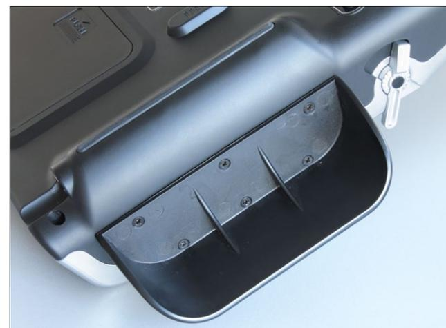
Die Handauflagen sind verschraubt und fixieren auch Ober- und Unterseite des Sendergehäuses
