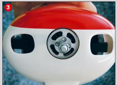
Der Motorspant dient als Bohrschablone fürs Brandschott (1) Mit den Muttern lassen sich Sturz und Seitenzug einstellen. Der Motor Boost 40 von Pichler hat sich als idealer Antrieb entpuppt (2) Durch die „versetzte“ Schraubenmontage fluchtet der Motor exakt mit der Öffnung in der Cowling (3)
