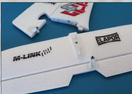
Das demontierbar ausgeführte Leitwerk steigert den Nutzwert des Modells
