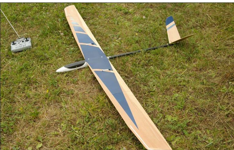
Abbildung 7: Die Evolution von Art-Hobby – mit zunehmender Erfahrung des Piloten wurde aus dem Anfänger-Modell durch Rücklage des Schwerpunkts ein Thermik-Leistungssegler
