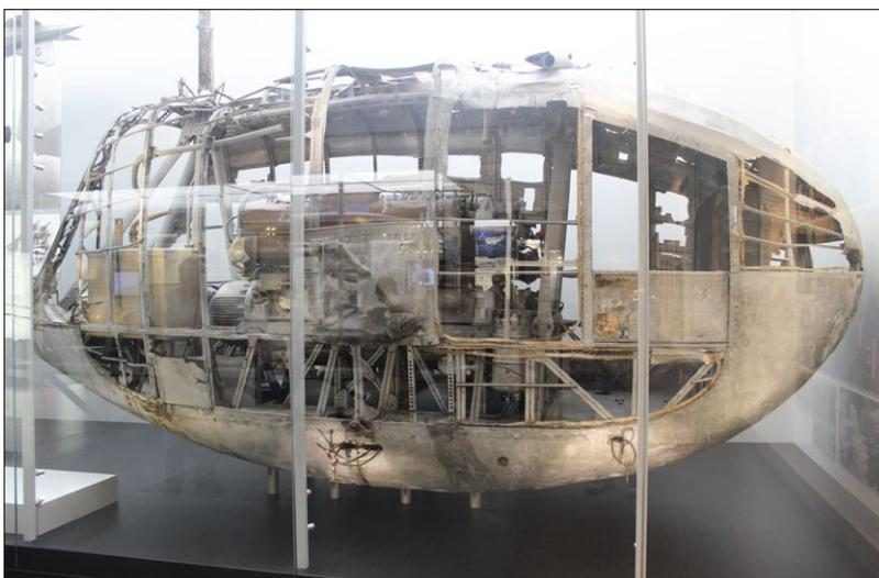
Ausgebrannte Backbord-Motorgondel mit Maybach-Motor aus dem verunglückten LZ 129
