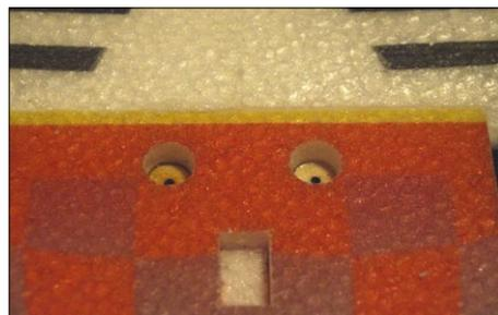
Die Sperrholzteile werden quasi „unter Putz“ im Rumpf verklebt. An ihnen wird später der CFK-Fahrwerksbügel verschraubt
