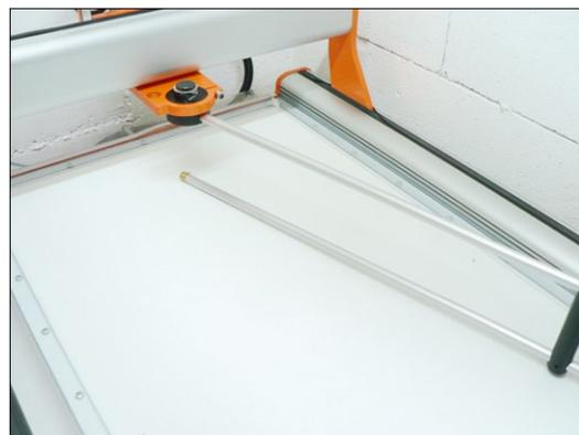
Die lange Halterung setzt mindestens bei einer der beiden Seiten viel Platz voraus, damit auch möglichst viel der Aufspannfläche genutzt werden kann. Die Kabelführung sollte zudem über das Portal verlegt werden, um ein Herabhängen der Halterung zu verhindern – dies führt bei dickeren Schaumstoffen sonst zu schrägen Kanten
