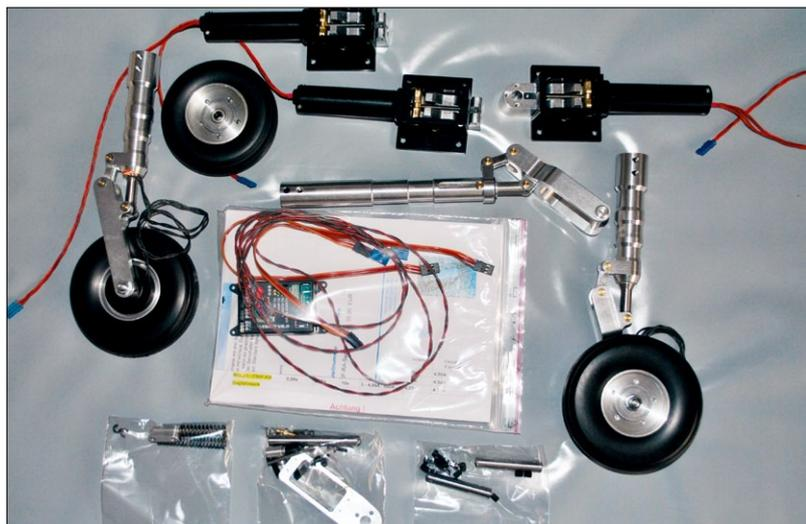
Behotec hat das passende elektrische Fahrwerk für die Futura im Programm. Sehr stabil, langlebig und zuverlässig sind die Eigenschaften dieser Teile von Thomas Berkold
