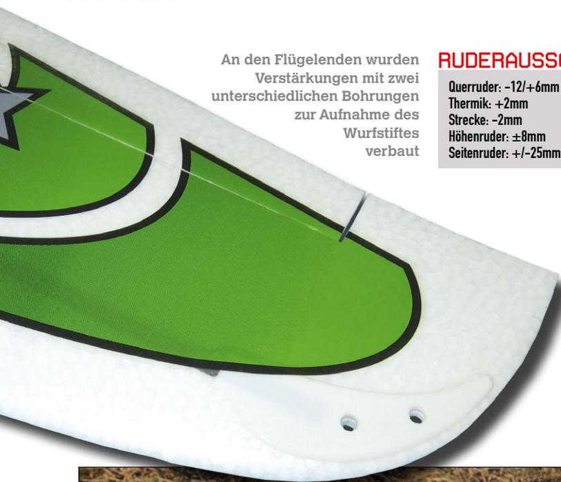
An den Flügelenden wurden Verstärkungen mit zwei unterschiedlichen Bohrungen zur Aufnahme des Wurfstiftes verbaut
