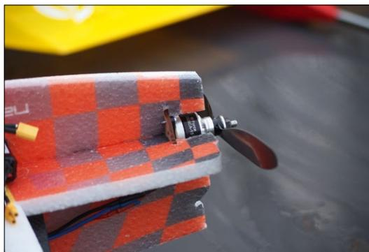
Gut zu sehen ist der Holzspant, der eine stabile Unterlage für den Motor bietet
