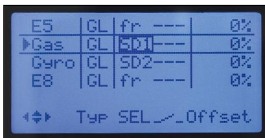
Im Gebermenü können mit wenigen Handgriffen Funktionen Dreh- oder Schieberegler zugeordnet werden
