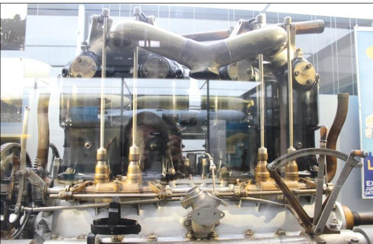
Exponat eines Daimler-Luftschiffmotors H4L mit 105 PS, wie er ab 1908 verwendet wurde
