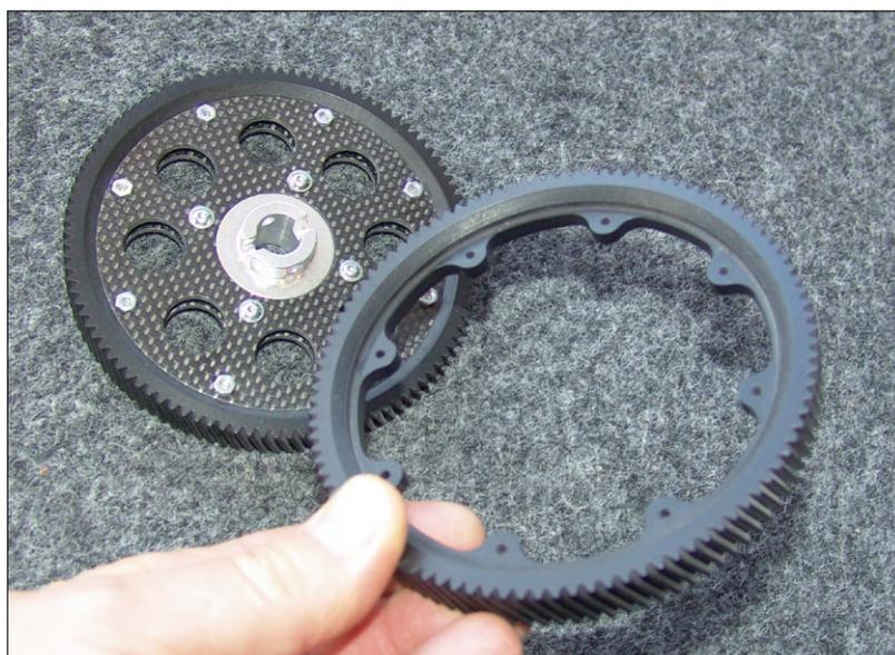
Das Hauptzahnrad besteht aus einem Kunststoff-Zahnkranz, der mit den Carbonspeichen verschraubt wird – eine geniale Idee
