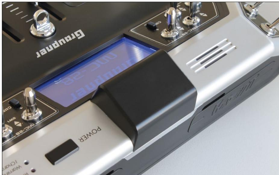
Integriert, aber nicht versteckt: Die polarisierte Patch-Antenne
