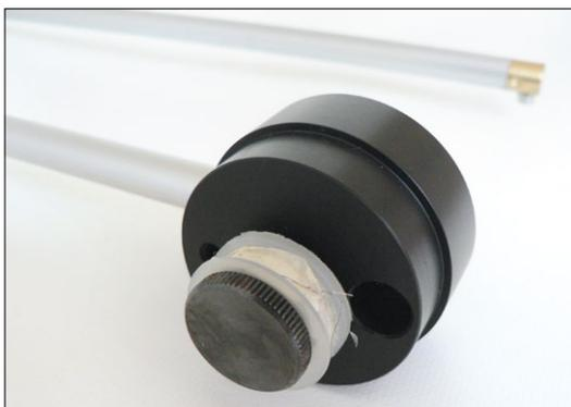
Mit der Zeit sammeln sich Reste um den Draht und die Verzunderung setzt der Oberfläche zu. Nach einiger Zeit reißt dann der Draht, daher hat man auf der Trommel mehr als genug Ersatzdraht. Der Zeitpunkt des Wechsels hängt stark von den Parametern ab und muss daher ebenfalls erarbeitet werden
