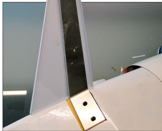
Die Verkleidungen des Fahrwerks aus Tiefziehmaterial müssen noch ausgeschnitten werden und decken dann die Alubügel ab
