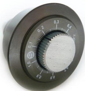
Die Messerspitze muss mit einem bestimmten Abstand aus dem Messerhalter herausragen, dieser wird sehr feinfühlig über eine Skala justiert. Je nach Dicke der Folie reichen in der Regel Werte zwischen 0,1 und 0,3 Millimeter völlig aus
