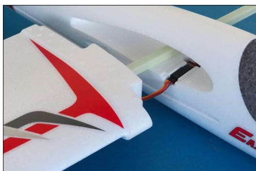
Ein Vierkantholm sorgt für Stabilität. Die Kabelkontakte sind ab Werk fertig installiert
