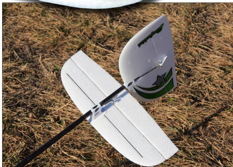
Das Höhenleitwerk wird mit einer Schraube am Rumpf befestigt. Das Seitenruder ist bereits im Auslieferungszustand mit dem Kohlefaserrohr verbunden
