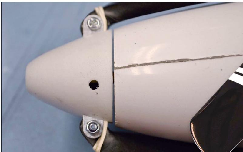
Durch den eingebauten Motorspant sitzt der Spinner perfekt am Rumpf. Die Rumpfnähte sind nicht so schön ausgeführt
