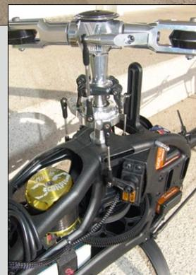
Markanteste technische Aufwertung beim Logo 550 sind der Alu-Hauptrotorkopf mit 8er-Blattlagerwelle und die größere Taumelscheibe
