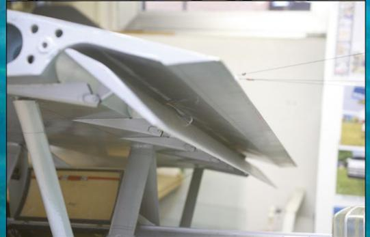
Zahlreiche Details kennzeichnen das Modell wie diese drei Venturidüsen, die beim Original den Unterdruck für die entsprechenden Anzeigeinstrumente erzeugen
