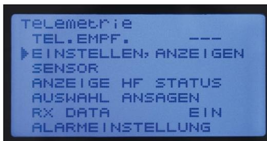
Hochinteressant ist die Möglichkeit, Empfänger über den Sender zu programmieren. Da der beiliegende GR-18 ein vollwertiges Flybarlesssystem beinhaltet, können alle Parameter dafür über die Fernsteuerung vorgenommen werden
