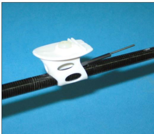
Das Höhenruder aus Schaum sitzt auf einem erhöhten Pylon aus gespritztem Kunststoff und wird dadurch absolut exakt in Position gehalten
