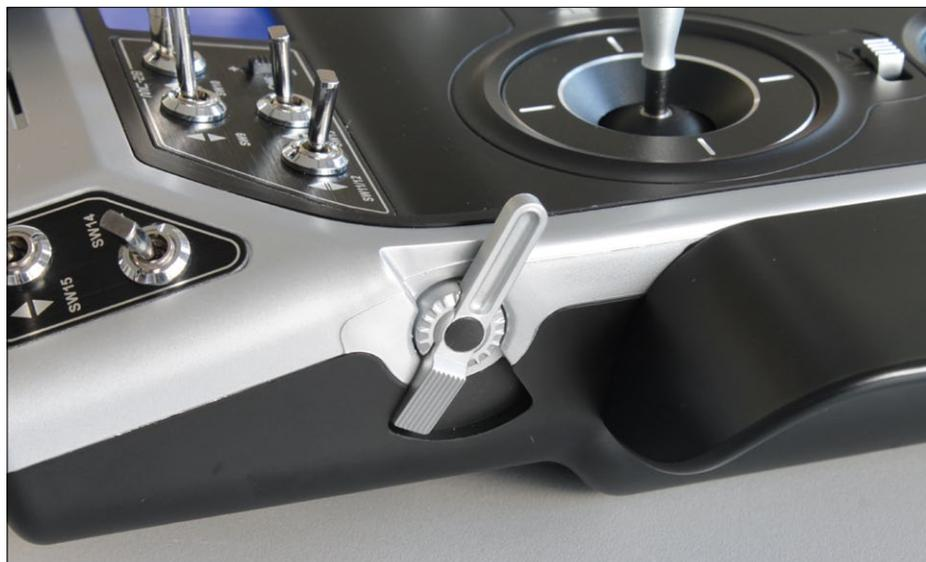
Die seitlichen Drehgeber können von oben oder unten bedient werden
