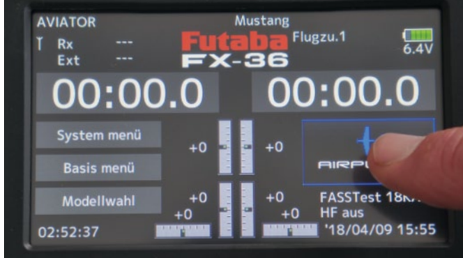
Der berührungsempfindliche Bildschirm ermöglicht ein schnelles und gezieltes Navigieren durch die Menüs – einfach auf ein Feld drücken und weiter geht's
