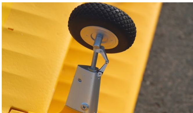
Das gefederte Fahrwerk sorgt für sanftes Rollen bei Start und Landung
