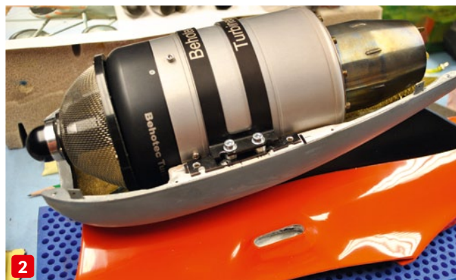
Die untere Gondelhälfte wird exakt eingepasst und Lücken zwischen Rumpf und Träger geschlossen (1). Die Befestigung der Behotec 130 selbst ist nach bewährter Methode ausgeführt. Hier noch zu sehen ist das lange Gondelende, das später eingekürzt werden musste (2)
