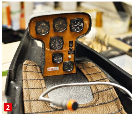
Die lederne Auflage besteht aus Kunstleder und einem Schaumstoffkern. Die Nähte sind selbst ausgeführt (1). Ein Instrumentenpiz gehört wie die Cockpitwanne zum Lieferumfang der DG-800S. Ein besonderer Effekt ist das Wurzelholzimitat (2)
