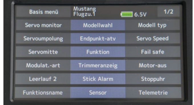
Das Basis-Menü ist eines von drei Hauptmenüs. Hier platziert sind wichtige Untermenüs wie Modellwahl und -typ, Modulationsart, Alarme, Telemetrie-einstellungen und mehr
