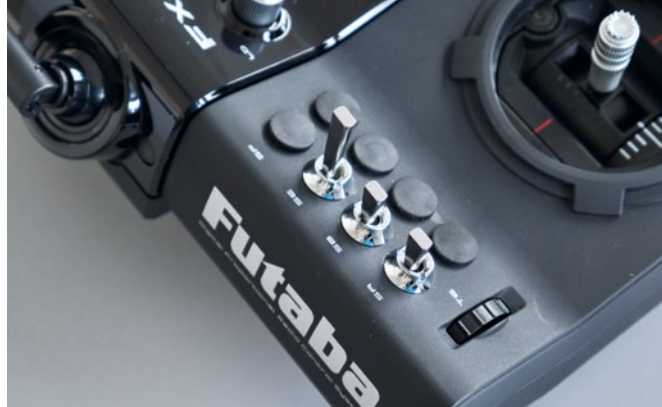
Für zwei weitere Schalter bietet die FX 36 noch einen Ausbauplatz. Entweder in einem der Schalterplätze oder in den Sticks
