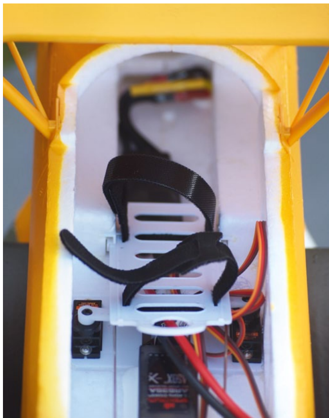
Die Akkurutsche mit den Klettbandern ist verschiebbar eingebaut, damit sich der Schwerpunkt genau ausrichten lässt
