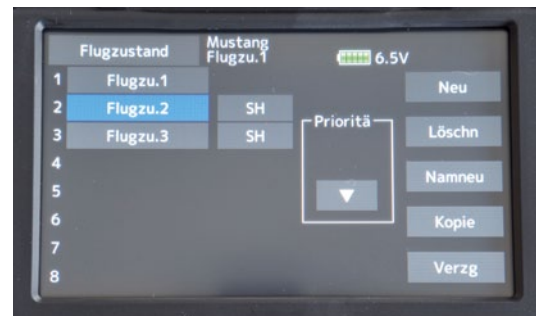
Bei jedem Flächenmodell sind bis zu acht Flugphasen einstellbar. Da Schalter mit Logik-Funktionen belegt werden können, sind auch sinnvolle Zustände programmierbar
