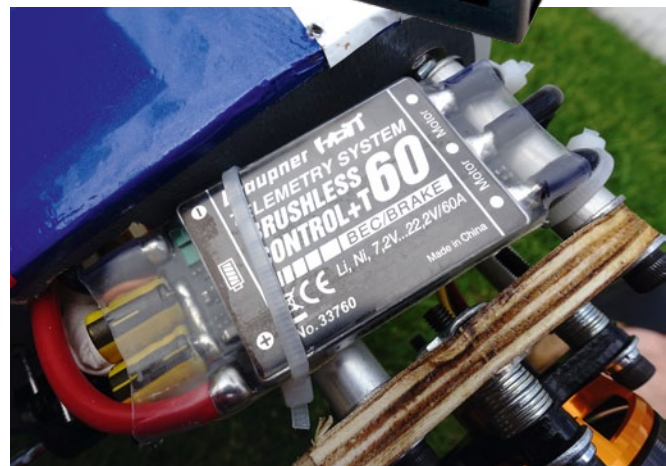
Von seinem Arbeitsplatz aus liefert dieser Regler wertvolle Daten wie Strom, Spannung, Drehzahl, Temperatur und Kapazität - alles wird in Echtzeit an den Empfänger weitergereicht
