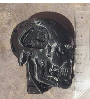
Ein guter Modellbaukollege fertigte mit seinem 3D-Drucker die Figurenelemente für den T-800. Dass die Oberfläche so wenig porös ist, liegt an der Nachbehandlung mit Aceton
