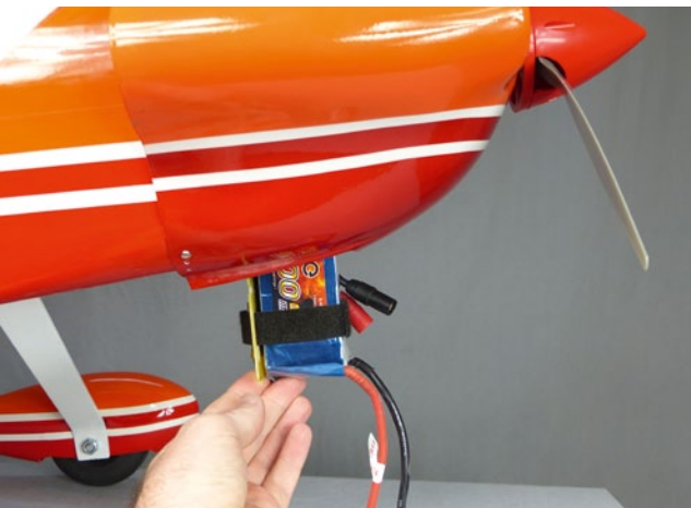
Auch bei aufgesetzter Haube lässt sich der Akku problemlos einschieben und lösen
