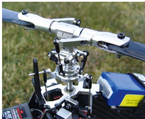
Der Rotorkopf ist komplett aus Aluminium gefertigt. Alle drehenden Teile sind mehrfach kugelgelagert und nahezu spielfrei
