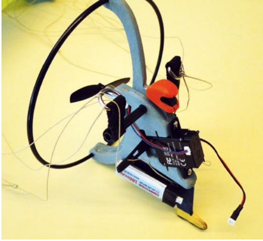
Alles inklusive wiegt die Gondel nur 36 Gramm, der Schirm weitere 7 Gramm
