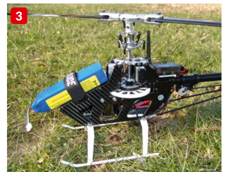
Das Spektrum-eigene AS3X Flybarless-System beinhaltet einen Sechskanal-DSMX-Empfänger. Alle Einstellungen für den Blade 360 CFX 3s sind bereits vorprogrammiert (1). Das mit der Hauptrotorwelle verschraubte Riemenrad lässt den Heckrotor in der Autorotation mitdrehen (2). Der Controller sitzt versteckt direkt unter der Hauptrotorwelle. Das AS3X Flybarless System findet seinen Platz auf einer separaten Plattform über dem Heckrohr (3)
