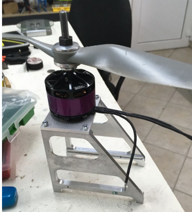
Erstes probeweises Zusammenschrauben der Teile. Noch sitzt der Motor etwas zu weit oben am Träger
