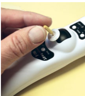
Wer keine Daumensteuerung mag, kann den mz-4-Sender auch mit einem Knüppel nachrüsten
