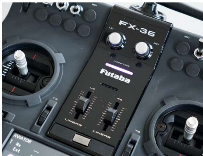
Mittig im Sender sind vier originäre Schiebe-/Dreh-Geber platziert, es lassen sich aber auch alle sechs Trimmer beliebig mit Funktionen belegen oder zu Schaltern ummünzen
