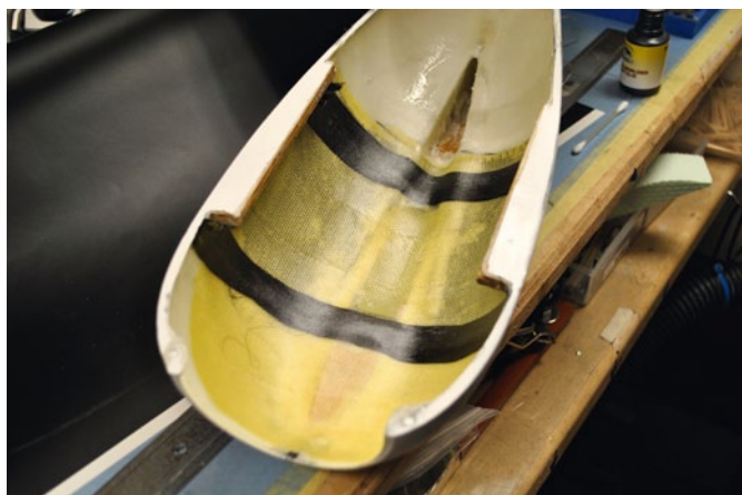
Statt die Turbine einfach nur stumpf auf dem Rumpf zu montieren, erhielt sie eine zweischalige – hier eine Hälfte – Ummantelung aus GFK
