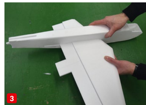
Der Rumpfdeckel kann flach auf der Arbeitsplatte liegend angeklebt werden (1). Der hintere Rumpfboden schließt den Rumpfkasten. Am besten eignet sich Uhu Por zum Verkleben – es dichtet auch sehr gut ab (2) Der Flügel wird von einer Seite in den Rumpfkasten geschoben, dann ausgerichtet und verklebt (3)
