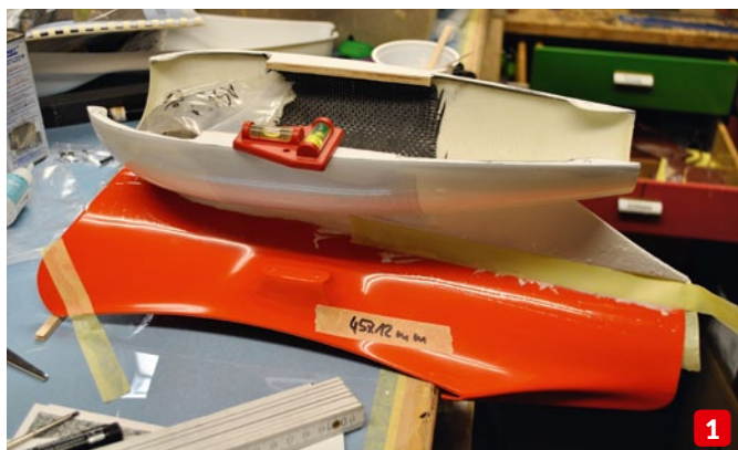
Die untere Gondelhälfte wird exakt eingepasst und Lücken zwischen Rumpf und Träger geschlossen (1). Die Befestigung der Behotec 130 selbst ist nach bewährter Methode ausgeführt. Hier noch zu sehen ist das lange Gondelende, das später eingekürzt werden musste (2)
