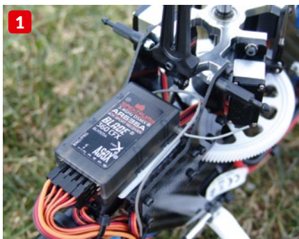
Das Spektrum-eigene AS3X Flybarless-System beinhaltet einen Sechskanal-DSMX-Empfänger. Alle Einstellungen für den Blade 360 CFX 3s sind bereits vorprogrammiert (1). Das mit der Hauptrotorwelle verschraubte Riemenrad lässt den Heckrotor in der Autorotation mitdrehen (2). Der Controller sitzt versteckt direkt unter der Hauptrotorwelle. Das AS3X Flybarless System findet seinen Platz auf einer separaten Plattform über dem Heckrohr (3)
