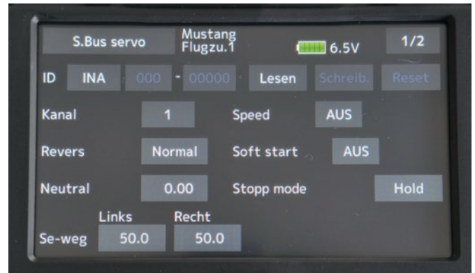
Praktisch ist das S.Bus-Servo-Untermenü zum gezielten Setup dieses Servotyps, der besonders bei größeren Modellen viele Vorteile bietet
