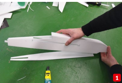
Der Rumpfdeckel kann flach auf der Arbeitsplatte liegend angeklebt werden (1). Der hintere Rumpfboden schließt den Rumpfkasten. Am besten eignet sich Uhu Por zum Verkleben – es dichtet auch sehr gut ab (2) Der Flügel wird von einer Seite in den Rumpfkasten geschoben, dann ausgerichtet und verklebt (3)
