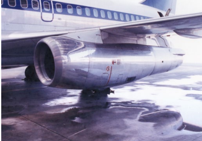
Die Cowling der 737-200 in Naturmetall verkleidet das Pratt & Whitney Strahltriebwerk (Foto: Gary Gray)
