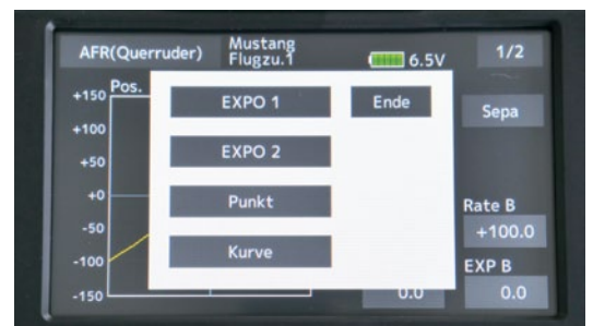
Eine Futaba-Spezialität sind Kurveneinstellungen. Bis zu 17 Punkte, je nach Funktion, lassen sich anwählen. Doch zunächst ist der Kurventyp zu bestimmen
