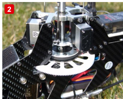
Das Spektrum-eigene AS3X Flybarless-System beinhaltet einen Sechskanal-DSMX-Empfänger. Alle Einstellungen für den Blade 360 CFX 3s sind bereits vorprogrammiert (1). Das mit der Hauptrotorwelle verschraubte Riemenrad lässt den Heckrotor in der Autorotation mitdrehen (2). Der Controller sitzt versteckt direkt unter der Hauptrotorwelle. Das AS3X Flybarless System findet seinen Platz auf einer separaten Plattform über dem Heckrohr (3)
