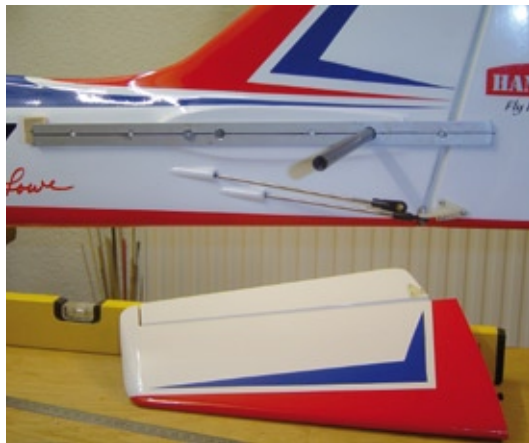
Die Korrektur der sich aus den werksseitigen Bohrungen ergebenden negativen Einstellwinkeldifferenz erfordert Sorgfalt und lässt sich am besten mit einer Bohrschablone vornehmen
