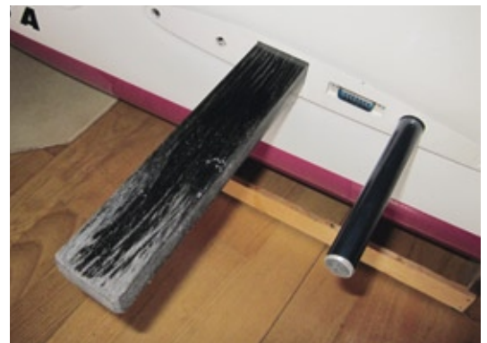
Die beiden Steckrohre, vorne CKF und hinten Aluminium
