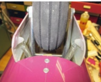
Fahrwerk zu Testzwecken ausgefahren. Gut erkennt man die Kunststoffstücke für die Klappen
