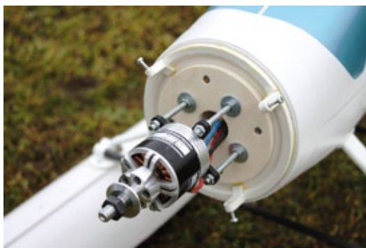
Zur Montage eines Elektroantriebs wurden Abstandshalter eingebaut
