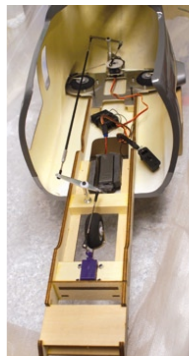
Der provisorisch eingesetzte Holzmontagerahmen inklusive dem komplett montierten Einziehfahrwerk
