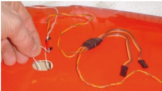
Das Einziehen der Servokabel erfordert trotz der Verlegehilfe ein wenig Geduld. Wird ein Einziehfahrwerk genutzt, muss der Druckschlauch sofort mit hinein
