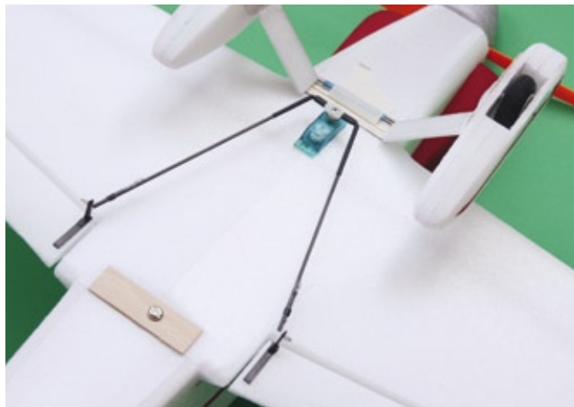
Hinten fixiert eine Schraube, die in eine Mutter greift, die Fläche mit dem Rumpf. Vorne nehmen zwei Dübel die Fläche auf
