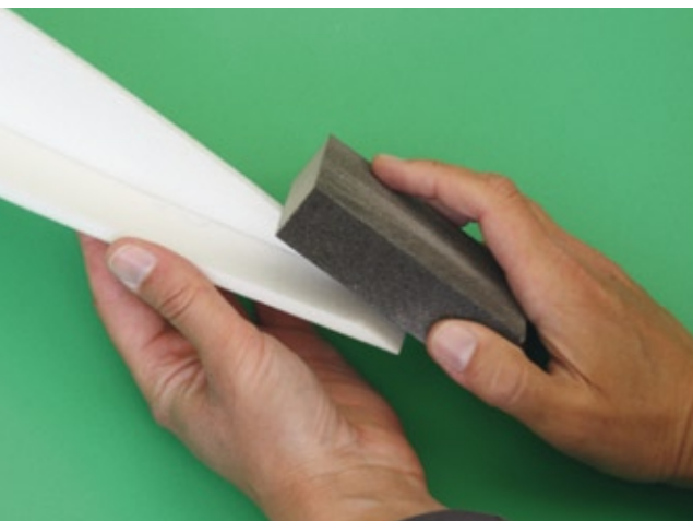
Erst wird das kürzere Seitenteil am Mittelboden angeklebt und dann am Heck dem Konturverlauf entsprechend verschliffen
