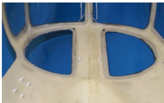
Deutlich zu erkennen sind die Haltehülsen, welche zunächst von der Innenseite her gesteckt werden
