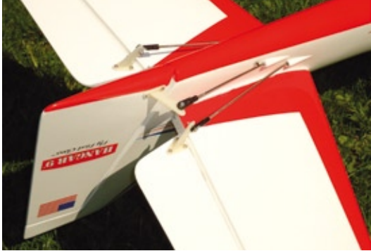
Für die Anlenkung der Ruder wurde beim Testmodell der Einsatz von Kugelköpfen favorisiert
