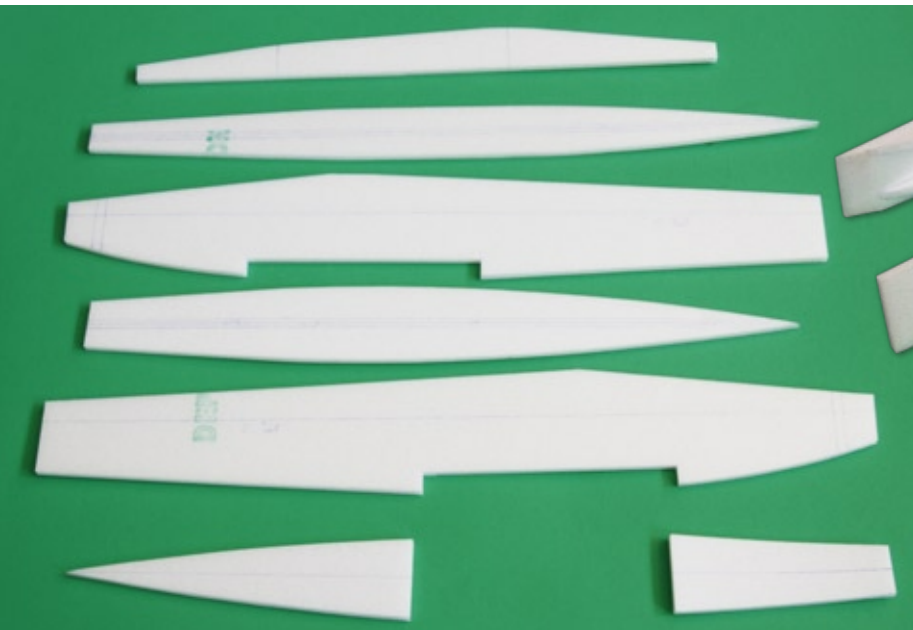
Alle Rumpfteile bestehen aus 6-Millimeter-Depron. Für die Tragfläche sind die Ausschnitte bereits vorgesehen
