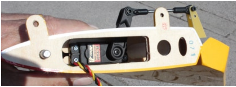
Steht eher 3D-Aerobatic im Fokus, sind die stabilen 38-mm-Gabelservohebel von Gabriel ( www.ganz-klar-vitrinen.de ) genau richtig
