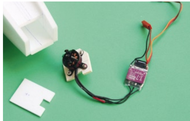
Bevor der obere Rumpfteil eingebaut wird, ist der Motor A10-12S samt Spant und Träger einzubauen
