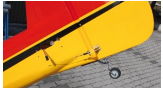
Das Seitenleitwerk ist mit Stahlseilen und das Spornrad mit einem Stahldraht angelenkt, der mittels Kugelkopfelenk mit dem Seitenruderblatt verbunden ist
