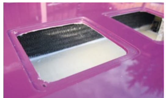
Hier ist sehr gut der D-Box-Holm zu sehen. Er zieht sich durch den ganzen Flügel
