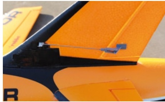
Beim Seitenleitwerksservo ist ein Stück schwarzes Gewebeband unauffälliger als die beiliegende transparente Abdeckung
