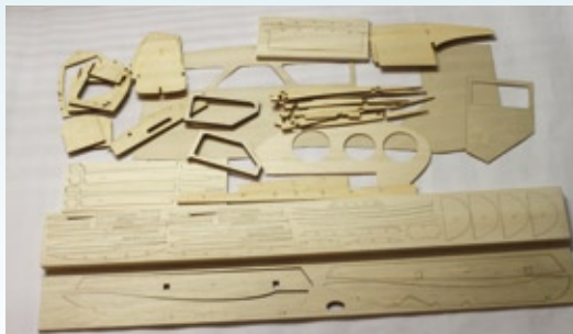
Der Teilesatz einer D.H. 89 Dragon Rapide mit 2.480 Millimeter Spannweite wurde per Lasertechnik aus dem Holz geschnitten
