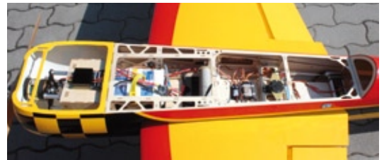
Elektroantrieb und Elektronik: AXI-Außenläufer, Regler Spin-125, Antriebsakku 12s-LiPo mit 5.000 Milliamperestunden Kapazität, Expander E4 für Telemetrie, Empfänger Duplex R8-EPC, Seitenruder-servo, elektronischer Schalter Jeti DPS-40 und 2s-Empfänger-LiPo
