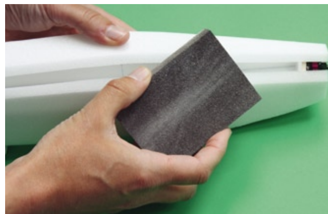
Ein Schleifschwamm leistet wertvolle Hilfe, um ein sauberes Schleifergebnis zu erzielen
