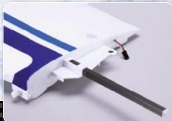
Die Tragfläche ist geteilt aufgebaut und kann für den Transport mit wenigen Handgriffen demontriert werden. Die Verbindung der beiden Tragflächenhälften erfolgt über ein kraftschlüssiges Steckungssystem aus Kohlefaser.
