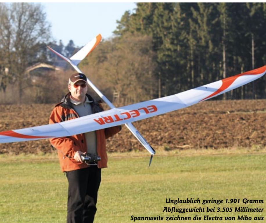
*Unglaublich geringe 1.901 Gramm Abfluggewicht bei 3.505 Millimeter Spannweite zeichnen die Electra von Mibo aus*
