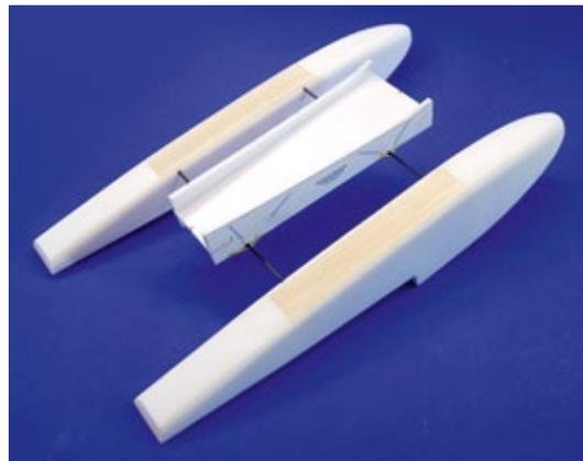
**Dank des auf dem Depron aufgeklebten Plan-Papiers sind die Winkel für die Drahtstäbe gut zu erkennen**
