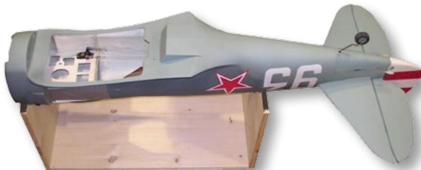
**Um den Bau und den späteren Zusammenbau auf dem Flugplatz zu erleichtern, bietet sich ein entsprechendes Gestell aus Holz an**
