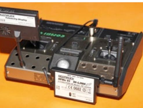
**Das HF-Modul wird mittels Klettband an der Gehäuse-Vorderseite befestigt, das Telemetry-Display an einem der freien Schalterplätze befestigt**
