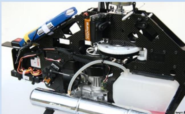
*Der O.S. MAX 55HZ mit angeflanschem Kompaktdämpfer. Gut zu erkennen sind auch das Hauptgetriebe und der Heckantrieb mit den beiden Kegelrädern*
