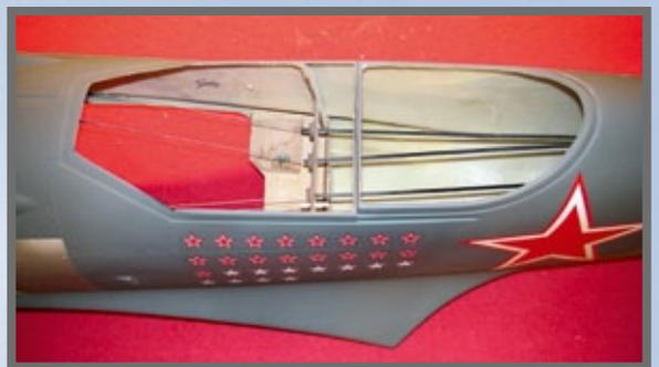
**Der Rumpf wurde rund um den Kabinenhaubenausschnitt aufgesägt, um einen Cockpitausbau zu ermöglichen**
