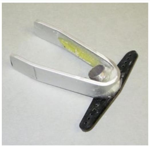
**Das Drehlager ist ein hartes V2A-Rohr, das mit Uhu Plus 300 endfest im U-Winkel und dem Steuerhebel verklebt ist**
