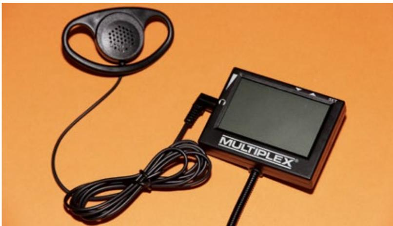
*Das Display ist mit einem kleinen Lautsprecher und einer Kopfhörerbuchse samt Lautstärkeregelung ausgestattet. Sehr sinnvoll, wenn man den MPX-eigenen Variosensor nutzen möchte, ohne seine Flugkollegen zu stören*
