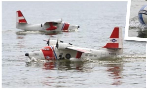
*Coast Guard im Einsatz. Claus Stoeven und Peter Sydow bauten ihre beiden 1.800 Millimeter spannenden Grumman Albatros parallel nach einer Aeromax-Dokumentation aus dünnem Sperrholz*
