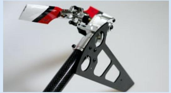
Der Heckrotor mit Alu-Gehäuse und dem 90-Grad-Kegelradgetriebe
