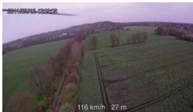
**FPV-Bild, hier mit nachträglich eingeblendeten Geschwindigkeitsdaten. Die CamOne Infinity stellt hierfür ein entsprechendes Logfile zur Verfügung, das während des Flugs aufgenommen wird**
