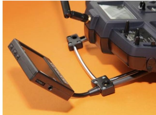
**Zur Befestigung des Displays an die unterschiedlichsten Handsendertypen liegen dem Display Kunststoffteile bei, womit sich die Telemetrieanzeige sicher an den Griffbügeln befestigen lässt. Hier zu sehen am Beispiel der Cockpit SX M-Link**
