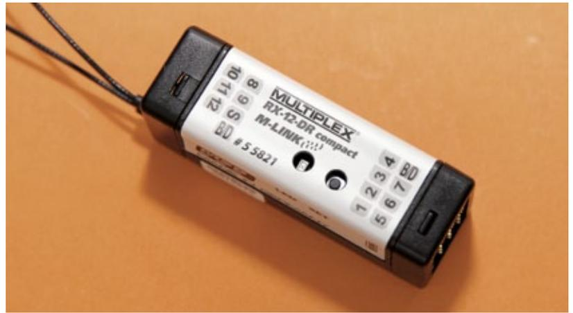
**Der RX-12 DR compact M-Link-Empfänger besitzt die Servoanschlüsse auf beiden Seiten. Zudem ist er mit zwei unterschiedlichen langen Antennen ausgestattet, um die optimale Verlegung auch in kleinen Rümpfen zu ermöglichen**
