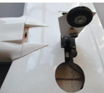
**Für das Einziehfahrwerk muss der Flächenausschnitt etwas vergrößert werden. Die Abdeckplatte stellt die aerodynamische Ordnung wieder her**
