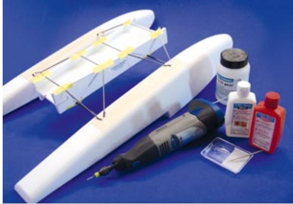
**Eine Minifräse, Fünf-Minuten-Epoxy und Micro-Ballons sind zum Einbau der Drähte erforderlich**
