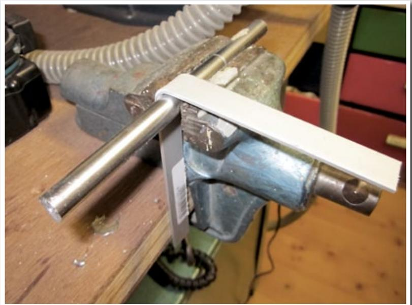
**Über ein Rohr und eingespannt im Schraubstock wird der U-Winkel passen gebogen**
