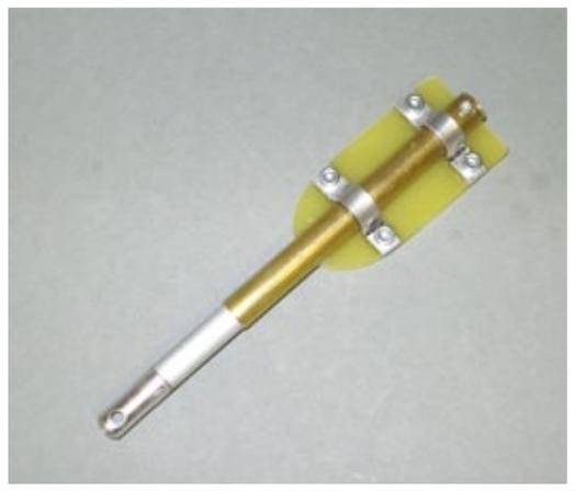
**Die Platte ist mit Uhu Plus 300 endfest am Hauptrohr befestigt und über die Schellen fixiert. Unten erkennbar ist die Bohrung zur Aufnahme des späteren CFK-Stabs zwecks Fixierung des Bauteils**
