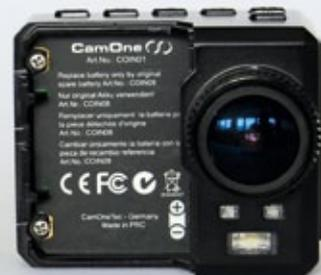
*... kommt man problemlos an den LiPo mit 800 Milliamperestunden Kapazität. Entsprechende Wechselakkus sind bei Aeme erhältlich*
