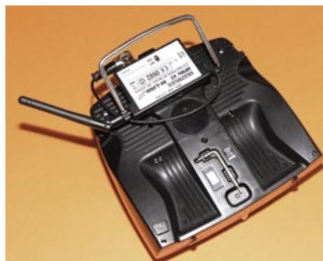
**Das HF-Modul wird einfach an der Gehäuseunterseite befestigt, der Griffbügel sorgt dafür, dass der Sender nicht auf dem HF-Modul aufliegt**
