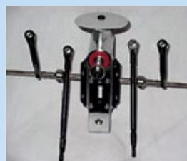
*Markant an der Konstruktion des Hauptrotors ist die axial verschiebbare Stabstange, die die Verwendung eines Pitchkompensators hinfällig macht*
