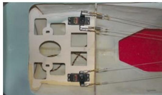
**Im Rumpf platziert sind die Servos fürs Höhen- und Seitenruder. Eine Besonderheit ist die zweite Seilanlenkung für das Heckspornrad**
