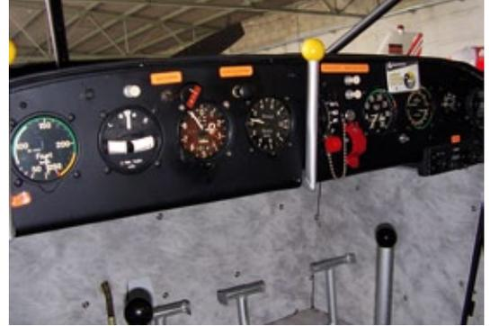
**Das sehr übersichtliche Instrumentenbrett der D-ECYS. Die Gashebel ragen direkt aus dem Instrumenten-Panel hervor**
