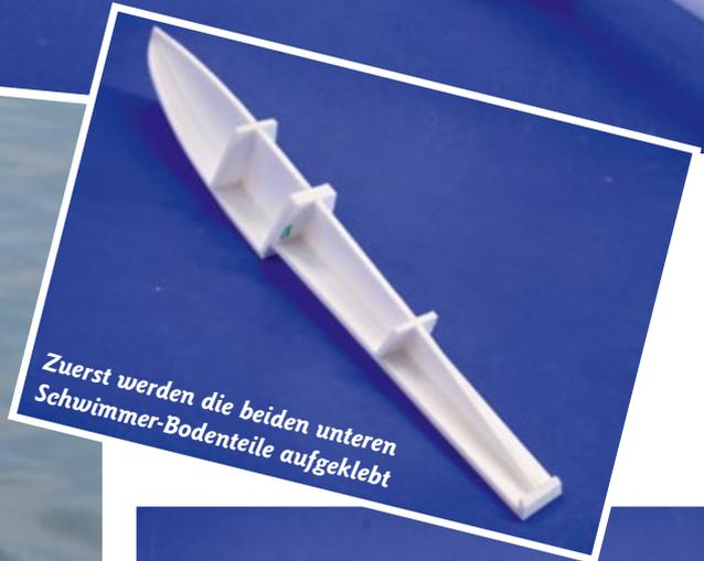
*Zuerst werden die beiden unteren Schwimmer-Bodenteile aufgeklebt*
