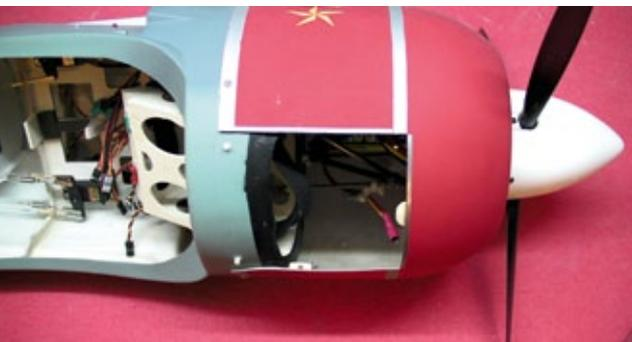
Durch einen Klappe kann die Motorhaube geöffnet werden, ein schneller Zugriff auf die Akkus ist somit gewährleistet
