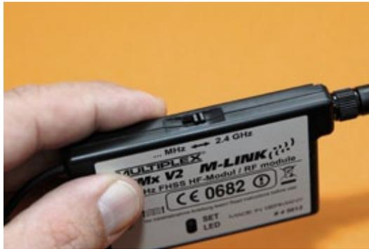
**(links) An der Oberseite des HF-Moduls befindet sich der versenkt eingebrachte Schiebeschalter zum Wechsel der Frequenzbänder**
