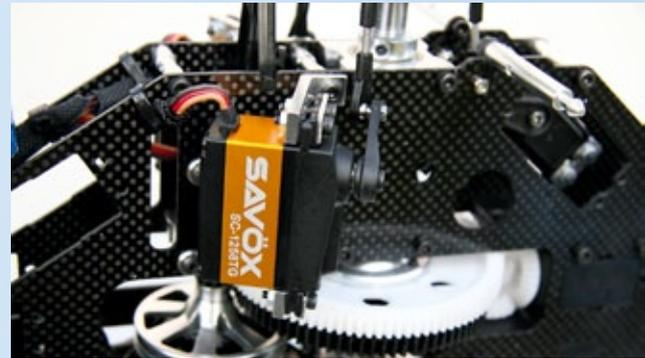
*Befestigung des rechten Rollservos über am CFK-Chassis angeschraubte Alu-Winkel*
