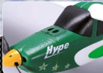
Der Antrieb des U-Can-Fly-Trainers erfolgt durch ein LiPo-Brushless-Power-System, das perfekt auf das Modell abgestimmt ist. Der Wechsel des Antriebsakkus erfolgt einfach und bequem über einen Deckel auf der Rumpfborsete.
