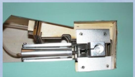
**In die Tragfläche eingebaute Fahrwerksmechanik. Lediglich die Beine sind noch zu montieren**
