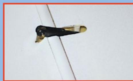
*An den Flächenrudern wurde der hohe Vorfertigungsgrad beibehalten, die Augschrauben sind bereits eingesetzt und die Anlenkungsgestänge eingehängt*
