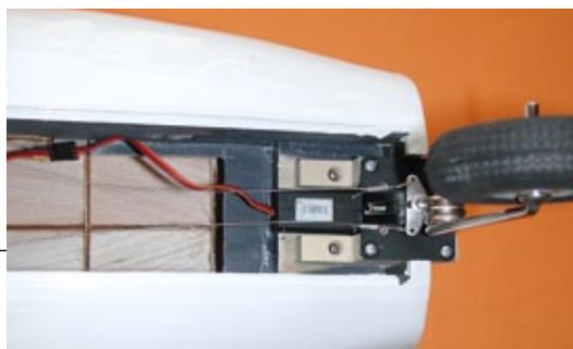
**Anlenkung durch flexible Stahllitzen**
