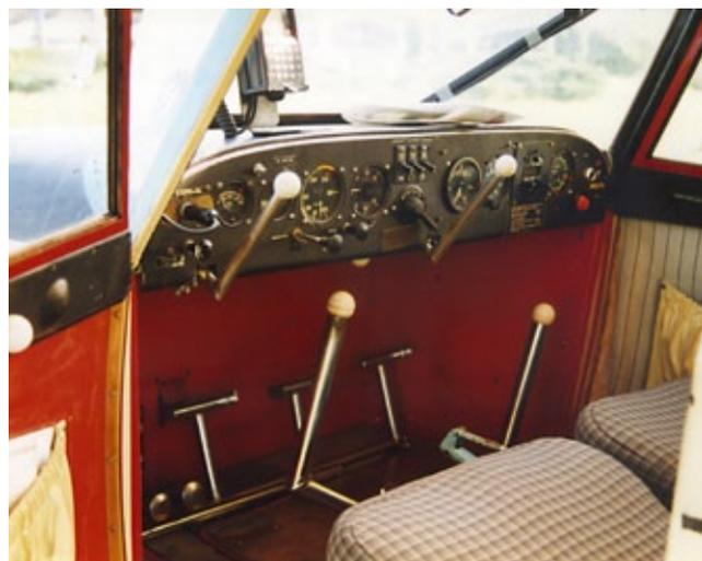
**Das Cockpit der D-EKYM. Funktionalität ist vorherrschend, alle Steuerorgane sind doppelt ausgelegt. Der Hebel für die Betätigung der Spreizklappen ist zwischen den Sitzen angeordnet**
