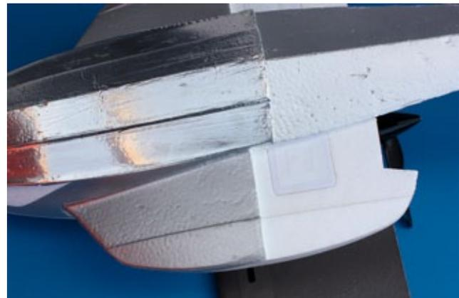
*Stabilität im Wasser erhält die Icon A5 durch die am Rumpf angeformten Stummelflügel. Der Rumpf wurde für den Einsatz auf vereister Schneedecke mit selbstklebender Alufolie verstärkt*
