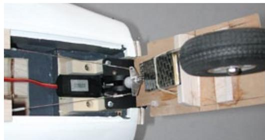
**Die Abdeckklappe – hier noch im Rohbau – ist multifunktional. Die Anbindung der Klappe an das Fahrwerksbein geschieht über Zahngummis. Diese reißfeste Sorte Gummiringe bekommt man in der Apotheke. Die schwarze Platte hält das Rad beim Einziehen gerade**
