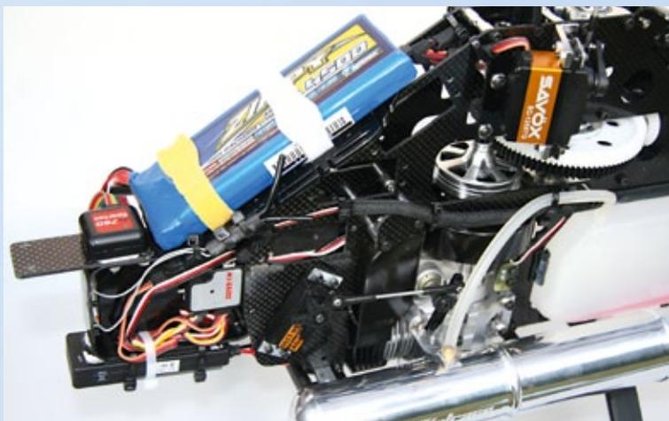
*Ansicht der linken Chassisseite mit Drehzahlregler, Gasservo und Glühelctronik*
