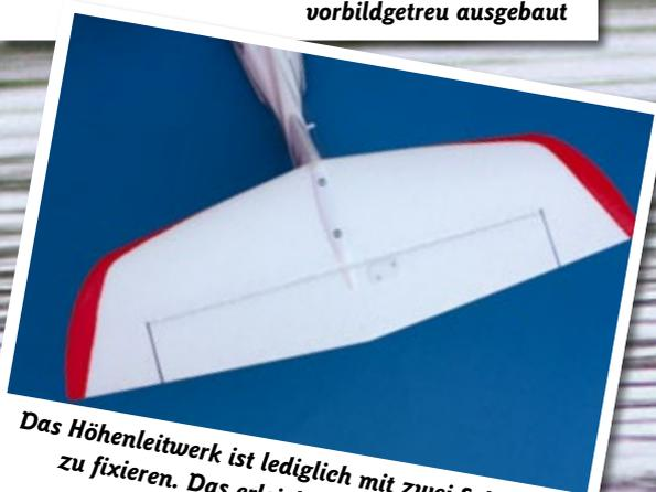
*Das Höhenleitwerk ist lediglich mit zwei Schrauben zu fixieren. Das erleichtert die Demontage zum Transport*
