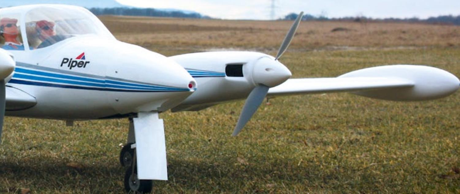
Starrfahrwerks nicht mehr, wenn die einziehbar Lösung gewählt wird. Letztere stützt sich, folgt man den Empfehlungen der englisch geschriebenen Bauanleitung, dann auf die üblichen Stahlfedern mit leider nur einer Federwindung. Eine Einfachlösung, die aller Erfahrung nach dem harten Flugplatzalltag oftmals nicht lange standhält. Zudem erfordert die werkseitig avisierte Lösung zum Wegschwenken des Fahrwerks je ein zusätzliches Servo für Haupt- und Bugräder.
