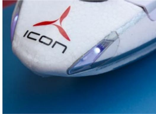
(Links) Die Querruderservos sind werkseitig eingebaut und mit dem Ruder verbunden (Rechts) Optional lassen sich LED in den dafür vorbereiteten Bugscheinwerfern einsetzen (Unten) Hoch oben im Cockpit ist der Spektrum-Empfänger platziert
