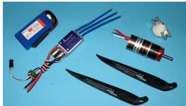
**Der F5J-Wettberbsantrieb von Mibo besteht aus einem Typhoon-Brushlessmotor mit angeflanschem KPG-Getriebe, einem 50-Ampere-Regler von Arrowind und einem 3s-LiPo von Hyperion. Die gesamte Einheit inklusive Luftschraube wiegt gerade einmal 298 Gramm**
