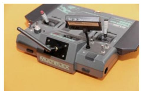
**Auch an einer Profi mc 4000 wurde das Telemetry-Display nachgerüstet. Einfach das Display an einen entsprechenden Schalterplatz schrauben und das Kabel mit dem COM-Anschluss am HF-Modul verbinden**
