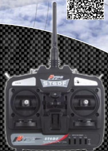
Die RTF-Version des U-Can-Fly-Trainers ist mit dem zeitgemäßen ST6DF-Fernsteuersystem ausgestattet, das über die zuverlässige 2.4GHz-Übertragungstechnik verfügt. In dieser Version ist der Empfänger bereits flugfertig im Modell montiert und mit allen Servos und dem Regler verbunden. Ebenso sind in der RTF-Version der 11,1V LiPo-Akku und das 12V-Balancer-Ladegerät enthalten.
