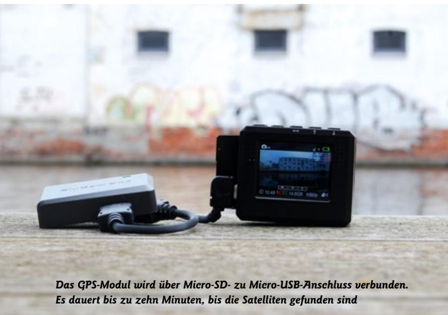
*Das GPS-Modul wird über Micro-SD- zu Micro-USB-Anschluss verbunden. Es dauert bis zu zehn Minuten, bis die Satelliten gefunden sind*
