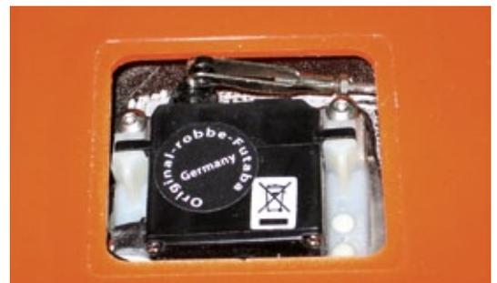
*Die Servos wurden mittels passender Servorahmen in die Flügel eingebaut. Das sorgt für einen sauberen Einbau und bei Bedarf auch schnellen Austausch*
