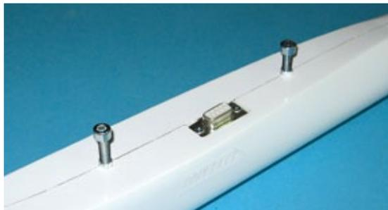
**Die Tragfläche wird mit zwei M5-Schrauben am Rumpf befestigt**
