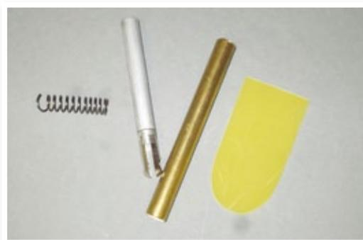
*Passend abgelängte Rohre aus Messing und Edelstahl bilden das Hauptrohr samt Federung*
