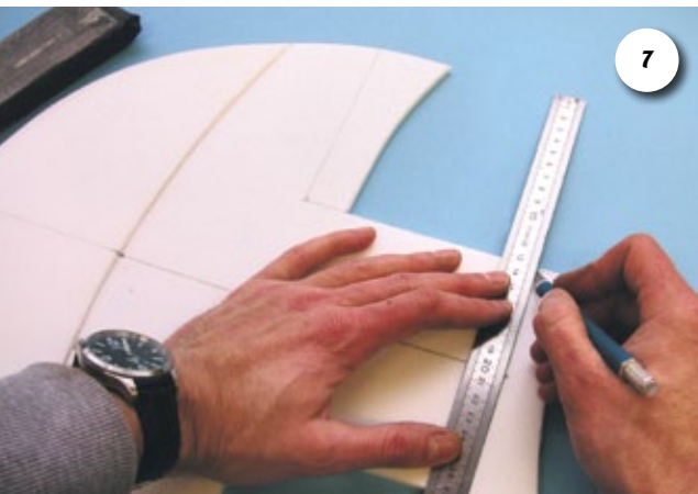
7 Die Ruder werden schräg abgeschnitten, das spart Schleifarbeit
