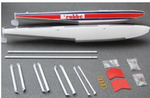
Die versammelten Bauteile für den Schwimmerbau
