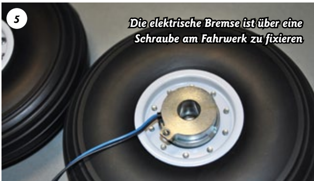
Gezieltes Bremsen wird durch die Magnetwirkung erzielt
