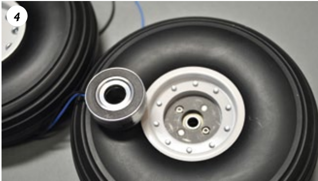
Gezieltes Bremsen wird durch die Magnetwirkung erzielt
