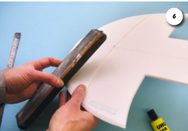
6 Die Nasenleiste wird symmetrisch geschliffen
