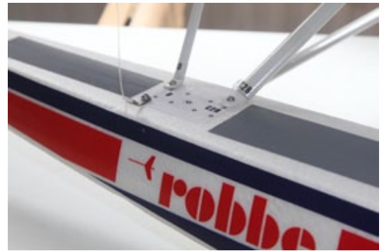
Die Schwimmerbefestigung rechts hinten mit dem Abspannseil der Tragfläche
