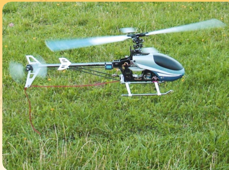
Abbildung 8: Ein kleiner T-Rex 450 – er fliegt sehr eigenstabil, zeigt jedoch ein merkliches Bodeneffekt-Verhalten
