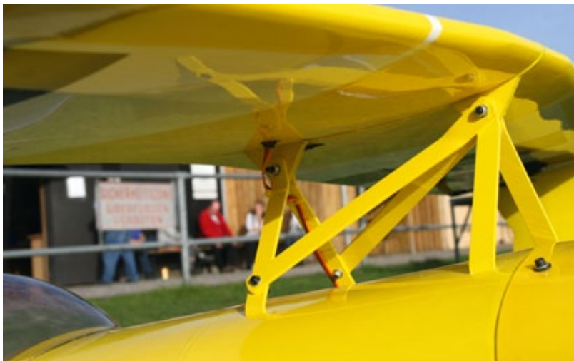
Die beiden oberen Querruderservos werden am Baldachin mit einem Verlängerungskabel gesteckt
