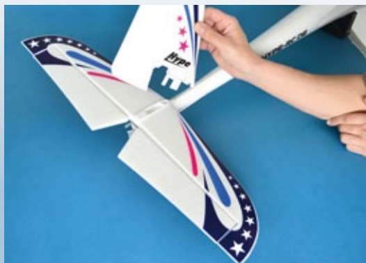
Plastikteile führen und sichern die Leitwerke auf dem Rumpf. Eine Schraube fixiert das Ganze dauerhaft
