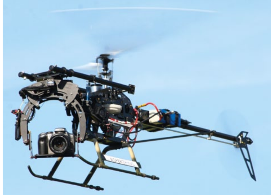
Der kameratragende T-Rex 700E im Einsatz. Deutlich zu erkennen sind auch die im Text erwähnten Stoßdämpfer
