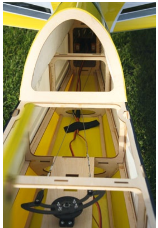
Eine Klettbandschleife sichert die Kabel der Höhenruderservos am Rumpfboden
