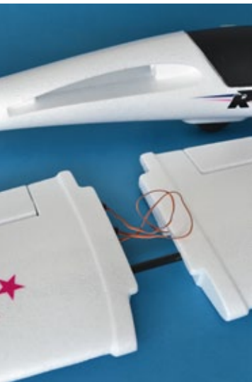
Die Flächen sind stabil über den CFK-Holm im Rumpf befestigt
