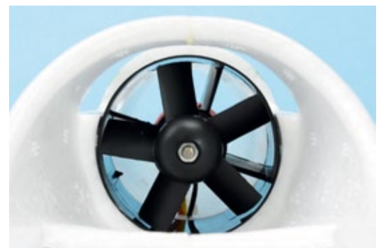
Der Fünfblattrotor schleift im Auslieferungszustand etwas am Mantel und muss gewuchtet werden
