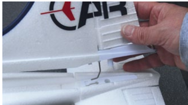
Montage des Seitenleitwerks: Der Lenkbügel greift in sein Gegenstück
