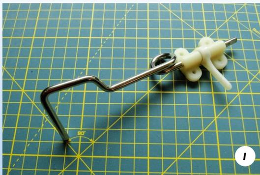
*Das mitgelieferte Drahtfahrwerk aus dem Baukasten. Dafür ist die schöne Cessna eigentlich zu schade*
