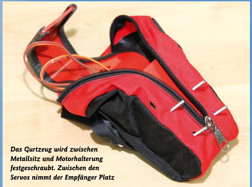
*Das Gurtzeug wird zwischen Metallsitz und Motorhalterung festgeschraubt. Zwischen den Servos nimmt der Empfänger Platz*
