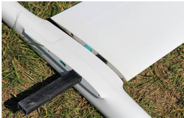
Der üppig dimensionierte CFK-Vierkant-Flächenverbinder hält allen Belastungen stand
