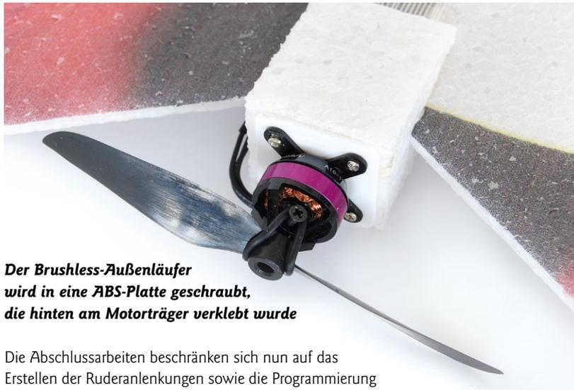
**Der Brushless-Außenläufer wird in eine ABS-Platte geschraubt, die hinten am Motorträger verklebt wurde**
