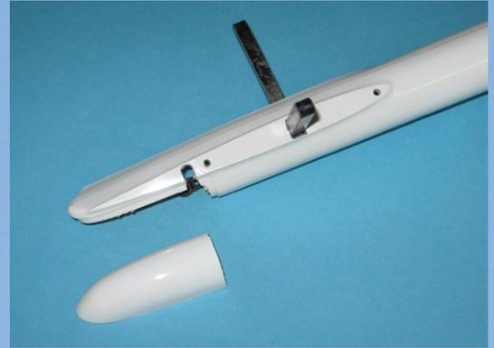
Die Steckung für das V-Leitwerk ist fix und fertig erstellt. Die Anlenkungen werden später mit einer kleinen Abdeckung aus GFK getarnt
