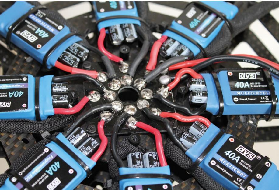
**Eine zentrale Einheit bildet die Stromverteilerplatte. Auf ihr werden alle Anschlüsse der acht Controller verlötet**
