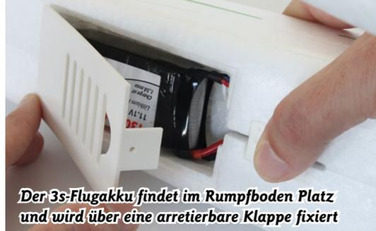
Der 3s-Flugakku findet im Rumpfboden Platz und wird über eine arretierbare Klappe fixiert
