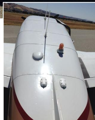
**Beim Blick von hinten über den Rumpf lässt sich erkennen, dass der Rumpf-Querschnitt fast rechteckig ausgeführt ist**
