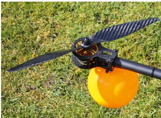
Zur besseren Lage-Erkennung dient eine orangefarbene Kunststoffkugel. Diese wurde am hinteren Ende eines Auslegers mittels Kabelbinder fixiert. Der Oktokopter MD8-800 kann mit Propellern von maximal 12 Zoll Durchmesser bestückt werden
