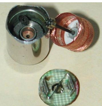
**Gut erkennbar die dünne, großenteils selbsttragende Wicklung des Coreless-Motors. Doch auch der Motorkern wird sichtbar, ein Dauermagnet, der gerade mal eine Unterlegscheibe festhält und unten der sehr filigran wirkende Bürstenapparat**
