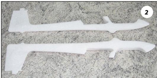
**Der Rumpf wird vertikal von vorne bis hinten durchtrennt. Dadurch lassen sich die Einbauten sehr einfach integrieren**
