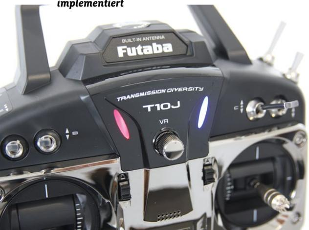
**Mit dem Menü Cntr Alm kann die Schwebegasknüppelposition mit einem Ton akustisch signalisiert werden**
