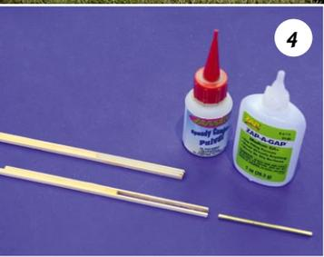
**Der Holm besteht aus zwei zusammengesetzten 3 x 3-Millimeter-Kiefernholzleisten. Dazwischen klebt man sorgfältig das 3er-Messing-Führungsrohr für den abgewinkelten 2er-Steckungsstahldraht**
