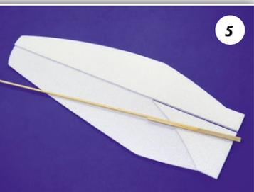
**Der vorbereitete Holm wird am Flügel eingesetzt, vorzugsweise mit wasserfestem Weißleim. Später erhält der Flügel noch einen einfachen, im Plan klar definierten Profilschliff**
