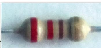
**Rot, Rot, Braun und Gold (der Ring für die Toleranz): die Farbmarkierung eines 220-Ohm-Kohleschicht-Widerstands**
