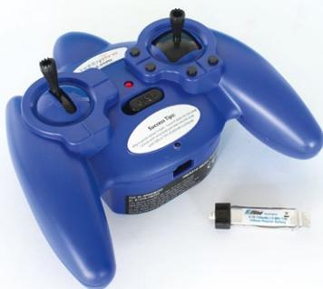
**Zum Set gehören ein 2,4-Gigahertz-Dreikanalsender sowie ein 1s-LiPo. Der Akku wird mittels der Fernsteuerung geladen**
