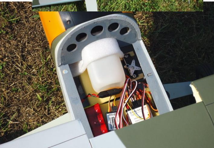
**Das Platzangebot lässt den Einbau eines Kraftstoffbehälters mit 160 Milliliter Fassungsvermögen zu. Das kleine Drosselservo sitzt direkt neben dem Tank**
