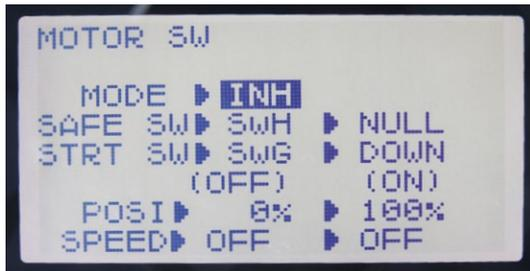
**Für Segler kann ein Schalter zur Motorsteuerung aktiviert werden – bei Butterfly ist das automatisch darauf eingeschränkt**
