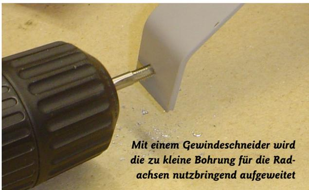
**Mit einem Gewindeschneider wird die zu kleine Bohrung für die Radachsen nutzbringend aufgeweitet**
