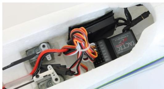
Bei dem Empfänger handelt es sich um einen Sechskanal-Receiver des Typs Tactic TR624
