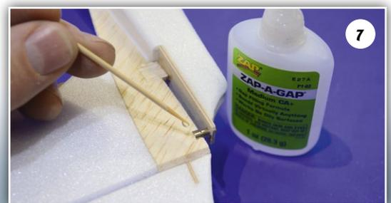
**Hinten fehlt noch das Leitwerk, das mit Hilfe von drei zylindrischen Magneten (Ø = 4 und Höhe = 3 Millimeter) zusammengehalten wird. Magneten klebt man mit dünnflüssigem Sekundenkleber fest**
