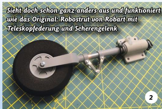
*Sieht doch schon ganz anders aus und funktioniert wie das Original: Robostrut von Robart mit Teleskopfederung und Scherengelenk*
