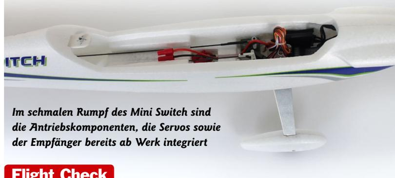
Im schmalen Rumpf des Mini Switch sind die Antriebskomponenten, die Servos sowie der Empfänger bereits ab Werk integriert
