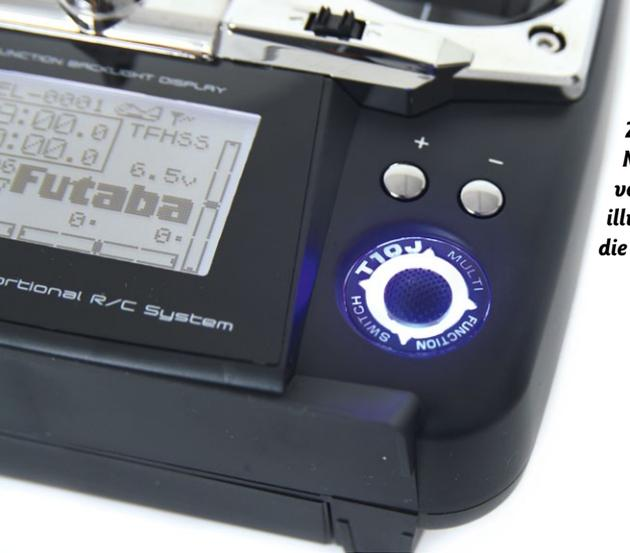
Zum Navigieren durch die Menüs und der Eingabe von Werten dienen der illuminierte 3D-Hotkey und die beiden Drucktaster
