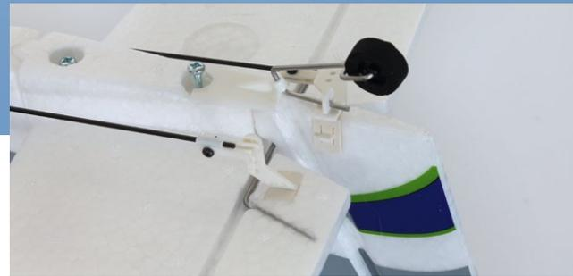
**Das Leitwerk des Mini Switch wird verschraubt. Da kein Kleber zum Einsatz kommt, kann das Bauteil zum Transport schnell und einfach demontiert werden**
