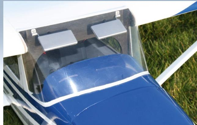
**Die Sonnenblenden entstanden in Eigenregie. Sie sollen optisch von dem massiven Spant im Cockpit ablenken**
