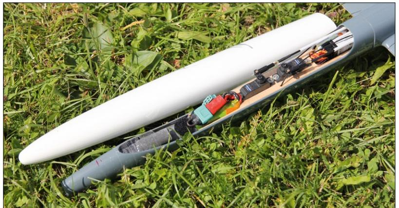
Nimmt man die Abziehschnauze ab, hat man vollen Zugriff zur RC-Anlage. Die beiden V-Leitwerksservos werden aus Platzgründen hintereinander montiert
