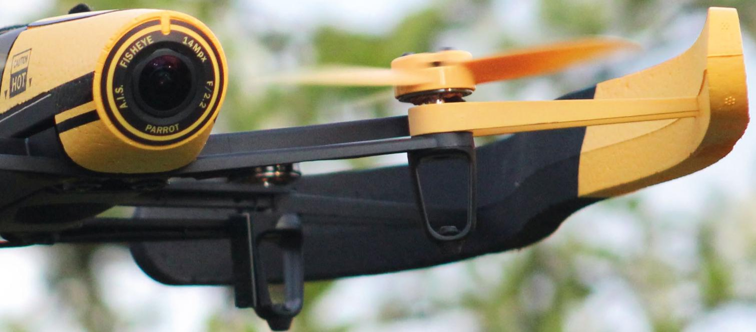
widerstandsfähigen Rahmen aus glasfaserverstärktem ABS, der mit einer strapazierfähigen EPP-Hülle verkleidet ist. Auf dem Rahmen befindet sich das Herzstück des Kopters, das auf Dämpfergummis gelagerte Motherboard, das neben den Prozessoren auch den internen Flashspeicher beinhaltet. Auf der Unterseite sind die Antennen platziert. An den Auslegern befinden sich die Brushlessmotoren, die ab Werk bereits mit Dreiblattpropellern bestückt sind.
