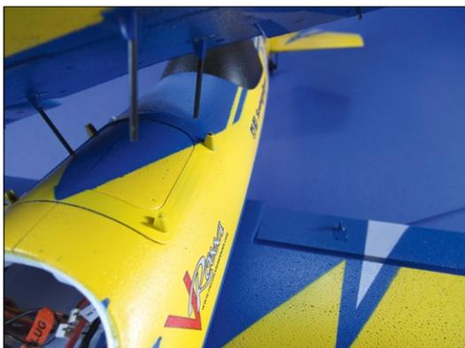
Der Oberflügel wird mit vier Kohlefaserstreben an den Rumpf geklebt
