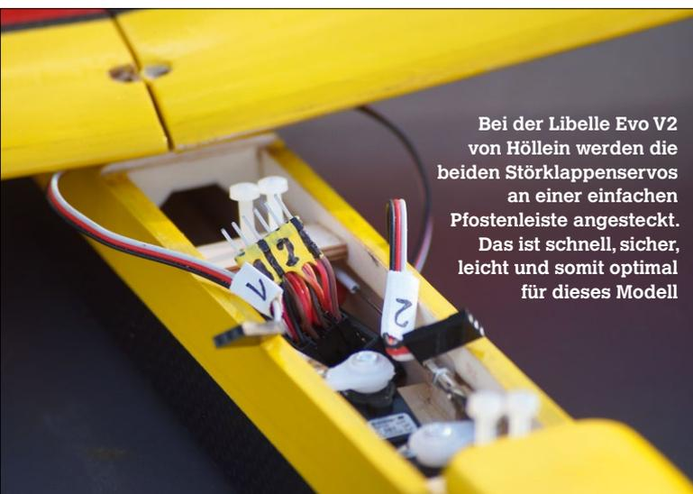
Bei der Libelle Evo V2 von Höllein werden die beiden Störklappenservos an einer einfachen Pfostenleiste angesteckt. Das ist schnell, sicher, leicht und somit optimal für dieses Modell
