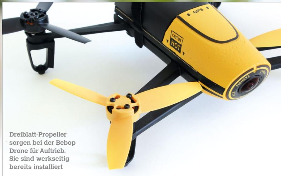
Dreiblatt-Propeller sorgen bei der Bebop Drone für Auftrieb. Sie sind werkseitig bereits installiert
