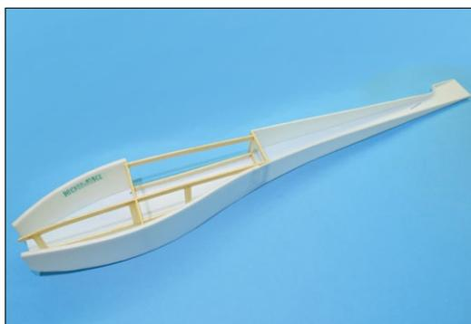
Gemeinsam mit dem Holz-Innengerüst werden die horizontalen Depronbauteile zwischen die Rumpfsseitenwände gesetzt. Man beachte: vorn robustes 6er- und hinten leichtes 3er-Material
