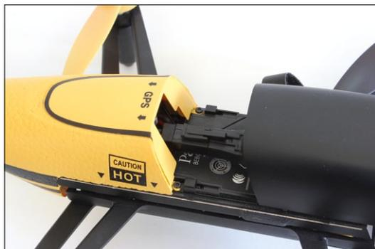
Der 3s-Flugakku wird mittels Mini-Tamiya-Stecksystem an der Bebop Drone angeschlossen
