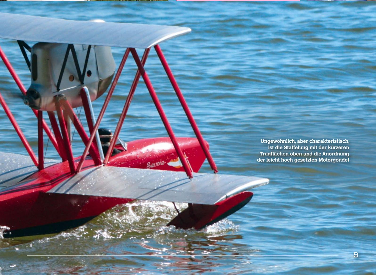
Ungewöhnlich, aber charakteristisch, ist die Staffelung mit der kürzeren Tragflächen oben und die Anordnung der leicht hoch gesetzten Motorgondel
