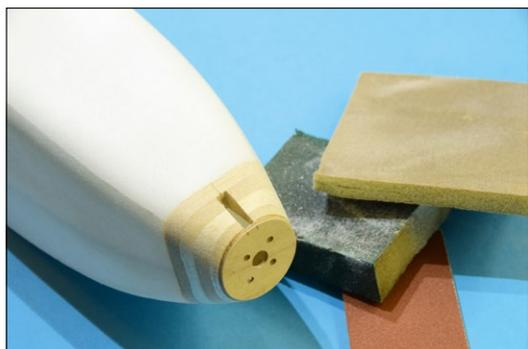
Die Rumpfschnauze besteht aus vier 6-Millimeter-Balsaspanten, vorn mit 1,5 Grad Seitenzug verschliffen. Davor leimen wir den Motorspant aus 1,5er-Sperrholz mit dem für den Motor passenden Bohrbild
