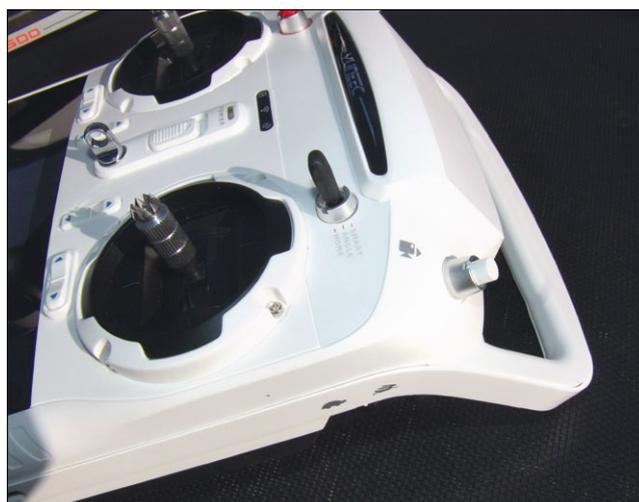
Der Dreistufenschalter für die Flugphasen. Mit dem Tastschalter auf der Stirnseite wird die Filmaufnahme gestartet und gestoppt
