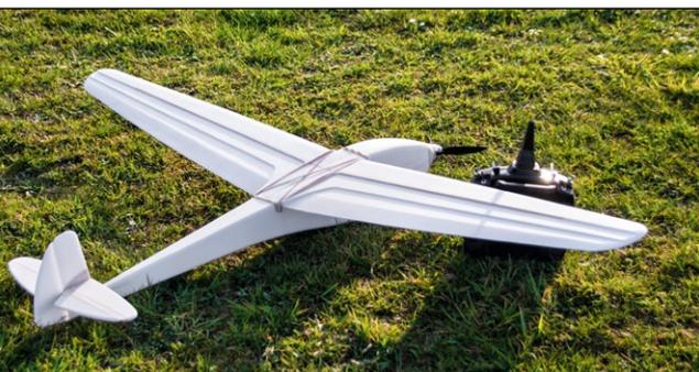
Fertig! So sieht Raus! vor dem Lackieren aus. Gut zu erkennen ist die zweifache KF-Stufe
