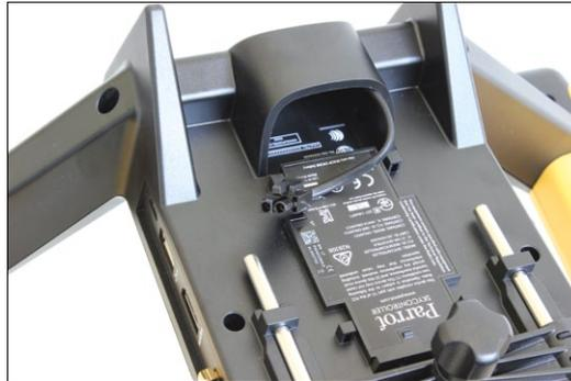
Die Stromversorgung des Skycontrollers erfolgt über dieselben 3s-LiPos, die auch in der Bebop Drone zum Einsatz kommen
