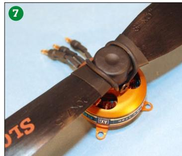
Dank „Entschärfung“ durch den Schrumpfschlauch wird der über die Kanten gezogene Gummi-O-Ring des Prop-Savers nicht mehr beschädigt und hat eine wesentlich höhere Lebensdauer **7**
