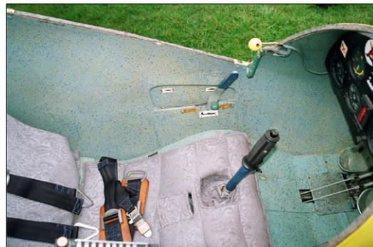
Führerraum der SP-1999, links der gelbe Ausklink-Knopf für die Schlepp-Kupplung, darunter der Bremsklappenhebel und die Höhenrudertrimmung. Vor dem Sitz der Knopf für die Seitenrudderpedal-Verstellung
