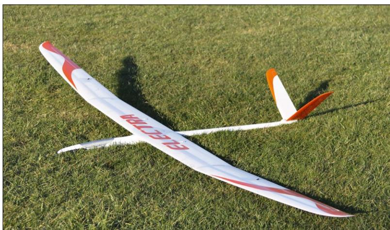
F5J-Modelle sind speziell für den Thermiksegelflug mit Unterstützung eines Elektromotors optimiert
