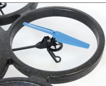
Bewährte Bürstenmotor-Getriebe-Technik plus Nylonpropeller in sechsfacher Ausführung sorgen für Schubkraft
