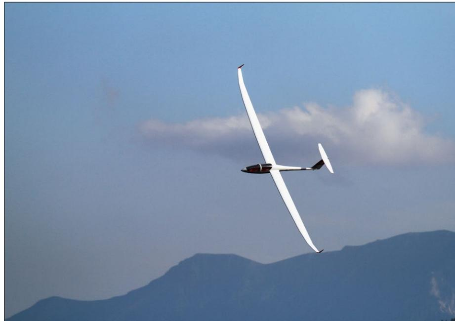
Reduziert man beim Zurückverlegen des Schwerpunkts gleichzeitig die Quer- und Höhenruderauslässe, so lässt sich feststellen, dass das Modell keineswegs kritischere Flugeigenschaften zeigt. Erstaunlich dabei: Trotz der kleineren Ausschläge wird der Segler bei niedrigeren Geschwindigkeiten wendiger sein. Hier hilft nur fliegen, fliegen und nochmals fliegen, um die Wirkung unterschiedlicher Schwerpunktlagen kennenzulernen.
