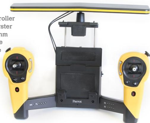
Die Tablet-Halterung des Skycontrollers nimmt Endgeräte mit einer Maximalgröße von 10,6 Zoll auf
