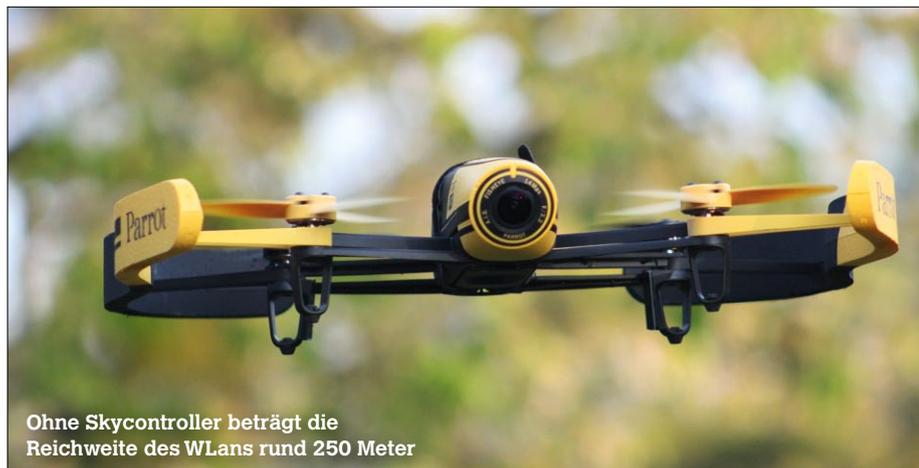
Ohne Skycontroller beträgt die Reichweite des WLans rund 250 Meter
