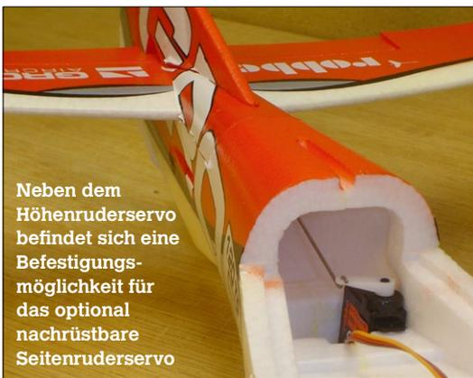
Neben dem Höhenruderservo befindet sich eine Befestigungsmöglichkeit für das optional nachrüstbare Seitenruderservo
