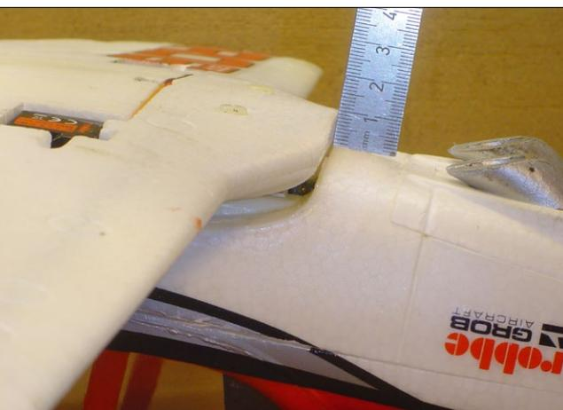
Ohne Korrektur am Höhenleitwerk ragt die Flügelvorderkante bei passender EWD stark aus der Rumpfkontur heraus
