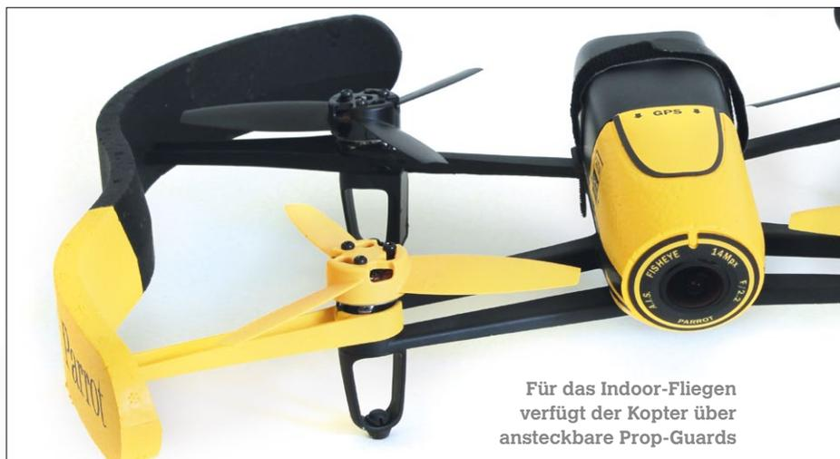
Für das Indoor-Fliegen verfügt der Kopter über ansteckbare Prop-Guards
