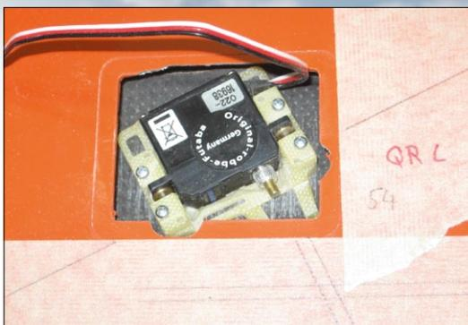
Bevor das RDS samt Servorahmen eingeklebt wird, sollte man sich die Lage der Tasche und der Stege im Flügel anzeichnen, um die optimale Position des Servos zu ermitteln
