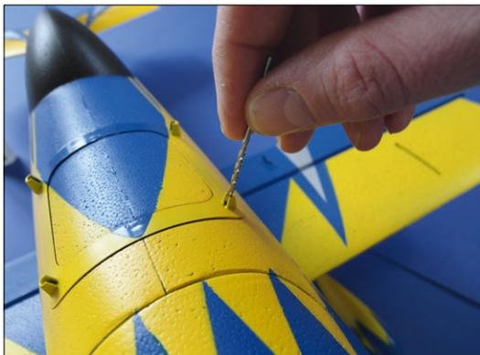
Lacknasen in der Strebenaufnahme lassen sich leicht mit einem passenden Bohrer entfernen
