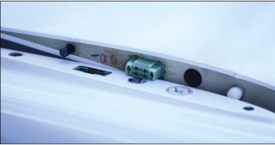
Bei diesem Segler, dem Vegas von Staufenbiel, sind die Multiplex-Steckverbinder für den Anschluss der Querruderservos bereits in die Fläche eingelassen
