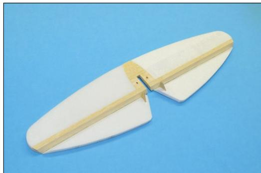
In den dreistöckigen 4 x 4-Millimeter-Kiefernholm fügt sich wunderbar ein 4-Millimeter-Messingrohr ein, das man mit Sekundenkleber und Füllpulver einkleben kann. Anschließend seitlich plan schleifen
