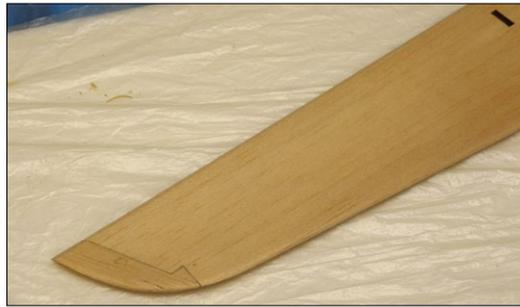
Die dünnen Leitwerke der Libelle aus 3-Millimeter-Balsa würden sich beim Bügeln verziehen. Daher sind die Enden mit quer gemaserten Teile abgesperrt
