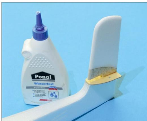
Den Heckabschluss bildet eine Auflage aus 1,5-Millimeter-Sperrholz sowie das Seitenleitwerk mit 6-Millimeter-Balsaverstärkungen. Weißbleim ist eine gute Klebstoffwahl für diese Baugruppe
