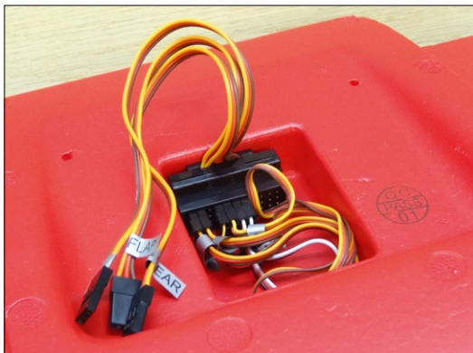
Ein spezieller Adapter sammelt die aus den Tragflächen austretenden Servokabel und reduziert den Kabelstrang auf drei Anschlüsse
