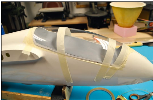
Die Kabinenhaube ist exakt einzupassen und mit dem Rahmen beziehungsweise Inlay zu verkleben
