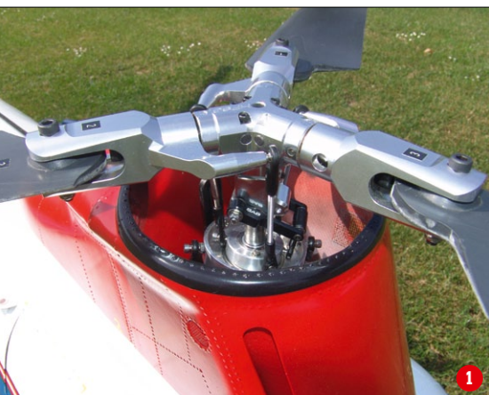
Der vordere, linksdrehende Dreiblatt-SAB-Rotor (1). Die hintere Mechanik mit ihren beiden Taumelscheiben-Servos. Der Rotorwellenantrieb erfolgt über ein stabiles Stahl-Kegelradgetriebe (2)
