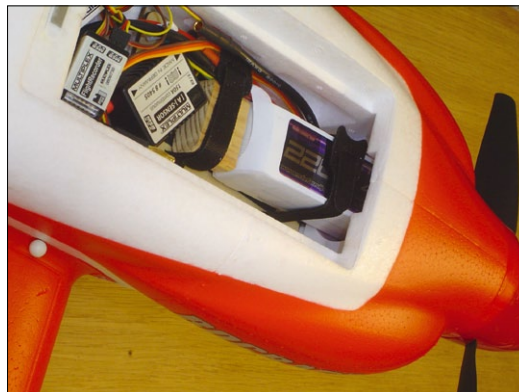
Mit Empfänger, Akku und einigen Telemetriesensoren ist der Platz unter der Zugangsklappe schnell aufgebracht
