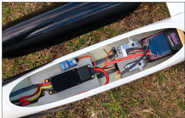
Einbauzustand: Über einen Schalter am Regler lässt sich das SBEC und somit die RC-Anlage ein- und ausschalten. Als Variometer kommt der GPS-Logger2 mit TEK-Düse zum Einsatz
