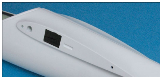
Der Flügelanschluss ist für die Aufnahme des Vierkantverbinders im Rumpf
