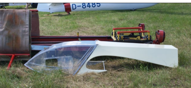
Abgenommene Haube mit Abdeckung des Rumpfmittelteils
