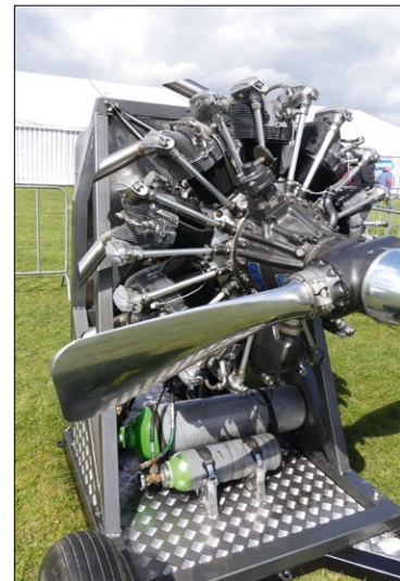
Auf der Aktionsfläche im Außenbereich stellte Franz Schabberger aus St. Pölten, Österreich seinen Eigenbau-Verstell-Propellerantrieb (+18 bis -5 Zoll) vor, der über eine Hohlwelle mit verschiebbarer Innenwelle verwirklicht wurde. 1:1,45-Untersetzunggetriebe, 26-Zoll-Propeller von Solo-Propellers, Langratec-Motor BLM8074-8T an 12s-LiPos 10 Ah, Gewicht mit Prop zirka 3.000 g
