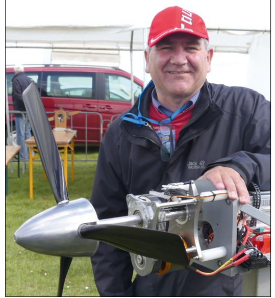
Auf der Aktionsfläche im Außenbereich stellte Franz Schabberger aus St. Pölten, Österreich seinen Eigenbau-Verstell-Propellerantrieb (+18 bis -5 Zoll) vor, der über eine Hohlwelle mit verschiebbarer Innenwelle verwirklicht wurde. 1:1,45-Untersetzunggetriebe, 26-Zoll-Propeller von Solo-Propellers, Langratec-Motor BLM8074-8T an 12s-LiPos 10 Ah, Gewicht mit Prop zirka 3.000 g
