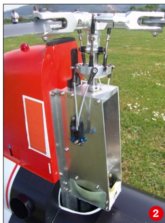
Der vordere, linksdrehende Dreiblatt-SAB-Rotor (1). Die hintere Mechanik mit ihren beiden Taumelscheiben-Servos. Der Rotorwellenantrieb erfolgt über ein stabiles Stahl-Kegelradgetriebe (2)
