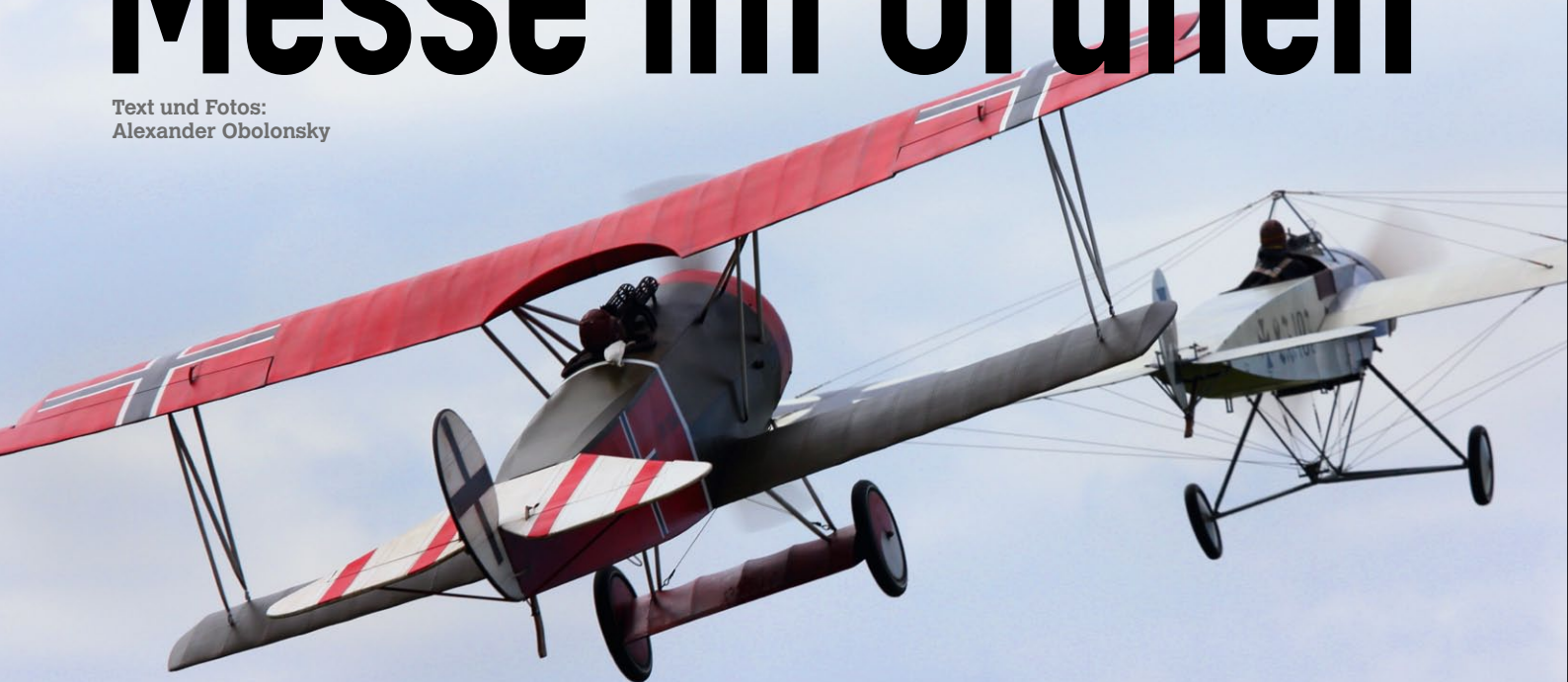
Doppeldecker Fokker D.VI von Gregor Treml und Horst Keul im Team der Firma Toni Clark mit Motor Valach VM-170B2-VT Viertakt-Boxer. Vorne eine 4.400 mm spannende und von einem Valach VM-120B2-VT angetriebene Fokker E.I Eindecker von Gerhard Reinsch – beide Modelle im Maßstab 1:2,5
