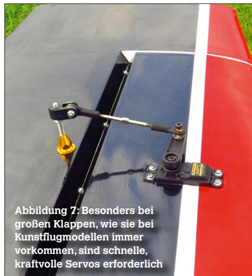
Abbildung 8: Landeklappenservos sollten viel Stellmoment mitbringen
