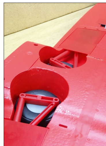
Bei eingezogenem Fahrwerk liegen die Schachtabdeckungen sauber an der Profilunterseite an
