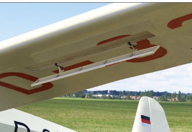
Ausgefahrene Drehbremsklappe beim D-3214
