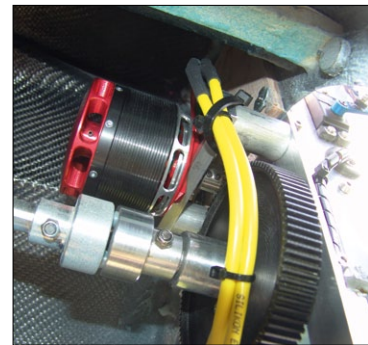
Blick von unten auf das Kunststoff-Zahnrad sowie die zum hinteren Pyro führende Edelstahlwelle mit Anschlusskupplung. Das auf dem Pyro montierte Ritzel ist vorne zusätzlich gelagert
