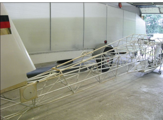
Stahlrohr-Rumpf bei der Restaurierung
