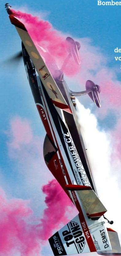
Gernot Bruckmann mit der Yak-55 von Modellbau Bruckmann. In dem 18,5 kg schweren Modell ist ein Valach-Viertaktmotor VM 210B2-4T mit 210 cm<sup>3</sup> Hubraum eingebaut, der sichtlich keine Schwierigkeiten mit der Kunstflugmaschine hat
