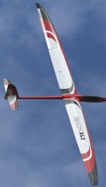
Das Kreisflugverhalten geht in Ordnung. Wegen der geringen V-Form muss aber kontrolliert mit dem Seitenruder zugearbeitet werden
