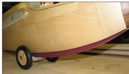
Das Fahrwerk zum Starten ist gesteckt und kann ferngesteuert abgeworfen werden
