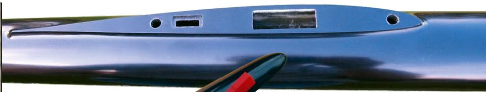
Spielfreie Passungen für den Flächenverbinder und die Torsionsstifte gewährleisten den festen Sitz der Tragflächen. Für elektrischen Anschluss sorgen die Multiplex-Verbindungsstecker
