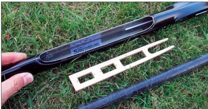
Dem Modell liegen ein Servobrett und das Ballastrohr bei
