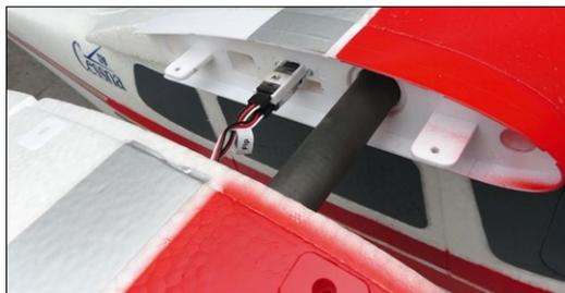
Die rumpfseitigen Stecker an den markierten Kabeln für Querruder und Landeklappen sind etwas wackelig in der Halterung fixiert. Abhilfe schafft Doppel-Klebeband. Zwei Schrauben sichern die Fläche am Rumpf
