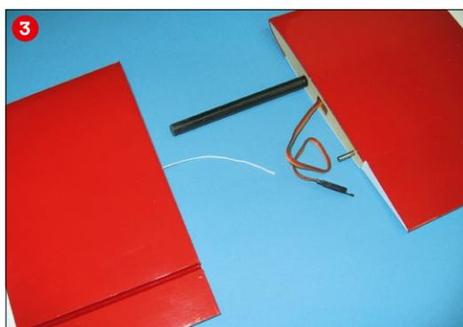
Der 4s-LiPo sitzt gut erreichbar direkt unter der Kabinenhaube. Dadurch lässt er sich rasch wechseln (1). Robustheit-erhöhende Maßnahme: Die beiden Winglets wurden nicht nur stumpf angeklebt, sondern durch einen Buchenrunddübel formschlüssig mit der Tragfläche verbunden (2). Auch die Flächensteckung vom inneren Flügel zum Außenohr ist perfekt vorbereitet – sogar eine Schnur zum Einziehen der Kabel ist vorhanden (3)
