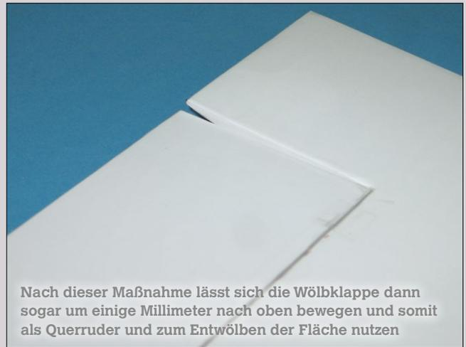
Nach dieser Maßnahme lässt sich die Wölbklappe dann sogar um einige Millimeter nach oben bewegen und somit als Querruder und zum Entwölben der Fläche nutzen
