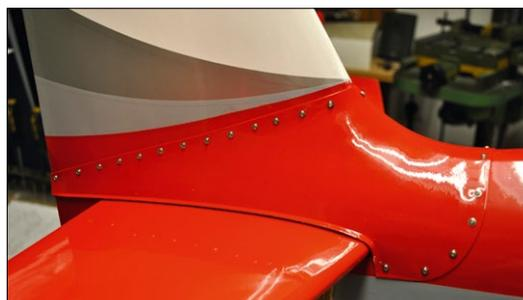
Die fertig lackierte GFK-Verkleidung wird mit kleinen Schraubchen am Rumpf fixiert
