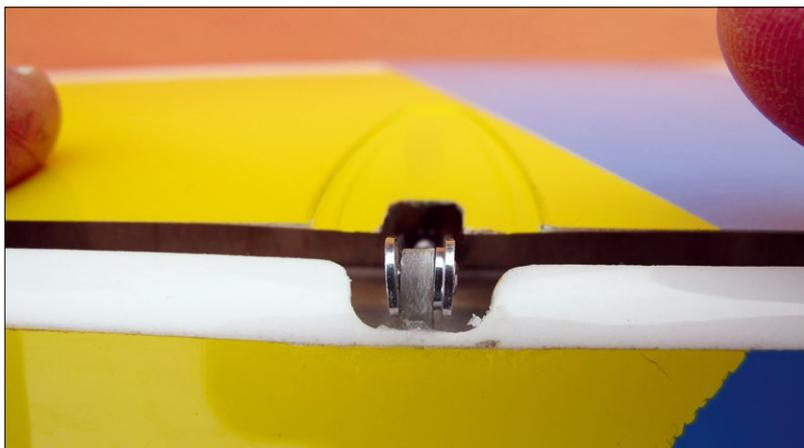
Bereits mit den beiliegenden Metallgabelköpfen kann eine aerodynamisch günstige Anlenkung erreicht werden
