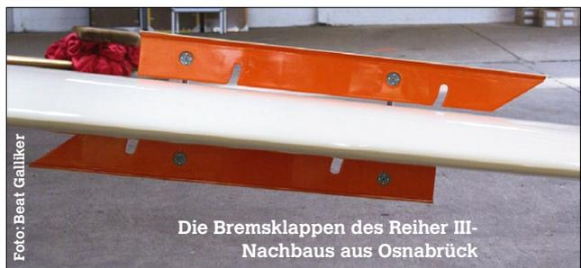
Die Bremsklappen des Reiher III-Nachbaus aus Osnabrück
