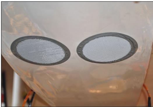
Die beiden schon eingebauten Auspufftunnel dienen uns als Kühlluftschächte und werden für eine schönere Optik am Rumpfboden mit weiß lackierten Gittern verkleidet
