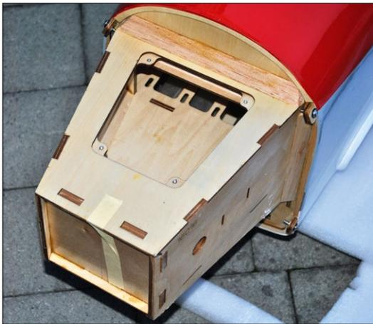
Am Motordom lässt sich ein Zweizylinder-Boxermotor mit 100 Kubik oder aber Elektroantrieb anbringen
