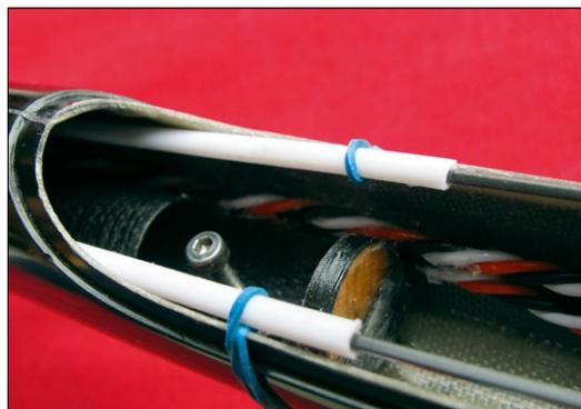
Das Ballastrohr bietet die Möglichkeit, Einzelgewichte im Schwerpunktbereich zu platzieren
