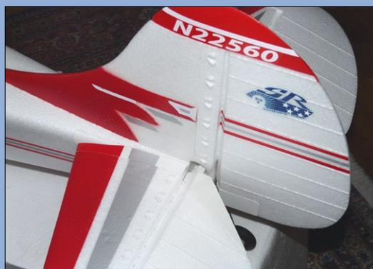
Das abnehmbare, mittels Kohlefaserrohr gelagerte Höhenleitwerk wird bei der Montage in rumpfseitige Kunststoff-Taschen eingeschoben und rechts und links durch je einen Klarsicht-Klebestreifen gesichert
