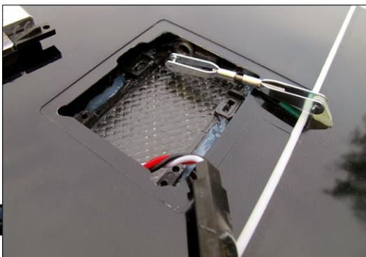
Für die Zugänglichkeit der Befestigungsschrauben im Servorahmen muss der Tragflügelausschnitt leicht nachgearbeitet werden
