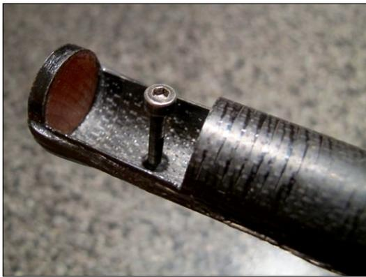
Im Testmodell wird das letzte Gewicht über eine Schraube gesichert
