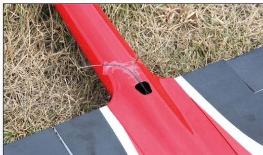
Da der Rumpf überall mit CFK verstärkt wurde, müssen die 2,4-Gigahertz-Antennen nach draußen geführt werden
