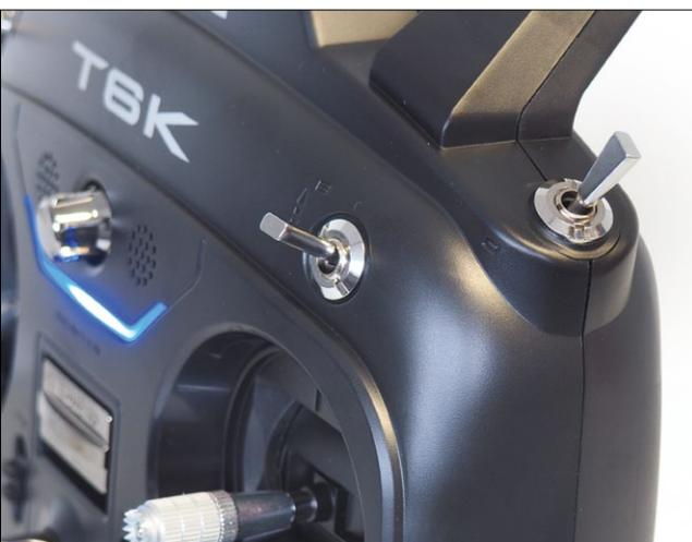
Vier frei belegbare Schalter und ein Drehgeber sind im matt schimmerndem Gehäuse integriert
