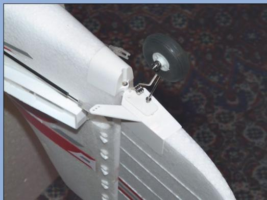
Das Spornfahrwerk ist ebenfalls Ruck-Zuck montiert. Die untere Schraube dient zugleich als Drehlager für das Seitenruder
