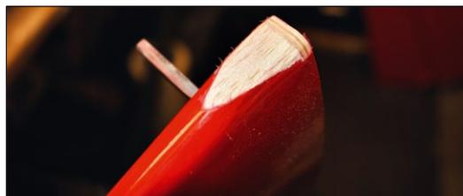
Bei beiden Höhenrudern muss an der Nasenleiste am Rumpfübergang ein wenig abgeschliffen werden
