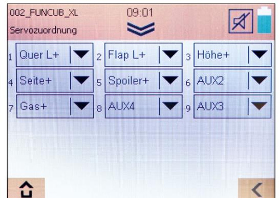
So sieht die Servoanordnung der FunCub XL bei der Nutzung des Wingstabi aus. Pro Geber wird nur ein Signal ausgegeben, also 1 x Quer, anstatt Quer 1 und Quer2
