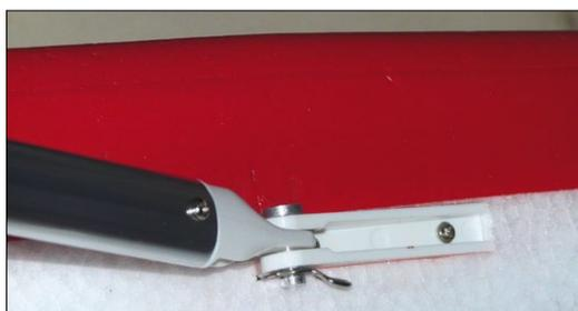
Die Alu-Streben sind an Flügel und Rumpf nur mit je einem Bolzen befestigt. Der jeweilige Bolzen für die Aufnahme am Flügel ist am Kragen abgeflacht. Er wird auch nur einmal montiert und verbleibt dann mit der Strebe an der Fläche
