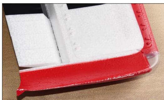
Beim Transport knicken die dünnen Ausfallenden der runtergezogenen Randbögen an den Tragflächen leider leicht ab. Vortexgeneratoren sind auch auf der Flügelunterseite platziert
