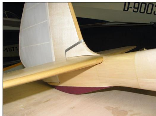
Mit Entfernen des Keils ist das Höhenleitwerk für den Transport demontierbar
