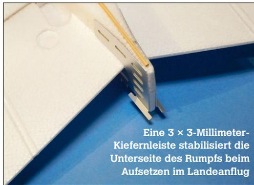
Eine 3 × 3-Millimeter-Kiefernleiste stabilisiert die Unterseite des Rumpfs beim Aufsetzen im Landeanflug
