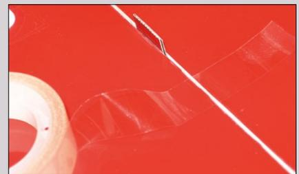
Mittels Abstandsstreifen werden die Ruder wieder neu angeschlagen, zuerst mit kleinen Streifen quer zur Scharnierlinie
