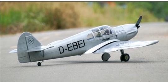
Pichler Modellbau stellt mit der neuen Messerschmitt BF-108 Taifun ein Elektromodell in ARF-Holzbauweise vor, das fertig bespannt für 249,- Euro angeboten wird. Serienmäßig kommt es mit einem starren Fahrwerk, kann jedoch auch mit einem optionalen Einziehfahrwerk ausgerüstet werden. Die Spannweite beträgt 1.625, die Länge 1.300 Millimeter und das Abfluggewicht 2.900 Gramm. [www.shop.pichler.de](http://www.shop.pichler.de)
