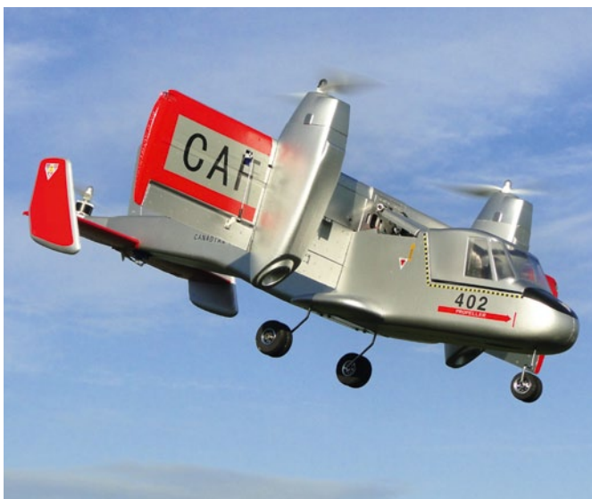
Abbildung 7: Bei der CL-84 Dynavert wird die Fläche mit daran befindlichen Motorgondeln verschwenkt
