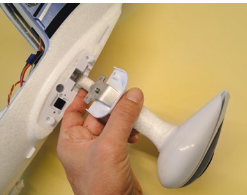
Das robuste Fahrwerk wird seitlich in den Rumpf eingeschoben und dann sicher fixiert
