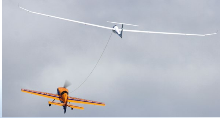
Wirklich beeindruckend konnte der Sound und die Leistung des Vierzylinder-Boxers RM 170 FS von Roto, der im Vertrieb von Engel-MT ist. Der Viertakter ist so leise, dass man glaubt, einen E-Antrieb zu hören. Eingebaut in eine Extra 330SC mit 3.100 mm Spannweite, schleppte das Kraftpaket auch noch einen Segler mit gut 7 m Flügelspanne locker auf Höhe
