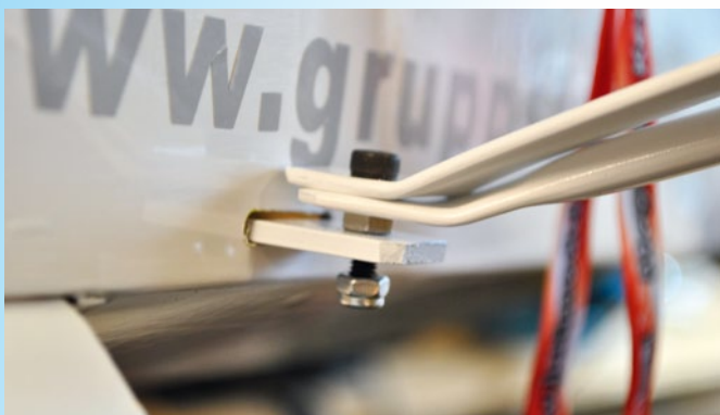
Die Flächenstreben sind so fixiert, dass sie sich leicht von der Befestigung am Rumpf lösen lassen und für den Transport an den Flügeln verbleiben können
