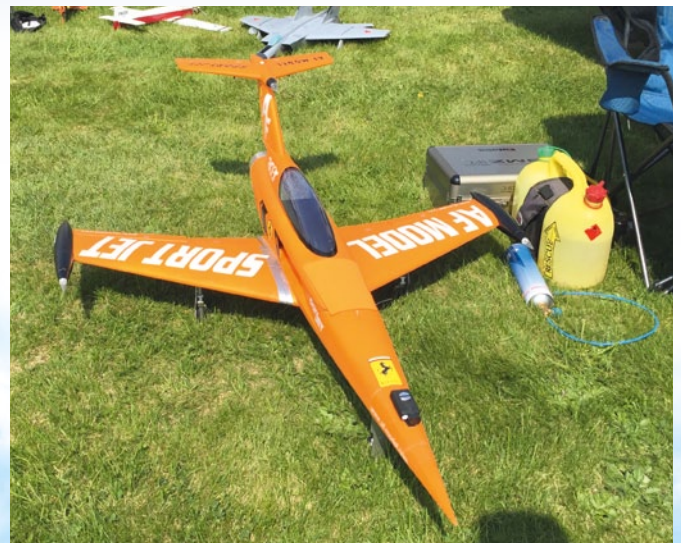
Der Sport Jet von AF Model, erhältlich über hebu-shop.ch, ist eigentlich für 90er-Impeller vorbereitet
