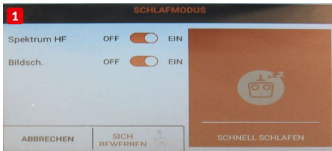
Der Sleep Mode versetzt den Sender in Standby ohne HF-Abstrahlung und Displayanzeige – das spart Strom. Nach Drücken des Ein-Aus-Tasters ist er sofort betriebsbereit (1). Alle Geber, beispielsweise der Autorotations- oder Flugphasenschalter, können völlig frei zugeordnet werden (2)
