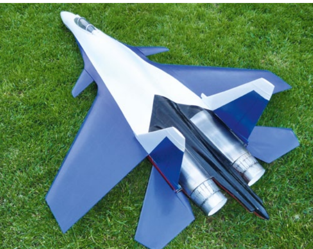
Noch in Arbeit sind das Farbschema und die Detaillierung dieser Su-35. Die Steuerung des Modells erfolgt nur über die Tailerons
