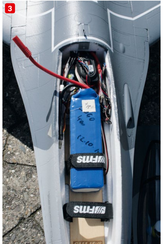
Dank weniger Schraubverbindungen ist die F-16 schnell zusammengebaut (1). Vier verschiedene Decal-Varianten liegen dem Kit zur Auswahl bei (2). Wegen des Schwerpunkts muss der LiPo ganz hinten auf der Akkuauflage befestigt werden, dadurch wird die vordere Schlaufe nutzlos (3)
