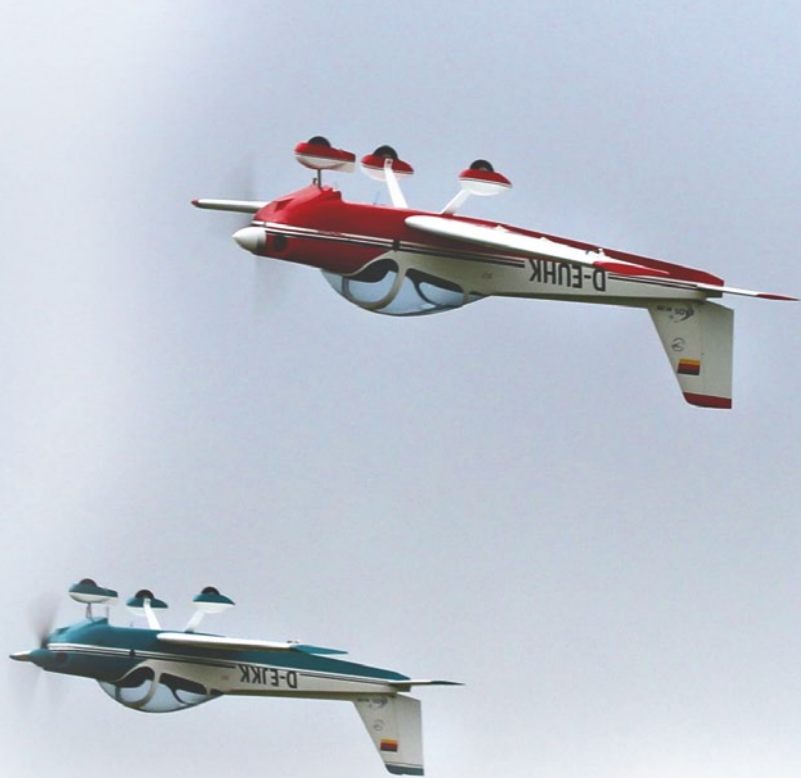
Die Bolkow Bo 209 Monsoon hatte Kempf-Modellbau in 2015 vom „Wilga-Spezialisten“ Alexander Frisch in den Vertrieb übernommen. Der Bausatz wird in Gemischtbauweise (GFK/Styro/Abachi) nebst reichlich Zubehör geliefert. Dass das Modell nicht nur bestens für den Seglerschlepp geeignet ist, zeigten die Piloten im Synchronflug. Loopings, Rollen und weitere Akrobatik sind kein Problem. Die Spannweite beträgt 3.230 mm und das Gewicht ab 17 kg
