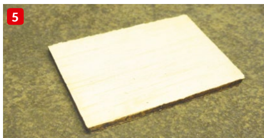
Ein sehr kleiner 1-Millimeter-Fräser ist noch immer recht groß und somit nicht für feinste Strukturen verwendbar (4). Ein Balsabrettchen lässt sich mit einem Laser leicht zerschneiden – und das völlig kräftefrei (5). Aufbau eines klassischen Festkörper-Lasers nach Theodor Maymann (6)
