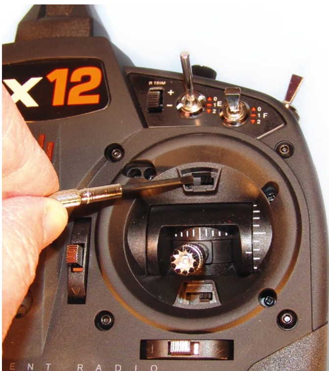
Die Knüppelaggregate der iX12 lassen sich vollständig von vorne einstellen, inklusive mechanischer Wegverkürzung auf der Pitchfunktion
