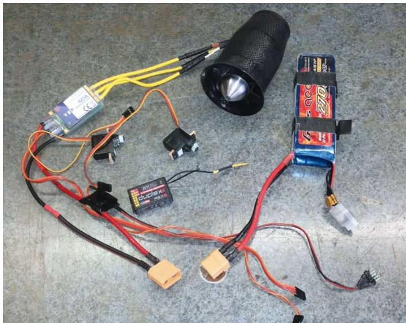
Das komplette technische Setup bestehend aus speziell angepasstem Impellerantrieb, Akku, Regler, Empfänger, Sensor und Servos
