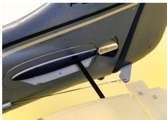
Die beiden Höhenleitwerkshälften und -ruder werden über eine Kunststoffbrücke beziehungsweise Plastikmitnehmer gekoppelt
