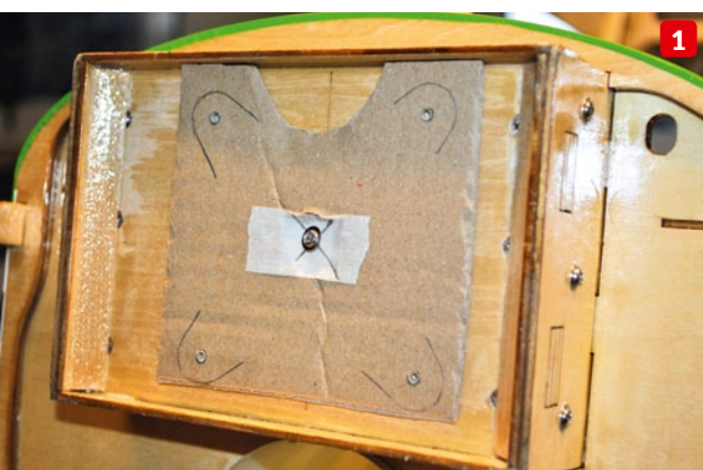
Ob man sich für einen Verbrenner oder E-Antrieb entscheidet, bleibt jedem freigestellt. Mit Hilfe einer Schablone erfolgt die exakte Positionierung der Motorträger für den Brushless-Motor von Hacker (1). Schon lange und immer wieder bewährt hat sich dieser Hacker-Motor aus der Q80-Serie. Unter den Trägern befestigt ist der 200-Ampere-Regler, ebenfalls aus dem Hause Hacker (2)
