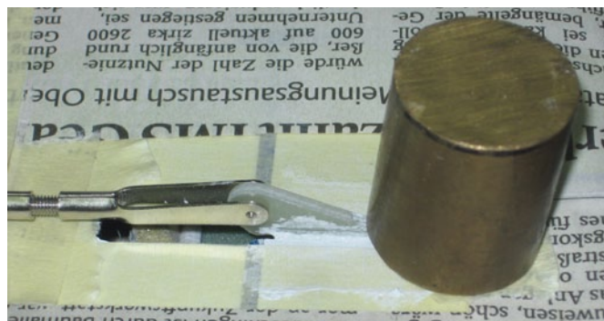
Färbt man das Harz zum Einkleben der Ruderhörner gleich passend ein, ergibt sich später eine perfekte Optik
