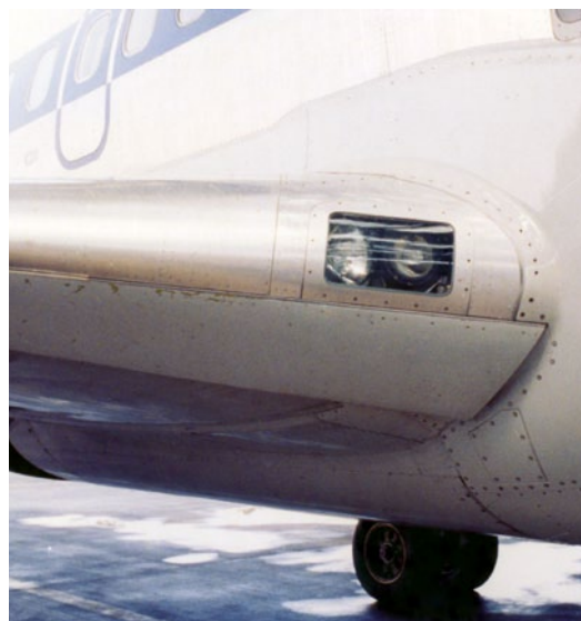
Unter den Landescheinwerfern die geschlossene Krügerklappe (Foto: Gary Gray)
