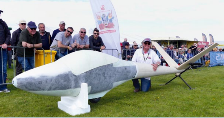
Marc Hauss aus Frankreich gehört ebenfalls zu den Piloten der ersten Stunde auf der ProWing. Neben seinen Flugaktivitäten stellte er noch sein neuestes Projekt im Rohbau vor: Kunstflugsegler Glasflügel H-101 Salto von 1970. Bei einem Nachbaumaßstab von 1:1,33 ergibt das eine stolze Spannweite von 10.200 mm und eine Rumpflänge von 4.420 mm. Das Gewicht wird etwa bei 65 kg liegen. Da wird der Kreis der möglichen Schleppflugzeuge schon sehr klein
