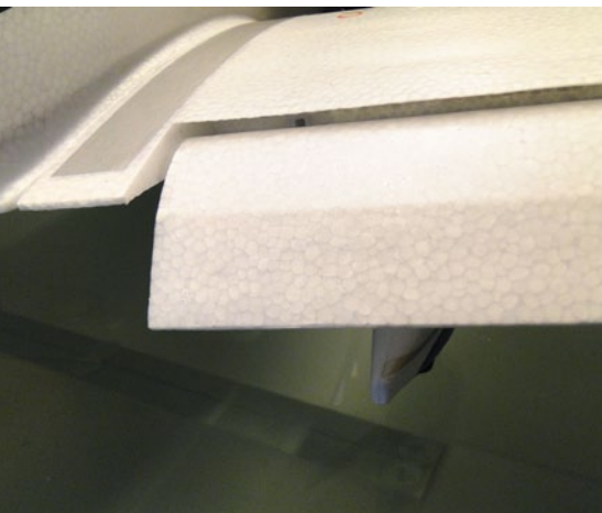
Bei ausgefahrenen Klappen entsteht ein Luftspalt, der gute Langsamflugeigenschaften fördert
