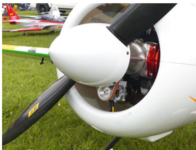
Entgegen aller Insolvenz-Gerüchte um den Motorenhersteller 3W, zeigte dieser in Bad Sassendorf mit einem starken Auftritt Flagge. Werkspilot Thomas Friedrich hatte in der Su-29 von Krill einen 3W-110iB2R (mit Heckvergaser) eingebaut. Besonderheit des Motors: er war mit einem Generator ausgerüstet, der sowohl als Starter als auch als Lichtmaschine fungiert. Bei laufendem Motor wird der Starterakku (3S-Lipo 2.200mA) schonend bis zu 80 Prozent aufgeladen. Das Zusatzgewicht beträgt ca. 600 g. Der Generator lässt sich auch an bestehende 3W-Motoren bis 170 cm 3 nachrüsten
