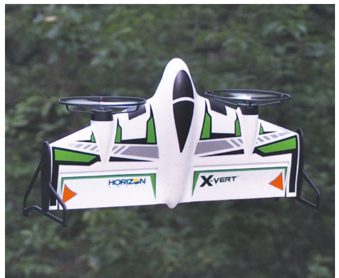
Abbildung 8: Zu den Transition-Modellen zählt auch das X-Vert von Horizon Hobby, bei dem eine Lageregel-Elektronik zwei verschiedene Flugmodi zulässt
