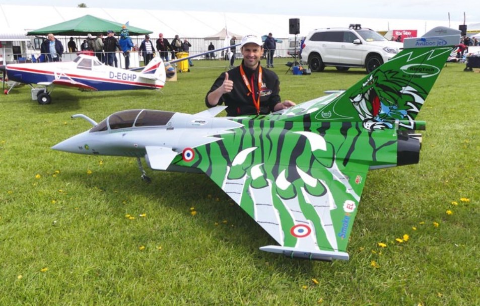
Im Slot der Luxemburger Firma JMB-Jets/KingTech-Turbinen konnte Jonathan Bossion mit der 1:5-Rafale begeistern. Der Jet ist mit einer Schubvektorsteuerung ausgerüstet, die eine atemberaubende Bodenakrobatik erlaubt. Die Spannweite beträgt 2.100 mm und die Länge 2.900 mm. Verwendet wird eine Turbine KingTech 310G
