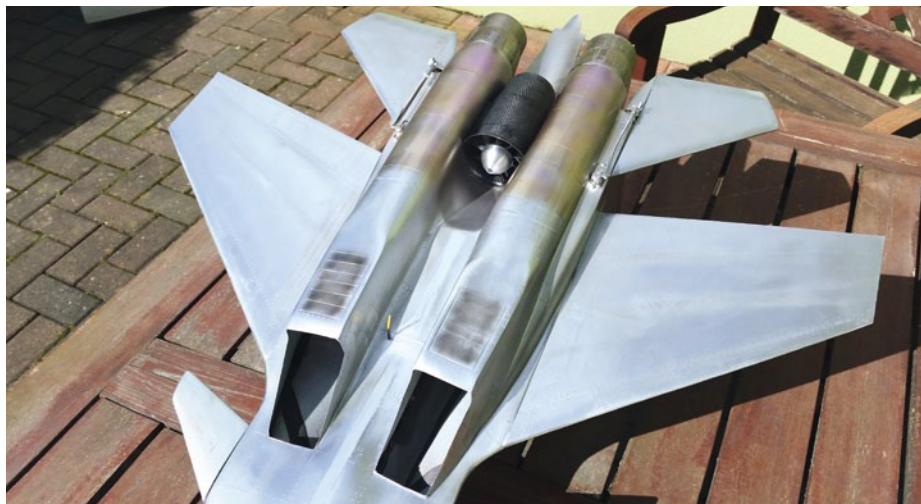
Die großen Lufteinläufe erlauben auch die Umsetzung eines zweistrahligen Antriebs, statt des zentralen, wie hier
