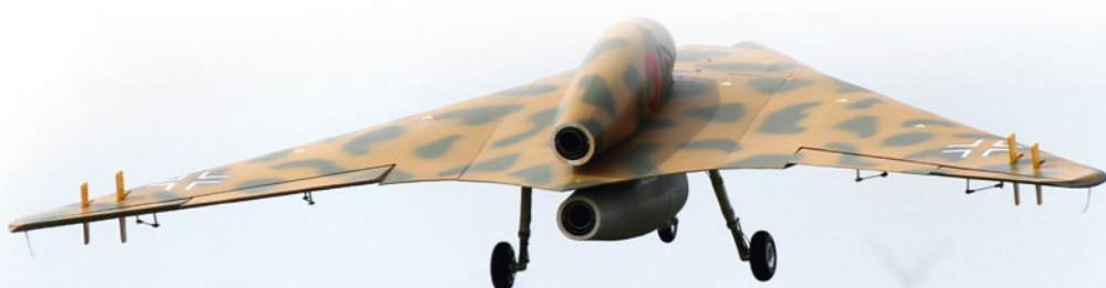
Der Holländer Erik van den Hoogen, Holzwurm und Pilot (wie er sich selbst bezeichnet), gehört mit seinen diversen Nurflügel-Konstruktionen seit Jahren zum Stamm der ProWing-Showpiloten. Das Original dieser Gotha P60A von 1944/45 hat es allerdings nie über das Zeichenbrett hinausgeschafft. Im Maßstab 1:4 gehalten ergibt sich eine Spannweite von 3.300 mm, eine Länge von 2.550 mm und ein Fluggewicht von 35 kg mit 2 x AMT Mercury HP-Turbinen
