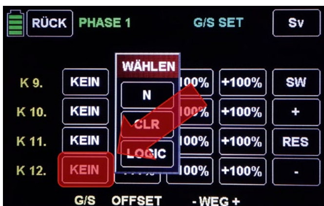
Sobald neben „K 12.“ auf die Schaltfläche „Kein“ getippt wird, erscheint das Fenster „Wählen“. Jetzt das gewünschte Bedienelement betätigen, um es einzulernen
