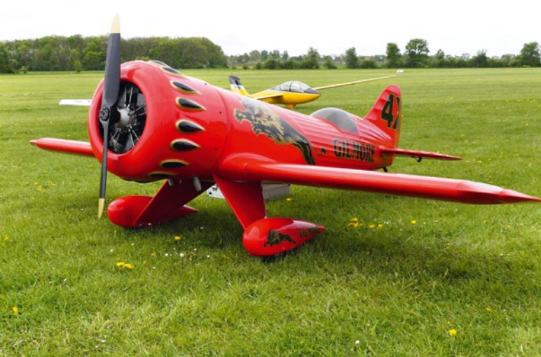
Ein bildschönes Modell: Die Turner, ein Rennflugzeug der 1930er-Jahre, das bei Delro erhältlich ist. Die großzügigen Platzverhältnisse unter der Motorhaube sind geradezu ideal für den Einbau eines Fünfzylinder-Sternmotors beispielsweise von Moki. Die Spannweite liegt bei 2.800 mm, die Gesamtlänge bei 2.700 mm und das Gewicht bei etwa 23 kg
