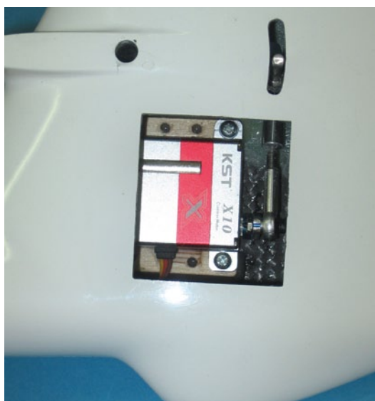
Das Höhenruderservo sitzt an Ort und Stelle und steuert das Ruder auf direktem Wege an
