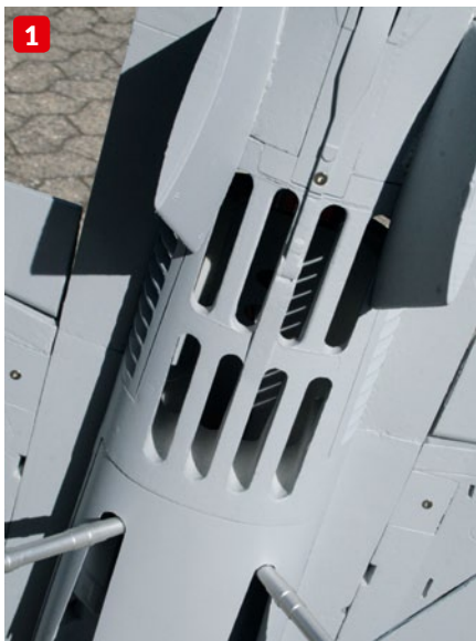
Über zusätzliche Lufteinlässe – den Cheater Holes – bezieht der Impeller seine Atemluft (1). Im Gegensatz zur echten F-16 hat das Modell keine Tailerons, dafür aber Querruder (2). Beim Landen kann mit hohem Anstellwinkel angefliegen werden, trotzdem neigt die F-16 gelegentlich dazu, auf der Fläche zum Stehen zu kommen (3)
