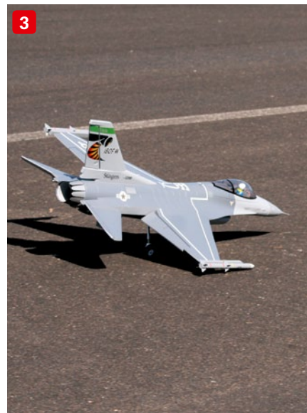
Über zusätzliche Lufteinlässe – den Cheater Holes – bezieht der Impeller seine Atemluft (1). Im Gegensatz zur echten F-16 hat das Modell keine Tailerons, dafür aber Querruder (2). Beim Landen kann mit hohem Anstellwinkel angefliegen werden, trotzdem neigt die F-16 gelegentlich dazu, auf der Fläche zum Stehen zu kommen (3)
