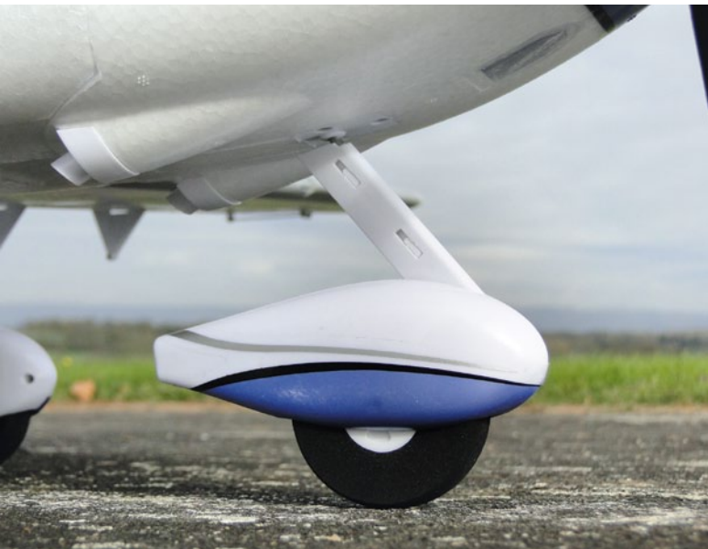
Die Radpuschen sind durchaus praxistauglich und das Bugrad steuert gut
