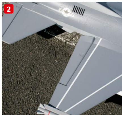
Über zusätzliche Lufteinlässe – den Cheater Holes – bezieht der Impeller seine Atemluft (1). Im Gegensatz zur echten F-16 hat das Modell keine Tailerons, dafür aber Querruder (2). Beim Landen kann mit hohem Anstellwinkel angefliegen werden, trotzdem neigt die F-16 gelegentlich dazu, auf der Fläche zum Stehen zu kommen (3)
