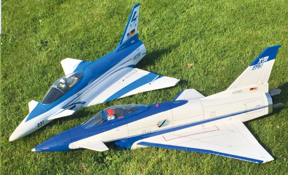
Zwei selbst gebaute MBB X-31 mit eingebauten T-30-Turbinen. Das Original diente damals zur Erprobung der Schubvektorsteuerung
