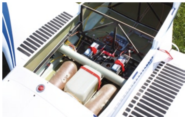
Die Einbauten sind hervorragend zugänglich. Das 40-Millimeter-Steckungsrohr fällt größer als die beiden LiPos aus
