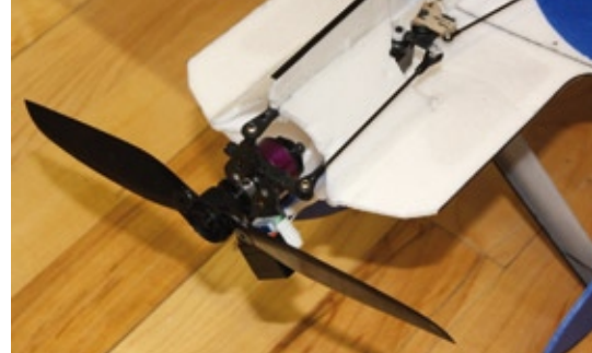
Front einer MX-2 von RJ Gritter und Devin McGrath (beide USA). Das Pitch-Servo unter dem Motor steuert den Verstellpropeller und das vordere Servo im Rumpf ist für die Vektorsteuerung des Antriebs zuständig
