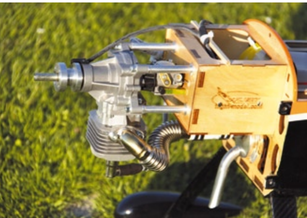
Die DLE-30-Motoreinheit von Staufenbiel wird komplett mit Schalldämpfer ausgeliefert
