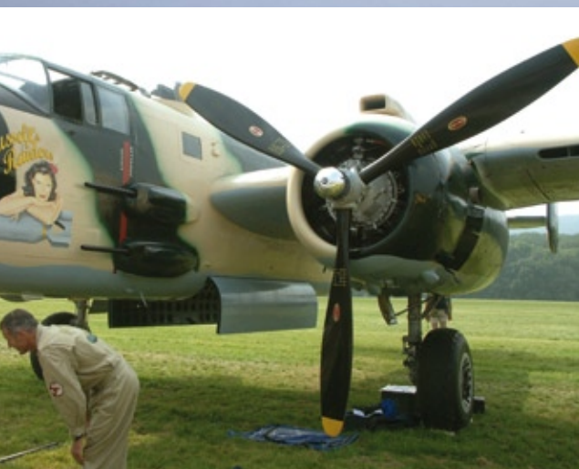
Blick auf den geöffneten Bombenschacht und die zusätzlich am Rumpf montierten Maschinengewehre der B-25J
