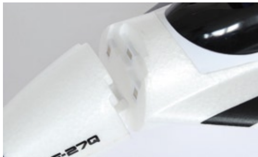
Vier kräftige Magnete halten die demontierbare Nase
