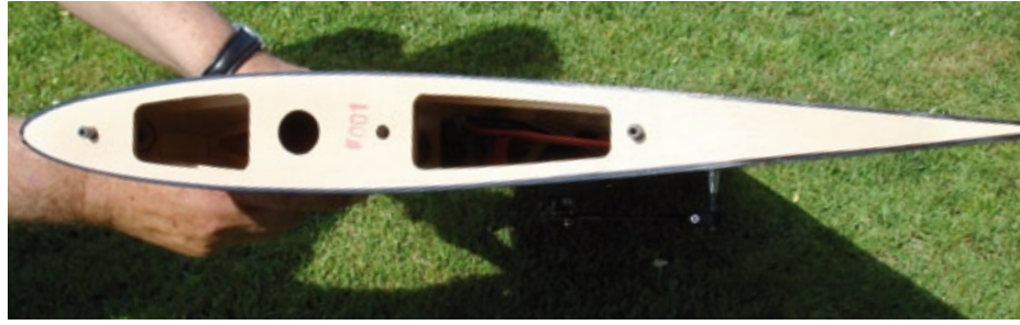
Die Zapfen, die den Flügel gegen Verdrehen sichern, sind aus CFK gefertigt
