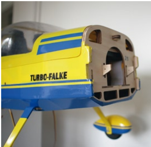
Die zu kurz geratene Motorhalterung reicht nicht aus, um den 550-Watt-Antrieb unterzubringen
