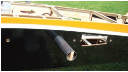
Eine stehend eingeklebte Hartholzleiste gibt dem nach Ansicht des Autors etwas schwach dimensionierten CFK-Steckungsrohr zusätzliche Festigkeit
