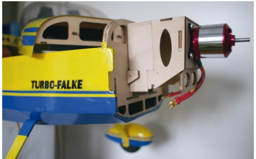
Eine kleine Sperrholzkonstruktion, die auf der Innenseite verstärkt wurde, verlängert die Motorhalterung
