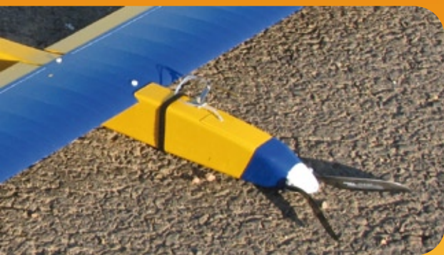
Abbildung 6: Staurohr an einem Elektrosegler. Der Winkel des Sensors entspricht dem Anstellwinkel des Modells
