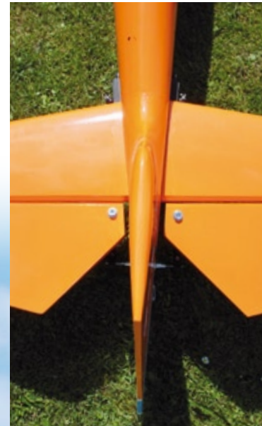
Die auf der gegenüberliegenden Seite des Ruderhebels aus dem Ruder stehenden Schraubenköpfe sehen aufgrund der aus Aluminium gefrästen Füße edel aus
