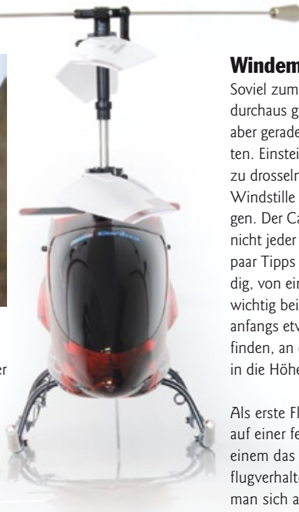
Die Rotorblätter schlugen mehrfach gegen Heckrohr und Höhenleitwerk und splitterten viel zu schnell
