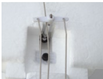
Im Bild zu sehen ist die Schraube, die das Höhenruder mit dem Seitenruder verbindet. Der Ruderarm des Seitenruders wird mit Stahldrähten angelenkt
