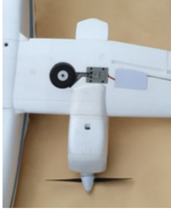
Die Motorgondel von unten betrachtet mit dem Einziehfahrwerk bei der Tragfläche und die bereits vom Hersteller montierte Abdeckung des Klappenservos
