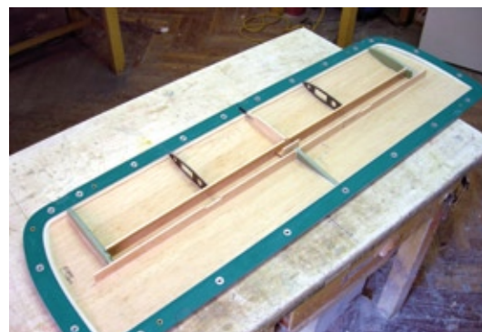
Das Höhenleitwerk ist zum Abformen vorbereitet
