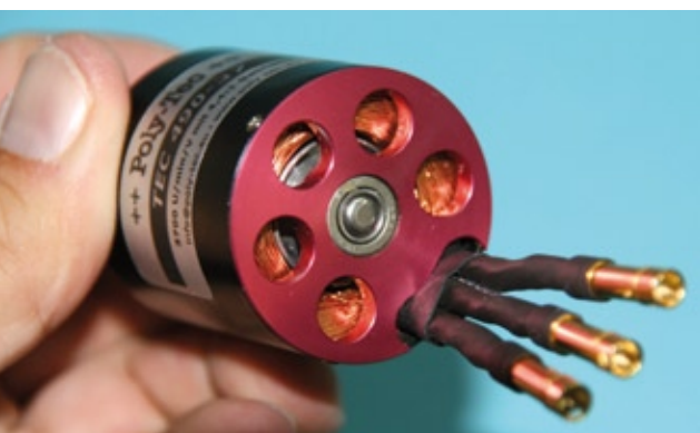
Der Motor besitzt Kühlöffnungen, um die Wärme abzuführen. Er ist sauber verarbeitet und kugelgelagert
