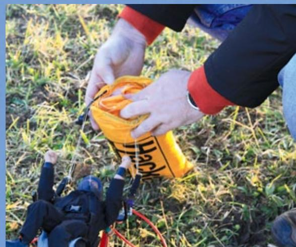
**Legt man den Pilot zum Packen direkt hinter den Schirm, so liegen alle Leinen im Segel und werden automatisch mit eingepackt. Zuerst werden die Enden eingeschlagen und dann nochmal in der Höhe gefaltet**
