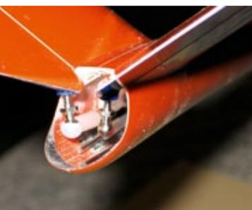
**Im Lieferzustand der ersten Serie waren die Bowdenzüge im Leitwerksbereich zu tief verlegt. Dieser Fehler ist mittlerweile behoben**
