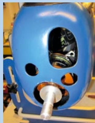
**Passend eingebaut kommt die Welle exakt aus der Haube**
