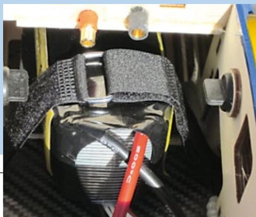
**Der 6s-LiPo wird von einem Klettgurt gesichert. Darüber sind die Stecker zu sehen, die zum Regler führen**
