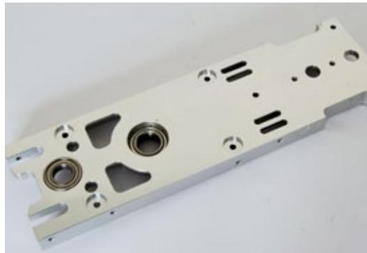
**Die Aluminium-Grundplatte bildet die Basis für das Getriebe, den Rotor und die Servos**
