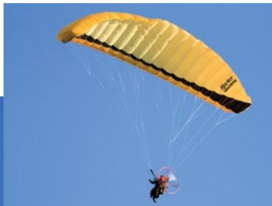
**Hier sieht man sehr schön, wie die linke Hinterkante des Schirms nach unten gezogen wird. Der Schirm wird links abgebremst und daher eine Linkskurve fliegen**
