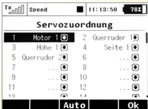
**Servo-Mapping:** Hier stellt man im Sender ein, an welchem Empfänger Ausgang welches Servo angeschlossen wird. Die Menüdarstellung der DC-16 ist übersichtlich und selbsterklärend
