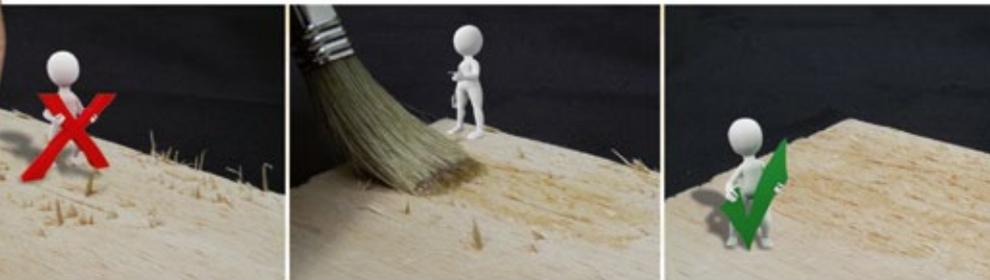
Dieser speziell für Holzbauweise entwickelte Kleber bewirkt eine Verklebung der Holzoberfläche und verhindert dadurch das Ablösen der Folie durch Faserriss. Auch schlechtere Holzqualitäten werden so optimal verarbeitbar.
