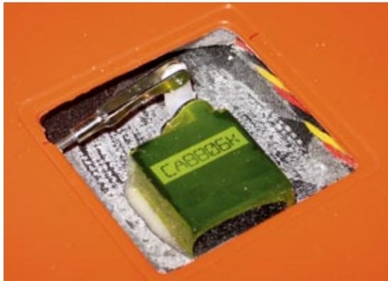
Die Servos werden mit Schrumpfschlauch und Epoxy an ihrem Einsatzort fixiert
