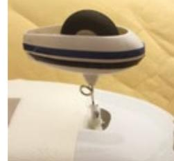
Das Bugfahrwerk wird in die Alu-Hülse eingesteckt und mit einer Madenschraube gesichert
