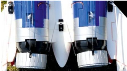
**Drei Servos sind für die Schubvektorsteuerung zuständig und die Düsen zeigen je fünf Grad nach außen**
