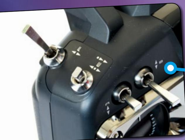
Mehrere Zwei- und Dreiwegeschalter sind bereits am Sendergehäuse integriert
