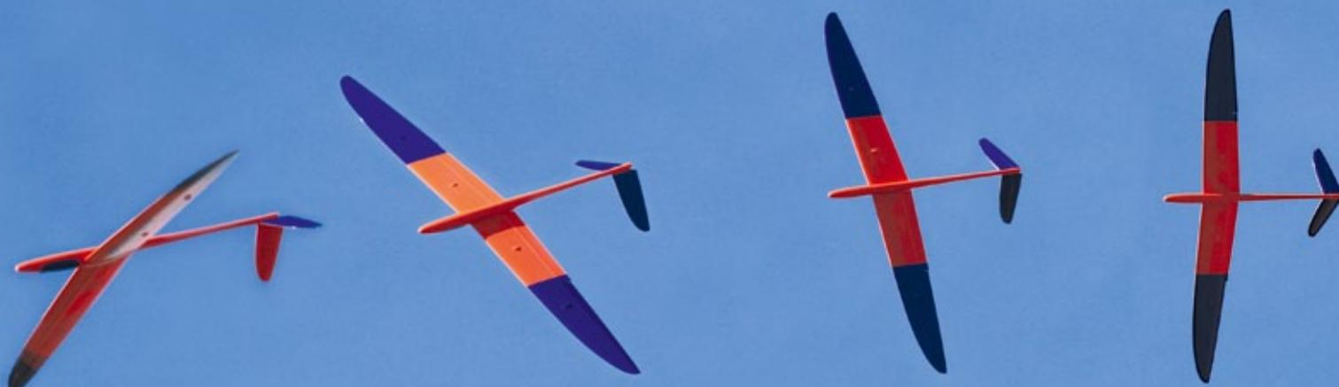
Die Rollrate ist durch den Vierklappenflügel bei Bedarf sehr hoch
