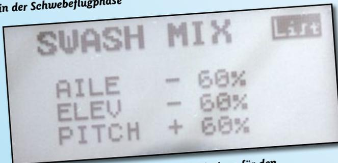
Die Einstellung des Taumelscheibenmischers für den korrekten Servolauf beim Blade 450
