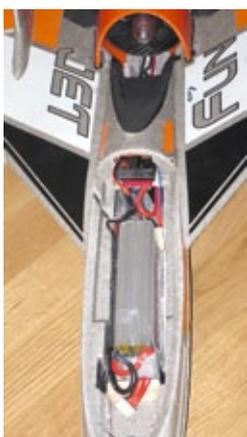
**Anordnung des Empfängers, Reglers, Akkus und der Telemetrie. Im Gegensatz zum 3s-Modell muss der Akku hier stehend eingebaut werden, da der verwendete 4s-LiPo sonst nicht hineinpasst**
