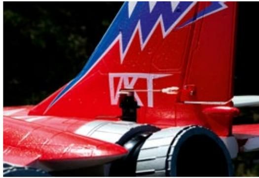
**Die Anlenkung der Seitenruder erfolgt über kurze Gestänge und die Servos sind im Seitenleitwerk selbst eingebaut**
