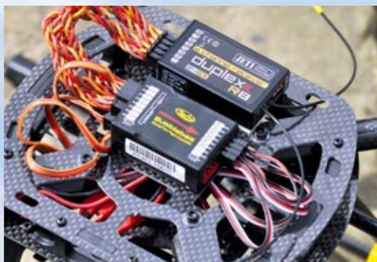
In der Mitte die Control Unit, die eigentliche Steuerelektronik. Darüber der Empfänger
