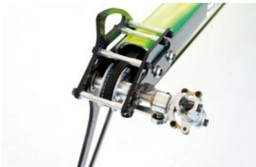
Die Heckriemenrolle ist sehr groß dimensioniert, was ein Überspringen des Riemens bei hohen Belastungen wirkungsvoll verhindert
