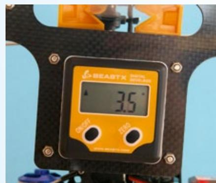
**Bei gleicher Knüppelstellung ohne Expoanteil entsteht ein Einstellwinkel von 3,5 Grad. Der Heli ist agiler**
