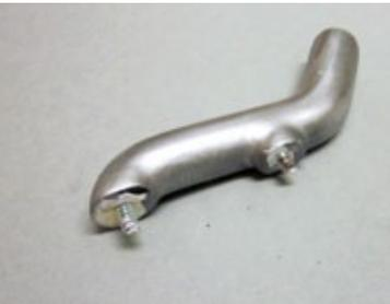
**Der Auspuff ist mit den eingedrehten Schrauben – Kopf abgezwickelt – fertig zum Einkleben**
