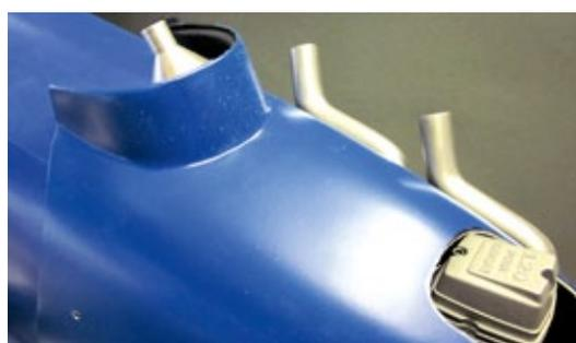
**Hier schaut der Zylinderkopf aus der Cowling, weshalb eine Abdeckung erstellt wurde**
