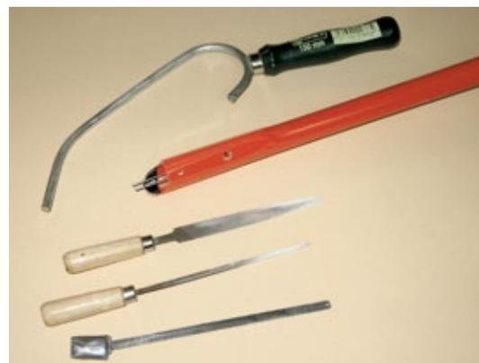
**Mittels eines PUK-Sägeblatts und Schlüsselheilen wurden die Züge vom Rumpfboden gelöst und in der korrekten Position wieder eingearzt**
