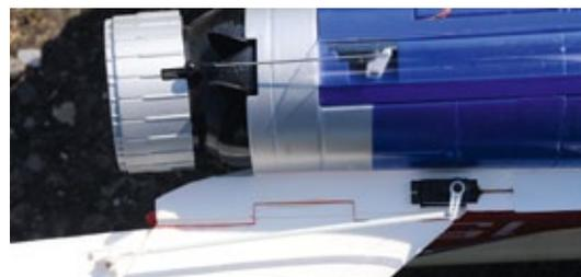
**Das Höhenruder ist nicht als Taileron ausgeführt und daher sind die erforderlichen Ruderausschläge auch so groß wie in der Anleitung angegeben. Auch hier ist die Anlenkung optimal ausgeführt**
