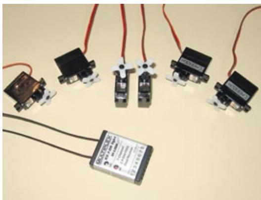
**Sechs Servos, hier DES von Graupner, und ein Siebenkanal-Empfänger von Multiplex werden im Omega Mini verbaut**
