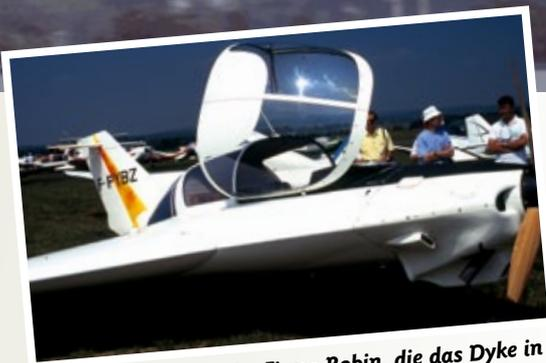
*Der Versuchsträger der Firma Robin, die das Dyke in Manta umbenannte, mit der runden Cockpithaube*
