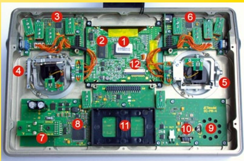
**Elektronik für Knüppel, Schalter, Drehgeber und Sound (1) Grafikkontroller GE-S320240C0; (2) 32-KByte-Grafikspeicher (static RAM); (3) und (6) ATmega-328-Controller; (4) und (5) Knüppelaggregate; (7) 3D-Rotary-Geber; (8) ATmega-329-Controller; (9) Lautsprecher; (10) Soundchip mit Audioverstärker; (11) Batteriefach; (12) Grafik-Display-Anschluss**
