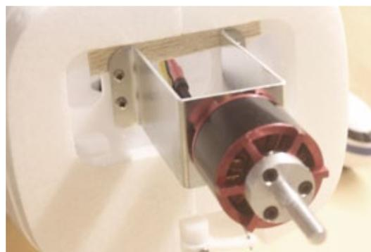
Durch das Hinterlegen der oberen Motorbefestigung mit Holz wurde der Motorsturz auf -2 Grad eingestellt
