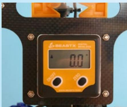
**Null Grad Einstellwinkel bei Mittenstellung des Nickknüppels**
