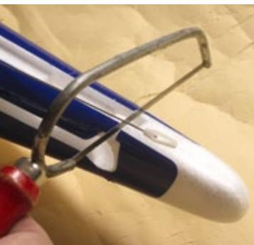
Am Heck wird eine Säge – alternativ ein Cutter – angesetzt und der Schlitz zum Einschieben des Höhenruders hergestellt
