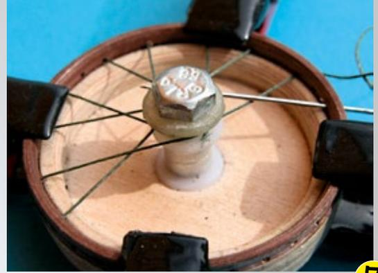
**7 Über eine Schraube mit Mutter wird die Nabe fest in der Montageschablone zentriert**
