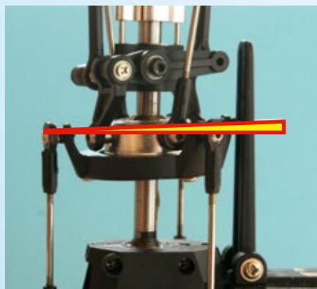
**Mit 25 Prozent Expoanteil entsteht ein relativ geringer Neigewinkel bei halbem Knüppelweg zwischen Mitte und Endanschlag vorn**
