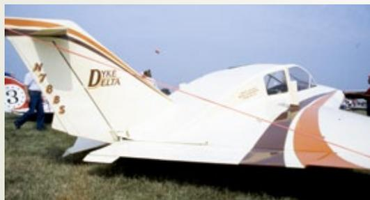
*Einige Nachbauten wurden mit einem Höhenleitwerk ausgestattet*
