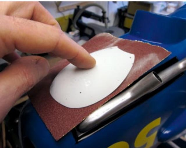
**Der Teil der Spinnerkappe wird mittels Schleifpapier auf die Haubenkontur übertragen**
