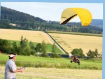
**Beim Start wird der Schirm vom Boden in einer gleichmäßigen Bewegung gegen den Wind aufgezo-gen, kurz die Leinen kontrolliert und dann zügig in die Luft geschoben. Dies erfordert etwas Übung und gelingt Anfangs nicht jedesmal. Das macht aber nichts, Gleitschirme sind sehr robust**
