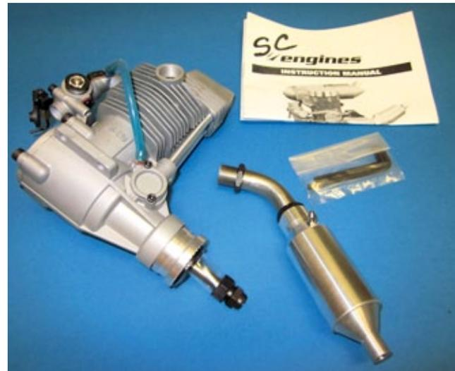
**Der Viertaktmotor SC 120 von J Perkins mit Dämpfer und Werkzeug**
