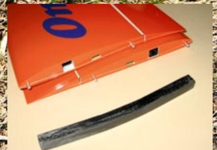
*Bei den Tragflächen ist die Steckung betriebsfertig eingebaut. Die Vierkant CFK-Flächensteckung kommt auch beim größeren Bruder, dem Omega, zum Einsatz*
