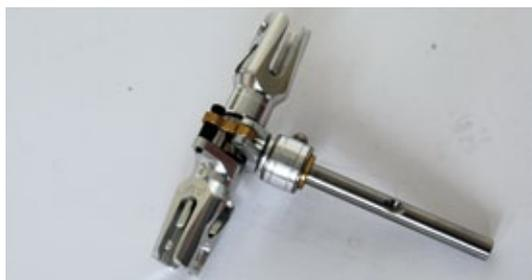
**Der Heckrotor kommt bereits fertig montiert. Alle Schraubverbindungen waren bereits mit Sicherungslack versehen. Natürlich sind in den Blatthaltern Drucklager verbaut**
