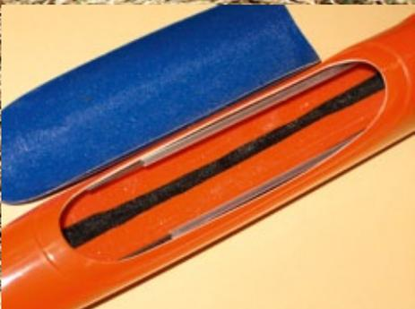
*Der Haubenauschnitt ist großzügig bemessen, der Rumpf per CFK-Rovings verstärkt und die beiden Bowdenzugrohre für das V-Leitwerk sind bereits ab Werk verlegt*
