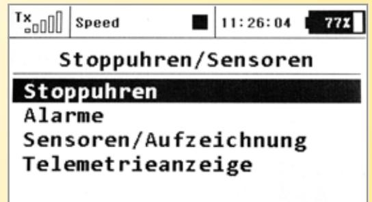
Im Menü Stoppuhren/Sensoren ist die Telemetrie Anzeige ein wichtiges Untermenü: Hier kann der RC-Pilot bestimmen, welche Daten der angeschlossenen Telemetriesensoren auf dem Grafikdisplay erscheinen sollen
