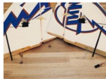
**Bei den beiden Flügelteilen sind lediglich die Karbonstäbe einzukleben – der Rest ist bereits erledigt**
