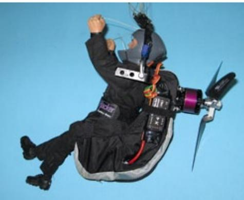
**Die Puristen fliegen ganz ohne Trike oder Schutzkäfig, nur mit einem Rucksackmotor. In den Bergen dient dieser als Heimkehrhilfe, in der Ebene als Starthilfe**
