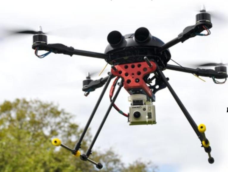
*Die ersten Aufnahmen mit einer GoPro Hero in selbstgebauter Halterung. Es funktioniert, die Vibrationen stören aber – es laufen „Wellen“ durchs Bild*
