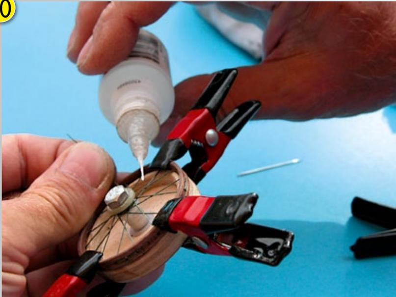
**Klammern halten die Felge. Mit Sekundenkleber den Faden fixieren**
