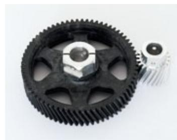
... und die zweite Getriebestufe
