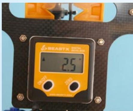
**2,5 Grad Einstellwinkel bei halbem Knüppelweg zwischen Mitte und Endanschlag vorn mit 25 Prozent Expoanteil**
