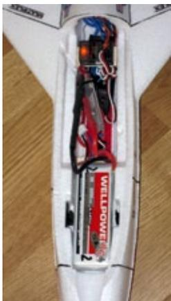
**Anordnung des Empfängers, Reglers, Akkus und der Telemetrie beim 3s-Setup**
