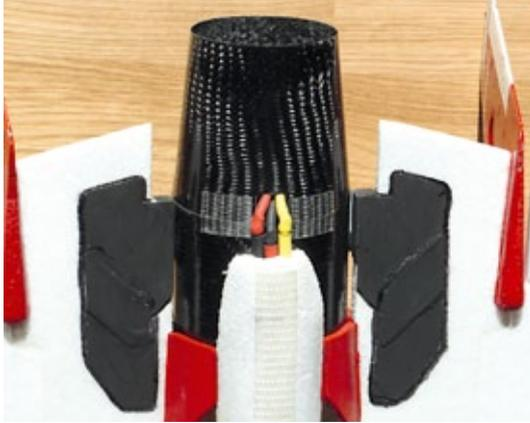
**Die selbst hergestellte Düse aus CFK erhöht die Strömungsgeschwindigkeit und die Speed des Modells**
