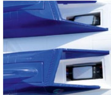
**Die beiden 65-Ampere-Regler sind im Lufterlass eingebaut und somit bestens gekühlt**
