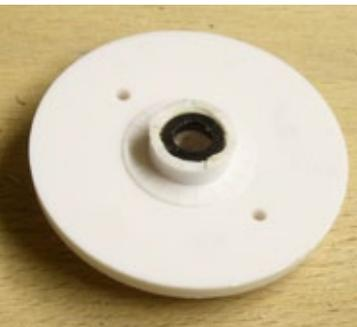
Nachdem die Spinner-rückplatte aufgebohrt wurde, konnte ein Distanzring von einer Luftschraube in das Loch gedrückt werden. So laufen Spinner und Luftschraube sauber rund
