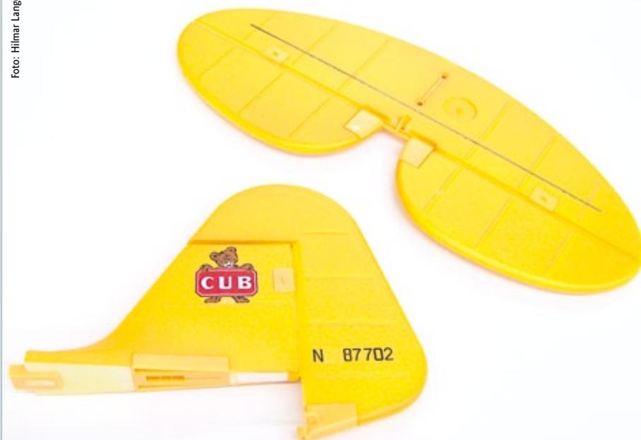
**Leitwerksteile einer Piper-J3. Die elliptische Form ist unverkennbar**
