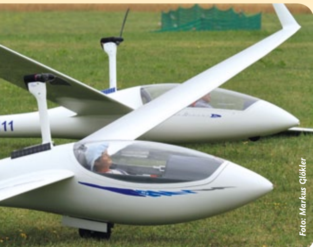
Abbildung 10: Bei diesen Klapptriebwerken von Florian Schambeck Luftsporttechnik reicht ein einziges Propellerblatt
