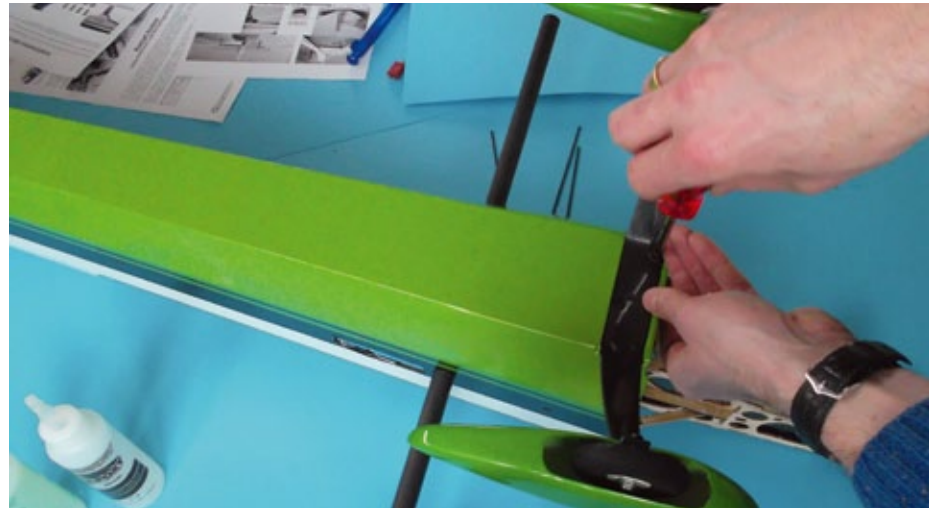
Das CFK-Fahrwerk ist leicht und robust
