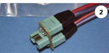
2 Die Anschlussstecker sind schon fertig verlötet und auf einer Platine zusammengeführt
