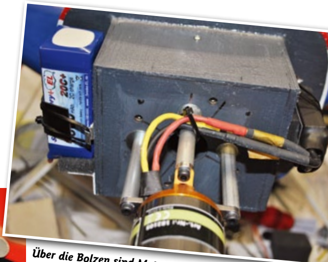
Auch beim Antrieb fiel die Wahl auf ein Setup von Derkum. Der Motor vom Typ Torster Gold A 4130/8-360 und der Regler vom Typ Torster Pro 100 Opto 100 A passen ideal zur Cessna
