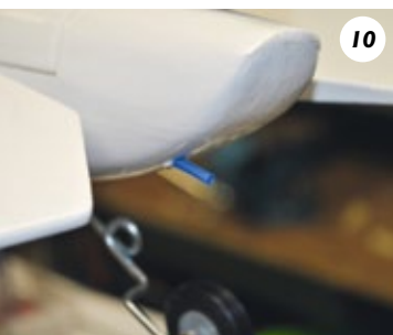
Am Heck der Cessna tritt die Tankentlüftung aus dem Modell
