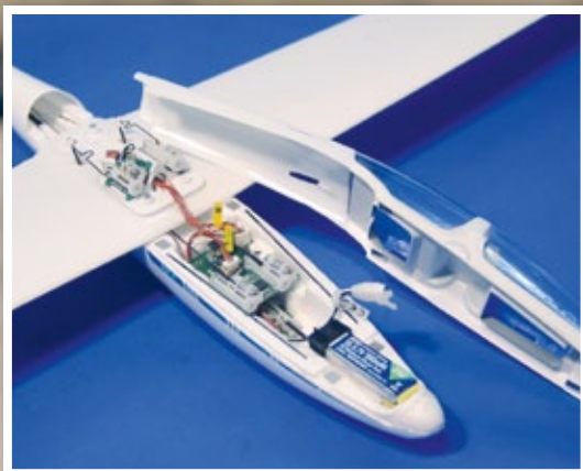
Für jedes Ruder und die Schleppkupplung gibt es ein separates Servo. Jedes kann einzeln angesteuert werden. Und alles ist perfekt ins Modell integriert
