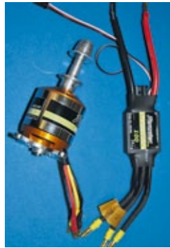
Auch beim Antrieb fiel die Wahl auf ein Setup von Derkum. Der Motor vom Typ Torster Gold A 4130/8-360 und der Regler vom Typ Torster Pro 100 Opto 100 A passen ideal zur Cessna
