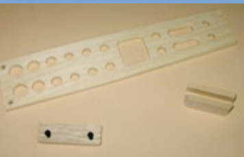
Ein Querbrett mit eingeklebten Einschlagmuttern hält das Akkubrett vorne, ein weiteres Querbrett mit Nut nimmt es im hinteren Rumpfbereich auf
