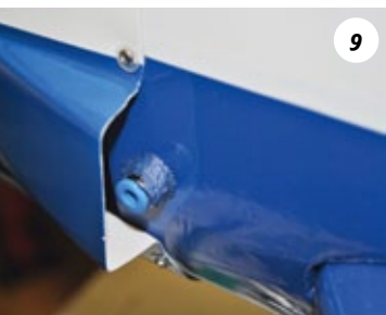
Das Festo-Einwegsperrventil für die Betankung mit Smoke-Öl
