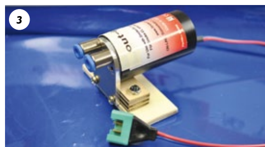
3 Smoke-Pumpe mit selbst angefertigten Halterungen aus Holz
