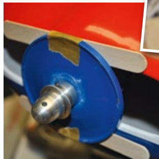
Über die Bolzen sind Motorsturz und Seitenzug gut übertragbar und die Anpassung von Spinnerplatte zu Motorhaube optimal möglich
