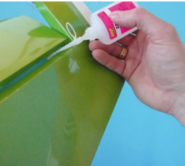
Mit Sekundenkleber – ZAP von LRP electronic – werden die Vliesscharniere verklebt
