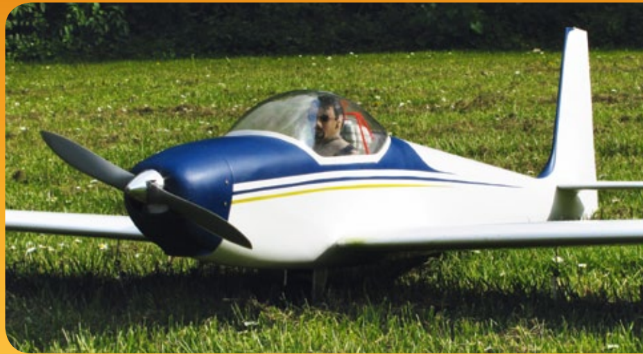
Abbildung 8: Ein 12-Zoll-Propeller an der 3 Meter spannenden ASK14 stellt das absolute Maximum an Durchmesser dar
