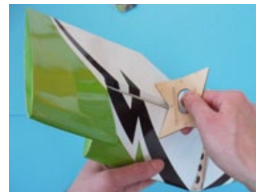
Bei der Montage des Höhenruders hilft die mitgelieferte Winkelschablone
