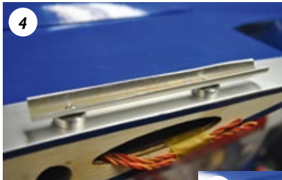
Das hitzebeständige Glasfaservlies wird sonst für Auspuffkrümmer aus dem Kfz-Bereich genommen und verhindert hier, dass die Wärme auf den Flügel ausstrahlt
