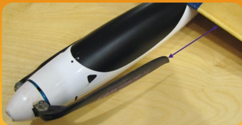
Abbildung 9: Zwischen Blattspitze und Nasenleiste muss ein gewisser Abstand sein, sonst sind Beschädigungen des Flügels zu erwarten
