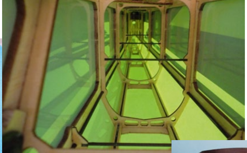
Am Rumpf wird die konsequente Leichtbauweise deutlich: Überall Ausfräsungen plus CFK, wo es drauf ankommt
