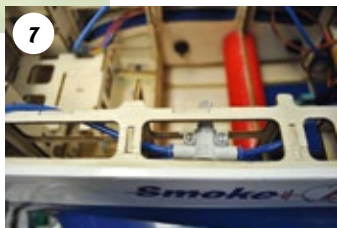
Die beiden Festo-Ventile sitzen innen an der Rumpfwand. Hier können sie sehr gut verstellt werden
