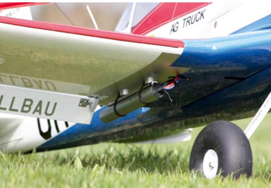
Am inneren Stummelflügel sind die elektrischen Smoker montiert. Gut zu erkennen sind die Lager der Landeklappen
