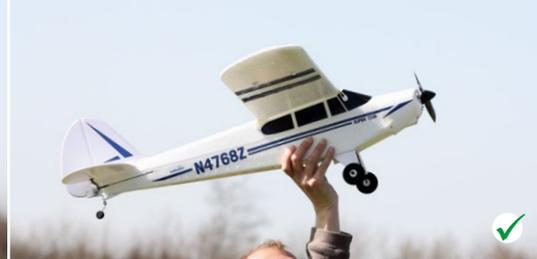
**Zum Starten ist das Modell mit einem beherzten Schubs aus der Hand zu werfen, allerdings nicht in Richtung Boden oder zu steil, sondern um wenige Grad nach oben geneigt**
