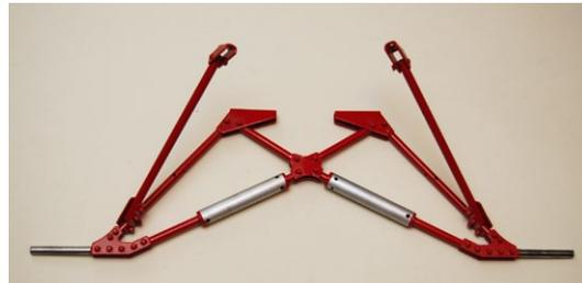
**Durch die Federung verkraftet das stabile Fahrwerk auch härtere Landungen**
