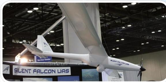
Diese Konstruktion von Silent Falcon UAS ist für Langstrecken-Missionen konzipiert und kann je nach Bedarf mit verschiedenen Sensoren bestückt werden. Zum Einsatz kommen Klappflugschrauben von aeronaut
