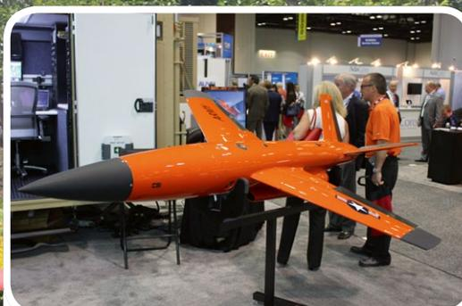
**Bei einer Länge von 3.280 Millimeter hat die MQM-178 Firejet von CEi eine Spannweite von 1.980 Millimeter. Das turbinengetriebene Flugobjekt wird über ein pneumatisches Startsystem in die Luft gebracht und als Ziel im Pilotentraining verwendet**
