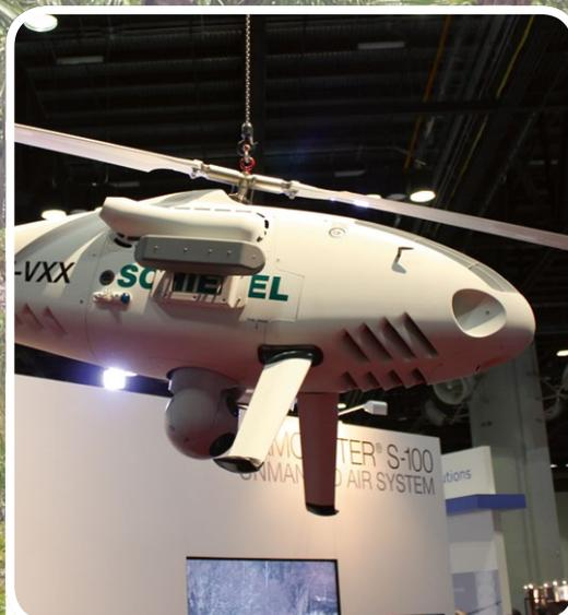
*Schiebel Unmanned Air Systems stellte den Camcopter S-100 vor. Das Leergewicht des autonom fliegenden Kopters beträgt 110 Kilogramm, der Rotordurchmesser 3.400 Millimeter*
