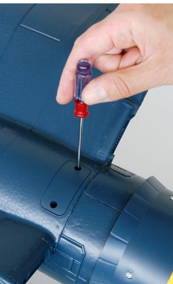
**Zwei Schrauben fixieren den Flügel sicher am Rumpf**
