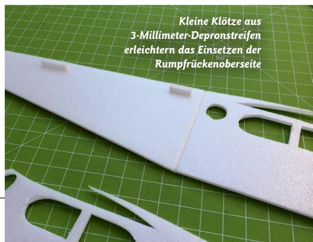
*Kleine Klötze aus 3-Millimeter-Depronstreifen erleichtern das Einsetzen der Rumpfrückenoberseite*
