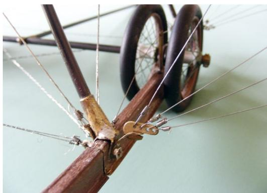
**Rechts erkennbar ist die am Fahrwerk eingehängte untere Flügelverspannung. Zahlreiche Messingbeschläge, die auf CFK oder Holz montiert sind, ermöglichen erst die Scale-Bauweise**
