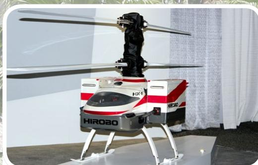
*Der HX-1 von Hirobo ist ein multifunktionell einsetzbarer Koaxial-Heli mit einem 2.400-Millimeter-Rotorkreis und einer Länge von 1.253 Millimeter*
