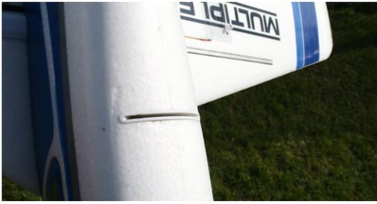
**Der Schlitz im Rumpfboden nimmt das Fahrwerk oder den zentralen Schwimmer auf**
