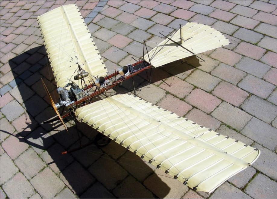
**Der erste Nachbau aus dem Jahr 1987 hatte fast zwei Meter Spannweite und wurde zu schwer, um fliegen zu können**
