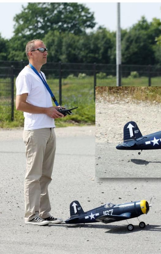
**Einfach und sicher ist der Bodenstart: Hinters Modell stellen, nochmals Ruder checken, stetig Gasgeben, dann etwas Höhenrunder ziehen, schon hebt die Corsair ab und steigt**
