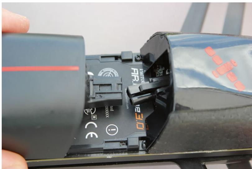
**Der 3s-Flugakku hat eine Kapazität von 1.200 Milliamperestunden und wird mittels Mini-Tamiya-Stecksystem am Kopter angeschlossen. Bei einem Crash werden die Verbindung gelöst und die Stromversorgung getrennt**
