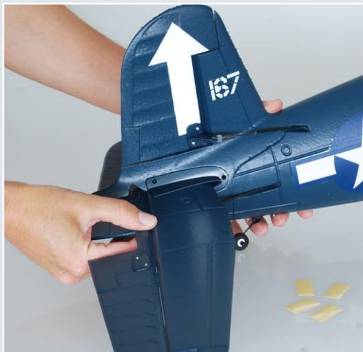
Das Höhenleitwerk ist einzuschieben und mit vier Klebestreifen zu sichern
