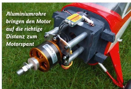
*Aluminiumrohre bringen den Motor auf die richtige Distanz zum Motorspant*
