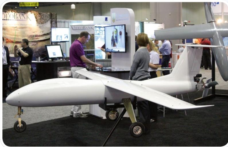
Die Outlaw G2E von Griffon Aerospace hat eine Spannweite von 4.900 Millimeter und verfügt über einen 150-Kubikzentimeter-Motor
