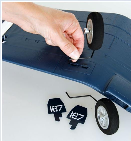
Das fertig gebaute Drahtfahrwerk braucht lediglich eingesteckt und gesichert werden
