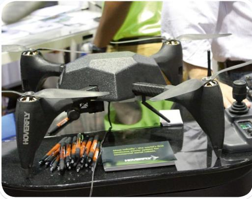
Das LiveSky-System ist für Langzeiteinsätze ausgelegt und wird inklusive 12-Volt-Netzteil geliefert, das die Stromversorgung vom Boden aus sicherstellt. Ein Brushless-Gimbal sowie ein Joystick-Sender gehören zum Set
