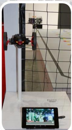
*Jumping Sumo lautet der Name dieses Modells von Parrot. Es wird per WLAN gesteuert und gibt ein Live-Bild auf dem Smartphone aus*
