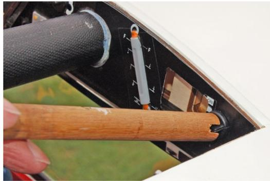
Ein Rundstab mit einem Querschlitz erleichtert das Ein- und Ausdrehen der Flächenbefestigungsschrauben erheblich
