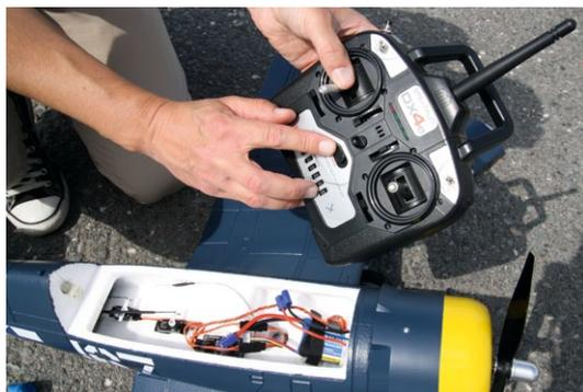
**Erst Sender einschalten, Gasknüppel einschließlich Trimmhebel nach unten, dann den Akku anschließen**
