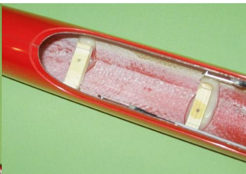
**Über zwei eingeklebte Sperrholzspannten lässt sich das Servobrett jederzeit ein- und wieder ausbauen**
