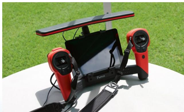
**Der Prototyp des Skycontrollers: Die vier integrierten Antennen sollen die WLAN-Reichweite auf bis zu 2.000 Meter vergrößern**
