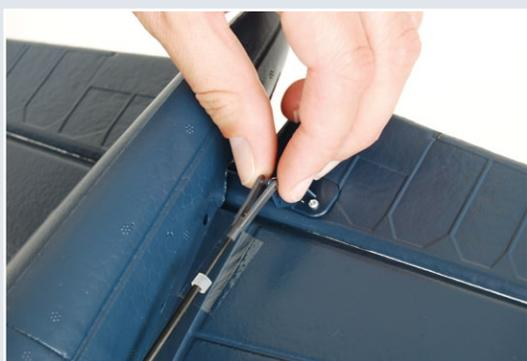
Gestängeklips einhängen und mit der Gummitülle sichern
