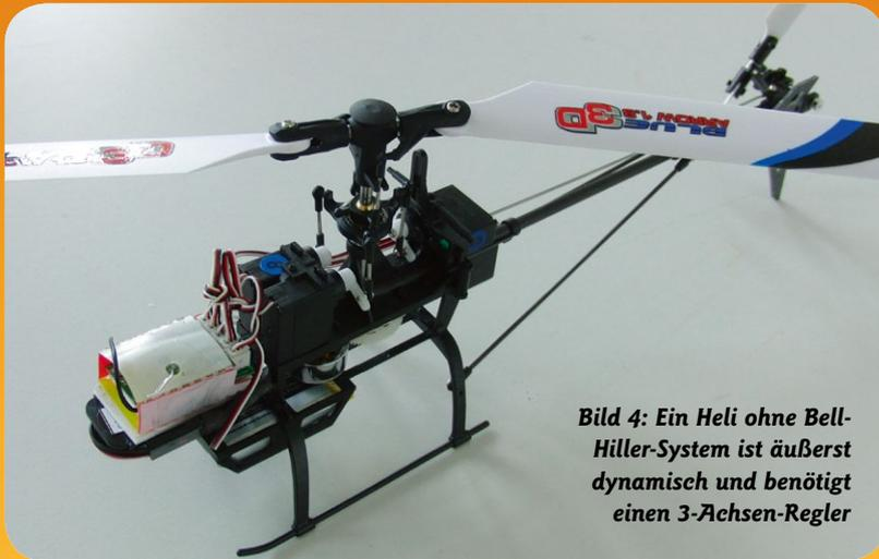
**Bild 4: Ein Heli ohne Bell-Hiller-System ist äußerst dynamisch und benötigt einen 3-Achsen-Regler**
