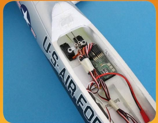
**Abbildung 5: Ein Drei-Achs-Beschleunigungsregler (P-Regler) für Flächenmodelle**
