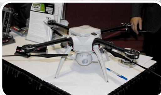
50 Minuten Flugzeit verspricht der Sky Ranger von Aeryon Labs. Die Ausleger lassen sich schnell abnehmen, was den Kopter sehr transportfreundlich macht. Der Sky Ranger ist selbst bei Windgeschwindigkeiten von 90 Kilometer pro Stunde einsetzbar
