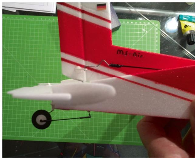
*Die Drehbewegung des Seitenleitwerks wird mittels Draht auf das Spornrad umgelenkt*
