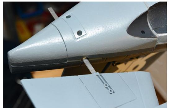
**Über zwei Schrauben wird das Pendelhöhenruder auf dem Lenkstab befestigt**
