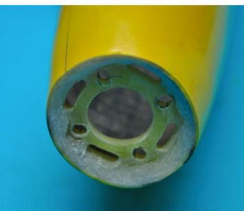
**Dick eingeklebter, runder Motorspant mit Kühlluftschlitzen**
