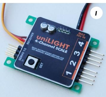
**Das Schaltmodul steuert bis zu vier unabhängige Lichtkreise**
