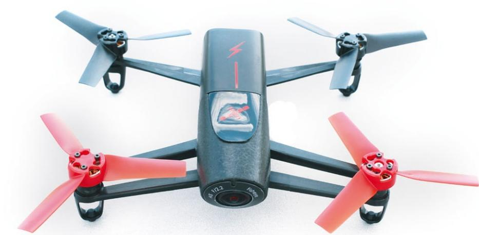
Höhensensor und einer vertikalen Kamera sorgen für eine gute Stabilität und Manövrierbarkeit des Modells. Dabei hat die WLAN-Funkstrecke eine Reichweite von rund 300 Meter. Dazu tragen vier Keramikantennen im 2,4- und 5-Gigahertz-Band bei, die auf der Unterseite der Bebop Drone platziert sind.
