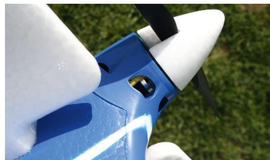
**Der Elapor-Spinner ist auf die Propellermutter aufgeklebt, was wenig Service-freundlich ist**
