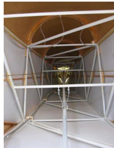
**Beim Blick in den Hinterrumpf ist ganz klar der Aufbau des Stahlrohrrahmens, der Rumpfoberseiten-Sperrholzbeplankung sowie der Stoffbespannung zu erkennen**
