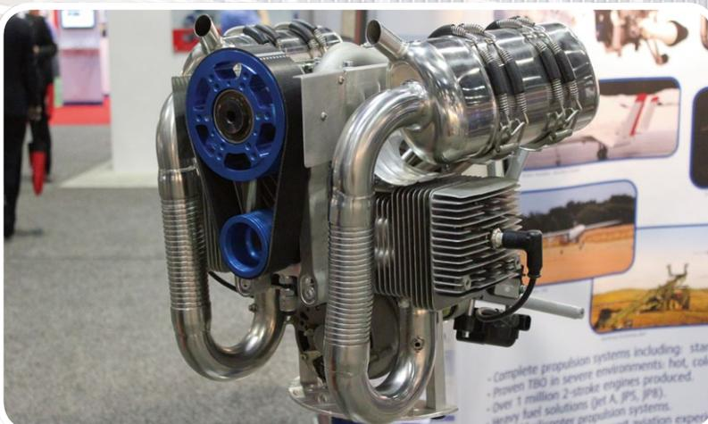
Der S1215 von Hirth ist ein luftgekühlter, membransteuerter Zweitakter mit Höhen- und Temperaturkompensation. Bei einem Hubraum von 521 Kubikzentimeter leistet das Aggregat 50 PS
