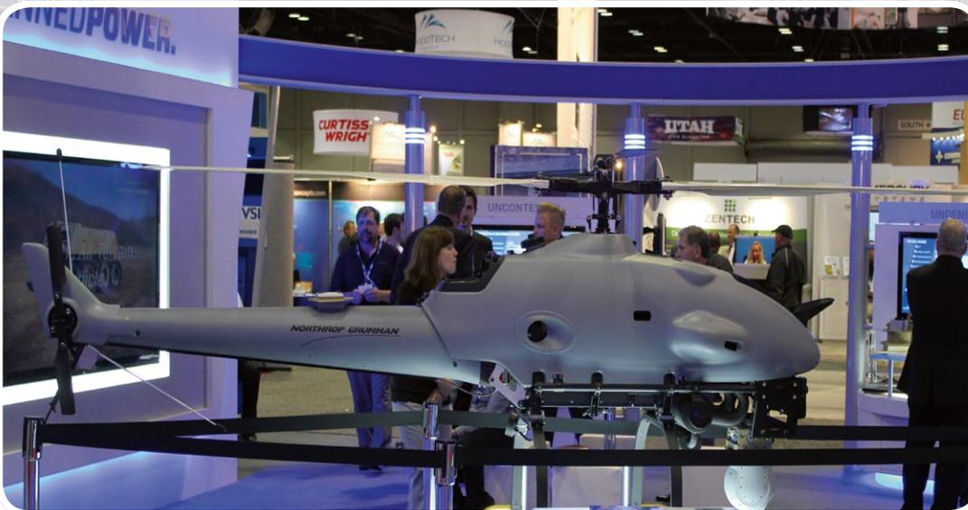
Von Northrop Grumman stammt die R-Bat, ein Überwachungs-System mit einer Länge von 3.650 Millimeter, einem maximalen Abfluggewicht von 93 Kilogramm und einer Einsatzzeit die über vier Stunden beträgt
