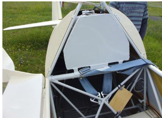
**Hinter dem Führersitz ist der 20-Liter-Kraftstofftank angeordnet. Der Stahlrohrrahmen ist in diesem Bereich als Überrollbügel ausgelegt**
