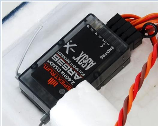
Herzstück der Corsair S ist die im neuen Empfänger AR636 integrierte SAFE-Technologie
