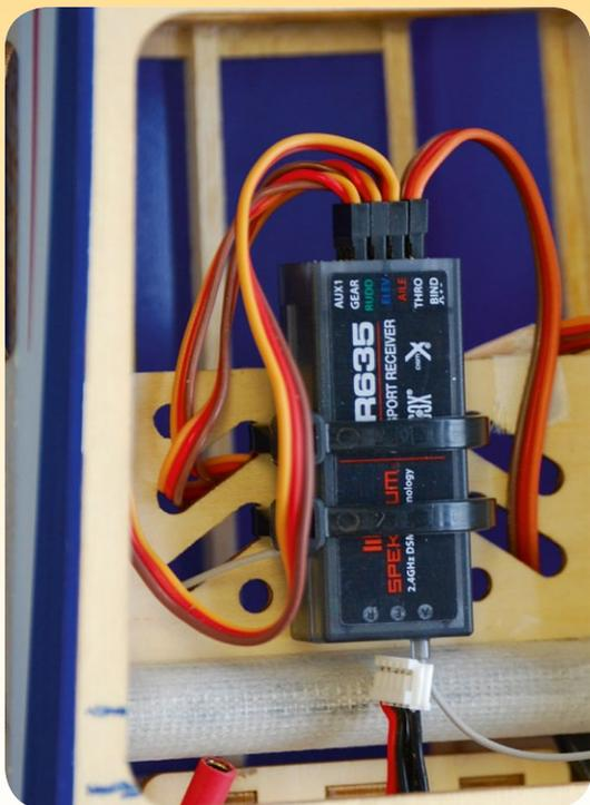
**Abbildung 3: Empfänger AR635 von Spektrum mit integrierter Regelung (hier Flächenstabilisierung)**
