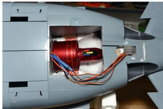
**Der original Impeller lässt sich leicht durch einen Impeller mit höherem Wirkungsgrad ersetzen**
