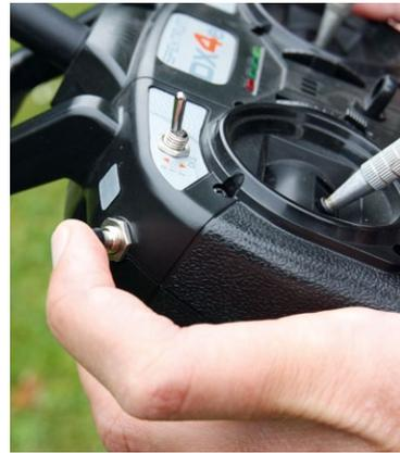
**Der Panikbutton hilft in Notsituationen, dient aber auch als Landehilfe: Anfliegen, gedrückt halten, Gas raus, aufsetzen lassen. Daneben der dreistufige SAFE-Schalter**
