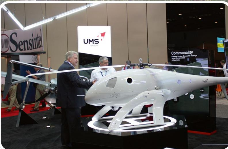
Die Bezeichnung R-350 trägt dieses System der UMS Group. Es hat einen Missionsradius von 120 Kilometer, einen Rotordurchmesser von 3.500 Millimeter, verfügt über eine 25-kW-Turbine und erreicht eine Maximalgeschwindigkeit von 145 Kilometer pro Stunde
