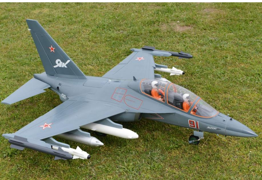
gere Zeit der Sonne ausgesetzt sein. Durch Wärmestau bläht sich beispielsweise der Schaum im Cockpit schon nach kurzer Zeit auf. Hier hilft, die Yak zuzudecken.
