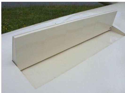
**Einfache Bremsklappen an der Tragflächen-Oberseite dienen zur Gleitwinkel-Steuerung**
