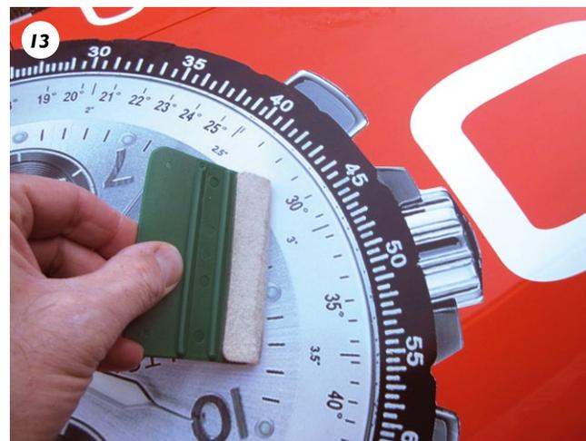
**Mit dem Raket werden die Luftblasen herausgedrückt**
