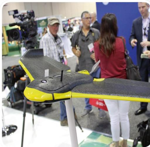
**700 Gramm wiegt die sensefly eBee von Parrot. Das Modell mit einer Spannweite von 960 Millimeter fliegt vollständig autonom und wurde als Werkzeug zum Kartographieren entwickelt**
