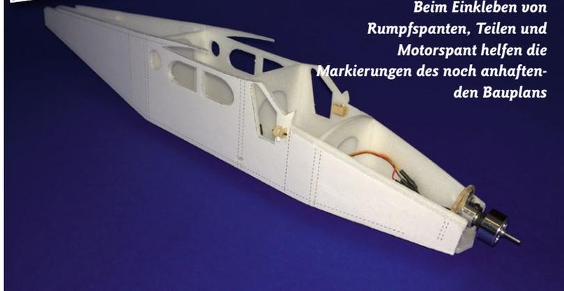
wenn man das Depron zuvor mit einer CD an einem Lineal über die Markierung rollt und leicht andrückt. So bekommt man eine saubere Kante, ohne die Oberflächenstruktur zu zerstören. Mit den Knickkanten hinter dem letzten Rumpffenster wird genauso verfahren.
