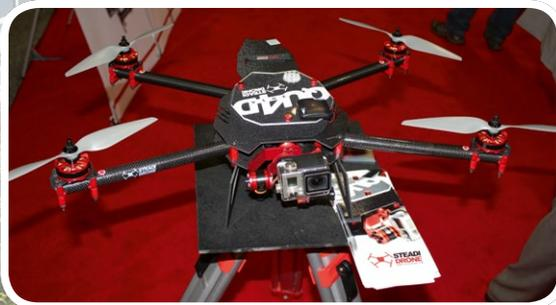
Der QU4D ist die kompakteste Koptergröße im Sortiment von Steadi Drone. Das Modell verfügt über GPS-Navigation und ein integriertes Brushless-Gimbal für Action-Cams des Typs GoPro
