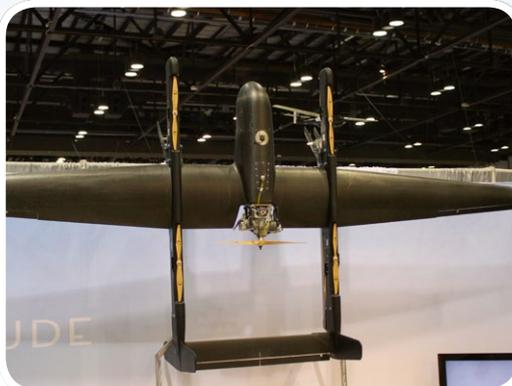
Latitude, bekannt durch seine Hybrid-Quadrotor-Modelle, zeigt mit der HQ50 ein System, das mit Zuladung eine maximale Flugzeit von 24 Stunden erreichen kann
