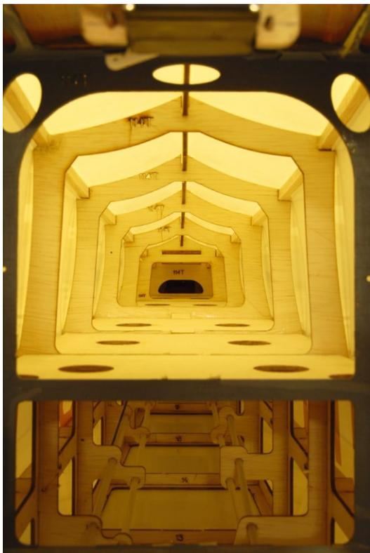
wurden im Rahmen der Fertigung komplett mit Klebmasse gefüllt, was dazu führt, dass das Auffinden der Positionen unter der Folienbespannung eher einem Suchspiel gleicht und nach dem Freilegen ein Gewindeschneider wieder für Funktionsfähigkeit sorgen muss.
