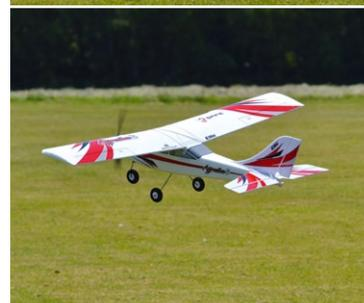
**Beim Bodenstart langsam den Knüppel auf Dreiviertel- bis Vollgas schieben und nach wenigen Metern Rollstrecke etwas am Höhenruder ziehen. Der Steigwinkel nach dem Abheben sollte nicht über 20 Grad hinausgehen. Driftet das Modell beim Rollen zu einer Seite ab, ist mit etwas Seitenruder die Spur zu halten**
