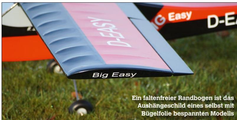
Ein faltensfreier Randbogen ist das Aushängeschild eines selbst mit Bügelfolie bespannten Modells
