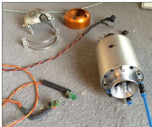
Dank des großzügigen Zugangs zur T-15, ließ sich diese zum Austausch eines Sensors leicht ausbauen
