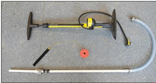
Die komplette Startvorrichtung. Hier bereits mit Kunststoffmanschette
