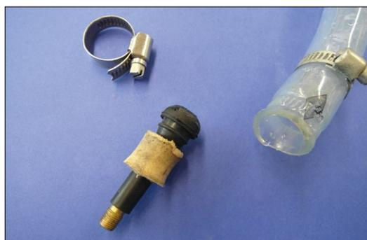
Das pumpenseitige Ende: Das Ventil steckt in einem halbierten und durchbohrten Kunststoffkorken. Schlauchschellen sorgen für Halt und Dichtigkeit
