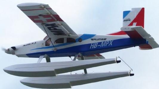
Ruderblatt höchstens einige Millimeter über die Unterkante des Schwimmers herausstehen. In der Verdrängerphase, also wenn man langsam auf dem Wasser unterwegs ist, befindet sich das Ruder dann im Wasser und wirkt. Ist das Modell schnell unterwegs, ist die Hinterkante der Schwimmer frei und die Wasserruder haben keinen Kontakt mehr. Für die dann noch anfallenden Korrekturen reicht das „aerodynamische“ Seitenruder am Modellrumpf allemal aus.
