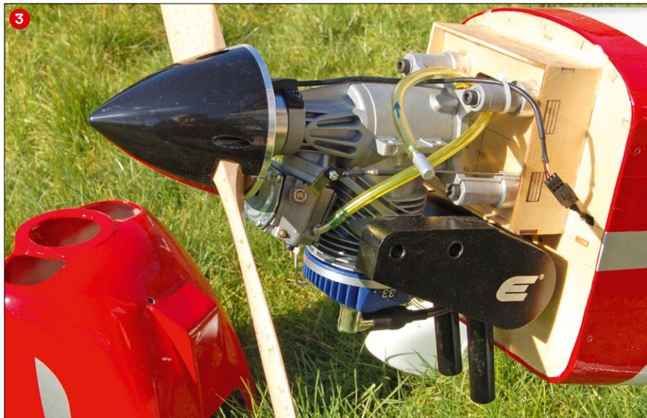
Zur Vermeidung von Blasenbildung wird das einfache Tankpendel gegen das dem Motor beiliegende Feinsiebpendel getauscht (1). Geht auch mit Kabelbinder, besser ist jedoch Sicherungsdraht in zweifacher Wicklung (2). Der Benzinmotor Evolution 33GX ist an seinem Arbeitsplatz befestigt (3)
