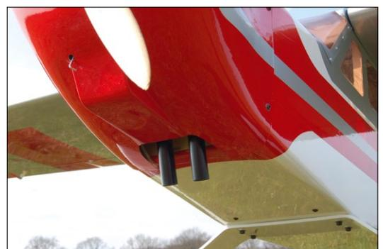
Lediglich zwei Rohre schauen nach unten aus der Motorhaube. Dank des verwendeten „Luftleitblechs“ genügt die Öffnung voll und ganz
