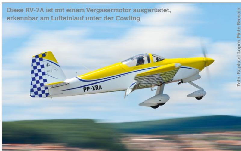
Diese RV-7A ist mit einem Vergasermotor ausgerüstet, erkennbar am Luftenlauf unter der Cowling
