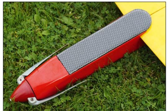
willkürlich eine Linie auf der Rumpfseite festgelegt und von dort nach unten die Rumpfseite mit der Carbonfolie bespannt. Anschließend den Rumpfboden dann wie gewohnt bebügeln. Den Übergang zwischen der Seitenbespannung und der Folie am Boden sieht man trotz der Carbonbedruckung nur, wenn man es weiß und ganz genau hinsieht. Auf dem Flugplatz ist es jedenfalls noch niemandem aufgefallen.
