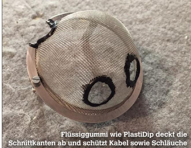
Flüssiggummi wie PlastiDip deckt die Schnittkanten ab und schützt Kabel sowie Schläuche
