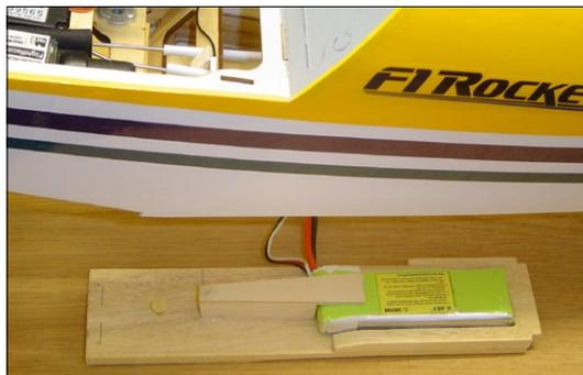
Um den Schwerpunkt mit dem schweren Viertakter ohne Bleizugaben einstellen zu können, muss der Empfängerakku weit in den Leitwerksträger hinein. Eine selbstgefertigte Lagerschiene sorgt für sicheren Halt
