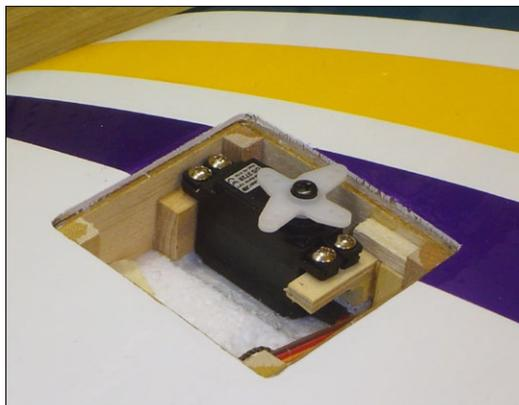
Bei stehender Montage eines flachen Servos kann die Befestigung direkt im Servoschacht erfolgen
