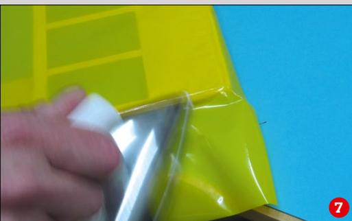
Mit Sorgfalt und etwas Ziehen der Folie arbeitet man die Rundungen der Endleiste heraus
