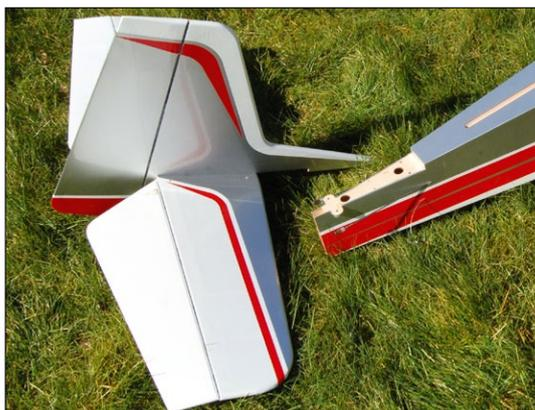
Mit insgesamt sechs Schrauben wird das Leitwerk zusammengehalten und am Rumpf befestigt. Dann kann das Seitenleitwerk mit dem Höhenleitwerk verschraubt und schließlich mit dem Rumpf verbunden werden
