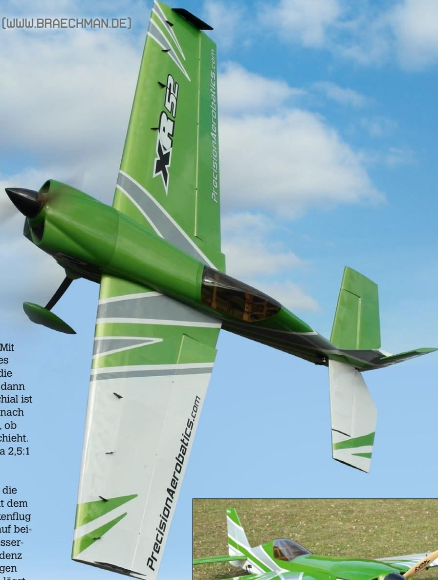
Besonders markant sind die aggressiv wirkende Motorhaube, die weit zurückliegende Kabine, der Holzpropeller und CFK-Spinner
