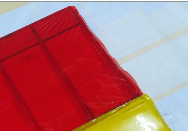
Das erste Feld des Außenflügels wird erst nach dem Verkleben der Flächenteile gespannt
