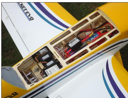
Optimale Hebelverhältnisse ermöglichen die Lagerung des Antriebsakkus bei elektrischer Auslegung genau im Schwerpunkt. Platz ist ausreichend vorhanden
