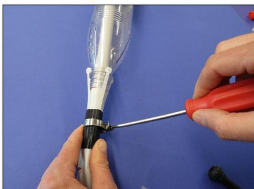
Die Kabelbinderklötzchen greifen in den Kragen am Flaschenhals. Im regelmäßigen Abstand von einem Stück Tape gehalten, verteilen sich die Kabelbinder gleichmäßig um das Rohr. Eine Schlauchschele hält sie fest
