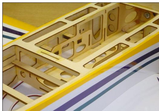
Durch einen zweischaligen Aufbau und saubere Verzapfung wird die Rumpffront extrem torsionssteif
