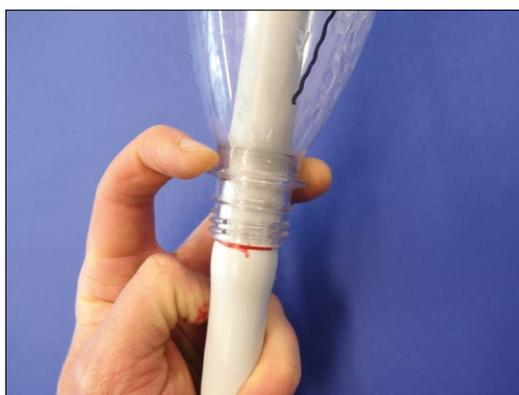
So wird es dicht: Das Rohr wird an der Markierung erhitzt und vorsichtig aufgepustet. Auf die noch leicht warme Ausbuchtung wird die Flasche gesteckt, um eine möglichst gute Passung zu erzielen
