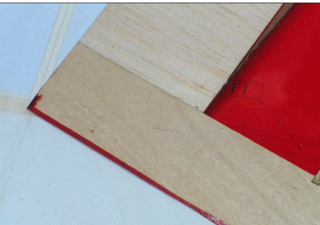
Bei transparenter Folie sollte man unbedingt die Überstände sauber abschneiden, denn man sieht sie auch nach dem Bespannen der Gegenseite deutlich – ein schmaler Streifen Carbonfolie deckt diese Stellen ab
