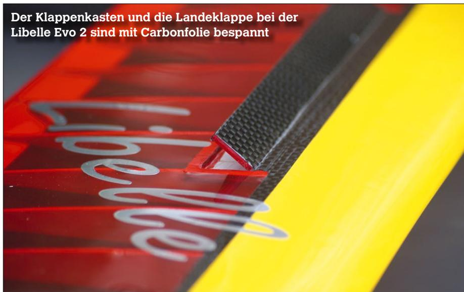
Der Klappenkasten und die Landeklappe bei der
