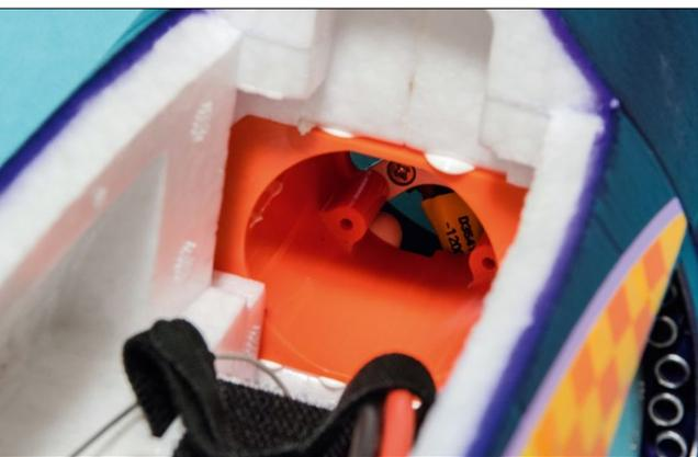
Der Motorträger ist ein großes Kunststoff-Bauteil, das fest im Rumpf verankert ist. Und das ist bei 1.000 Watt Antriebsleistung auch gut so
