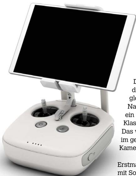
Neu designtes, ergonomisches Sendergehäuse mit zwei Sende-Antennen und verbesserter Smartphone-Halterung
