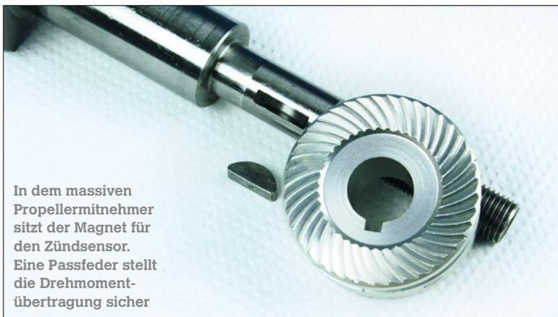
In dem massiven Propellermitnehmer sitzt der Magnet für den Zündsensor. Eine Passfeder stellt die Drehmomentübertragung sicher
