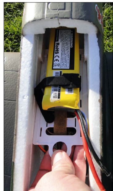
Der LiPo wird auf seiner Halterung wie eine Schublade in den Rumpf eingeschoben
