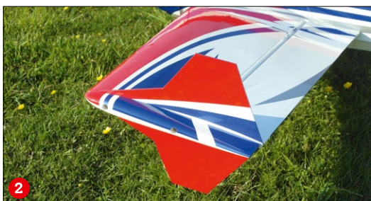
Leicht, stabil und alltagstauglich ist das Heckfahrwerk der Extra 330 LT (1). Die Side-Force-Generatoren stabilisieren die Extra im Harrier und verbessern die Messerflugeigenschaften (2). Eine klassische Form und ein gelungenes Finish sorgen für einen souveränen Auftritt (3)
