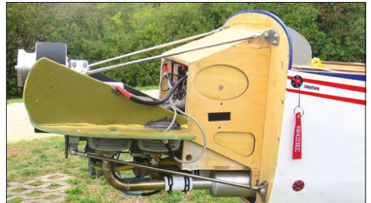
Vier Streben aus Edelstahl stützen den Vierzylinder-Boxermotor samt Riemengetriebe ab, damit sich die Antriebseinheit nicht während des Flugs aufschaukeln kann
