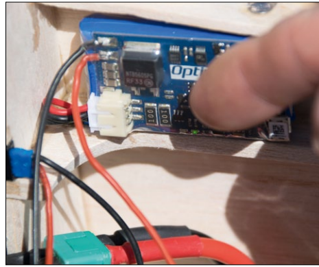
Abbildung 5: LED signalisieren die Betriebsbereitschaft
