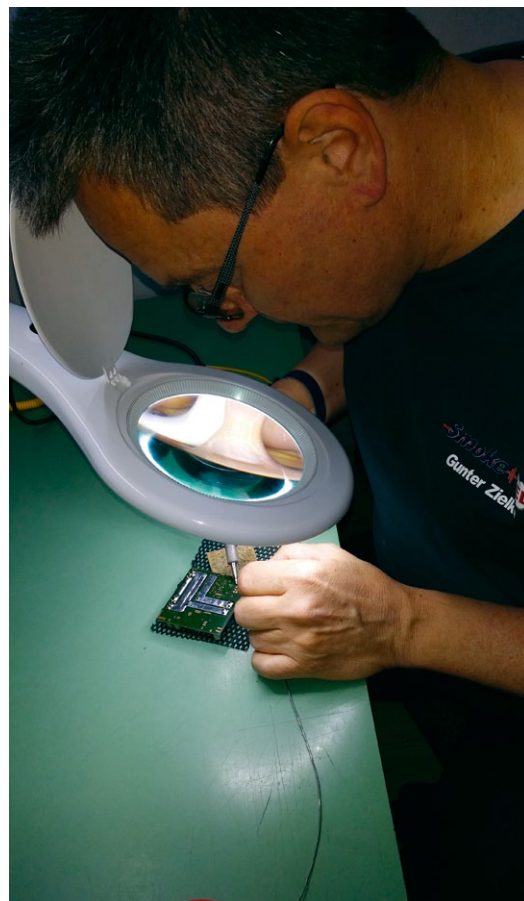
Gunter Zielhe optimiert laufend die Funktionssicherheit und den Funktionsumfang des GF-Smokedrivers durch Einbau und Test neuer elektronischer Komponenten
