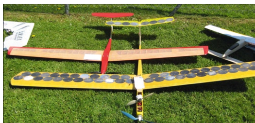
Ursprünglich verwendete man runde Solarzellen, wie in diesem Modell von Wolfgang Bleher
