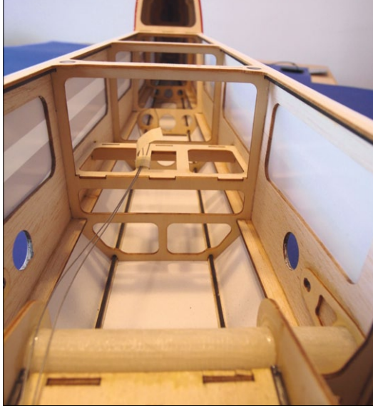
Exemplarisch für die Leichtbauweise: der filigrane und trotzdem stabile Rumpf
