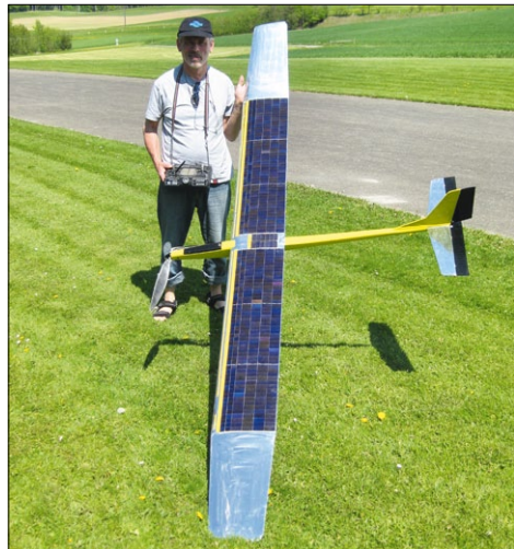
Auch dieser Trend ist im Modellflug heute fast vergessen: Edwin Bloch mit seinem Solarsegler ohne Speicherbatterie. Gefühlte 1.000 monokristalline Solarzellen auf der Fläche liefern die Energie. Das Modell fliegt auch heute noch nur mit Energie aus Sonne
