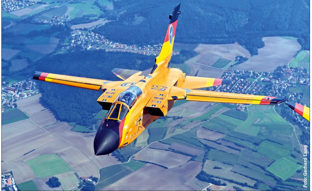
Der WTD 61 Tornado mit den Flächen in 25-Grad Stellung, die Vorflügel sind ausgefahren
