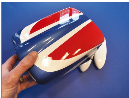
Die GFK-Motorhaube ist fast perfekt passend zur Bügelfolie lackiert
