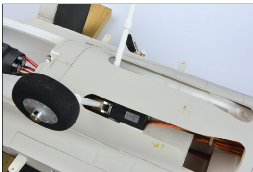
Das elektrische Einziehfahrwerk fährt nach vorn ein
