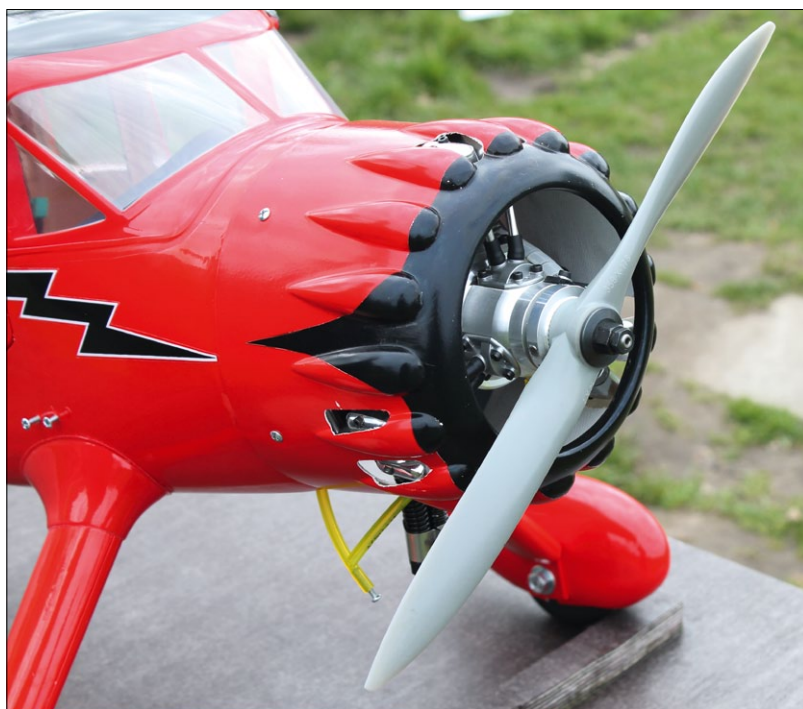
Der Dreizylinder-Sternmotor von Saito ist leistungstechnisch gut dimensioniert. Damit er unter die Haube passt, sind nur kleine Ausschnitte notwendig
