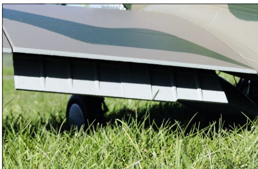
Wie beim großen Vorbild: Auch das Modell verfügt über Spreizklappen
