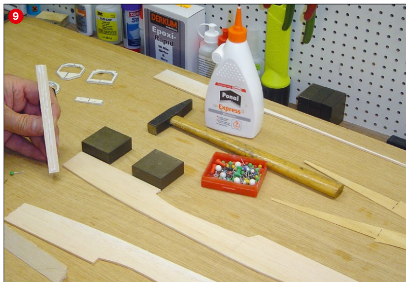
Eine Verklebung mit Weißbleim erfordert den Einsatz von Fixiernadeln während der Trocknungsphase
