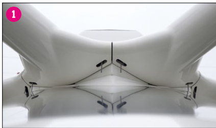
Detailansicht: Der Übergang der Rotorebene zur Kabine des Volocopters (1). Der Volocopter lässt sich im Vergleich zu anderen Ultraleichtsystemen sehr einfach steuern. Die Instrumente im Cockpit sind daher übersichtlich (2). Der Pre-Flight-Check dauert nur wenige Sekunden. Sind alle Systeme auf Grün, kann gestartet werden (3)
