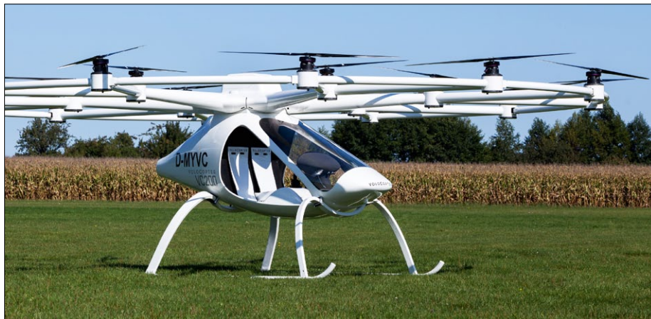
Der Durchmesser der Rotorebene beträgt 7.600 Millimeter. Angetrieben wird das System von 18 Elektromotoren
