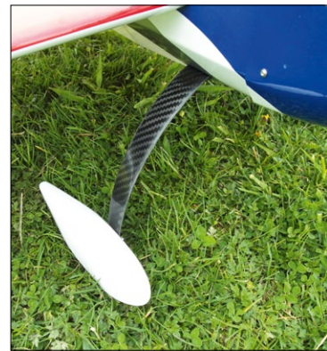
Das Carbon-Fahrwerk ist sogar aerodynamisch profiliert
