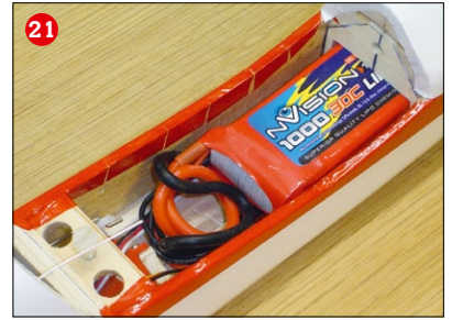
Der Platz im schlanken Rumpf reicht für Akku und RC-Komponenten gerade aus
