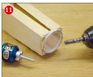
Die Innenkante des kreisrunden Frontrings dient als Führung beim Ausfräsen des Motorraums
