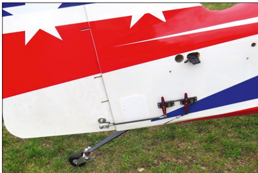
Seitenruder und Spornrad sind gemeinsam mit vier Spektrum HV-Servos der 40-Kilogrammklasse angelegt
