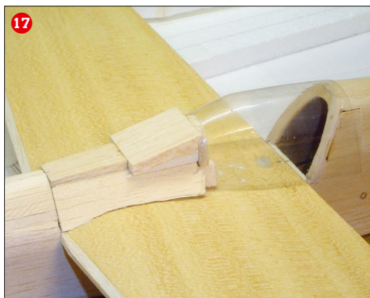
17 Der Bereich oberhalb des Flügels wird mit Balsa aus der Restekiste und, wenn verfügbar, mit einer Klarsichthaube gestaltet
