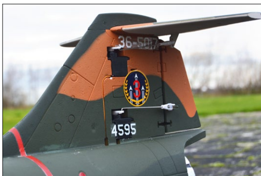
Die Servos im Seitenleitwerk fallen nur bei genauem Hinsehen auf
