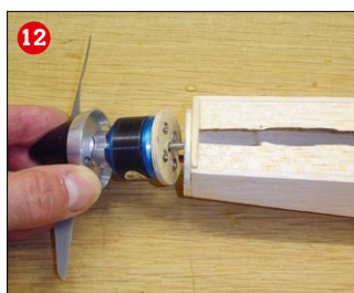
Die komplette Antriebseinheit wird mit angesetztem Montagespant in die Rumpfföffnung eingeschoben
