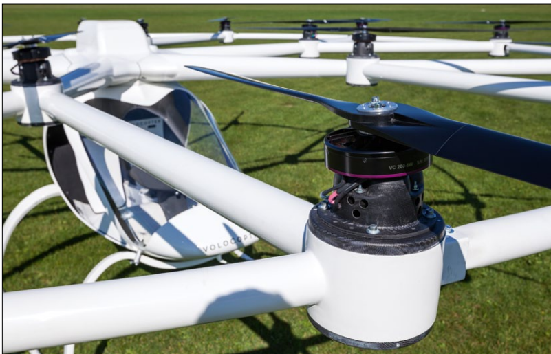
18 Elektromotoren treiben den Volocopter an. Diese verteilen sich auf der 7.600 Millimeter durchmessenden Rotorebene
