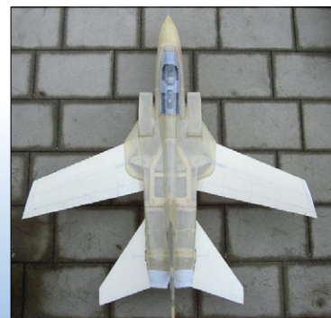
Die Flächenstellungen bei 25, 45 und in Endstellung 67 Grad
