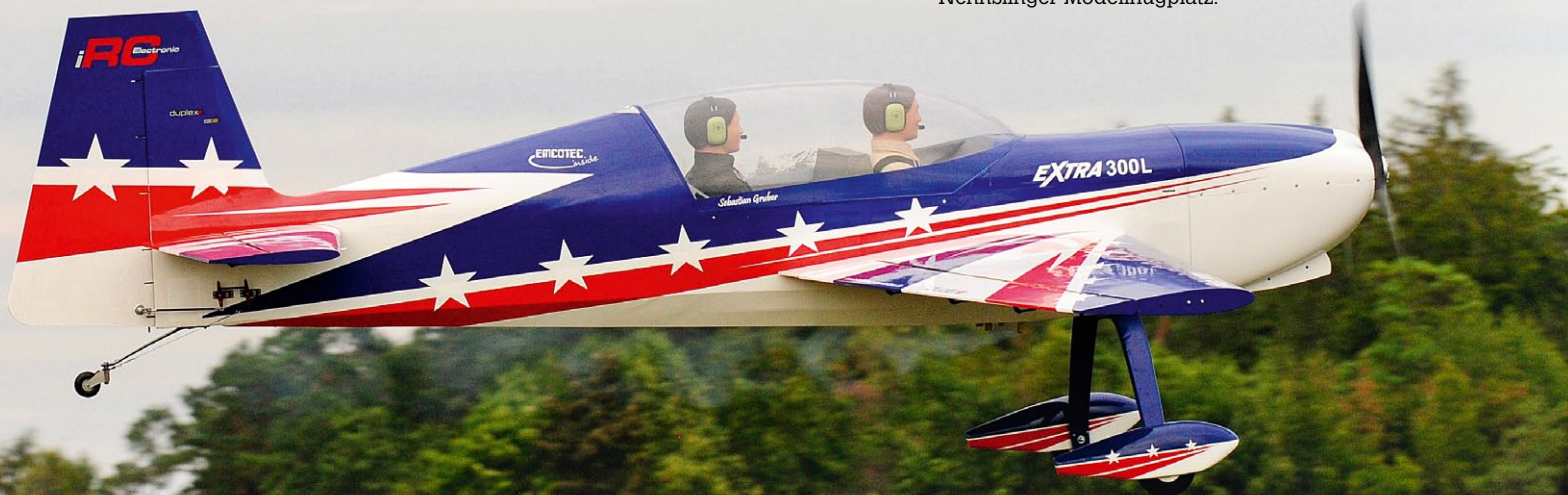
Seitenruder und Spornrad sind gemeinsam mit vier Spektrum HV-Servos der 40-Kilogrammklasse angelegt
