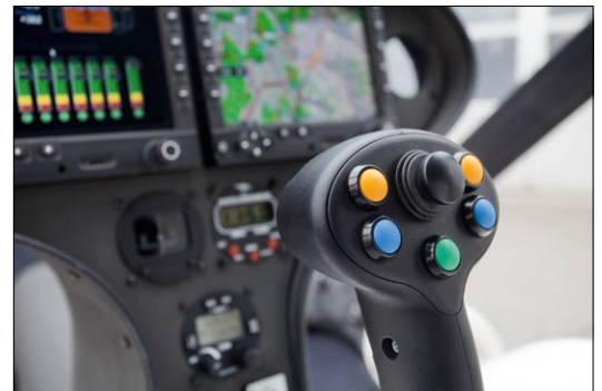
Geflogen wird der VC200 mittels Joystick. Lässt man diesen los, hält das System automatisch Position und Höhe
