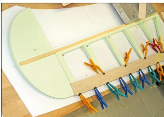
Der Randbogen ist verklebt und wird durch die Verlängerung der Holmleiste zusätzlich stabilisiert
