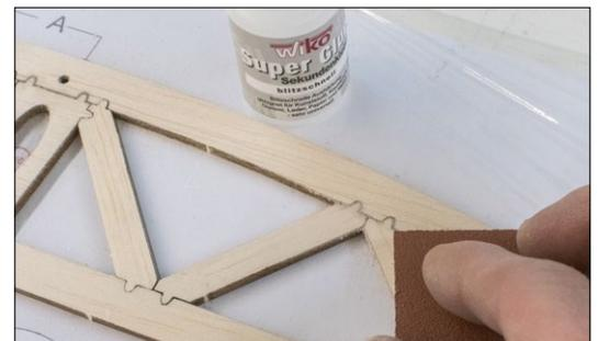
Die Laserschnitte sind technisch bedingt leicht schräg, sodass überall auf einer Seite ein kleiner Spalt bleibt. Trick: dünnflüssigen Sekundenkleber einbringen und dann sogleich mit dem 120er Schleifklotz überschleifen. Der Balsastaub bindet sich und füllt die Fuge
