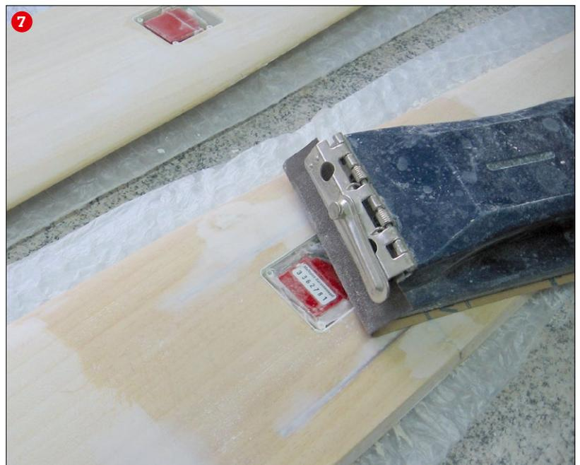
Furnier und Gewebe mit Spachtel egalisiert und wieder fein überschleifen; dazu am besten Schleifpapier mit 120er-Körnung einsetzen. Wir haben mit Zweikomponenten-Polyesterspachtel recht gute Erfahrungen gemacht. Dieser trocknet schnell und lässt sich gut schleifen. Allerdings muss beim Trockenschleifen öfters mal das Schleifpapier gewechselt werden, weil sich die Poren damit zusetzen.
