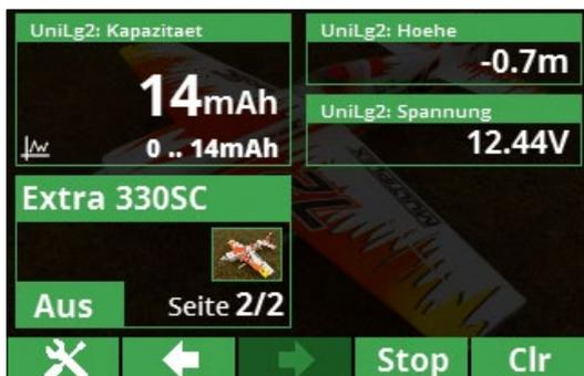
Welche Werte wie groß dargestellt werden, kann ebenfalls frei festgelegt werden. So lässt sich beispielsweise der Wert für die verbrauchte Kapazität größer als die Flughöhe oder die Spannung des Antriebsakkus anzeigen
