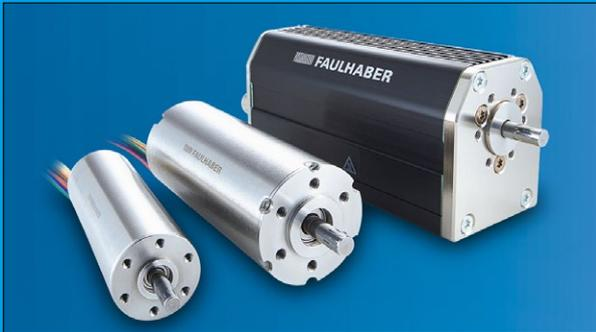
Faulhaber erweitert mit dem bürstenlosen DC-Servomotor 2264...BP4 die Produktfamilie BP4. Neben einem guten Verhältnis von Drehmoment zu Größe und Gewicht bietet der Kleinantrieb integrierte Sensorik und einen breiten Drehzahlbereich. Der vierpolige Motor erreicht ein Drehmoment von 59 Newtonmeter bei nur 140 Gramm Gewicht und einem Durchmesser von 22 Millimeter. Außerdem schafft der 2264...BP4 bis zu 34.500 Umdrehungen in der Minute. [www.faulhaber.com](http://www.faulhaber.com)
