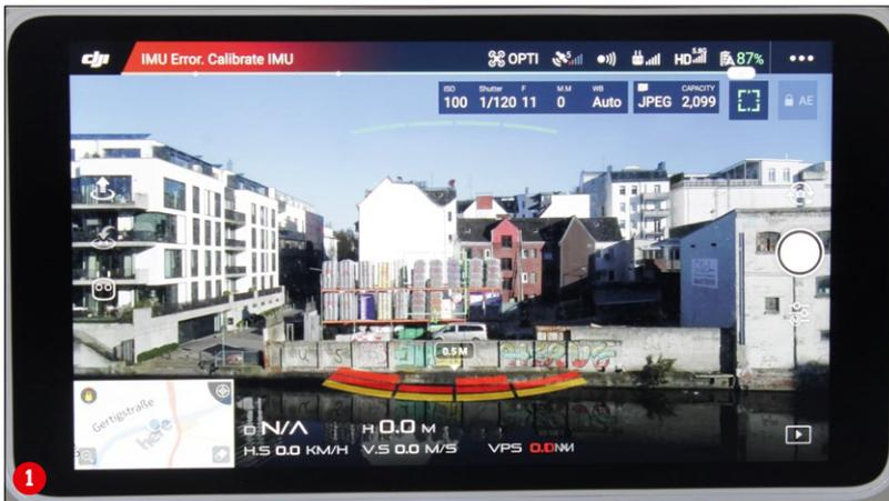
Auf dem Display werden das Live-Bild der Kamera, Warnhinweise, verschiedene Telemetriedaten und die Infos der Hinderniserkennung angezeigt (1). Nach der Landung kann man sich die Aufnahmen direkt auf dem Display ansehen (2). Steht eine W-Lan-Verbindung zur Verfügung, können die Clips direkt hochgeladen und in sozialen Netzwerken geteilt werden (3)
