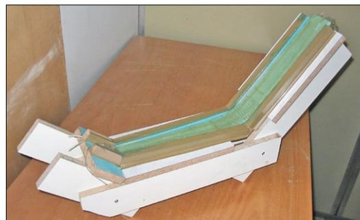
Für die Fahrwerksbügel wurde eine Negativform aus Sperrholzplatten gefräst. Hier zu sehen eine provisorische Form mit geraden Fahrwerksschenkel. Airex 75 mit 10 Millimeter Stärke dient als Stützstoff. Der erste Versuch erfolgte mit nur einer Lage 80er-Glasgewebe und Rovings. Der Bruch erfolgte leider schon bei 150 Newton Last
