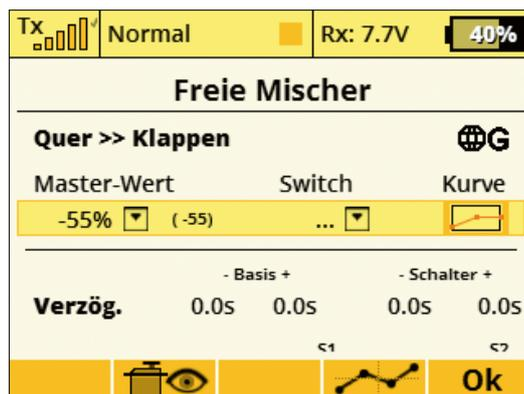
Das „G“ sagt aus, dass die Mischer global und nicht flugphasenspezifisch wirken. Hier erfolgt die Zumischung der Querruderkfunktion auf die Wölbklappen
