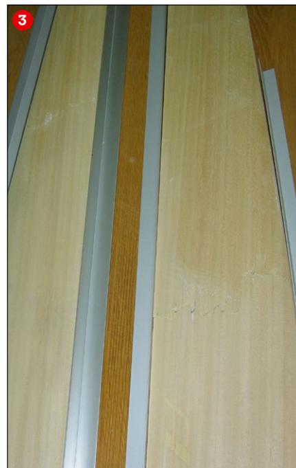
In dieser Helling werden die Tragflächen im ersten Schritt nur stumpf aneinander geklebt, um sicherzustellen, dass die Geometrie und der Anstellwinkel exakt passen (3)
