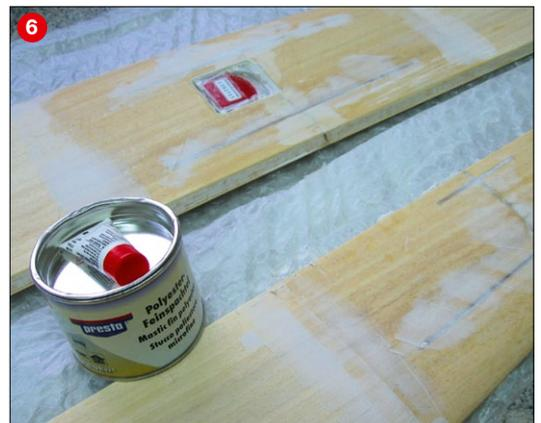
Die meiste Spachtelmenge wird wieder weggeschliffen. Der Vorgang des Spachtelns und Schleifens ist solange zu wiederholen, bis die Tragfläche wieder eine perfekt glatte Oberfläche besitzt (7)
