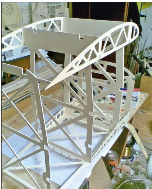
Das wenige, das die CNC-Fräse von 6 m<sup>2</sup> Sperrholz übrig ließ, bildet die Spanten. Deren Größe und die ursprüngliche Idee, im Team zwei Bellanca zu bauen, brachte die Fräse fast an ihre Grenzen. Die Bauteilgröße sowieso.
