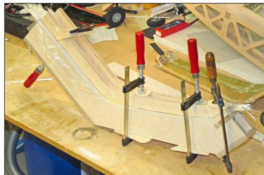
Hier nun die geschlossene (und endgültige) Form nach Einlegen des Stützstoffs und der Gewebelagen. Ohne Anpressdruck würden sich GFK-Gewebe und Stützstoff nicht ausreichend verbinden
