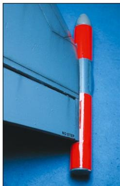
Zur besseren Lageerkennung des Jets wurden die Ausleger der Tragflächen in leuchtrot beklebt
