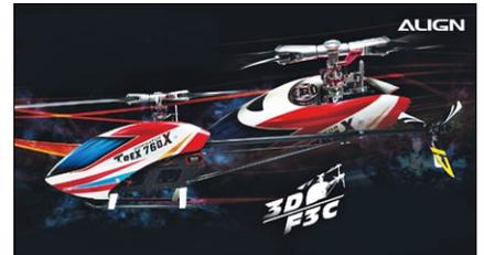
freakware bietet mit dem Align T-REX 760X einen neuen 760er-Heli an, der sowohl für 3D- als auch F3C-Flug geeignet ist. Sein 700EFL-Rotorkopf realisiert einen besonders niedrigen Schwerpunkt, auch der Body in Leichtbauweise und die aerodynamische Haube sorgen für gute Flugeigenschaften. Der T-Rex kommt mit den neuesten DS820M/DS825M-Servos, einem 850MX-Motor mit 490 KV und dem neuen Platinum HV 160A V4 ESC. [www.freakware.de](http://www.freakware.de) <<<<<
