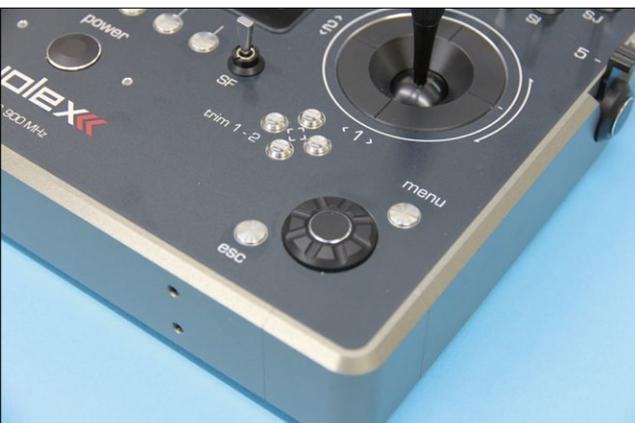
Der 3D-Drehgeber und die beiden Tasten dienen als Eingabelemente bei der Programmierung des Senders
