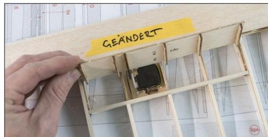
In diese Störklappe wurde das Servo um 180 Grad gedreht eingesetzt, damit beide Rudermaschinen gleichsinnig laufen. Dazu muss im Wesentlichen der Servorahmen gespiegelt zusammengesetzt und der Klappen-Anlenkungsspann an einer neuen Position (hier links statt rechts) angesetzt werden
