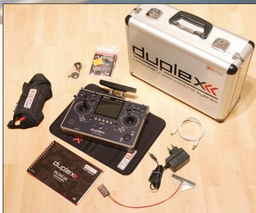
Der Lieferumfang der dc-24 umfasst neben Ladegerät und USB-Kabel auch den Backup-Empfänger und einen stabilen Alukoffer
