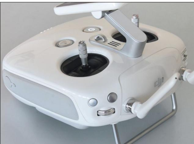
Der Sender verfügt über eine ganze Reihe von Bedienelementen. Über die Rädchen wird zum Beispiel die Gimbal-Cam gesteuert
