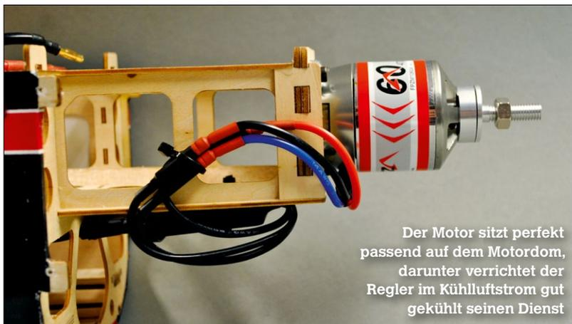
Der Motor sitzt perfekt passend auf dem Motordom, darunter verrichtet der Regler im Kühlluftstrom gut gekühlt seinen Dienst
