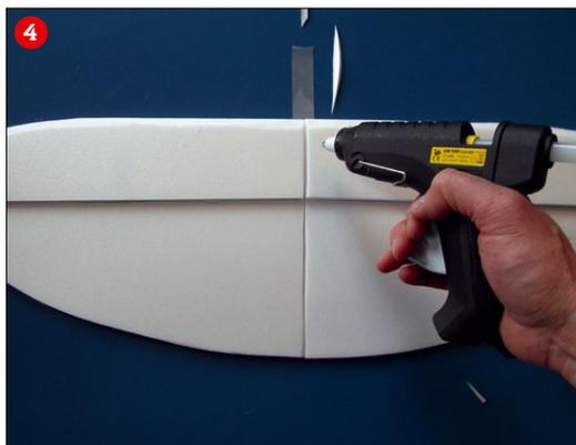
Der Rumpf ist sehr einfach auf Depron aufgebaut (1) In der Jupiter-Familie hat sich die bis zum Heck durchgezogene Kastenbauweise etabliert (2) Das Prinzip der Profilstufe und V-Form ist hier zu erkennen (3) Beim Verkleben ist zur Erreichung der V-Form eine Flächenhälfte an der Spitze zu unterlegen (4)
