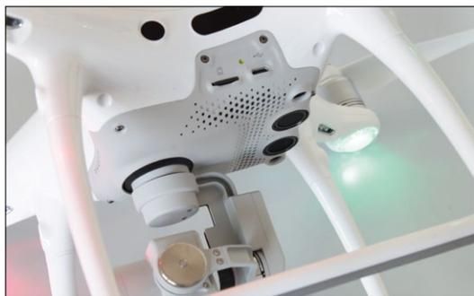
Für sichere Starts und Landungen sowie für stabile Flüge in Bodennähe garantiert die nach unten gerichtete Sensorik. Dazu gehören auch zwei Ultraschallsensoren
