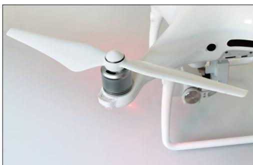
Die Propeller des Phantom lassen sich in wenigen Sekunden montieren und wieder abnehmen – ein Schnellwechselsystem macht es möglich
