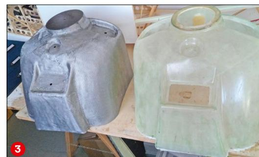
Aus 50er-Styroporplatten entstanden die 3D-formgefräste Segmente des Positivmodells für die GFK-Haube (1). Das zusammengesetzte Urmodell sollte ein Positiv bleiben. Die benötigte Anzahl an Hauben erlaubt ein Laminieren auf der Außenseite, auch wenn dann mehr Spachtel-Arbeiten anfallen (2). Der Styrokern erhielt zunächst einen Überzug aus Glasgewebe und wurde nach dem Schleifen mit Bohnerwachs behandelt, um darauf die 300 g leichte GFK-Haube aus drei Lagen 80er-Glasgewebe zu laminieren (3)
