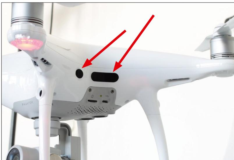
Hier zu sehen, das seitliche Infrarotsystem, das Teil der umfangreichen Hinderniserkennung des Phantom ist. Darunter der Micro-SD-Karten-Slot sowie ein Micro-USB-Port
