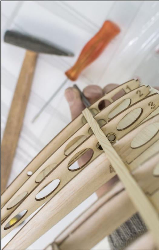
Laut Anleitung wird der Steckungsstahl mit einem davorgeklebten Stück Holz am Durchrutschen gehindert. Eine Alternative: die Messingröhrchen außen mit kleinen Kerben beschlagen. Aufpassen: Beim Einkleben der Rohre sollte man den Flügel an den Rumpf stecken, weil schräg verklebte Rohre dort zwangsläufig einen Spalt in der Passung erzeugen
