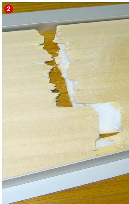
Nach dem Entfernen der Folie werden die Tragflächenstücke mit Hilfe von Aluwinkeln aneinandergesetzt (2)
