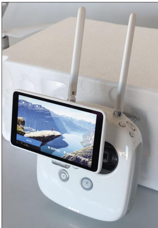
Der Sender des Phantom 4 Pro Plus ist mit einem klappbaren 5,5-Zoll-Display versehen, das sich auch bei Sonnenlicht hervorragend ablesen lässt
