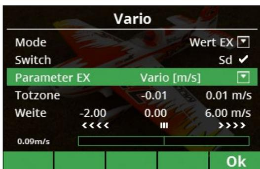
Für das Variometer gibt es ein separates Menü, mit dessen Hilfe eine Nullschieberausblendung möglich wird oder aber die Empfindlichkeit des Variosignals eingestellt werden kann
