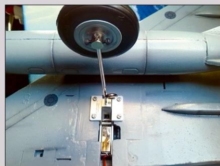
Für den beschriebenen Fahrwerksumbau werden erstens die Plastikaufnahmen gegen Sperrholzaufnahmen ersetzt, die dann mit passender Revell-Acrylfarbe überstrichen werden. Zweitens sind statt der original Einziehfahrwerke jetzt solche des Typs EFLG330 von Horizon Hobby im Einsatz
