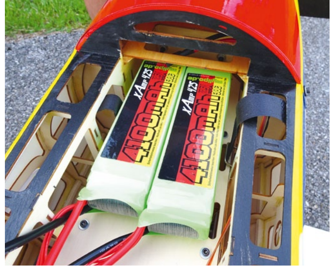
Die voluminöse Kabinenhaube gewährleistet sehr guten Zugang ins Rumpffinnere, sodass der Akkuwechsel zum Kinderspiel wird
