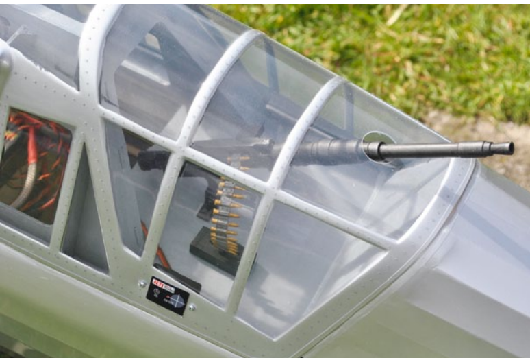
Mit einem Zentrierbohrer ließ sich sauber das Loch für das nachträglich platzierte MG erstellen
