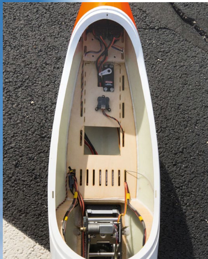
Ab Werk ist ein hochwertiges Voll-Carbon-Einziehfahrwerk installiert
