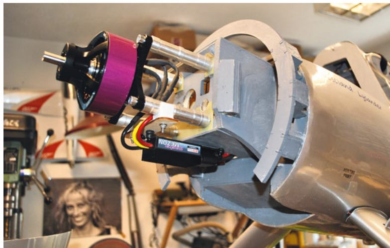
Der Q 80 8M V2 von Hacker passt in puncto Leistung optimal zur Lysander. Der Regler Master Mezon ist mit maximal 135 Ampere Belastbarkeit für alle Spitzen gerüstet
