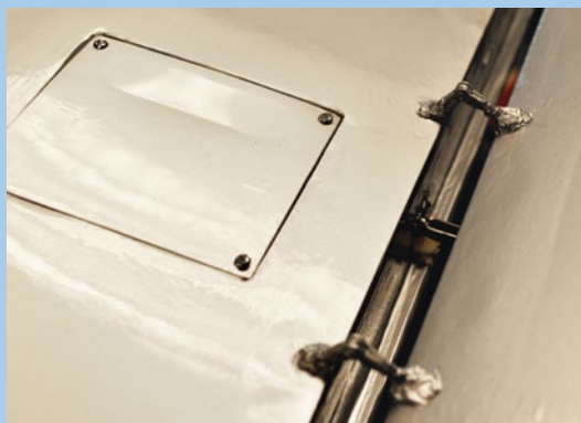
Nicht nur optisch, sondern auch funktionell ist die alternative Befestigung der Landeklappen mit exzentrischen Scharnieren und innenliegender Anlenkung besser
