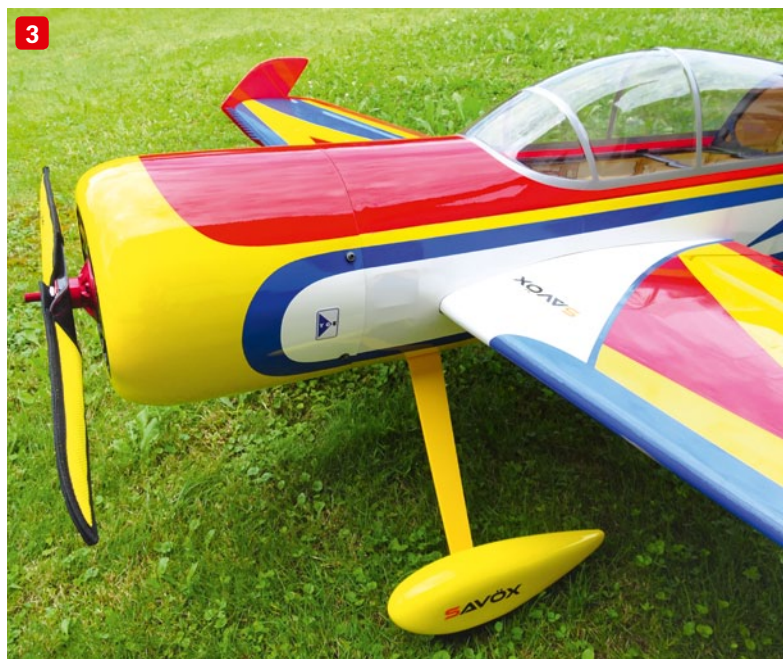
Die Gabriel-Servohebel der Länge 30 beziehungsweise 92 Millimeter auf Seite gestatten extreme 3D-Ausschläge (1). Das Seitenruder ist über eine Seilanlenkung angesteuert, für deren Einbau ab Werk sogar bis zu den Schlitzen in der Rumpfwand alles perfekt vorbereitet ist (2). Die Motorhaube bietet viel Platz für Motor und Regler. Im Bedarfsfall können zusätzliche Öffnungen ausgeschnitten werden, um einen optimalen Kühlluftstrom für die Antriebselektronik zu generieren (3)
