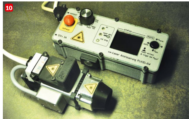
Abbildung 10: Der mit Sensoren und Fokusring erweiterte 6W-cw-Laserkopf von Opt-Lasers und das Steuergerät Marke Eigenbau auf Arduino-Basis im 3D-Druck-Gehäuse
