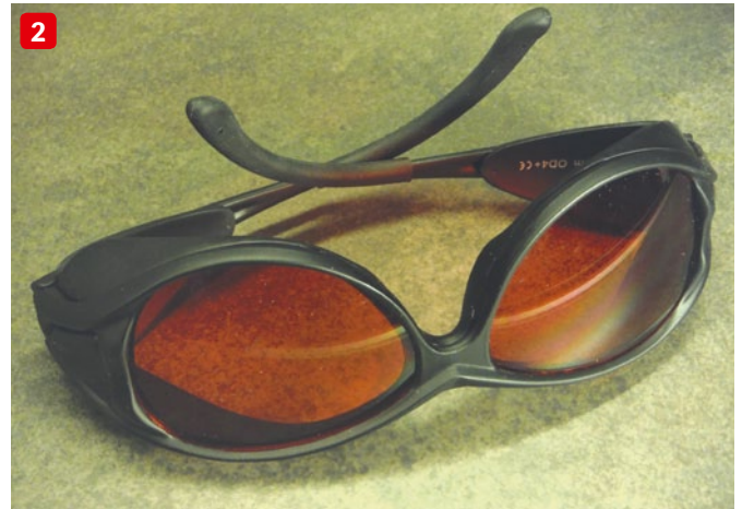
Abbildung 2: Eine CE-zertifizierte Laserbrille für den Bereich von 200 bis 500 Nanometer (nm) mit einer optischen Dichte von 4
