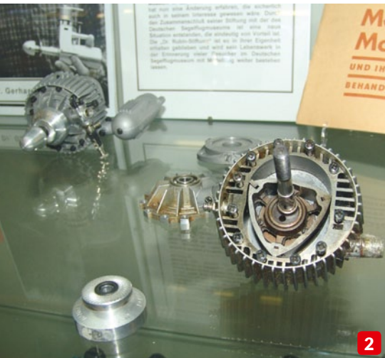
Röhrenempfänger mussten früher vibrationsgedämpft an Federn im Modell aufgehängt werden. Der „Antrieb“ der Tip-Tip Rudermaschinen erfolgte durch einen aufgedrehten Gummistrang im Leitwerksträger (1). Das Segelflugmuseum zeigt eine beachtenswerte Zahl von Verbrennungsmotoren, hier zum Beispiel den ersten Wankelmotor von OS/Graupner (2). Das Segelflugmuseum mit Modellflug auf der Wasserkuppe präsentiert zahlreiche Segelflugzeuge, die Geschichte geschrieben haben (3)
