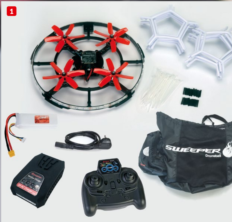
Das Graupner-Set zum Sweeper enthält alles, um erfolgreich an Droneball teilzunehmen. (1) Geschützt durch den Rahmen sind die Sechsstabprops und der LED-Ring. (2) Droneball kann jeder spielen. Die Regeln sind einfach und der Spaßfaktor ist riesig (3)
