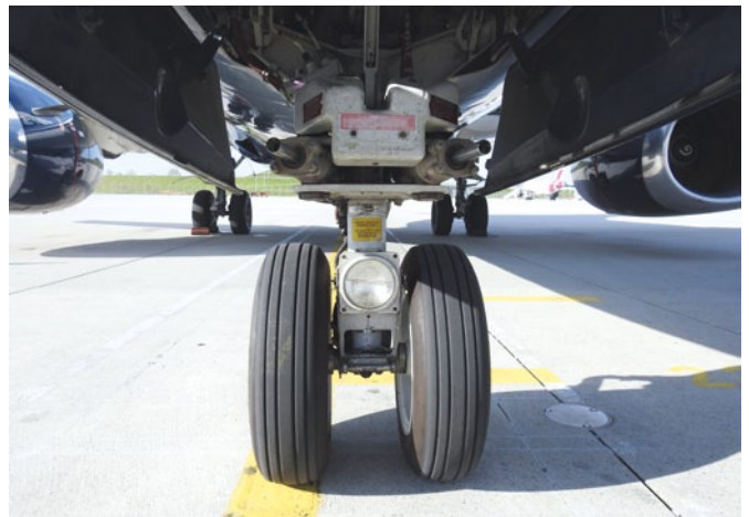
Auch das nach vorn in den Rumpf einfahrende Bugfahrwerk ist mit Zwillingsreifen ausgerüstet
