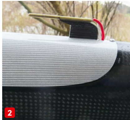
V-förmig herausgeführt sind die Antennen des Satelliten in der Rumpfserviceklappe. Die Antennen des zweiten Satelliten sind in der 2,4-GHz-freundlichen GFK-Haube „unter Putz“ verlegt (1). Das Pitotrohr auf der Kabinenhaube ist wichtiger als ein Vario. Mit 120 bis 200 Stundenkilometer von einem Aufwindfeld zum anderen zu zischen, ist Thermikfliegen der anderen Art (2)
