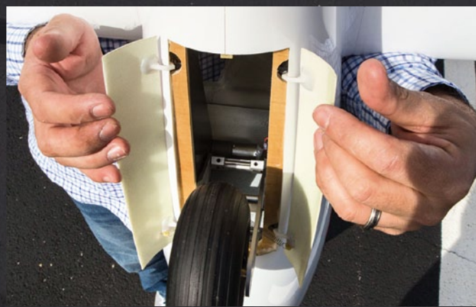
Ab Werk ist ein hochwertiges Voll-Carbon-Einziehfahrwerk installiert
