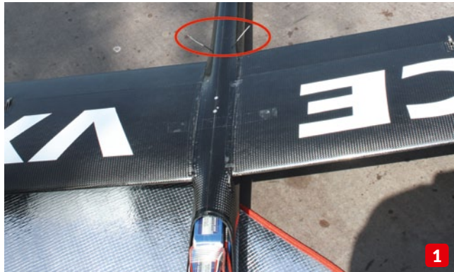
Steife Seitenrudderanlenkung: 6-mm-Carbonrohr, Buchendübel, geknickte 3-mm-Schubstange und ein 4-mm-Bowdenzugrohr, befestigt am inneren Rumpfsseitenrudderübergang
