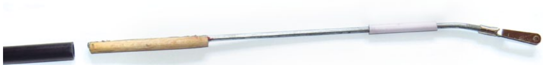
Steife Seitenrudderanlenkung: 6-mm-Carbonrohr, Buchendübel, geknickte 3-mm-Schubstange und ein 4-mm-Bowdenzugrohr, befestigt am inneren Rumpfsseitenrudderübergang
