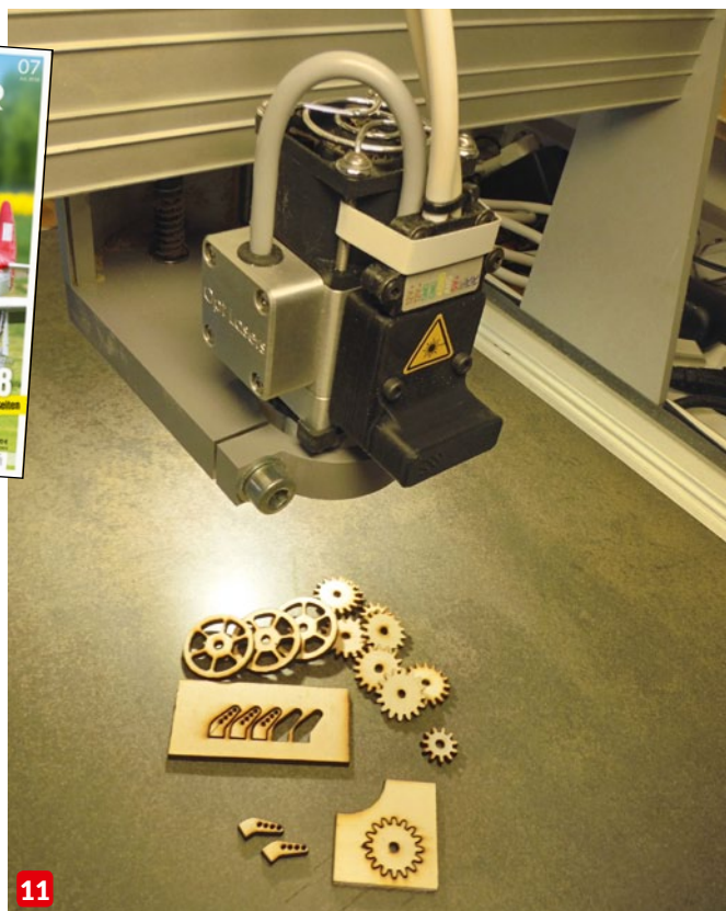
Abbildung 11: Mit Laser-Technik lassen sich nicht nur Zubehör-Teile herstellen, sondern ganze Modellteile-Sätze produzieren
