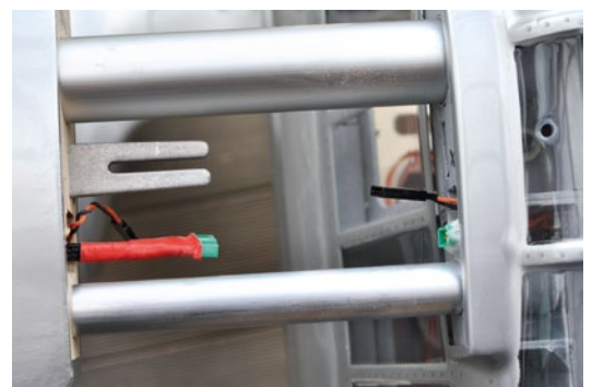
Die Zunge aus der Fläche lässt sich über die Cockpitkanzel mit einer Schraube sicher fixieren
