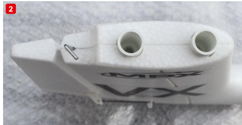
Die Tragflächensteckung und die Wurzelrippe aus Kunststoff versprechen hohe Festigkeit. Trotzdem können sich die Flächen bei harten Landungen vom Rumpf leicht lösen, um Schäden zu vermeiden (1). Die Höhenruderaufnahme ist gut und robust gelöst. Zum Transport kann das komplette Leitwerk abgenommen werden (2)
