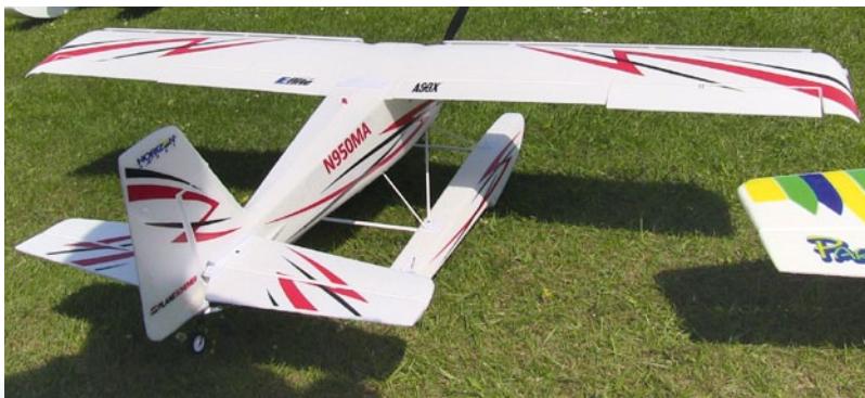
Die Timber von E-flite aus robustem Z-Schaum zeigt mit Schwimmern, dank der Spaltklappen und Vorflügel gute Wasserstarteigenschaften
