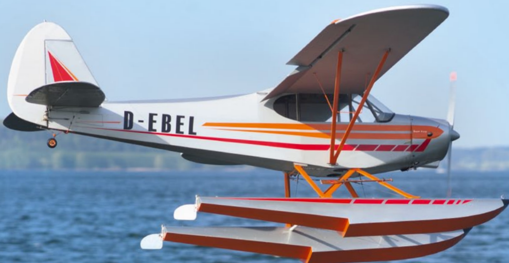
Die Timber von E-flite aus robustem Z-Schaum zeigt mit Schwimmern, dank der Spaltklappen und Vorflügel gute Wasserstarteigenschaften
