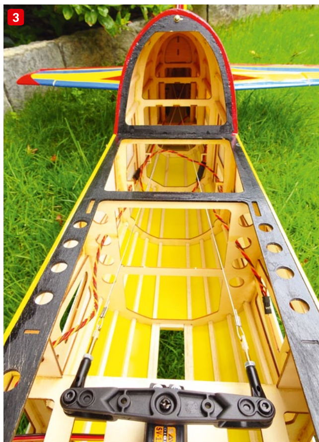
Der CFK-Flächenverbinder bietet stabilen Halt bei gleichzeitig geringem Gewicht (1). Der YGE-Regler vom Typ 90 HVT glänzt durch eine feinfühliges Gasannahme und unbegrenzte Teillastfestigkeit. Besonders praktisch ist die integrierte Anti-Blitz-Funktion, die das durchdachte Gesamtpaket abrundet (2). Die Gabriel-Servohebel vereinen optimale Stabilität und geringstmögliches Gewicht (3)
