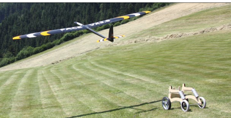
Sicherer Start: Aufgebleit mit sechs Ballaststangen im Flügel (920 Gramm) geht's beim Modellflughotel „Karawankenblick“ in Kärnten in die Luft. Rund 7.300 Gramm Fluggewicht kann man kaum werfen, da ist ein Startwagen von Frank Teichner die richtige Wahl
