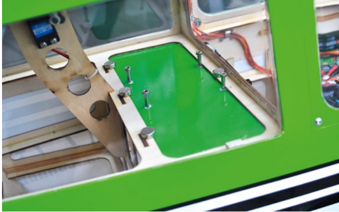
Die Winde wurde Schwerpunktneutral und nahe einer bereits zuvor eingebauten klassischen Winde platziert
