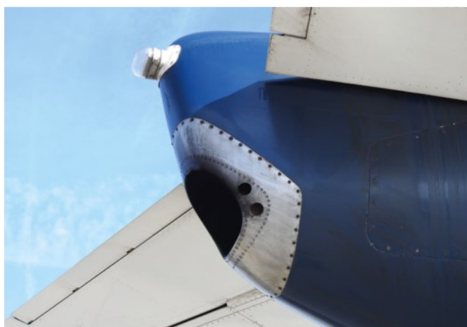
Am Heck der Auslass für die APU-Turbine, also dem Hilfstriebwerk
