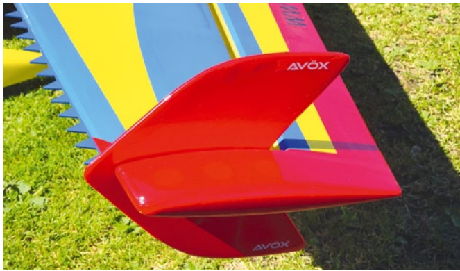
Die beiden Side-Force-Generatoren sind mit drei Schrauben flexibel abnehmbar angebracht, sodass sie zum Transport in den Flächenschutztaschen demontiert werden können
