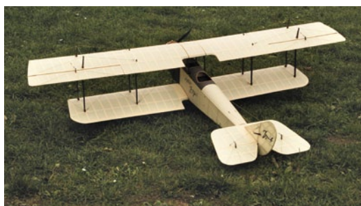
Abbildung 5: Die Curtiss-Jenny war das erste reale Modell, das alleine mit FLZ_Vortex ausgelegt wurde – das Flugverhalten war vom ersten Start an vorbildlich
