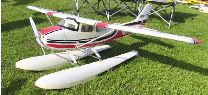
Mit 1.800 Millimeter Spannweite ist die Cessna ein imposantes Modell aus Hartschaum
