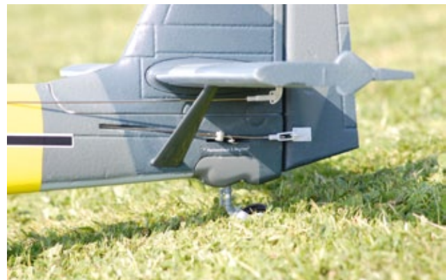
Der Hecksporn ist lenkbar
