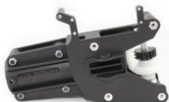
Heckantriebsgehäuse im Detail. Das Zahnflankenspiel der Kegelräder kann mit Passscheiben eingestellt werden
