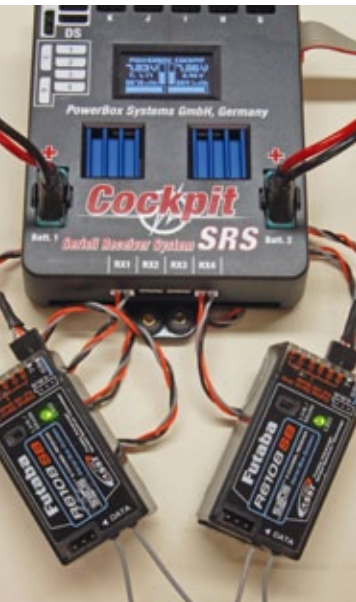
Maximale Sicherheit mit zwei Futaba R6108SB Empfängern
