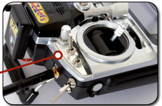
Acht Schalter, zwei Schieber- und zwei Drehgeber stehen zur Verfügung
