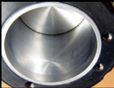
Die kaum wahrnehmbaren Kratzer am Kolbenboden sind der ursprünglich fehlenden Luftfilterung geschuldet
