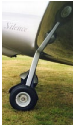
Das GFK-Hauptfahrwerk des zweiten Prototyps
