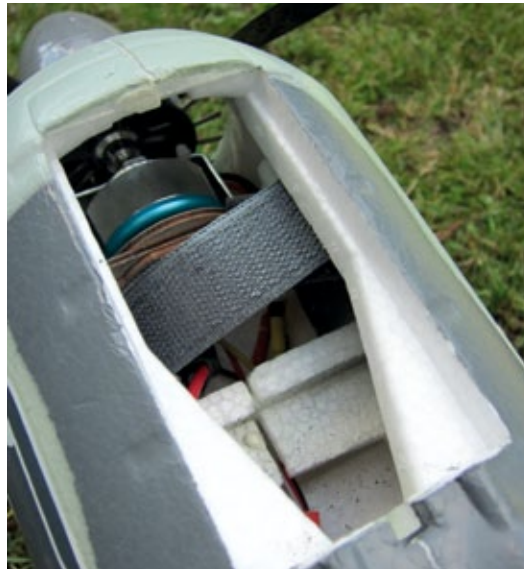
Unter einer Klappe der Motorverkleidung befinden sich der Motor, Regler und das Akkufach
