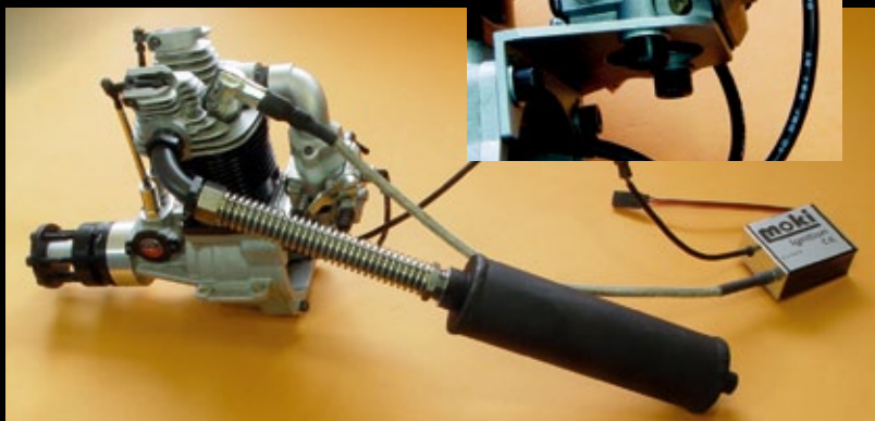
Fertig aufgebaut, komplett mit Krümmer, Wellrohr, Schalldämpfer und Zündanlage
