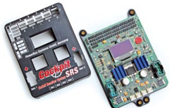
Dank SMD-Technik ist alles auf einer Platine unterzubringen
