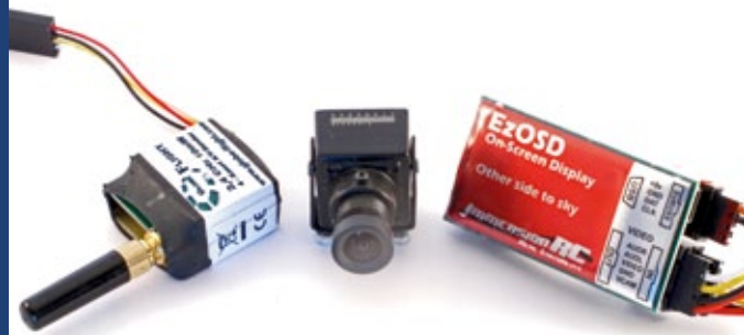
Der dritte Baustein macht unsere Anlage komplett (weitere können jedoch hinzukommen). Das OSD, das über GPS Flugdaten wie Höhe, Geschwindigkeit, Entfernung sowie Position zum Piloten ermittelt und in das Flugbild einblendet
