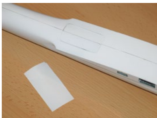
Die Öffnung für die Seiten- und Höhenruderservos der Elektroversion wird bei einem Segler nicht benötigt und bleibt verschlossen
