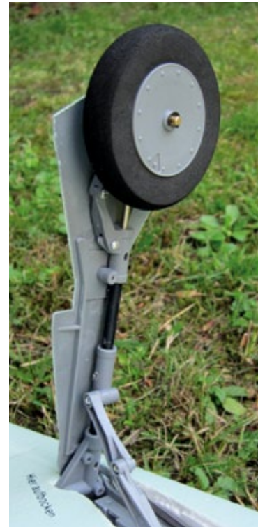
Das gefederte Einziehfahrwerk macht einen vorbildgetreuen Eindruck
