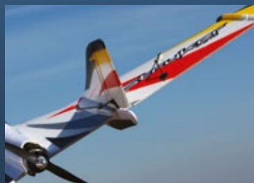
NEU Zwillings-Ruder mit unabhängig steuerbaren Servos
