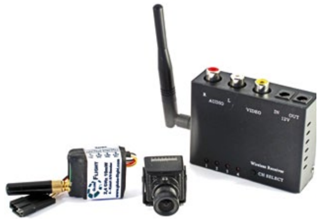
Die FPV-Grundausrüstung, nur Kamera, Sender (beide zusammen etwa 60 Gramm) und Empfänger. Die Kamera im Bild ist älter, es gibt inzwischen bessere. Siehe auch Kasten „FPV-Kameras“
