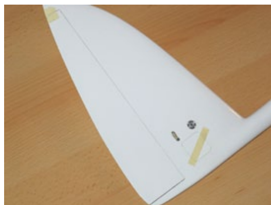
Die Anlenkung für das Pendelhöhenruder ist bereits vom Hersteller exakt und spielfrei eingebaut
