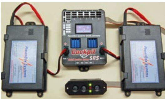
Cockpit SRS mit zwei 2s 2.800er-Stromquellen
