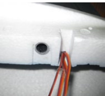
Die Steckrohraufnahme ist fest in der Fläche eingelassen
