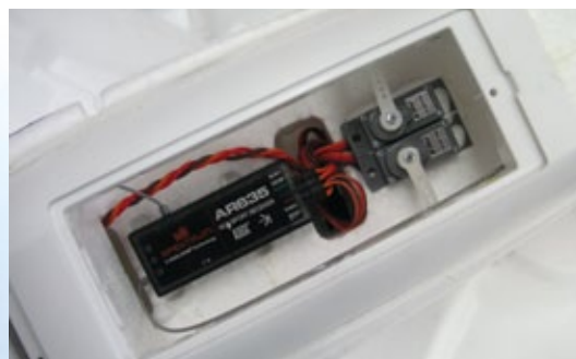
Die elektronische Fluglagestabilisierung AS3X steckt im Empfänger
