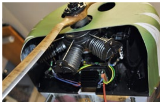
Der Einbau der Soundanlage erfolgte direkt unter der Cowling
