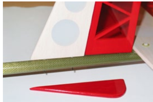
Seitenleitwerk und Sporn wurden mit Kohlefaserstiften durch das Rumpfrohr verzapft
