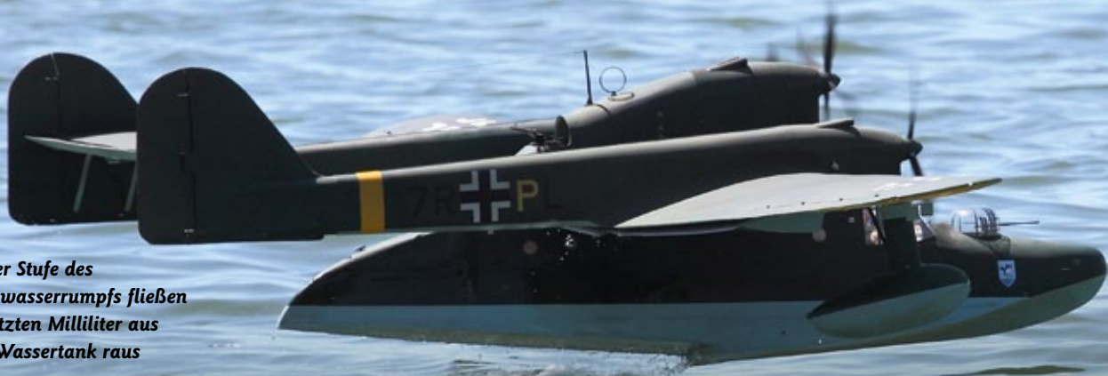
Die BV-138 ist konventionell aus Holz aufgebaut. Die schwarzen Stellen sind Verstärkungen aus Kohlefaserschnipseln
