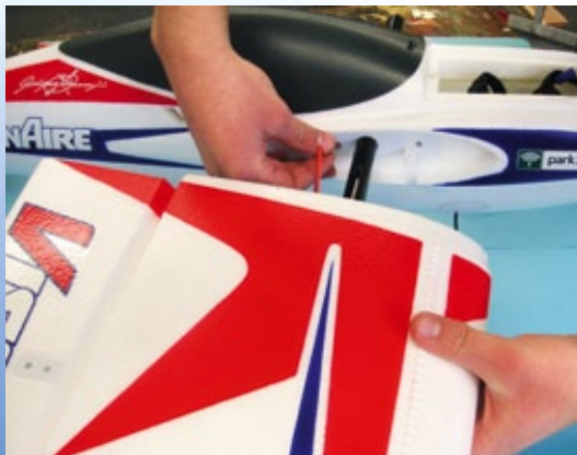
Ein stabiles Steckungsrohr sorgt für den erforderlichen Halt der Fläche
