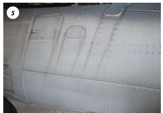
Die Wasserablaufspuren bei Flugzeugen mit Zweibein-Fahrwerk verlaufen immer schräg nach unten
