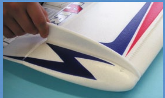
Die Sideforce-Generatoren optimieren das Flugverhalten im Messerflug
