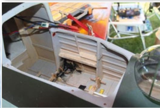
Die BV-138 ist konventionell aus Holz aufgebaut. Die schwarzen Stellen sind Verstärkungen aus Kohlefaserschnipseln
