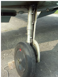
Die Hauptfahrwerksbeine werden nach außen in die Tragflächen eingeklappt
