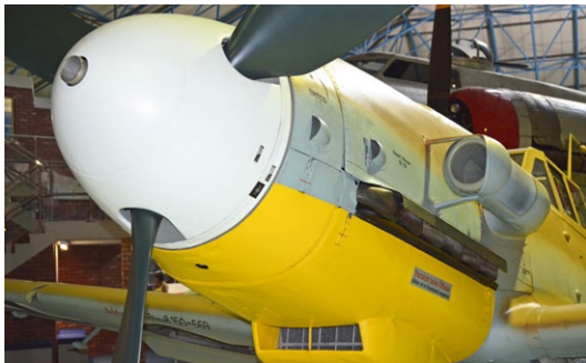
An dieser Bf-109G-2/Trop ist der typische Sandfilter über den Abgasrohren erkennbar
