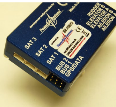
Die seriellen Eingänge des iGyro sowie der Eingang für den GPS-Sensor
