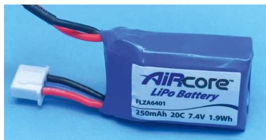
Bei so kleinen Modellen reicht ein zweizelliger 250er-LiPo für bis zu acht Minuten Flugspaß
