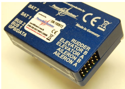
Ist der Ausgang „RUDDER“ und „ELEVATOR-B“ nicht auf S-BUS geschaltet, können hier bis zu fünf PWM-Servos angeschlossen werden
