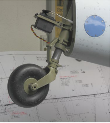
Das Heckfahrwerk: Optisch alles wie beim Original, nur mit Servolenkung
