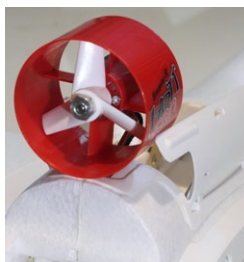
Der Dreiblattrotor setzt über 200 Watt in Schub um
