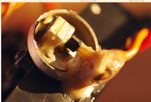
Abbildung 11: Hall-Sensor im inhomogenen Magnetfeld aus Abbildung 8 – wird er gekippt erreicht man ein nahezu lineares Stell-Verhalten
