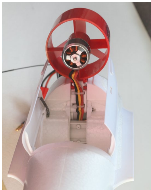
Der Dreiblattrotor setzt über 200 Watt in Schub um
