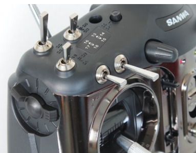
Mit zehn Dreiwegeschaltern ist die SD-10GS reich ausgestattet
