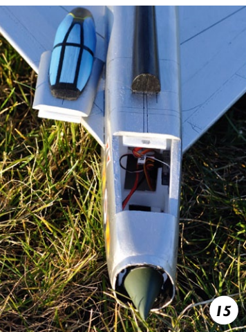
Ein kleiner Magnet hält den Cockpitdeckel des Akkufachs sicher am Platz
