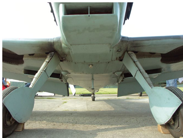
Das schmale Hauptfahrwerk der Bf-109 sorgte für so manchen Start- oder Landeunfall
