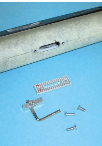
V-Leitwerksanlenkung mit nach oben zeigenden Ruderhebeln. Man sieht deutlich die kurzen Abstände des Anlenkungs-gestänges zum Drehpunkt des Ruders
