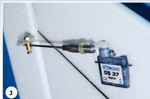
Anlenkung des Querruders an der Unterseite der Tragfläche. Die DS 37-Servos von Staufenbiel sind sehr leicht, kräftig und spielfrei
