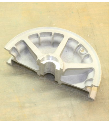
Das Gussteil für das Hauptrad ist auf Qualität geprüft
