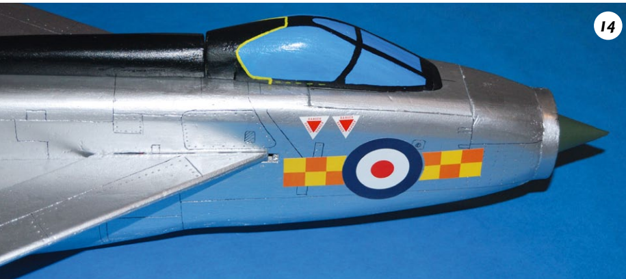
Mit einem CD-Marker wurden noch Wartungsklappen und Nieten aufgebracht. Die Decals sind aus selbstklebender Laserdrucker-Folie erstellt
