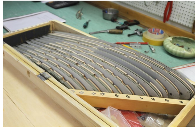
Der selbst gefertigte Rippensatz mit dem Profil Bf-109
