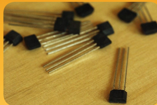
Abbildung 7: Ein handelsüblicher, kleiner und kostengünstiger Hall-Sensor mit internem Verstärker des Typs SS495A – von Conrad Electronic
