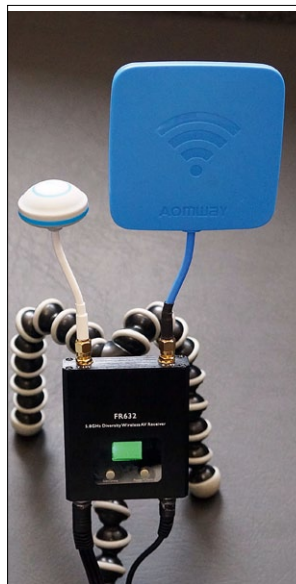
5,8-Gigahertz-Diversity-Empfänger mit einer omnidirektionalen und einer gerichteten CP-Antenne
