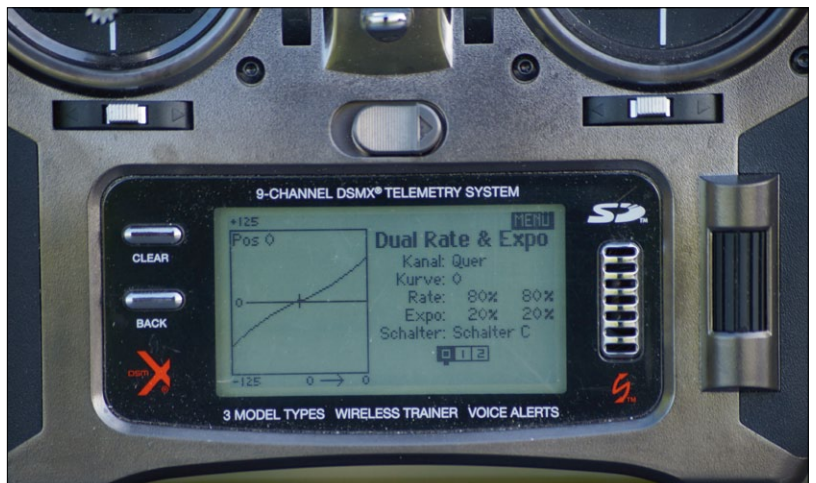
Über die Einstellungen von Dual-Rate und Expo kann man die Ruderausschlaggrößen und das Ansprechverhalten der Ruder an die persönlichen Vorlieben anpassen
