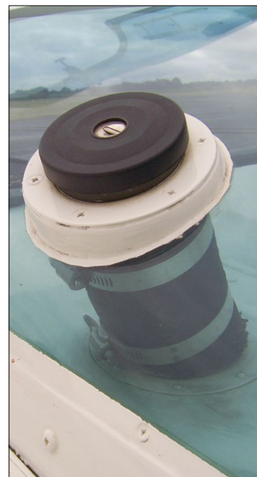
Einfüllstutzen für die 100 Liter Kraftstoff bei der C-Version
