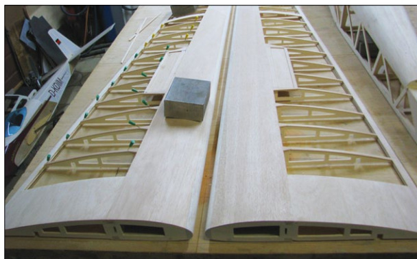
Fertig gestellte Rippenfläche mit Beplankungsflächen und Rippen-Aufleimer für eine bessere Bespannung
