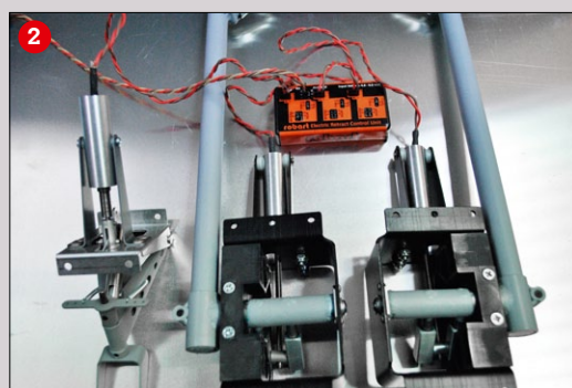
Damit man die Höhenleitwerke abnehmen kann, wird in die Alurohr-Steckung je eine Mutter mittels einer Holzzunge eingeklebt, um diese zum Fliegen zu verschrauben (1). Das nur für die FW-190 passende Robert Einziehfahrwerk inklusive Hecksporn. Es funktioniert einwandfrei. Klasse ist die Elektronik (2). Hier gut zu sehen die Fahrwerksaufnahme. Hier passen keine herkömmlichen Einziehfahrwerke (3)
