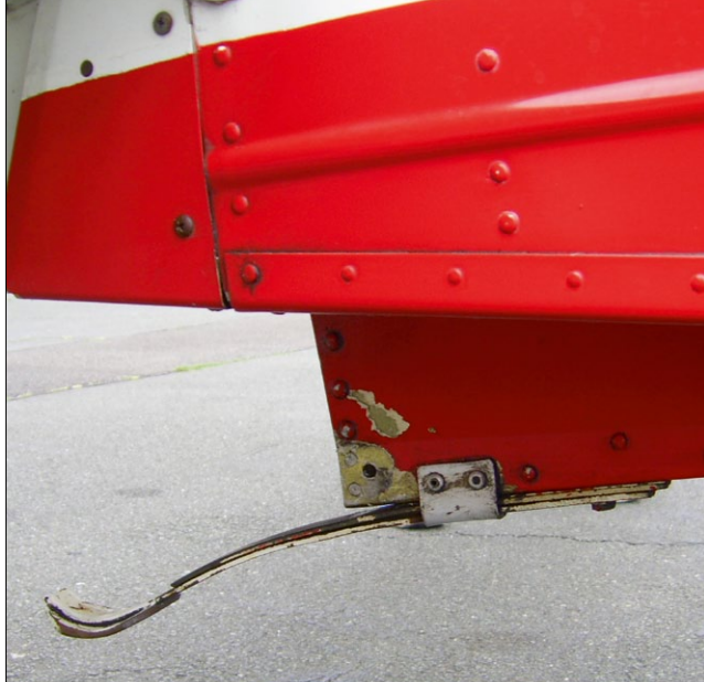
Ein Hecksporn schützt das Rumpheck vor heftigen Bodenberührungen
