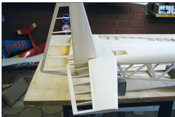
Demontierbares Höhenleitwerk mit in Hohlkehle gelagertem Ruder sowie festem Seitenleitwerk
