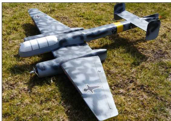
Aus nur neun Styro-Elementen ist die Arado 240 zusammengebaut, was den Bauaufwand stark reduziert
