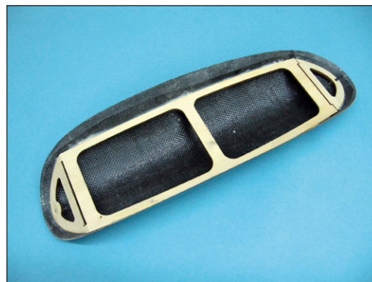
Die Kabinenhaube ist von innen mit einem Sperrholzgerüst verstärkt und behält so auch langfristig oder bei höheren Außentemperaturen ihre Form
