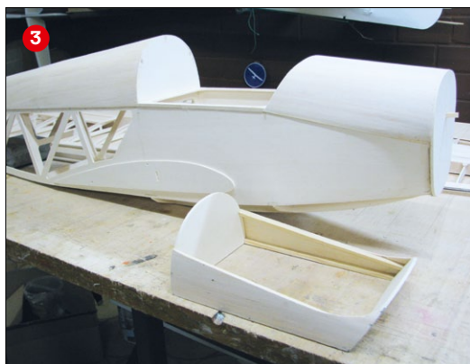
Um die typische Rumpfform erzielen zu können, ist der Bugbereich eingeschnürt verleimt (1). Aus gefrästen Pappelsperrholz-Spanten und Kiefernholzstringern entsteht das Rumpfgerüst (2). Da die Kabinenhaube später klappbar ist, wird hierfür ein separates Bauteil erstellt (3).
