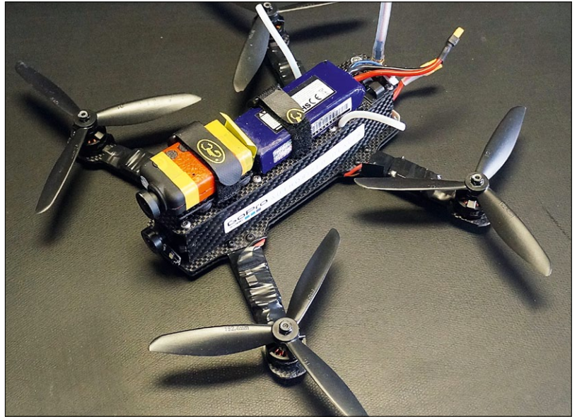
250er-Race-Copter komplett mit HD Mobius Kamera. Trotz unzähliger Abstürze ist dieser dank der robusten Bauweise noch gut in Schuss
