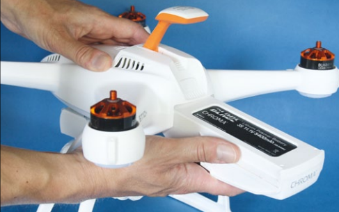
Sicheren Stromkontakt und Halt bekommt der Akku nach dem Einschieben in den Schacht
