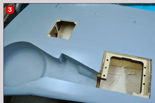
Damit man die Höhenleitwerke abnehmen kann, wird in die Alurohr-Steckung je eine Mutter mittels einer Holzzunge eingeklebt, um diese zum Fliegen zu verschrauben (1). Das nur für die FW-190 passende Robert Einziehfahrwerk inklusive Hecksporn. Es funktioniert einwandfrei. Klasse ist die Elektronik (2). Hier gut zu sehen die Fahrwerksaufnahme. Hier passen keine herkömmlichen Einziehfahrwerke (3)
