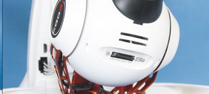
SD-Mikroarten der Klasse 10 mit Größen von 4 bis 32 Gigabyte sind erforderlich, um Filme in Full-HD (1.920 x 1.080 Pixel) oder Fotos mit 16 Megapixeln zu erstellen
