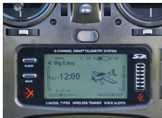
Das Timermenü der Spektrum DX9 schlägt als Grundeinstellung für die Stoppuhr der Motorlaufzeit 5 Minuten vor. Ein guter Grundwert für den Erstflug, der beim Big Easy später auf 12 Minuten angepasst wurde
