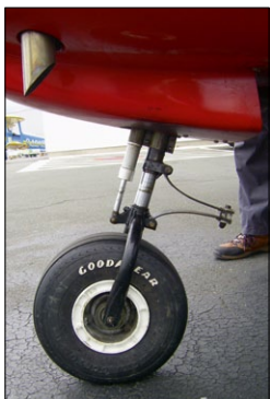
Das lenkbare Bugfahrwerk mit dem Ölstoßdämpfer
