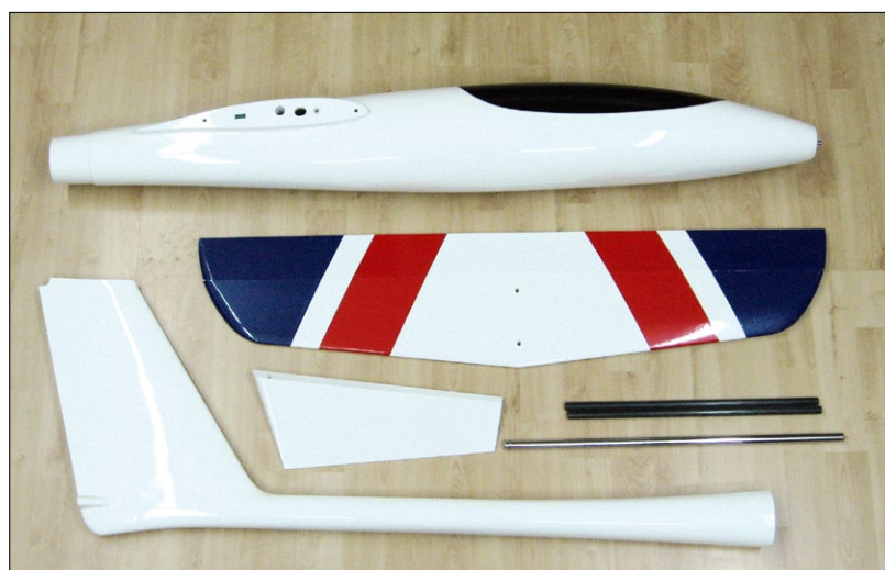
Der Rumpf wird aus Transportgründen zweiteilig geliefert und muss noch zusammengesetzt werden
