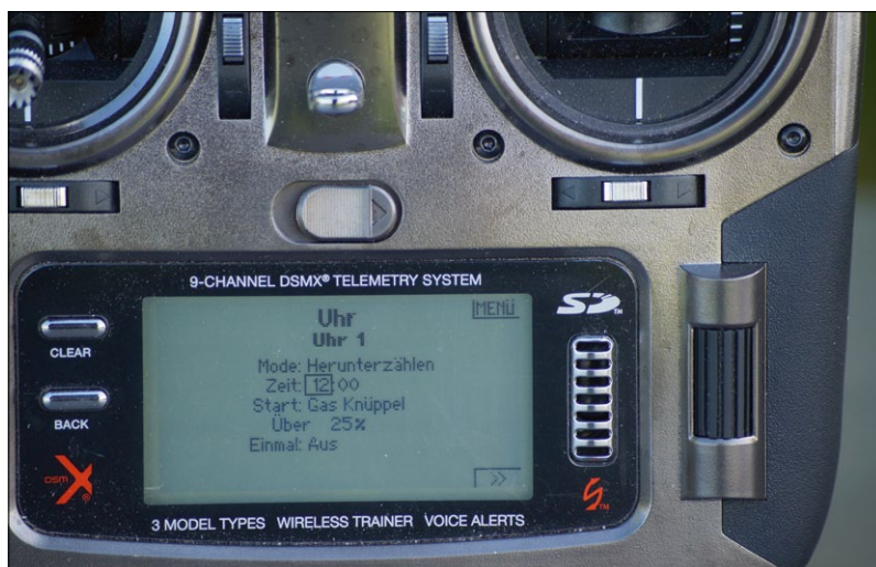
Das Timermenü der Spektrum DX9 schlägt als Grundeinstellung für die Stoppuhr der Motorlaufzeit 5 Minuten vor. Ein guter Grundwert für den Erstflug, der beim Big Easy später auf 12 Minuten angepasst wurde
