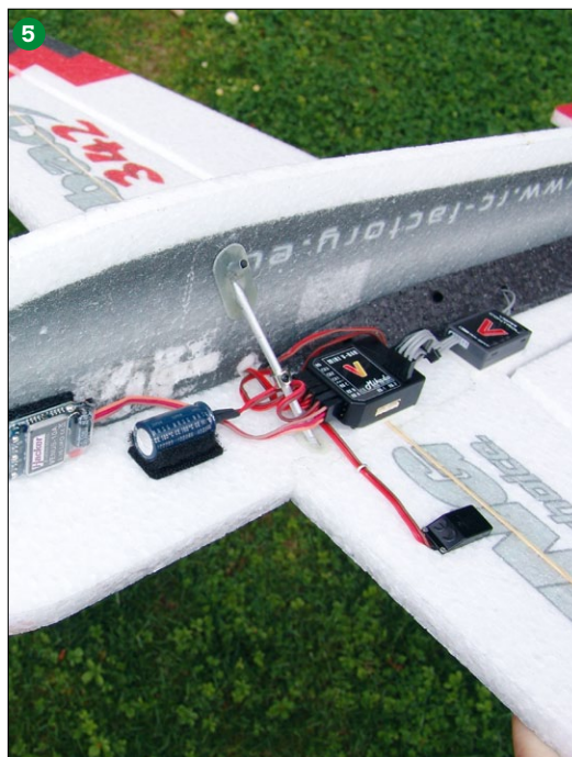
Ohne Fahrgestell wird das Aluminiumröhrchen mit einem kurzen CFK Stab ausgesteift damit es sich nicht verbiegt (5)
