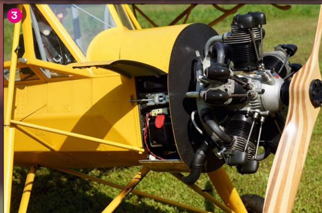
Quasi als Vorgeschmack auf den in Kürze erscheinenden Bau- und Flugbericht ein Foto des Cockpits der MS-505, die sich aktuell noch im Bau befindet (2). Unter der hochgestellten Wartungsklappe ist einer von zwei rechts und links angeordneten Exenter-Verschlüssen zu erkennen, die das gesamte Vorderteil mit allen Einbauten (Motordom, Motor, Zündung, Zündakku, Tank und Gasservo) am Rumpf halten (3). Bereits beim Aufbau der Rippenflügel kommt Freude auf. Alles ist perfekt vorbereitet und durchdacht (4)
