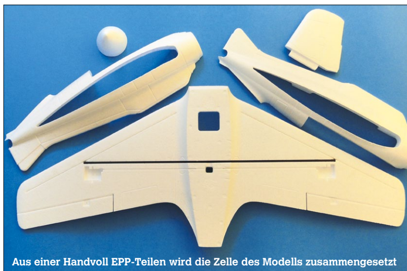
Kohle gibt Sicherheit: Der Flügelholm ist ausreichend dimensioniert
