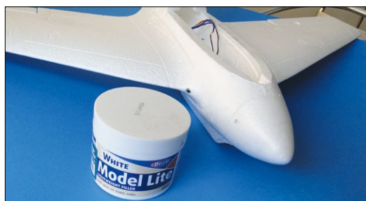
Zum Spachteln eignet sich Leichtspachtel wie „Model Lite“ von Krick sehr gut
