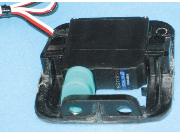
Das Servo sitzt liegend im Rahmen, ein Ruderhorn ist bereits montiert und wird durch das Gegenlager abgefangen
