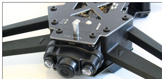
Vorne befindet sich die FPV-Kamera, die von zwei hellen LED flankiert wird
