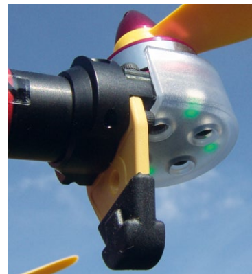
Zum Landen hat der MR25 gummierte Stützen an den Motoren
