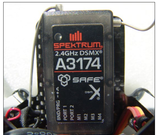
Herzstück des Kopters ist der Spektrum A3174: Empfänger und Flight-Controll in einem Gerät. Es sind sieben Anschlussplätze vorhanden
