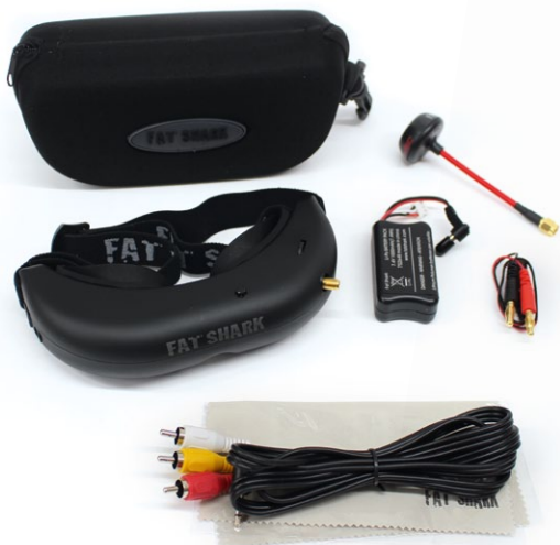
Hier ein EC-Komplettset einer Attitude V2 mit 7-Kanal-Empfangsmodul, 1.000er-1s-LiPo und Spironet-Antenne
