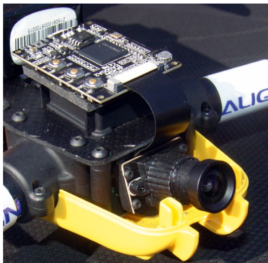
Die HD-Kamera ist neigbar und über ein herausnehmbares Flachbandkabel mit dem Video-Rekorder verbunden
