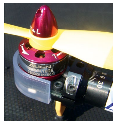
Die Motoren lassen sich im Anstellwinkel beliebig verdrehen (Markierung)
