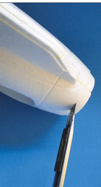
Feinschnitt: Der Überstand am Rumpf wird sorgfältig entfernt
