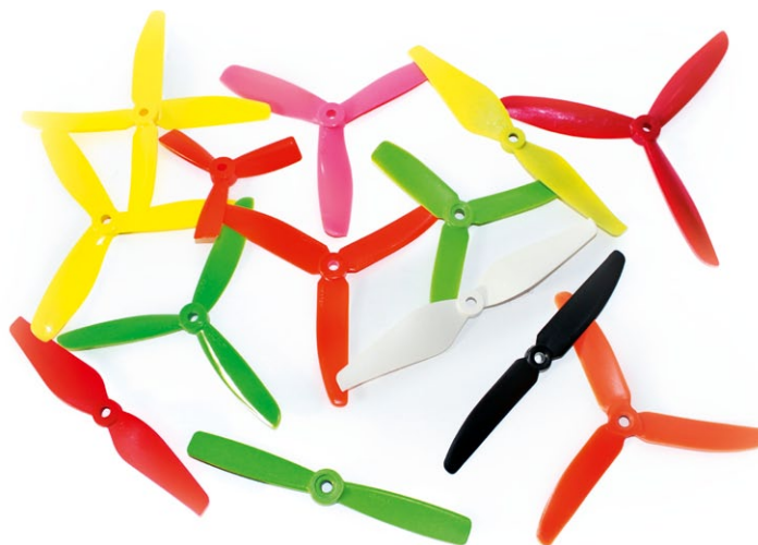
Zwei-, Drei-, Vier-, Sechsstab in 3-, 4-, 5- oder 6-Zoll-Größe, Bullnose, T1 oder C-Prop von DAL, Graupner, Gemfan oder HQ – bei den Props hat man eine riesige Auswahl. Hier muss zum einen der passende Prop zum Kopter/Antriebs-Setup gefunden werden, zum anderen muss man testen, welcher Prop dem Piloten am besten liegt. Momentan werden auf den Racekoptern hauptsächlich 5 Zoll große Drei- oder Vierblatt mit 4s und 2204/2804-Motoren mit 2.300 bis 2.650 kv geflogen
