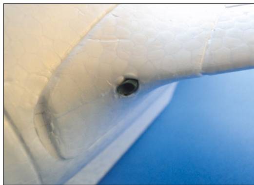
Mit einem Plastikröhrchen kann die Mündung der Bordkanone imitiert werden. Den Spalt am Flügelansatz sollte man noch spachteln
