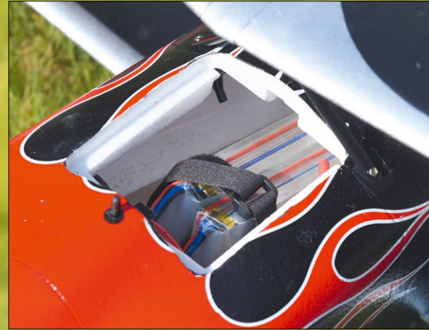
Durch diese große Öffnung vor der Fläche lassen sich die Akku einfach wechseln, während das Modell auf dem Fahrwerk steht
