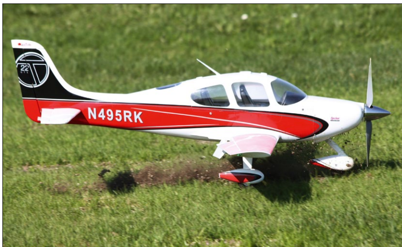
Das Fahrwerk ist stabil, nur für den Propeller nicht hoch genug. Hier wäre eine Umrüstung auf Dreiblatt ideal
