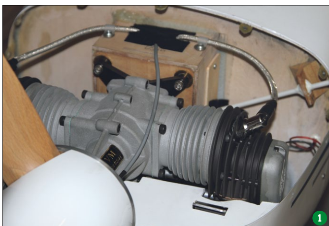
Für den Praxistest wurde das Schleppmodell Symphony OMF 100-160 mit 3.400 Millimeter Spannweite umgerüstet – der Valach-Boxer wurde ausgetauscht (1). An die Stelle des Verbrenners kommt das Kontronik Stirnrad Getriebe (2)
