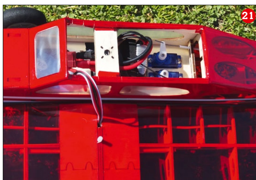
Gekröpfte Rudergestänge aus dünnem Draht, hölzerne Ruderhörner und dünne Ruderhebel sind ein klares Indiz für ein kleines Modell. Die transparente Bespannung mit Oracover-Folie zeigt das filigrane Innenleben des Tragflügels (20)
