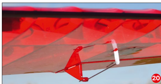
Gekröpfte Rudergestänge aus dünnem Draht, hölzerne Ruderhörner und dünne Ruderhebel sind ein klares Indiz für ein kleines Modell. Die transparente Bespannung mit Oracover-Folie zeigt das filigrane Innenleben des Tragflügels (20)
