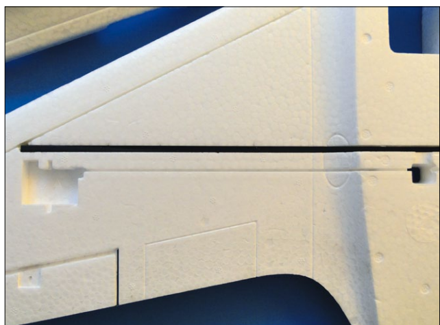
Kohle gibt Sicherheit: Der Flügelholm ist ausreichend dimensioniert
