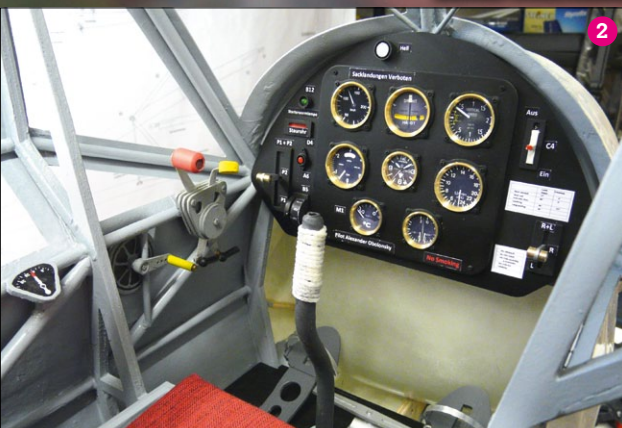
Quasi als Vorgeschmack auf den in Kürze erscheinenden Bau- und Flugbericht ein Foto des Cockpits der MS-505, die sich aktuell noch im Bau befindet (2). Unter der hochgestellten Wartungsklappe ist einer von zwei rechts und links angeordneten Exenter-Verschlüssen zu erkennen, die das gesamte Vorderteil mit allen Einbauten (Motordom, Motor, Zündung, Zündakku, Tank und Gasservo) am Rumpf halten (3). Bereits beim Aufbau der Rippenflügel kommt Freude auf. Alles ist perfekt vorbereitet und durchdacht (4)
