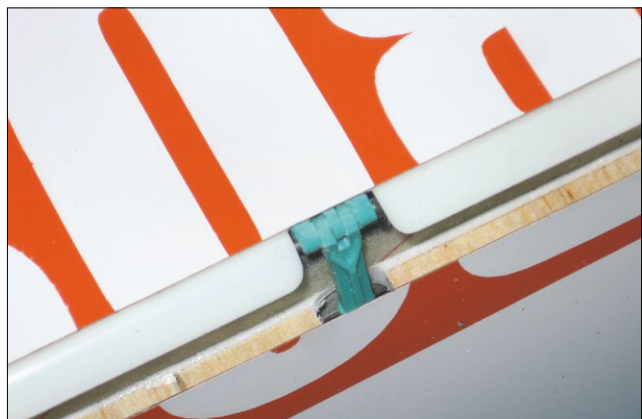
Für die Durchführung des Anlenkungsgestänges ist ein Durchbruch im Hilfsholm notwendig
