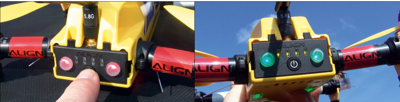
Das Ein- und Ausschalten erfolgt am Akku-Management-Board, das auch über die vier LED-Balken den Ladestatus anzeigt
