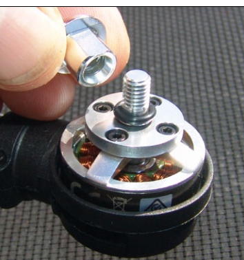
M5-Motorwellen nehmen die Propeller auf
