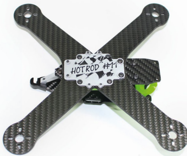
Das Beast Evo X von Artfantasie ( www.rcheli-store.de ) ist ein reinrassiger Wettbewerbs-Racer in 210er-Größe, der in X-Bauweise extrem leicht und stabil aufgebaut ist. Propeller mit maximal 5 Zoll können geflogen werden. Ein typisches Setup sind 2804-2650KV Graupner Ultra-Motoren mit 20A-Controller und 4s/1.500mAh-Akkus. Das Frame ist sehr durchdacht aufgebaut, und trotz der kleinen Abmessungen finden alle nötigen Komponenten Platz
