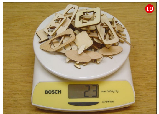
Um insgesamt 23 Gramm erleichtern die unzähligen Aussparungen den Rohbau (19)
