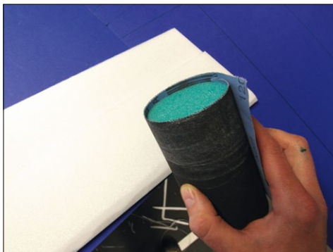
Ein Stück Schwimmnudel als „Schleifklotz“ mit 120er-Schleifpapier ist sehr gut geeignet für Depronmodelle
