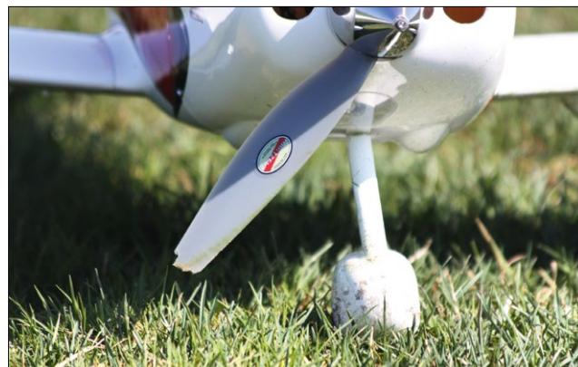
Das Fahrwerk ist stabil, nur für den Propeller nicht hoch genug. Hier wäre eine Umrüstung auf Dreiblatt ideal
