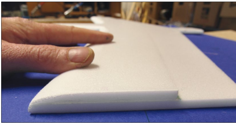
Nach dem Schleifen sollte die Nasenleiste etwa so aussehen
