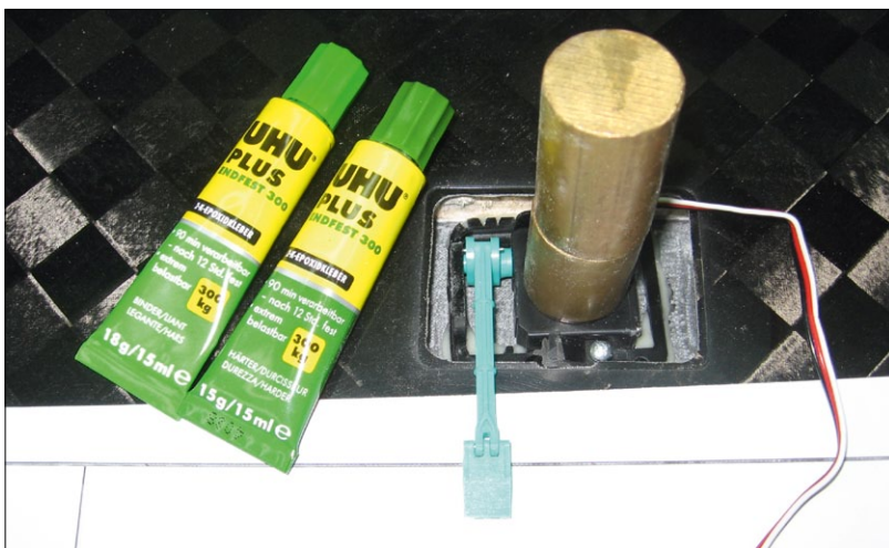
Beim Verkleben der Servorahmen sollten nur hochwertige Klebstoffe, wie hier Uhu Plus oder aber eingedicktes Langzeitharz zum Einsatz kommen. Zum Aushärten wird das Servo beschwert
