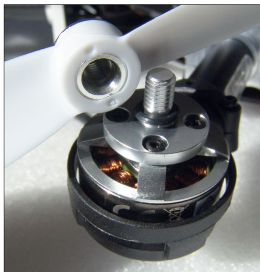
Spinner in Luftschrauben einstecken und Einheit bis zum O-Ring aufdrehen
