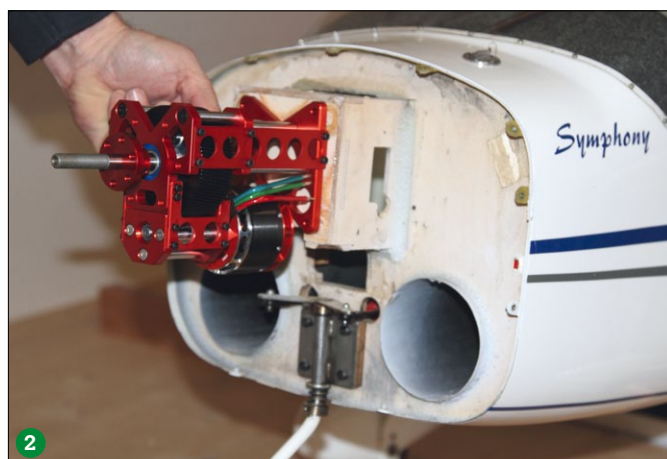
Für den Praxistest wurde das Schleppmodell Symphony OMF 100-160 mit 3.400 Millimeter Spannweite umgerüstet – der Valach-Boxer wurde ausgetauscht (1). An die Stelle des Verbrenners kommt das Kontronik Stirnrad Getriebe (2)
