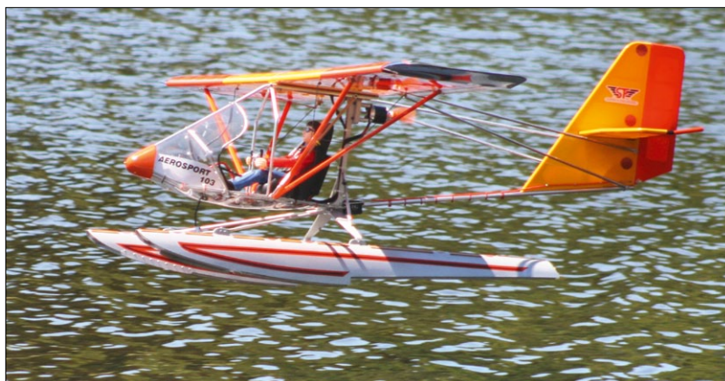
Die Aerosport 103 ist der Nachbau eines amerikanischen Ultraleicht-Flugzeugs der 120-Kilogramm-Klasse. Das attraktive Modell hat 2.390 Millimeter Spannweite
