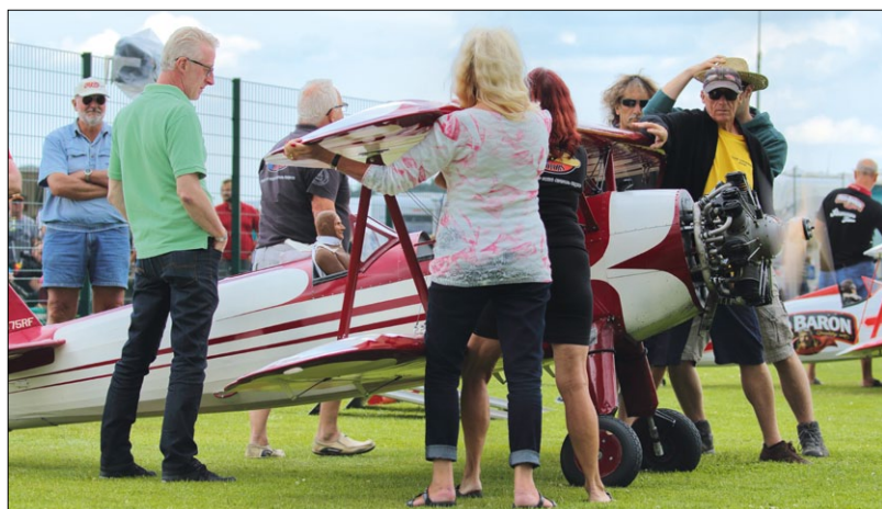
Alle Mitglieder des Eagles Aerobatics Teams müssen fest zupacken, wenn der Valach VM R7-800 Siebenzylinder-Sternmotor mit rund 45 PS an der Latte zerrt
