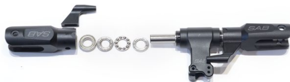
Pro Blatthalter sind zwei Radial- und ein Axiallager verbaut. Die 10-Millimeter-Blattlagerwelle ist durchgehend
