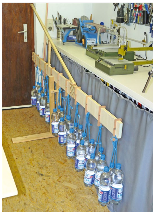
So sieht der Belastungstest mit Wasserflaschen aus. Der scheinbar „dünne“ Holm hat gehalten, der Keller blieb trocken
