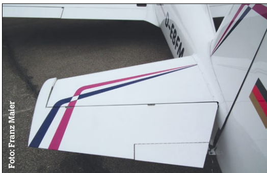
Das Leitwerk ist in Metallbauweise erstellt. Die Randbögen bestehen aus einer Fiberglas-Konstruktion
