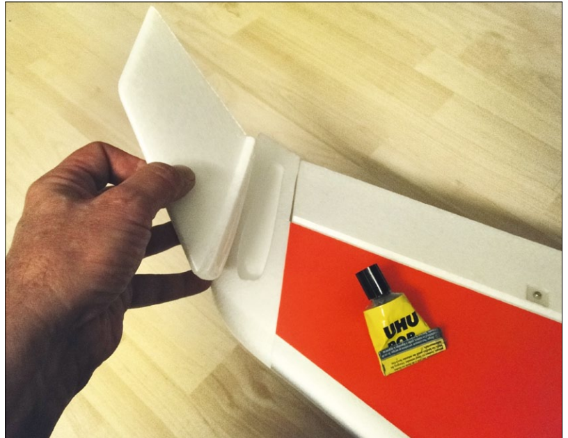
Die Winglets haben wir mit Uhu Por in die Flügel geklebt
