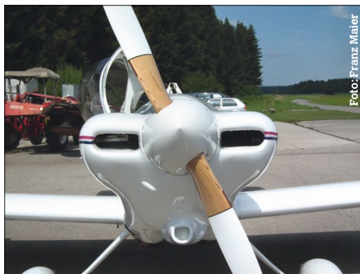
Unter der Motorverkleidung werkelt ein Lycoming-Triebwerk mit einer Leistung von 160 PS
