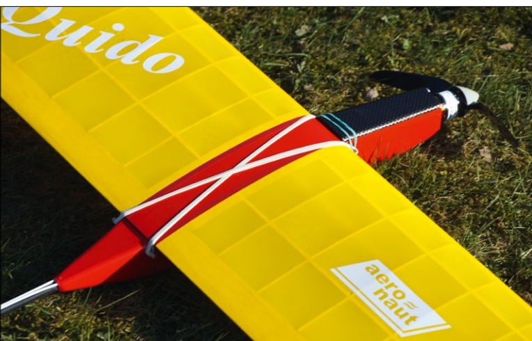
Klassisch und absolut effektiv ist die Tragflächenbefestigung mit Gummis. Ähnlich verfahren wird auch bei der Akkuklappe
