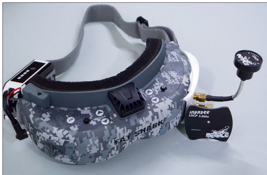
Zu einer hochwertigen FPV-Brille, wie die von Fat Shark, gehören auch sehr hochwertige Antennen, um optimale Voraussetzungen zu schaffen
