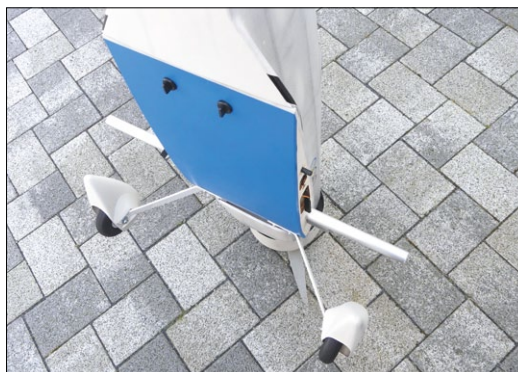
Das Mittelstück (blau) mit adaptiertem Fahrwerk wird einmalig unter den Rumpf geschraubt und muss höchstens zur Reparatur abgenommen werden
