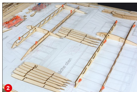
Der Aufbau einer unteren und einer oberen Tragflächenhälfte beginnt (1). Aufpassen muss man bei den Rippen Acht, in denen die Aufnahmen für die Stiele verbaut werden (2)
