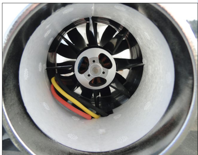
Das gibt es immer wieder mal zu sehen: Die Kabel des Motors liegen völlig unverkleidet im Luftstrom, was strömungstechnisch suboptimal ist
