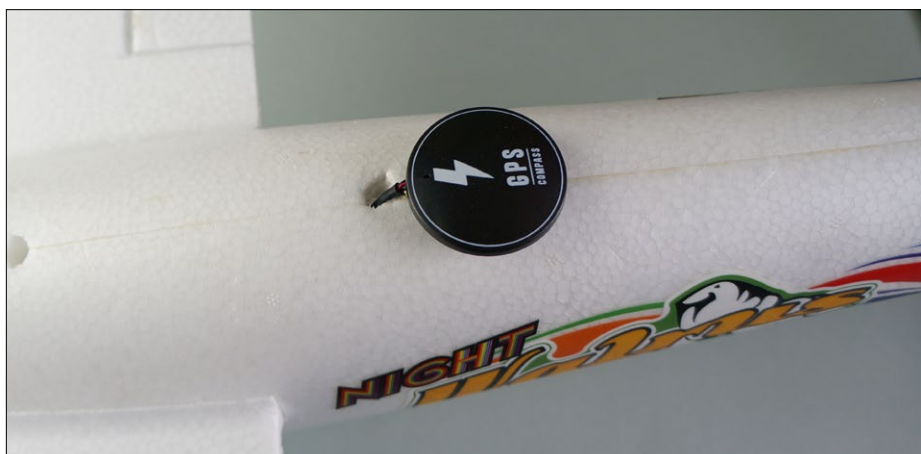
Das GPS-Modul ist außen auf dem Rumpf befestigt
