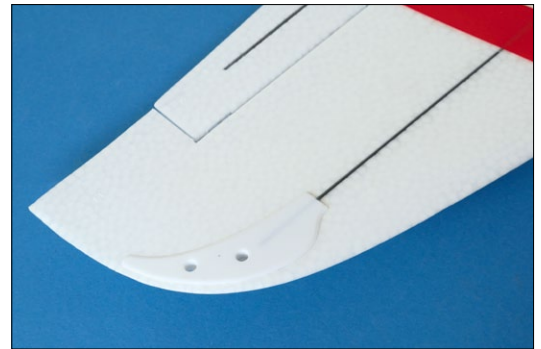
An zwei Punkten lässt sich der CFK-Stift im Plastikteil am Randbogen zum Werfen einstecken
