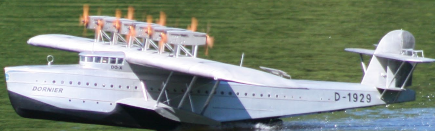
Die Do-X hat 2.500 Millimeter Spannweite und bringt knappe 10 Kilogramm auf die Waage. Hans-Jürgen hat rund 600 Baustunden in das perfekt gefinierte Modell investiert. Das Modell entstand aus Depron, die Außenhaut besteht aus GFK
