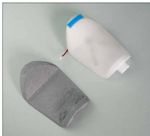
Zur optimalen Aufnahme der FPV-Komponenten wurde eigens ein Canopy aus PETG gedruckt
