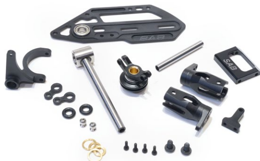
Der Heckrotor in seinen Einzelteilen. Die rechte Seitenplatte des Gehäuses ist aus Alu gefertigt
