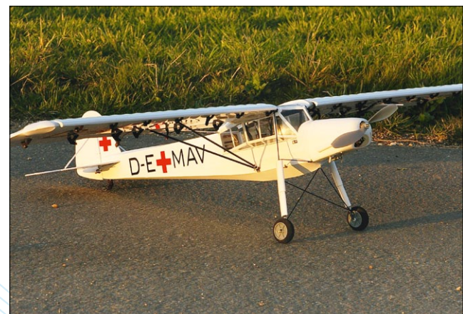
Abbildung 9: Mit seinem weit vorne montierten Fahrwerk mit großem Federweg und Abrissicherheit kann der Fieseler Storch in beiden Varianten gut gelandet werden
