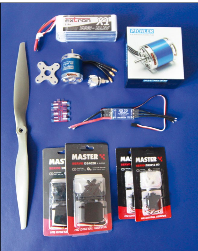
Das Combo-Set besteht aus Brushless-Motor und -Regler, Programmierkarte und 17 x 8-Zoll-Luftschraube. Zusätzlich benötigt werden noch vier Servos und ein 6s-LiPo
