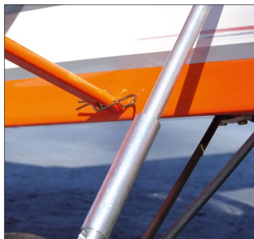
Das Einsetzen der großen Splinte zum Fixieren der Flächenstreben erfordert Fingerspitzengefühl
