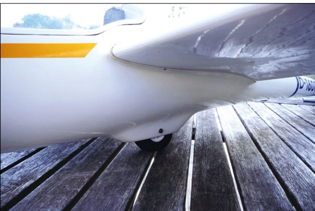
Abbildung 5: Das fest stehende Einradfahrwerk einer ASK-21 ist zum Teil strömungsgünstig verkleidet
