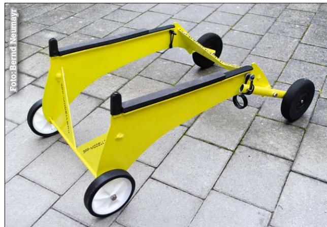
Abbildung 3: Ein Startwagen ist eine klassische Lösung aus dem mantragenden Flug, die noch heute im Modellflug verwendet wird
