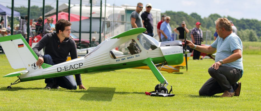
Niko Salewski beim Anwerfen des Moki Fünfzylinder-Sternmotors an seiner PZL-104 Wilga-35A
