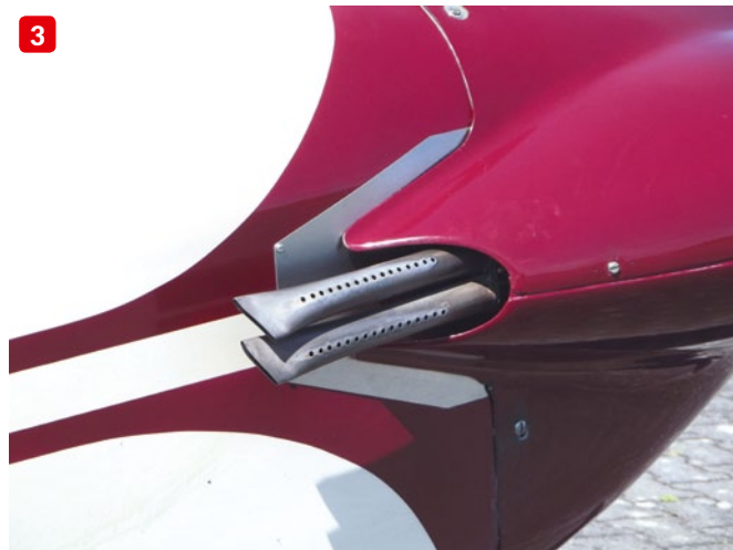
Die Sportavia-Pützer RF-4D macht einen harmonischen und schicken Gesamteindruck (1). Charakteristisch für die RF-4D sind die „Hamsterbacken“ an der Triebwerksverkleidung (2). Unter der Cowling arbeitet ein modifizierter Volkswagen-Boxer-Motor mit einer Leistung von 39 PS. Je zwei Abgasrohre ragen aus den „Hamsterbacken“ (3)
