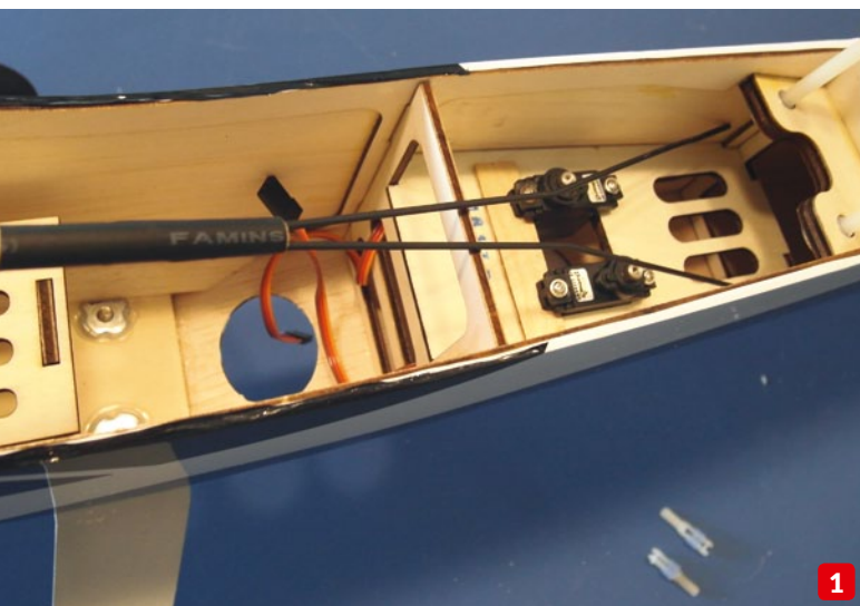
Die Anlenkungsgabel lässt sich nicht ohne weiteres durch den Rumpf fädeln, aber es gibt eine Lösung für dieses Problem (1). Eine Zugschnur aus Zwirn wird an einer schweren Nadel, die wie ein Lotgewicht wirkt, durch den Rumpf gefädelt (2). Anschließend den Faden am Draht sichern und alles vorsichtig durch den Rumpf dirigieren sowie durch die Löcher ziehen (3)
