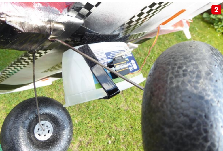
Das System wird mittels selbstklebendem Klettband im Schwerpunkt unter das Modell gehängt (2)
