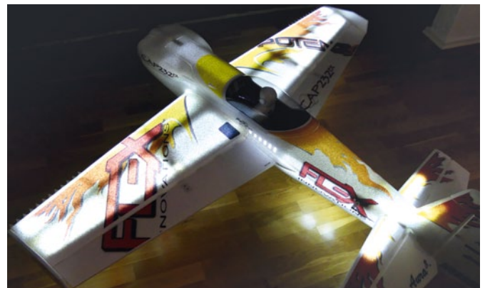
Die LED-Beleuchtung lässt die Cap 232EX von Lindinger von innen heraus leuchten. Ein wirklich toller Effekt für den Nachtflug
