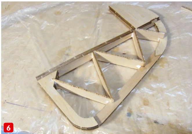
Das Seitenleitwerk ist wie das -ruder eine Rippenkonstruktion, die anschließend komplett beplankt wird. Beim Fixieren der Beplankungsbretter helfen eine Vielzahl an Klammern (4 und 5). Das Seitenruder vor dem Verschleifen. Die Diagonalstreben geben viel Stabilität und Festigkeit – zudem sieht das richtig gut aus (6). Selbst die Rippen des Höhenleitwerks sind noch ausgenommen, um Gewicht zu reduzieren. Allerdings hat sich der Aufwand nicht voll ausgezahlt (7)
