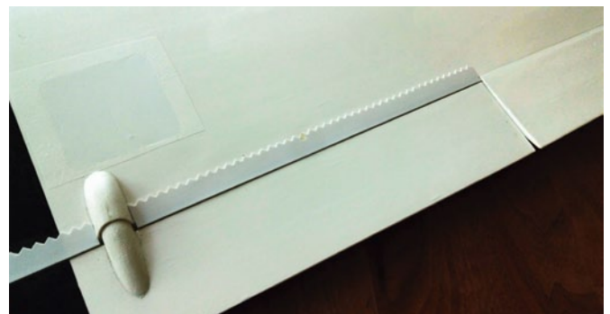
Abbildung 10: Ein Querruder-Turbulator auf der Unterseite einer Tragfläche – er dient gleichzeitig als Spaltabdeckung
