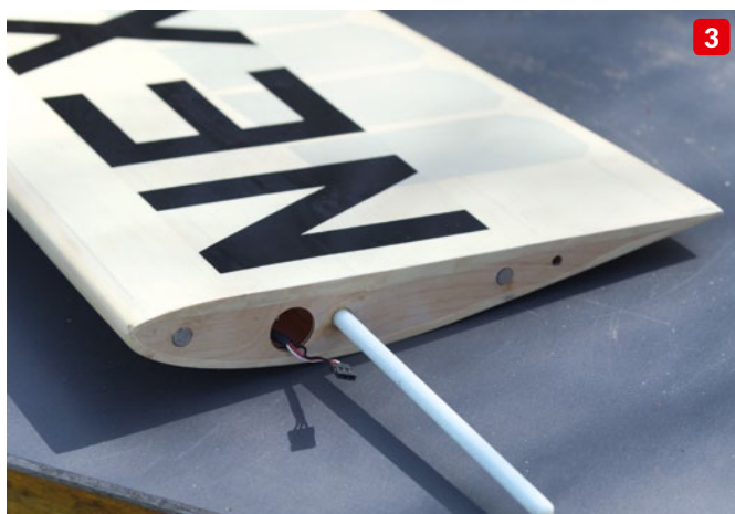
Der Außenflügel mit den Querrudern ist eine scheinbar filigrane Holzkonstruktion, tatsächlich ist der Aufbau absolut stabil (1). Das Höhenruder ist wie die Quer- und das Seitenruder mit Diagonalverstrebung aufgebaut. Diese Bauweise macht mehr Arbeit und erfordert etwas Erfahrung, sieht dafür aber unschlagbar gut aus und ist sehr funktional (2). Die Anschlussrippe des Außenflügels mit den beiden Magneten, dem Steckungsstab aus GFK und der Bohrung für den hinteren Zentrierstift (3). Am Motordom müssen leider gut 240 Gramm Trimmgewicht angebracht werden, um den Schwerpunkt passend einzustellen (4)
