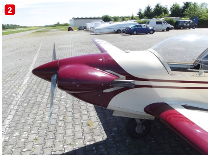
Die Sportavia-Pützer RF-4D macht einen harmonischen und schicken Gesamteindruck (1). Charakteristisch für die RF-4D sind die „Hamsterbacken“ an der Triebwerksverkleidung (2). Unter der Cowling arbeitet ein modifizierter Volkswagen-Boxer-Motor mit einer Leistung von 39 PS. Je zwei Abgasrohre ragen aus den „Hamsterbacken“ (3)
