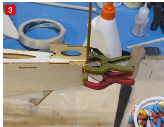
Eigentlich ist diese Holzkonstruktion zu schade, um gleich wieder durch die Bespannung verdeckt zu werden (1). Moderne Zeiten. Die neue Klemm besteht aus präzise gelaserten Sperrholzteilen, die den Aufbau des Modells gegenüber früher deutlich erleichtern (2). Weißbleim und Klammern sind die wichtigsten Hilfsmittel, um das Modell fertigzustellen (3)
