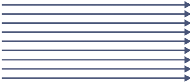
Abbildung 2: Die Schichten einer laminaren Strömung verlaufen nahezu parallel – es gibt keinen Austausch zwischen ihnen
