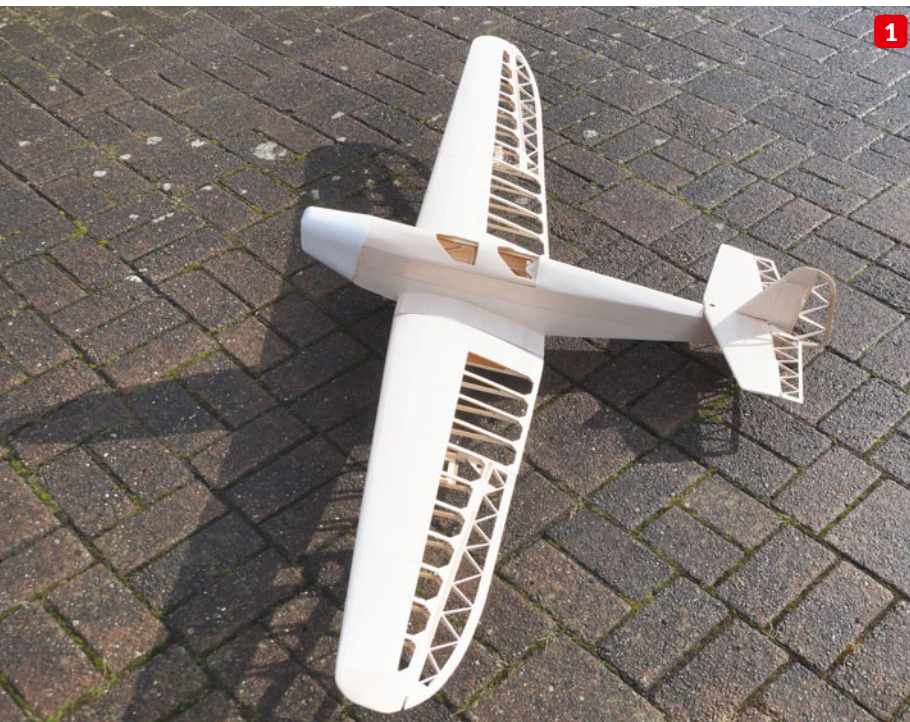
Eigentlich ist diese Holzkonstruktion zu schade, um gleich wieder durch die Bespannung verdeckt zu werden (1). Moderne Zeiten. Die neue Klemm besteht aus präzise gelaserten Sperrholzteilen, die den Aufbau des Modells gegenüber früher deutlich erleichtern (2). Weißbleim und Klammern sind die wichtigsten Hilfsmittel, um das Modell fertigzustellen (3)
