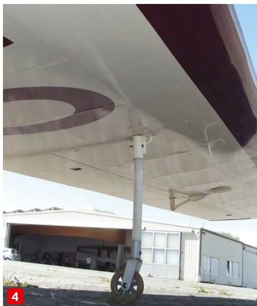
Die Tragfläche hat eine mit Sperrholz beplankte Nase, hinter dem Holm ist die Fläche Stoffbespannt (1). Auch die schicke D-KJNN haben wir in einer farbigen Dreiseitenansicht-Zeichnung dargestellt. Hier ein Blick auf das Leitwerk mit der Höhenruder-Trimmklappe links (2). Das Spornrad ist gefedert und über Federn mit dem Seitenruder gekoppelt (3). Unter jeder Fläche sorgt ein kleines Rad an einer GFK-Stange dafür, dass die Maschine einigermaßen waagrecht auf der Piste steht (4)
