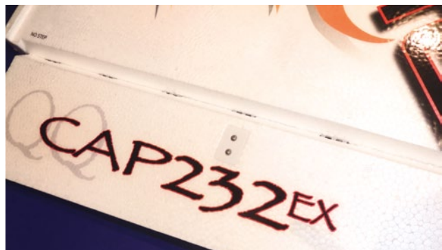
Die Querruder sind jeweils mittels sieben Scharnieren mit den Flügeln verbunden. Deren Festigkeit dürfte auch für den härtesten 3D-Flugstil ausreichen
