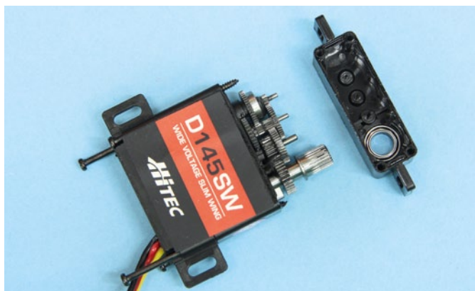
Auch beim neuen Flächenservo D145SW wurde der zur Verfügung stehende Raum perfekt ausgenutzt, um möglichst hohe Zahnräder und ein Kugellager im Gehäuseoberteil unterzubringen
