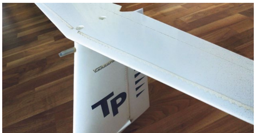
Abbildung 8: Auch am Leitwerk machen Turbulatoren Sinn – bei einfachen Brett-Leitwerken kann man jedoch darauf verzichten, da hier in der Regel keine laminare Anlaufstrecke existiert
