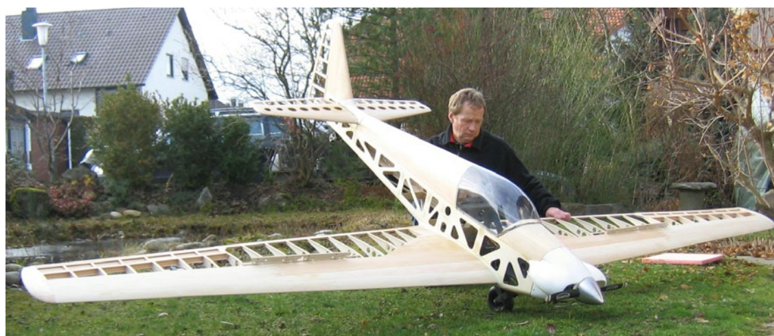
Frank Notter baute die große RF-4D in gut 500 Arbeitsstunden im Nachbaumaßstab 1:2,5. Zur Fertigung kamen keine CNC-Maschinen, sondern die Laubsäge zum Einsatz (Foto: Frank Notter)
