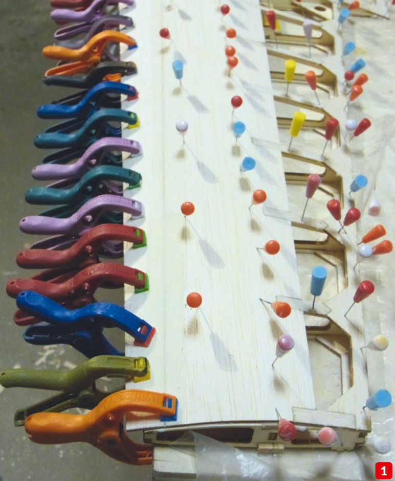
Die obere Beplankung wird mit Klammern und Nadeln gehalten. Von diesen kann man einfach nicht genug haben (1). Die Beplankung des Mittelflügels wird erst aufgebracht, wenn er mit dem Rumpf verklebt ist (2)
