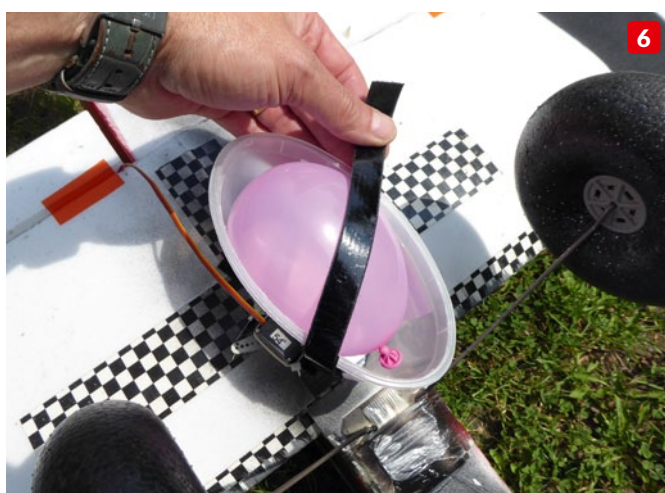
Der gelochte Deckel dient als Diffusor. Mit verschiedenen Lochgrößen erzeugt man eine unterschiedliche Wasserverteilung (4). Auch der Deckel wird einfach mit Klettband gesichert. Das lässt ein schnelles Nachfüllen zu (5). Möchte man einen zentrierten Schwall, befestigt man die Wasserbombe mit Klettband in der Dose. Achtung: nicht die raue Seite zum Ballon hin (6). Wie man hier erkennen kann, ist etwas Bodenfreiheit und ein geeigneter Untergrund von Vorteil, um den Ballon nicht beim Anrollen aufzureißen (7)
