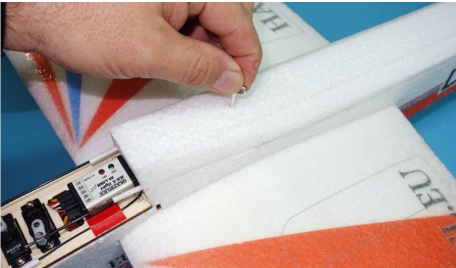
Ein von oben durchgesteckter Stahlstift sichert die beiden Tragflächen am Rumpf
