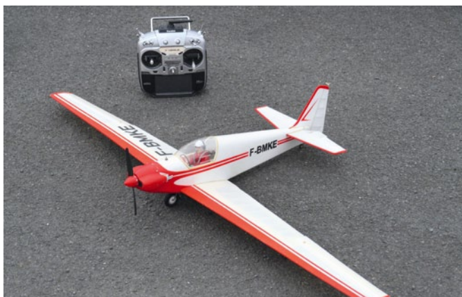
In Depronbauweise erstellte Wolfgang Braun diese RF-4D im Maßstab 1:10. Das Modell bringt 165 g auf die Waage (Foto: Wolfgang Braun)
