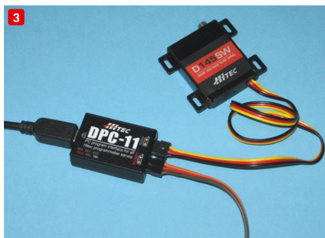
Die beiden Praxistest-Modelle: der Xplorer3 wurde mit vier D145SW in den Tragflächen ausgestattet. Im Kult arbeiten ebenfalls vier D145SW in der Fläche und zwei D85MG im Rumpf (1). Die im Lieferumfang enthaltenen Servorahmen beim D145 SW lassen sich nach gründlichem Anrauen problemlos sowohl in Schalenflächen, als auch mit Styro-Abachi-Tragflächen verkleben (2). Die Servos werden zur Programmierung über das DPC-11 Programmiergerät mit dem PC verbunden. Links der USB-Abgang zum PC, rechts werden das Servo sowie eine zusätzliche Stromversorgung angeschlossen (3)
