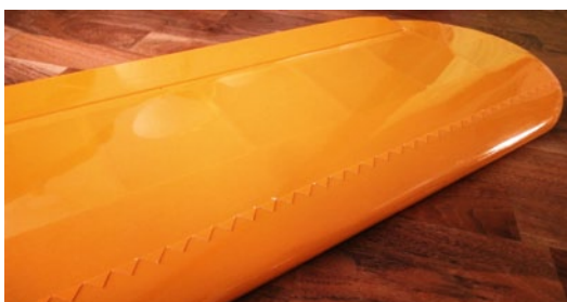
Abbildung 7: Ein Turbulator bei etwa 20 Prozent der Profiltiefe
