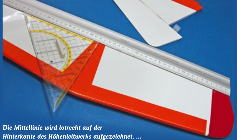
... danach lässt sich das Leitwerk einfach und schnell ausrichten
