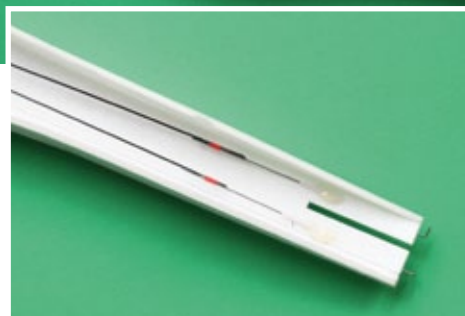
Vor dem Verschließen des Rumpfs sind die Rumpfgestänge exakt einzubauen und durch ein PVC-Rohr nach außen zu führen
