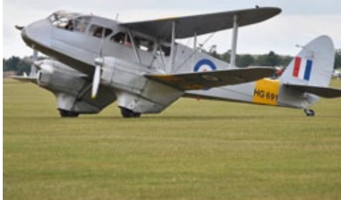
Charakteristisch für die DH.89 sind die beiden Motorgondeln mit darin befindlichem Fahrwerk
