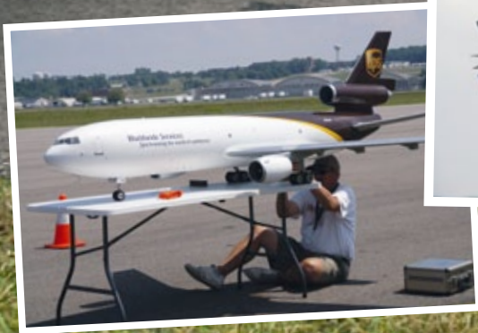
Außerhalb des Wettbewerbs gab es ebenfalls Interessantes zu sehen, wie diese DC-10 mit zwei elektrischen Schübeler-Impellern
