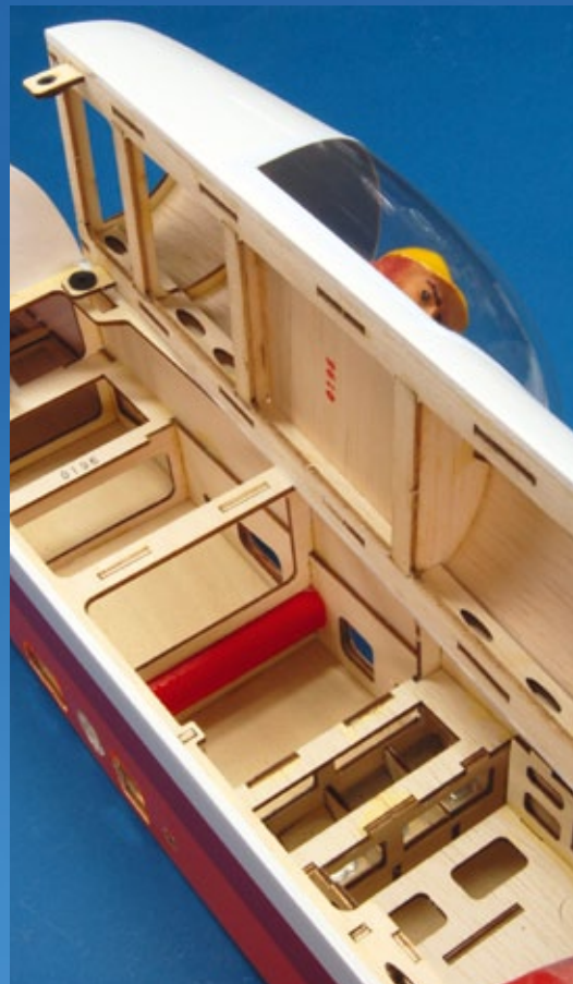
Die große Rumpfabdeckung erlaubt den leichten Zugang zu den „Innereien“
