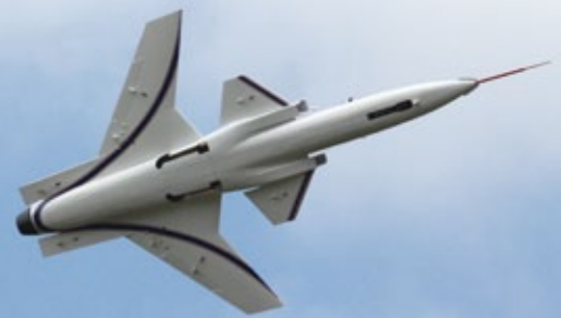
Das einmalige Flugbild des mit vorgepeilten Flächen ausgestatteten Experimentaljets X-29 kommt von unten betrachtet am besten zur Geltung
