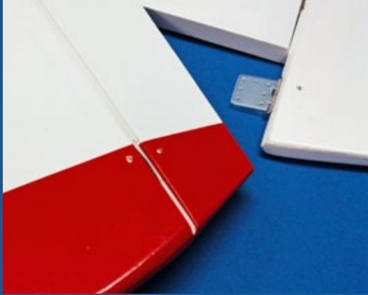
Bereits fix und fertig – Kunststoffsecharniere mit Sicherungsnadeln
