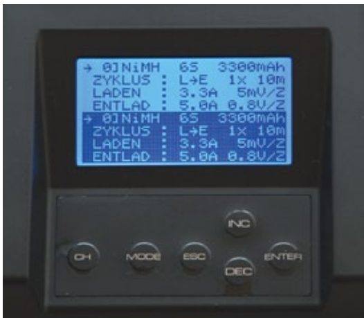
Die Info- und Bedienfront. Abgebildet sind die Speicherdaten mit aktivem Ausgang A1
