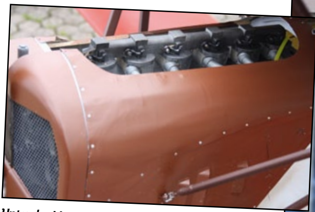
Unter der Motoratrappe der D-VII werkelt ein ZG80 mit Getriebe
