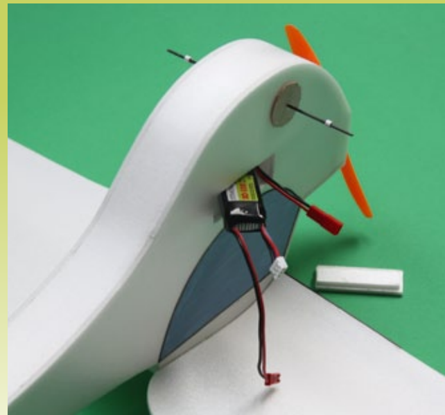
Selbstverständlich ist der Akkuwechsel ohne vorige Radmontage möglich
