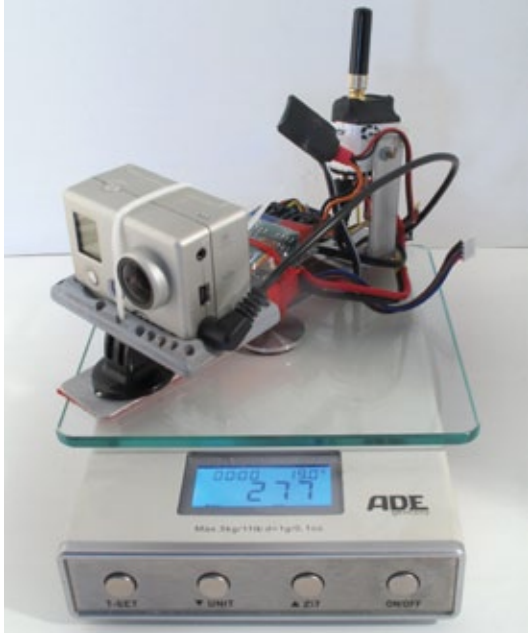
Die hero in FPV-Einsatz bringt mit allen Halterungen etwa 280 Gramm auf die Waage. Sie ist nicht mehr für ganz kleine Modelle geeignet
