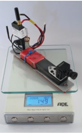
FPV für Weight Watchers. Nur Bildübertragung ohne weitere Daten. Die Anlage wiegt 120 Gramm, mit allen Halterungen knapp 150 Gramm
