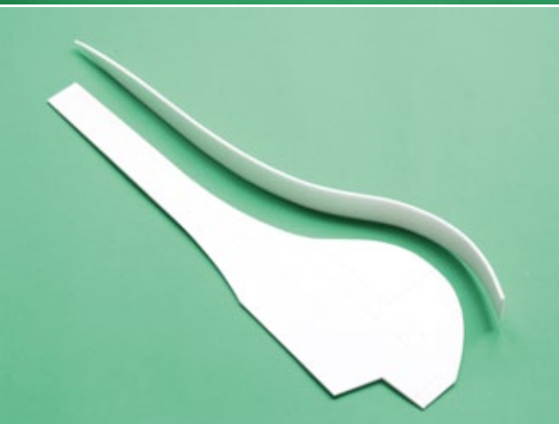
Die Rumpfbodenplatte wurde vorsichtig der Kontur folgend vorgebogen
