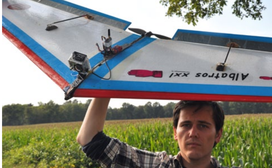
Die mit der Kamera mitgelieferten Gehäuse aus Acrylglas wiegen 70 Gramm. Als Schutz der Kamera (ein Gehäuse ist sogar bis 60 Meter wasserdicht) sind sie sinnvoll. Der inzwischen leicht ramponierte und in unseren Berichten schon mehrfach abgebildete Albatros XXL schafft auch diese Anlage (350 Gramm mit der hero im Schutzgehäuse)
