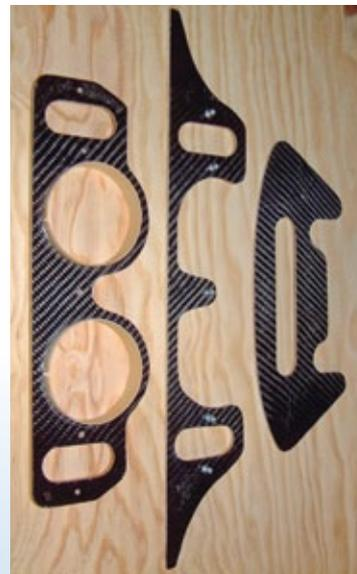
**Die selbst erstellten Spanten für die Tanklagerung**
