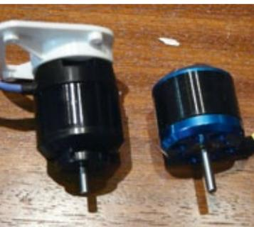
**Größenvergleich. Der Austauschmotor rechts hat die gleichem Maße und das gleiche Gewicht, aber mehr Leistung. Man beachte die unterschiedliche Ausrichtung der Motorwelle**
