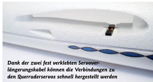
Dank der zwei fest verklebten Servoverlängerungskabel können die Verbindungen zu den Querruderservos schnell hergestellt werden
