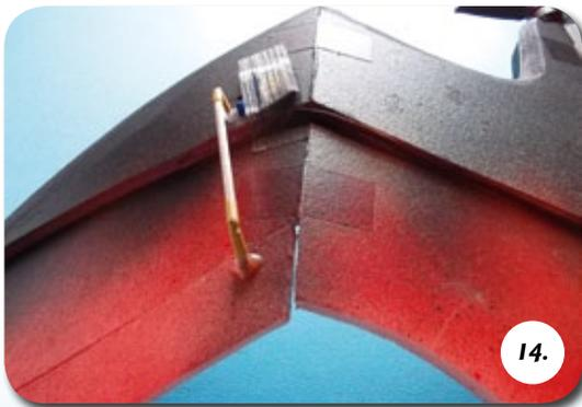
**Direkte, spielfreie Ruderanlenkung. Das Servo ist mit Gewebe-Klebeband gesichert**
