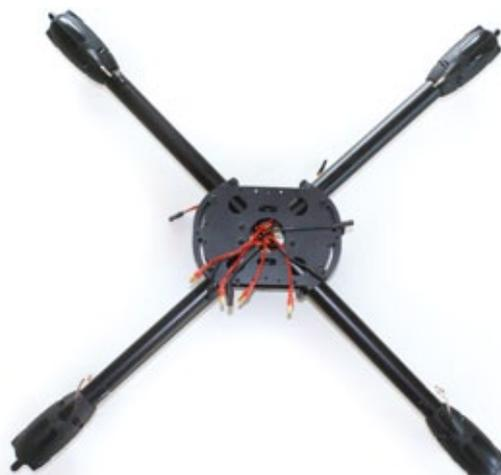
Die Unterseite mit den noch nicht zusammengesteckten Regleranschlüssen
