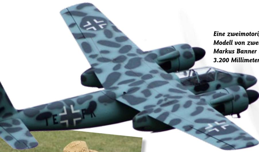
Eine zweimotorige TA-154 in 1:5. Angetrieben wird das Modell von zwei 50er-King-Motoren. Das Modell von Markus Banner ist eine komplette Eigenkonstruktion mit 3.200 Millimeter Spannweite und wiegt 24,6 Kilogramm
