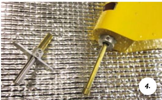
**Das Messingsrohr zum Lagern des Ruders hilft beim exakten Ausrichten beziehungsweise Einkleben des Aluminium-Teils**
