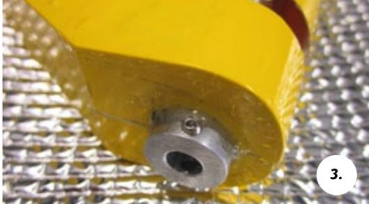
**Mit Uhu endfest 300 eingeklebtes Aluminium-Teil. Das Gewinde bleibt zugänglich**
