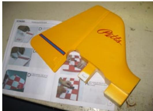
**Das Seitenleitwerk wird eingesteckt und verschraubt, somit sind keine Klebearbeiten nötig**
