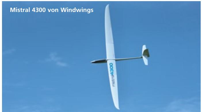
**Windwings** Der Mistral 4300 ist ein Hochleistungssegler mit einer Spannweite von 4.300 Millimeter. Das Modell verfügt über CFK-GFK-Sechsklappen-Flügel in Hartschale mit einem Carbon Doppelholm und Doppelstreckung. Bei einer Rumpflänge von 1.840 Millimeter kommt der Mistral 4300 auf ein Abfluggewicht von etwa 6.200 Gramm. Die Rumpfröhre ist mit Carbon verstärkt. Der Preis: 1.490,- Euro.
