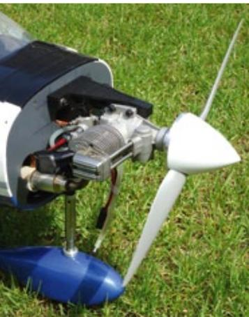
**Der Viertakter liefert den passenden Sound und verschwindet samt Schalldämpfer vollständig unter der Motorhaube**
