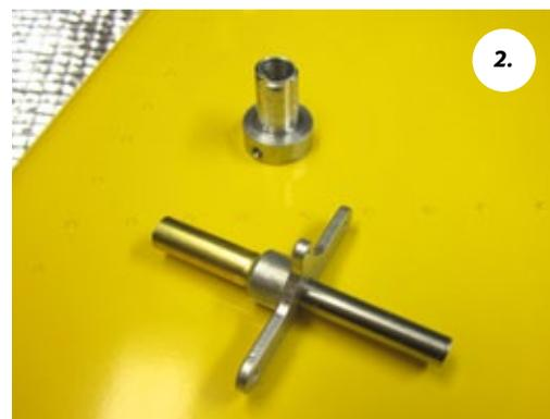
**Oben das Aluminium-Teil, das ins Seitenruder kommt, und unten die Rudernanlenkung, die im Rumpf verschwindet**
