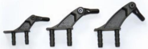
**Der Himmlische Höllein** Die neuen Gabelruderhebel bestehen aus Kohlefaser-verstärktem Kunststoff. Durch die hochfeste Auslegung ergibt sich eine harte und verwindungssteife Anlenkung der Ruder. Die Lieferung erfolgt mit bereits eingebautem, spielfreiem Kugelgelenk. Erhältlich sind die Ruderhebel mit 15, 20 und 27 Millimeter Wirklänge. Der Preis: Zwischen 5,30 und 9,10 Euro.
