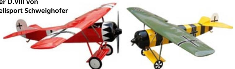
**Modellsport Schweighofer** Mit dem Baukasten der Fokker D.VIII bietet Modellsport Schweighofer ein ARF-Modell mit 2.090 Millimeter Spannweite und 1.560 Millimeter Länge an. Der Erste Weltkrieg-Nachbau ist eine klassische Holzkonstruktion, die mit Oracover bespannt wurde. Die Motorhaube ist aus GFK und fertig lackiert. Vorgesehen ist ein Verbrennungsmotor ab 25 Kubikzentimeter Hubraum. Von der Fokker sind zwei Farbvarianten erhältlich. Der Preis: 399,90 Euro.
