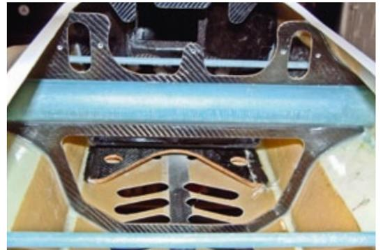
**Der Spant für die Tanks ist zweiteilig und sitzt auf dem Steckungsrohr**
