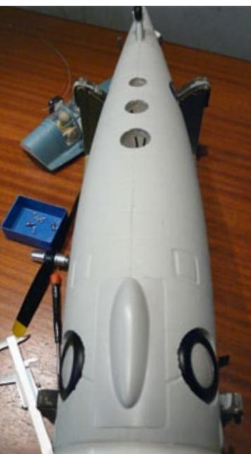
**Große Löcher für die Abluft sorgen für eine gute Kühlung der Komponenten**
