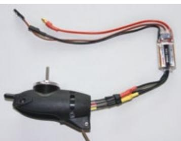
**Fertig montierte Motorgondel. Der Regler wird im Alu-Rohr platziert**
