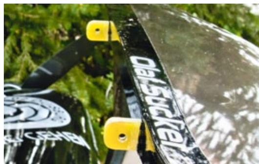
**In diese GFK-Laschen greifen die Stahlstifte der Kabinenverriegelung**
