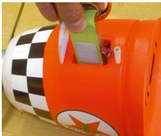
Der Antriebsakku lagert stehend im Rumpfkopf und ist über einen Deckel im Rumpfboden zugänglich. Platz ist für 3s-Lipos mit 1.800 bis 2.200 Milliampere Kapazität
