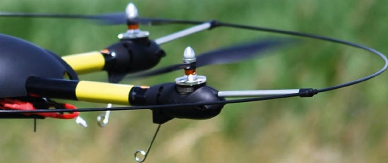
aus Aluminium in jeweils zwei entsprechenden Kunststoffhaltern schwenkbar gelagert. Am äußeren Ende der Alurohre werden Motorgondeln montiert, die aus zwei verschraubten Kunststoff-Halbschalen bestehen und außer den Motoren auch noch das Landegestell in Form eines Federstahldrahts aufnehmen.
