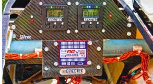
Von links: Kontroll-LED des Zündschalters (Bestandteil des Emtotec TSC), darunter der Programmierstecker des Emtotec TSC, LC-Display des Emtotec DPSI und die Kontroll LED des verdeckt eingebauten Emtotec Magnetschalters. Darunter befindet sich das Emtotec DPSI Twin Mini Pro Bluetooth
