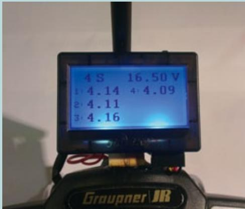
**FAS-100 Stromsensor und Display von Scale-Heli-Manufaktur**
