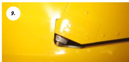
**Zwecks Ausrichtung und Klemmung der Anlenkung ist ein kleiner Schlitz mit Zugang zur Madenschraube geblieben**
