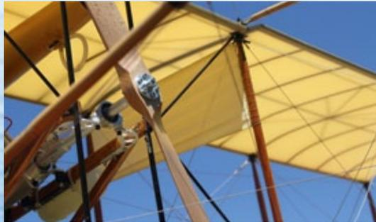
**... die ihre Leistung über eine selbst gefertigte Fernwelle an den Druckpropeller abgeben**
