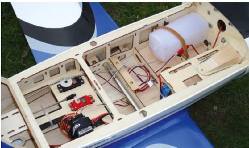
**Platzprobleme gibt es im geräumigen Rumpf der Lancair nicht. Eine sichere Befestigung der RC-Komponenten erfolgt mit Gummiringen und Klettbandern**
