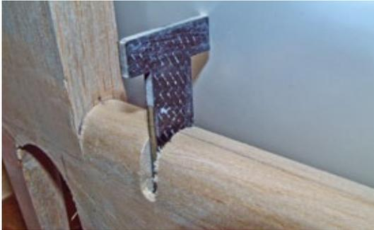
**Die Scharniere für die Lagerung des Seitenruders sind aus 3-Millimeter-Sperrholz nebst CFK-Beschichtung selbst hergestellt worden. Das „T“ liegt innen, hinter der Abschlussleiste des Rumpfs**
