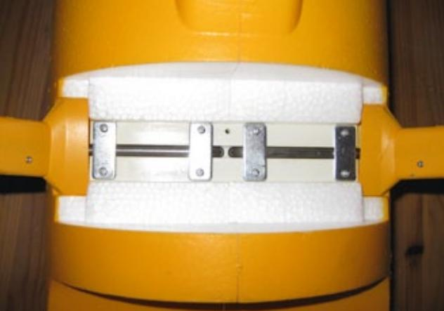
*Einfach und stabil gestaltet sich die Aufnahme des Hauptfahrwerks im Rumpf*
