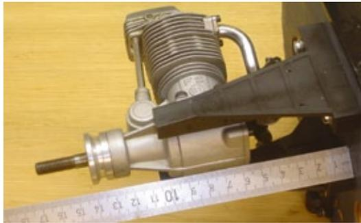
**Die Rumpffront bietet genügend Raum auch für den Einbau von Viertaktmotoren. Der Abstand vom Motorspant zum Luftschraubenmitnehmer soll 142 Millimeter betragen**
