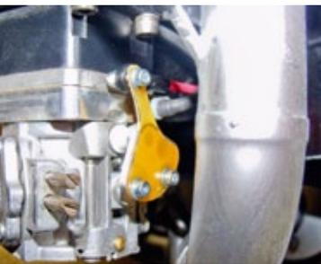
**Der Hebel der Drosselklappe entstand aus GFK und wurde mit zwei M3-Schrauben auf dem serienmäßigen Hebel verschraubt**
