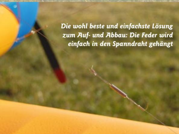
*Die wohl beste und einfachste Lösung zum Auf- und Abbau: Die Feder wird einfach in den Spanndraht gehängt*
