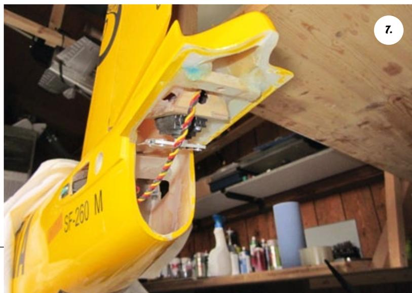
**Im Rumpf eingebautes Servo mit bereits abgelängter Seilzuganlenkung**
