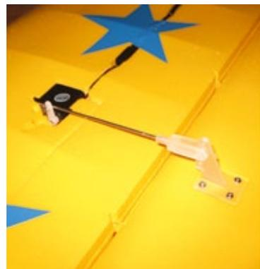
**Alle Servos sind bereits herstellereitig montiert. Und zwar pro Fläche eines der 9-Gramm-Klasse**
