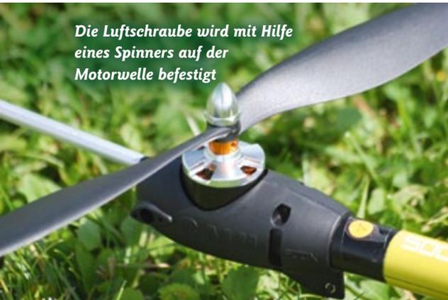
Die Luftschraube wird mit Hilfe eines Spinners auf der Motorwelle befestigt
