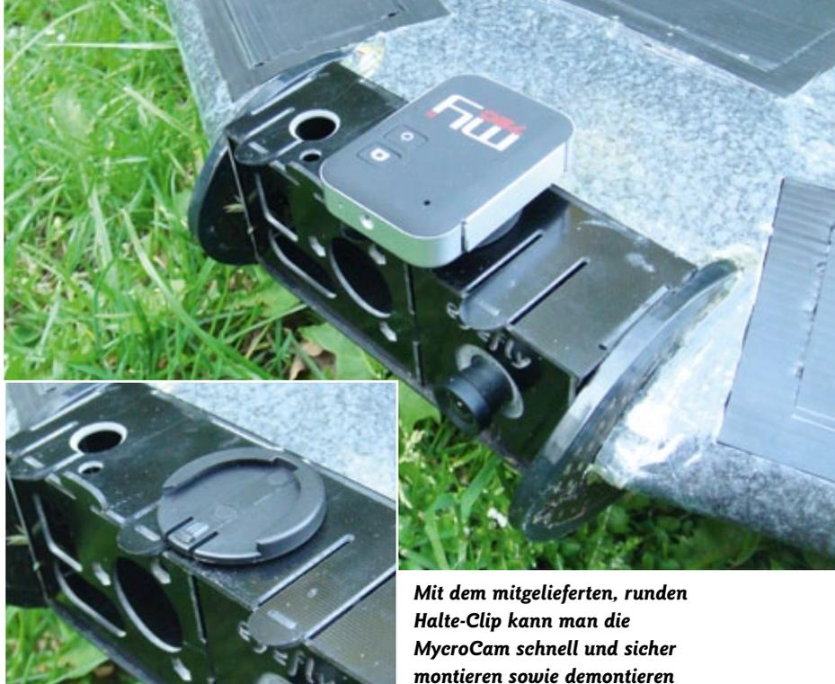
**Mit dem mitgelieferten, runden Halte-Clip kann man die MycroCam schnell und sicher montieren sowie demontieren**
