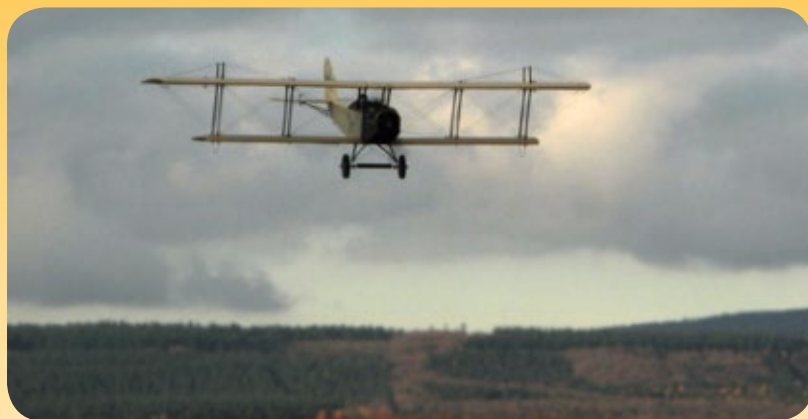
Abbildung 5: Die Curtiss-Jenny mit 1.800 Millimeter Spannweite fliegt dank Leichtbaus und optimaler Einstellung 50 Minuten am Stück
