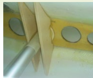
Die Aufnahme des Steckungsrohrs wird von Rumpfspanten gestützt
