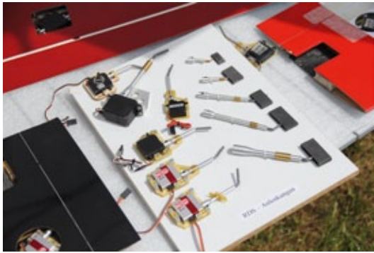
Ober Flugmodellbau ist Spezialist für RDS-Anlenkungen sowie F3B-Winden und hatte seine ganze Palette an RDS-Einbaurahmen mit dabei
