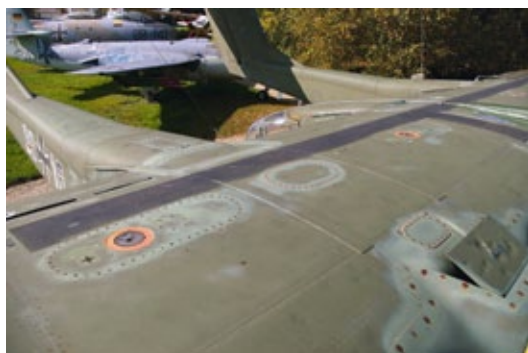
An den Flügeloberseiten sitzen oft größere, verschraubte Panels, die den Zugang zu den Tanks erlauben
