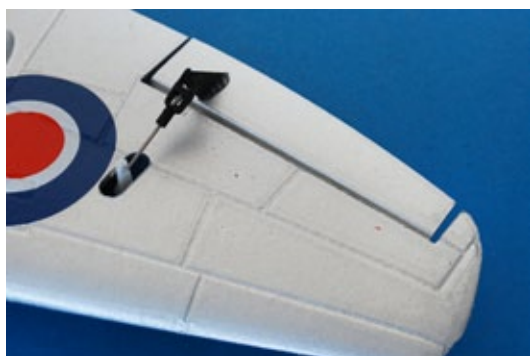
Rudergestänge und -hebel ragen deutlich hervor – der einzige optische Makel
