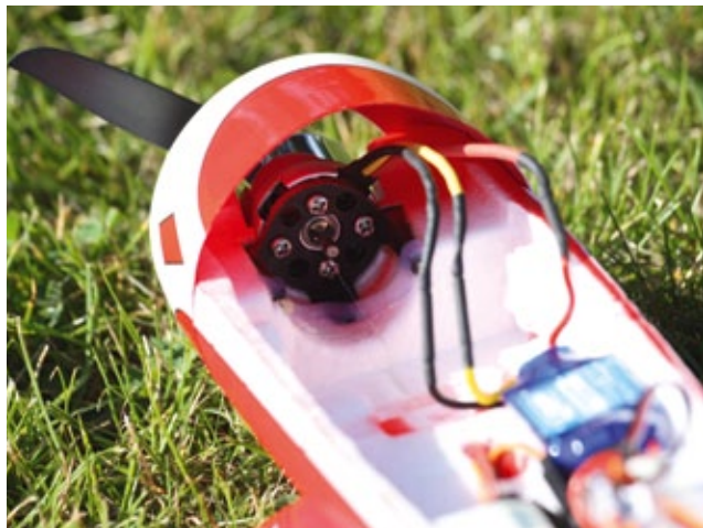
Ein stabiler Plastikmotorspant, der über Zapfen gut im Hartschaum verankert ist, trägt den hochoptimierten Außenläufer
