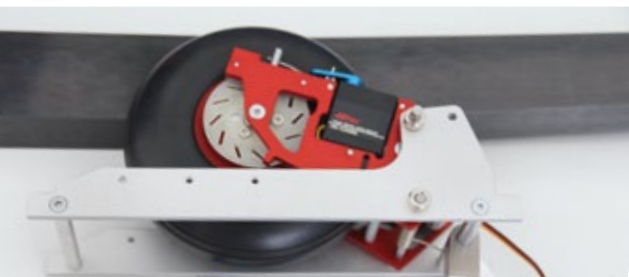
Bei Florian Schambeck sahen wir ein Einziehfahrwerk mit Scheibenbremse. Der Clou dabei: Das Bremsservo wurde direkt in die Fahrwerksschwinge integriert
