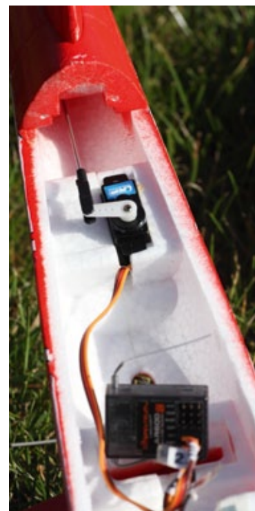
Im Heck ist das Höhenruderservo eingebaut, dessen Lenkgestänge im Rumpffinneren verläuft
