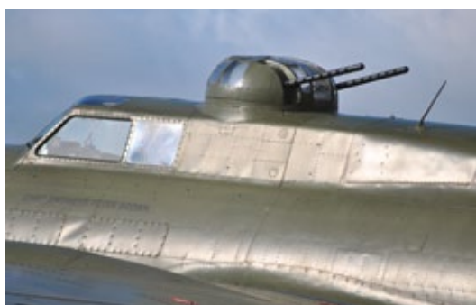
Auch im Original ist die Außenhaut der B-17 mit zahlreichen, aufgesetzten Blechdeckeln und Verstärkungs- blechen versehen
