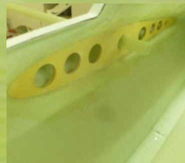
Einer der Hilfspanten ist innen im Rumpf eingeklebt
