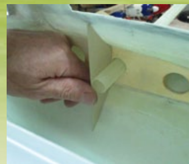
Die Aufnahme des Steckungsrohrs wird von Rumpfspanten gestützt
