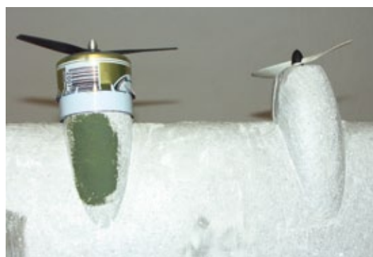
Von der Bierdose zur Triebwerksverkleidung. Beim Detaillieren mit Blech sind der Fantasie keine Grenzen gesetzt
