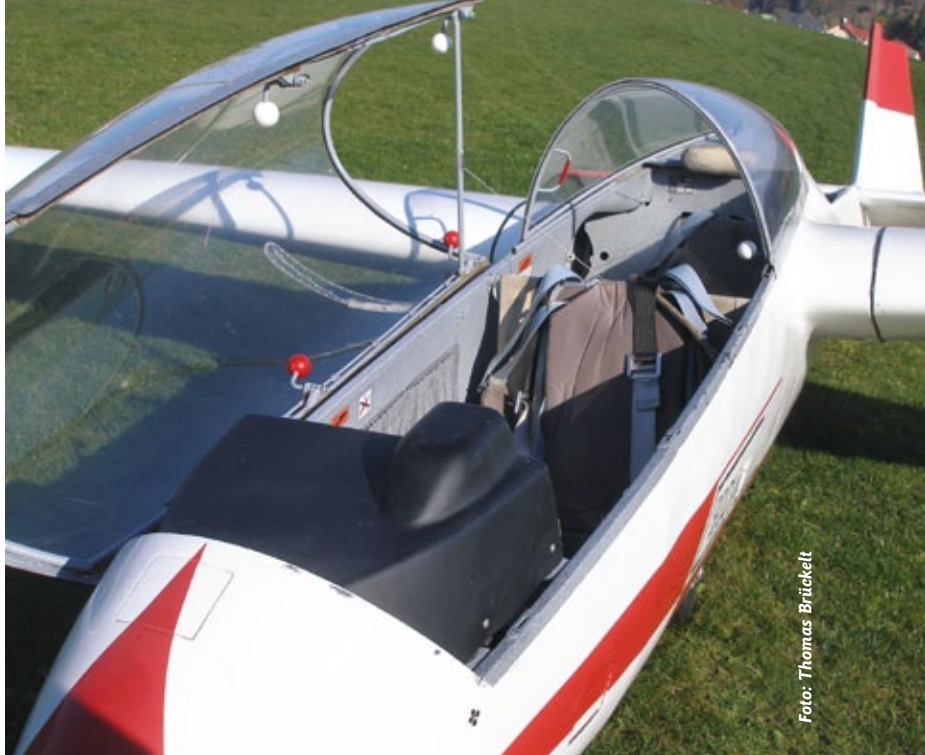
Blick ins Cockpit der SP-2591. Für die beiden Besatzungsmitglieder ist nur das zentrale Instrumentenbrett vor dem vorderen Piloten vorhanden
