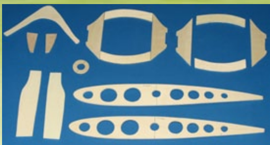
Holzspanten sorgen später für die erforderliche Steifigkeit des Rumpfs
