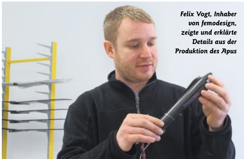
Eine Kohle-Kevlar-Rumpfspitze dient zum reinen Seglerbetrieb. Durch Austauschen der Spitze wird der Apus zum Elektrosegler
