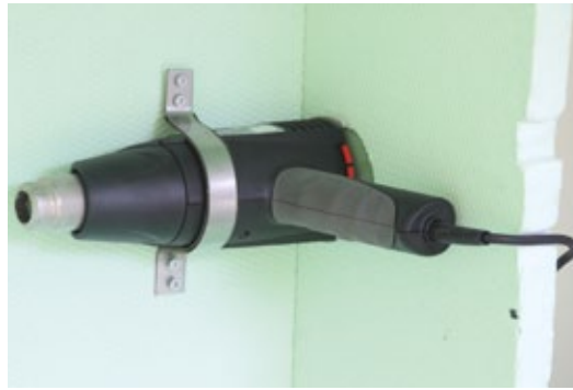
Ein regelbares Heißluftgerät wärmt die Isolierkiste für die thermische Nachbehandlung von größeren Bauteilen
