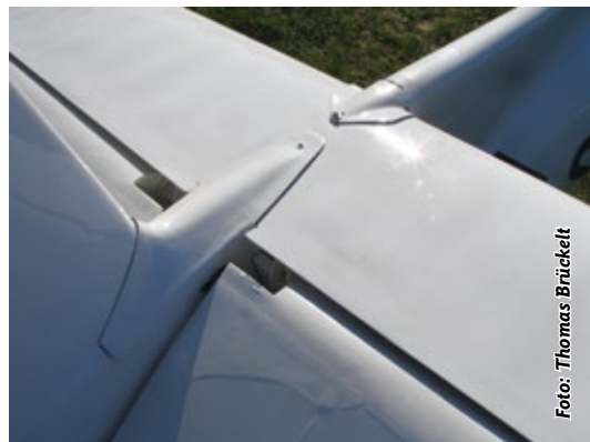
Die einteilige Höhenflosse wird von oben auf den Rumpf montiert, zwei Verkleidungen sorgen für einen aerodynamischen Übergang zum Rumpf beziehungsweise zur Seitenflosse
