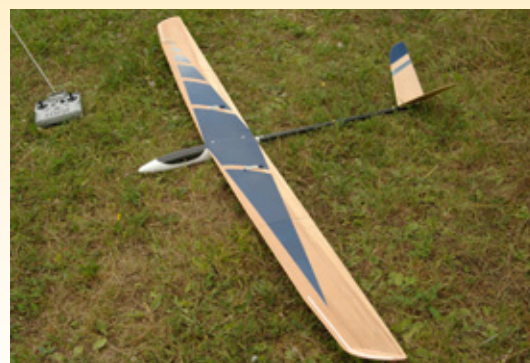
Abbildung 6: Ein Leichtwindsegler mit Wölbklappen – eine genaue Berechnung ergab, dass sie kaum etwas nützen.
