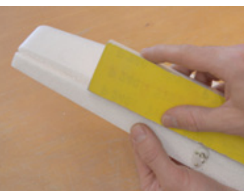
Ein schwergängiges Höhenruderscharnier sollte durch gleichmäßiges Ausdünnen der Scharnierkehle leichtgängig gemacht werden
