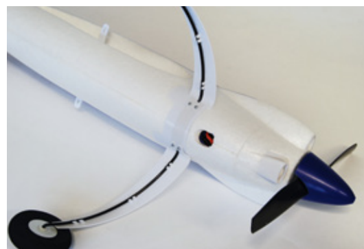
Die Montage des Hauptfahrwerks ist einer der wenigen Schritte, die zur Komplettierung des Modells erforderlich sind
