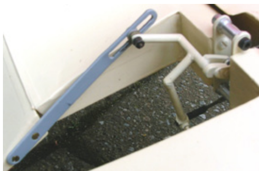
Die Anlenkungs-Kinematik des Höhenrunder-Trimmruders – eine hervorragende Detailarbeit
