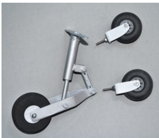
Lackiertes Heckfahrwerk und die beiden Radbügel der Stützräder, ebenfalls in Eigenregie entstanden
