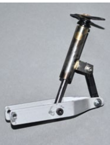
Beim Heckfahrwerk wurde auf eine Eigenkonstruktion zurückgegriffen. Diese federt und ist robust
