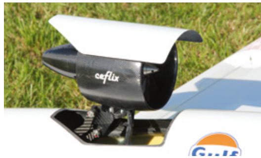
Klapp-Impeller: In Schwabmünchen wurde klar, dass hier der der neue Trend im Großseglerbereich liegt
