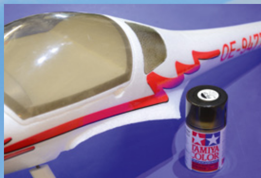
Tuningtipp Tönungsspray: Die unschön weiß belassenen Heckfensterbereiche lassen sich mit Tamiya „smoke“ prima optisch angleichen
