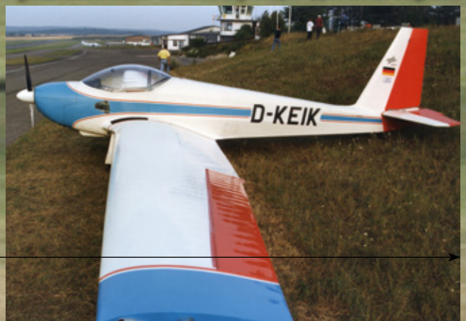
Für Untersuchungen zur Struktur und Dynamik der Atmosphäre bis etwa 3.000 Meter wurde bei der DFVLR ein System von drei gleich instrumentierten Motorseglern des Typs ASK-16 eingesetzt
