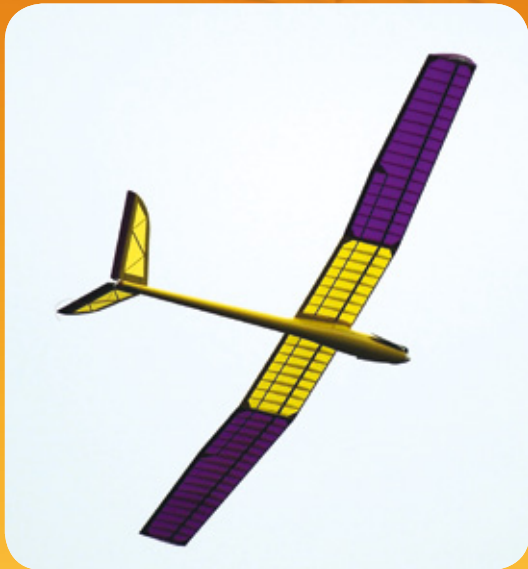
Abbildung 1: Ein kleiner HLQ in klassischer Holzbauweise. Er hat weder Querruder noch Wölbklappen und dennoch ganz hervorragende Thermikflugeigenschaften
