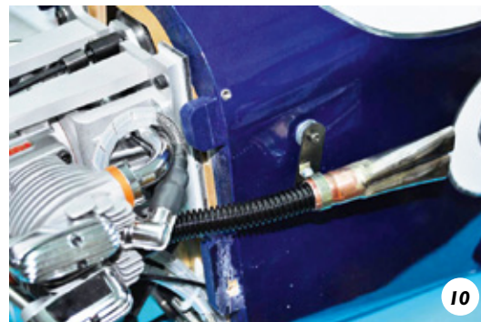
Vom Auslass geht es über die Flexschläuche in die Fishtails. Fixiert sind sie an Distanzhaltern
