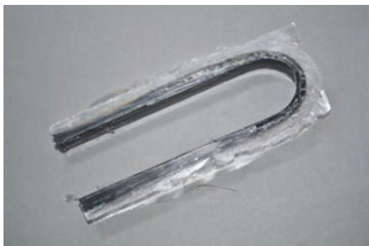
Der laminierte neue Fahrwerksbügel aus Glasfaser und Kohlerovings vor dem Verschleifen
