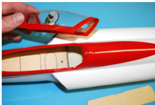
Die Kabinenhaube dient gleichzeitig als Zugang zum Akkufach. Sie wird durch zwei kräftige Magnete sicher gehalten
