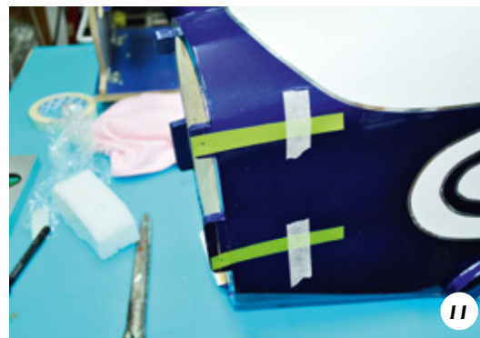
Mit diesen Streifen lassen sich die Haubenbefestigungslöcher übertragen
