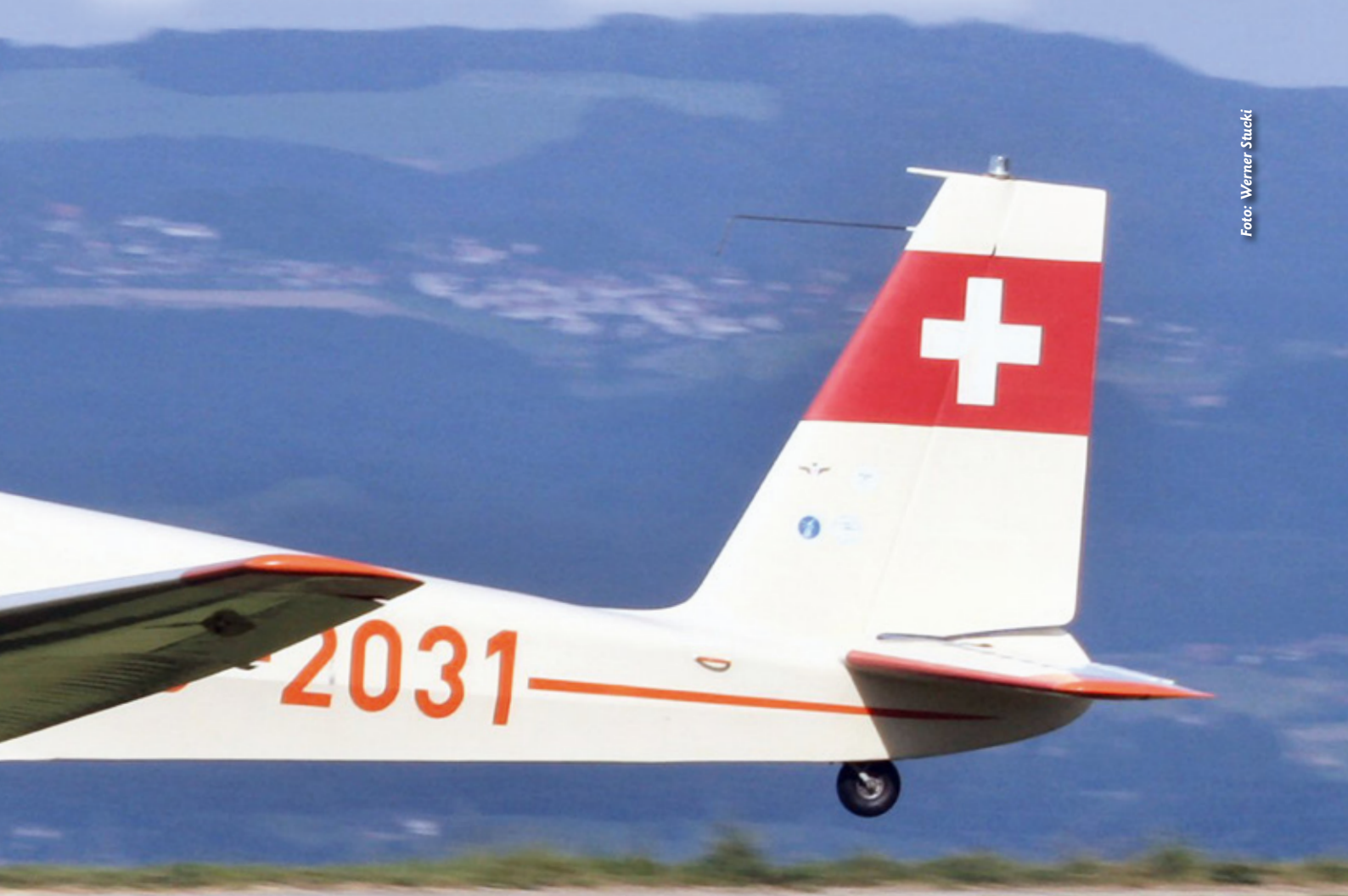
Für Untersuchungen zur Struktur und Dynamik der Atmosphäre bis etwa 3.000 Meter wurde bei der DFVLR ein System von drei gleich instrumentierten Motorseglern des Typs ASK-16 eingesetzt
