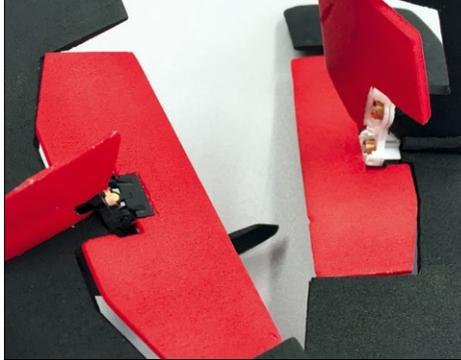
Aktuatoren verstellen die Ruder. Weiche Flugmanöver werden dank cleverer Puls-Steuerung möglich sein
