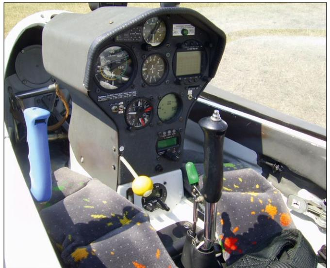
Vorderer Instrumentenpiz der DG-1000S. Der blaue Griff links betätigt die Schempp-Hirth-Bremsklappen
