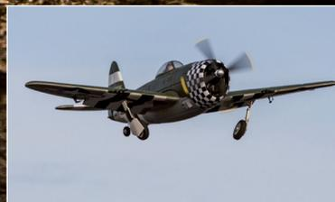
Tolle Scale-Optik mit dem serienmäßigen elektrischen Einziehfahrwerk mit Stahlgestänge und Fahrwerksklappen
