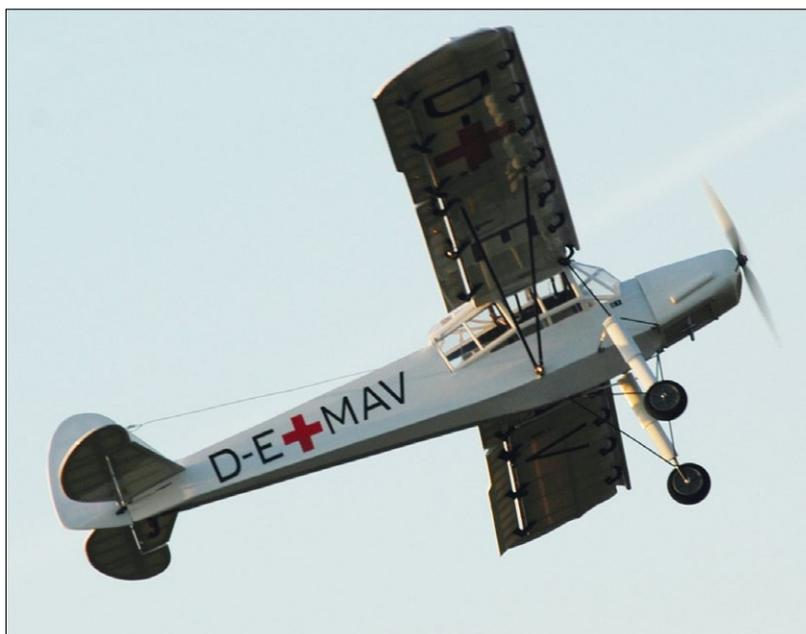
Abbildung 2: Der Fiesler-Storch hatte durch geeignete Klappen und Vorflügel extreme Langsamflug-Eigenschaften
