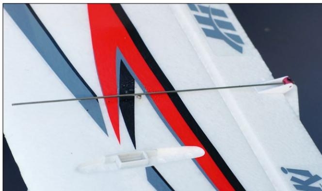
Die einzige kleine Modifikation am Testmodell: Damit beim Transport die Schubstange zum oberen Querruder nicht immer wegdreht und aneckt, wird sie von einem kleinen Magneten im Flügel in Position gehalten
