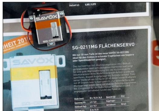
Savox hatte das neue Flächenservo SG-0211MG mit einer Breite von 10 Millimeter und einer Stellkraft von 8 Kilogramm bei 6 Volt mit dabei. Das Servo machte einen sehr hochwertigen Eindruck mit sehr geringem Getriebeispiel und dürfte somit zukünftig häufiger Verwendung in diversen Hochleistungsseglern finden
