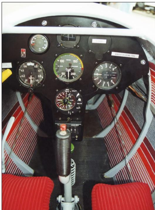
Instrumentenbrett der Ka 6, unten in der Mitte das Variometer mit dem Endanflugrechner
