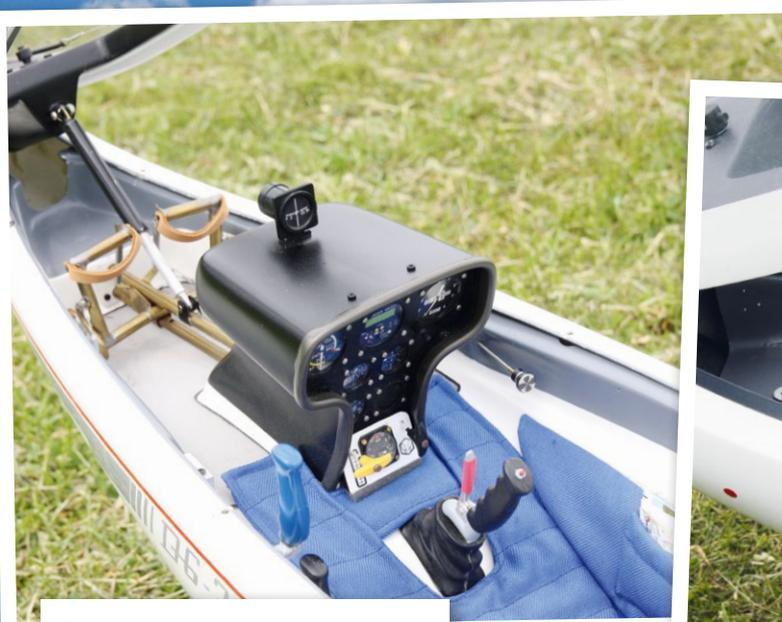
Blickfang eines modernen Seglers sind die Instrumentenpilze – sie lassen sich auch bei einem ansonst wenig er umfangreich ausgebautem Cockpit gut gestalten
