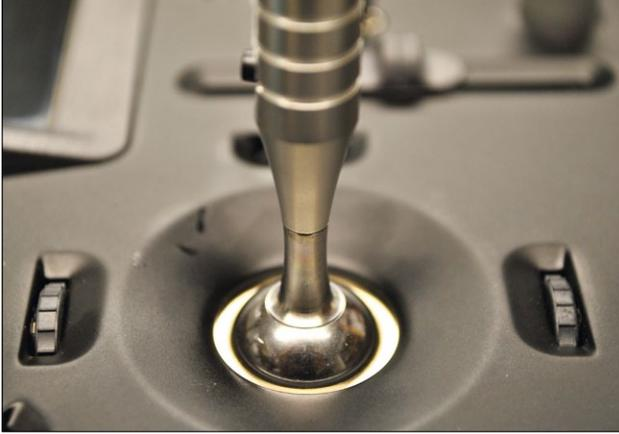
Der Knüppel ist zweigeteilt. Das Unterteil ist aus Stahl, der obere Teil aus Aluminium. Der untere Teil wird mit einem Tropfen Schraubensicherung eingesetzt
