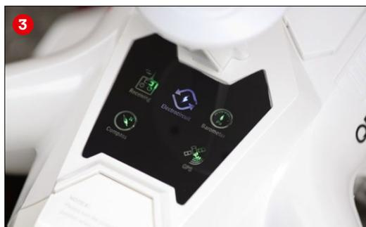
Kraftvolle Brushlessmotoren mit geringer spezifischer Drehzahl, die aber bei 8s-LiPos zu Höchstform anlaufen (1). Mit 100 Watt und 3 Ampere steht zum Laden des 8s-LiPo-Akkus genügend Leistung zur Verfügung (2). Leuchten alle fünf Symbole ist die Betriebsbereitschaft des QR X350 Premium sichergestellt (3)
