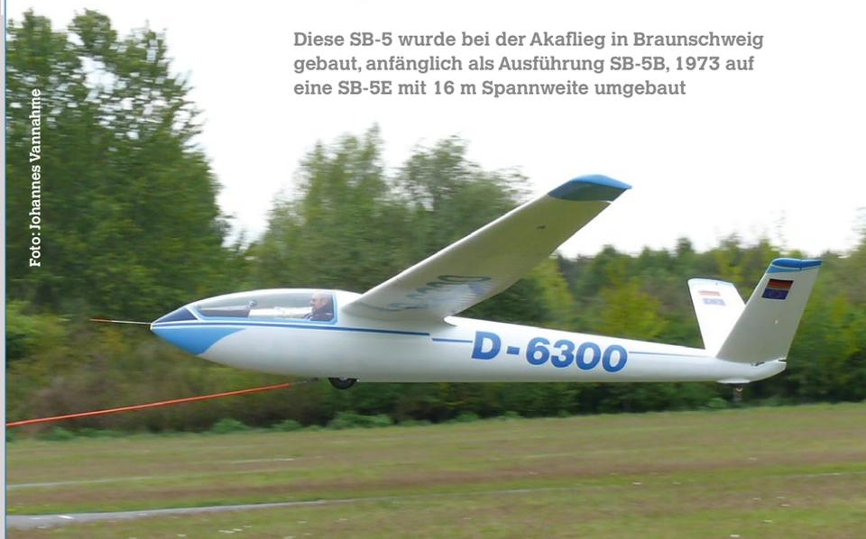
Diese SB-5 wurde bei der Akaflieg in Braunschweig gebaut, anfänglich als Ausführung SB-5B, 1973 auf eine SB-5E mit 16 m Spannweite umgebaut
