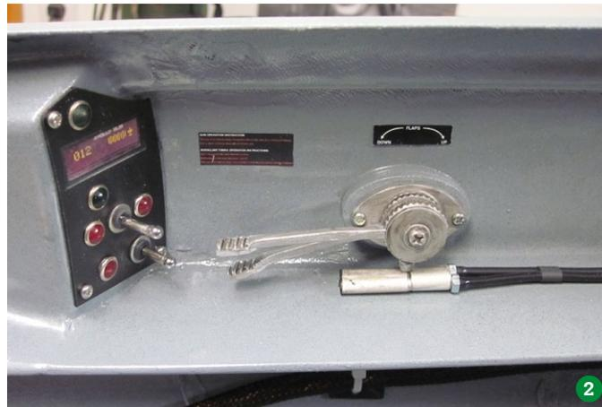
Der Gashebel an der Windex ist wieder aus diversen Restematerialien entstanden. Viele Teile, die sich zur Zweitverwertung eignen, finden sich bei Alltagsgegenständen, beispielsweise Verschlüsse von Arzneituben (1)
