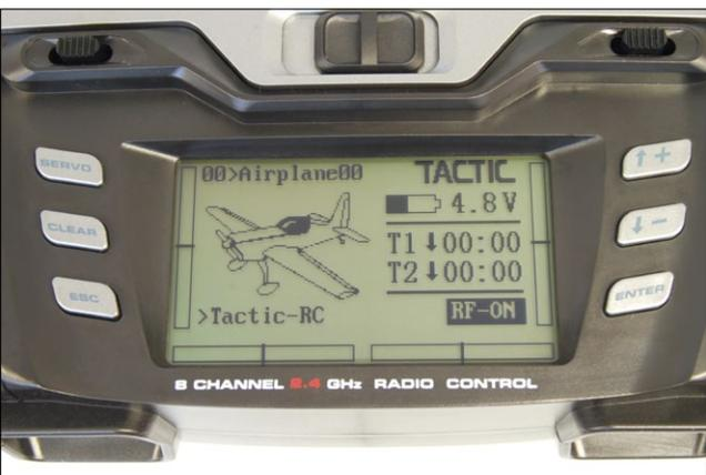
Sechs Tasten umrahmen das große LC-Display und ermöglichen eine einfache Bedienung
