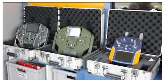
Bei weatronic drehte sich alles um den BAT60 Handsender und natürlich um den BAT64 Pultsender. Seit Kurzem gibt es ein Update mit eingebauter Sequenzerfunktion, die sich auch für den Einsatz bei Klapptriebwerken eignet
