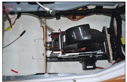
Hier gut zu sehen das rot eloxierte Aluminium und die Bremse, die durch ein Servo in der Schwinge bedient wird
