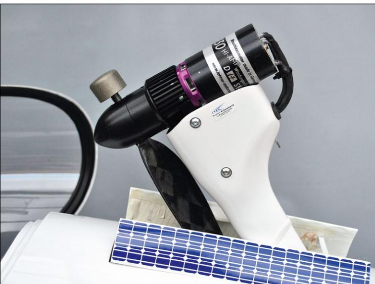
Das ATF 25 beim Ausfahren. Alles wird durch einen Schalter bedient und ist elektronisch gesteuert und gesichert
