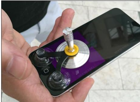
Zum Steuern wird es einen speziellen, leicht montierbaren Joystick geben
