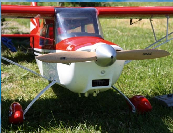
Der 30er-DLE passt mit dem Pitts-Muffler komplett unter die Haube. Lediglich ein Stück vom Zündkerzenstecker und die Auspuffrohre sieht man unten
