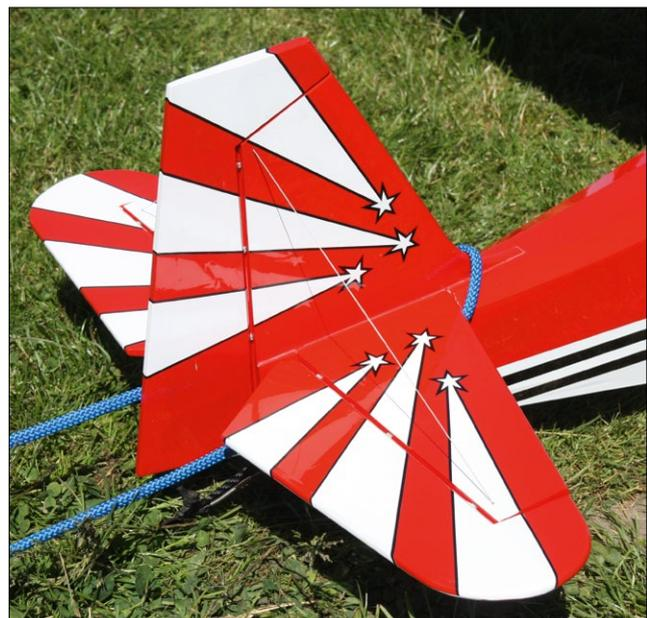
Das Leitwerk ist komplett aus Holz gefertigt und wird mit dem Rumpf verklebt
