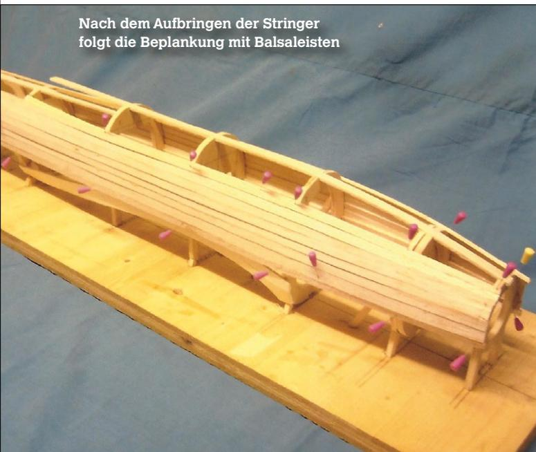
Ist der Rumpf abgenommen, kann er im unteren Bereich an die Fläche angepasst und entsprechend beplankt werden
