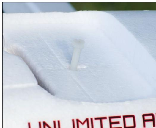
Die Aufnahme des oberen Flügels, der von nur einer Schraube gehalten wird. Durch eine Bohrung im Flügel ist die perfekt erreichbar, was den Aufbau deutlich erleichtert
