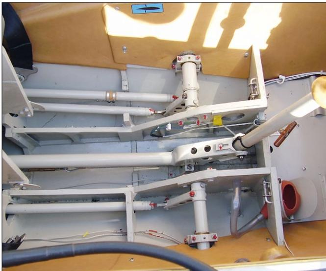
Blick auf den Steuerknüppel und das Steuergestänge der Jaskolka bei hochgeklapptem Führersitz
