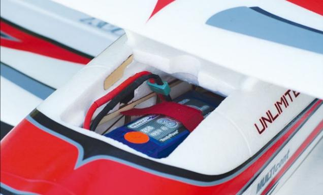
Der Akkuwechsel gelingt durch die Haube hinter der Cowling problemlos. Die Akkurutsche ist groß genug, um auch Akkus mit höherer Kapazität aufzunehmen
