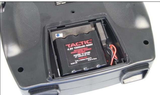
Serienmäßig wird die Fernsteuerung mit einem 4,8-Volt-Nickel-Senderakku samt Ladegerät ausgeliefert
