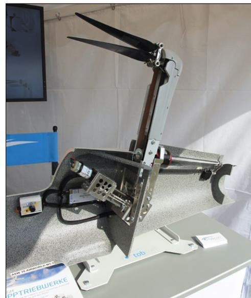
Die Firma tobcon war zum ersten Mal in Schwabmünchen und hat ein neues Klapptriebwerk in zwei Größen vorgestellt. Ein- und Ausfahren wird das Triebwerk über einen Spindelantrieb, ein Außenläufermotor treibt über eine Zahnriemen eine Klappluftschraube an
