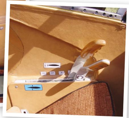
An der rechten Bordwand ist der Hebel für das Einziehfahrwerk und links sind die Handhebel für die Wölbklappen, Bremsklappen und die Radbremse
