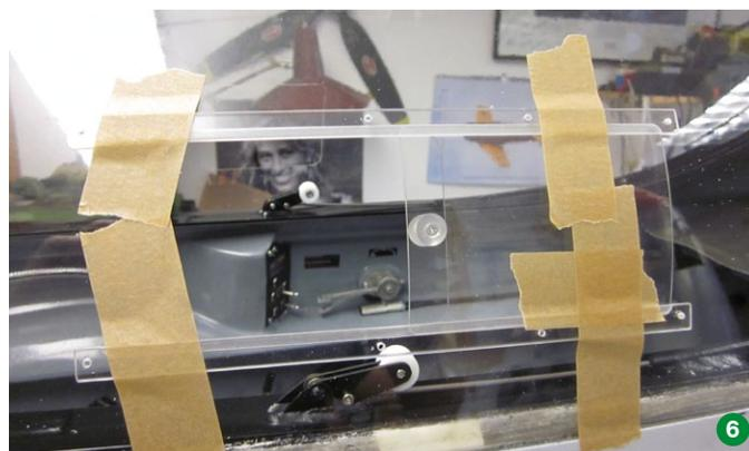
Die Leisten werden vor dem Bohren mit Tape angebracht, damit sie sich nicht verschieben. Lieber mehrmals vorher überlegen sowie prüfen und erst danach das Loch setzen (6)
