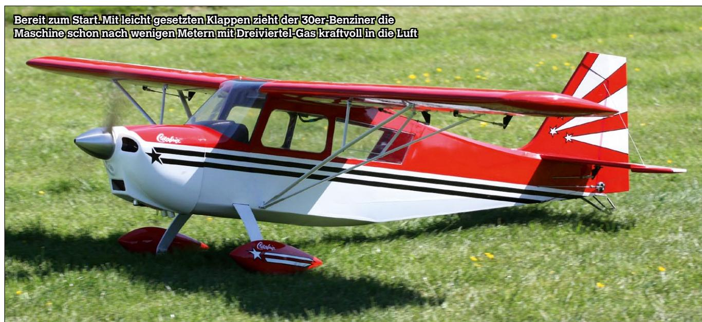
Bereit zum Start. Mit leicht gesetzten Klappen zieht der 30er-Benziner die Maschine schon nach wenigen Metern mit Dreiviertel-Gas kraftvoll in die Luft
