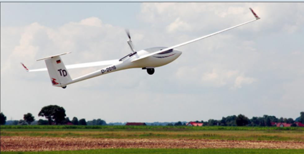
Mit der Leistung der heutigen Klapptriebwerke sind bei Bedarf sehr zügige Steigflüge möglich. Hier die große ASW-27 von tobcon
