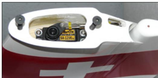
Für das Höhenruder-Servo ist die Aufnahme in der Finne des Seitenleitwerks vorgerüstet und die Durchführung des Rudergestänges passgenau gefräst. Das in Hohlkehle gelagerte Seitenruder ist mit Spaltabdeckband versehen
