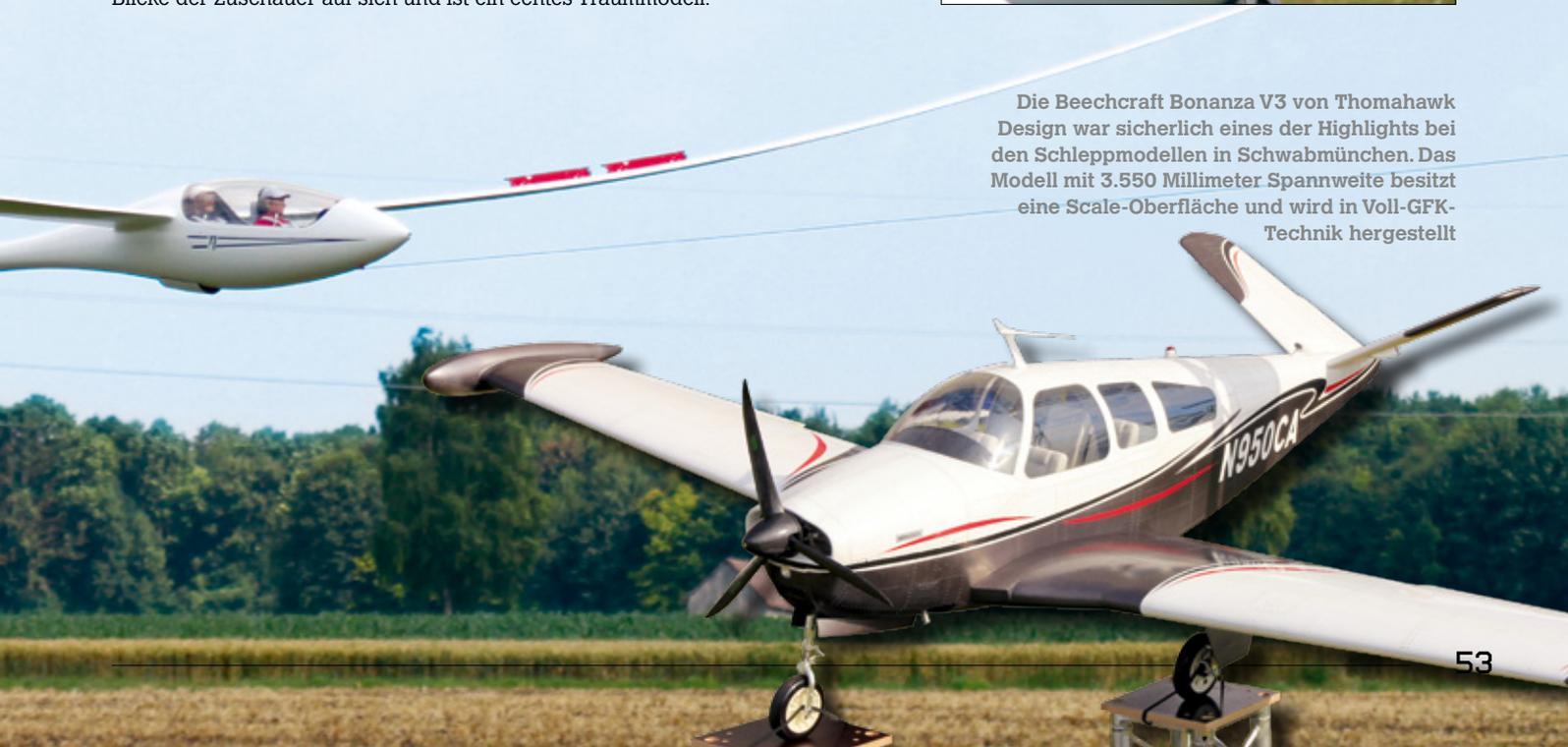
Die Beechcraft Bonanza V3 von Thomahawk Design war sicherlich eines der Highlights bei den Schleppmodellen in Schwabmünchen. Das Modell mit 3.550 Millimeter Spannweite besitzt eine Scale-Oberfläche und wird in Voll-GFK-Technik hergestellt
