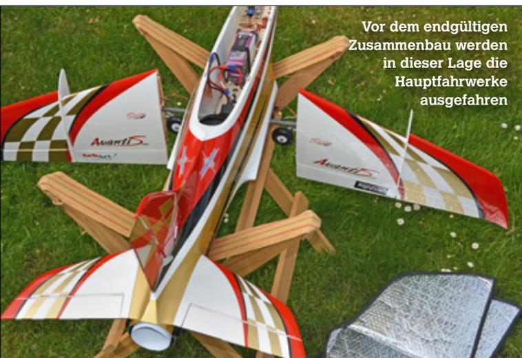
Vor dem endgültigen Zusammenbau werden in dieser Lage die Hauptfahrwerke ausgefahren
