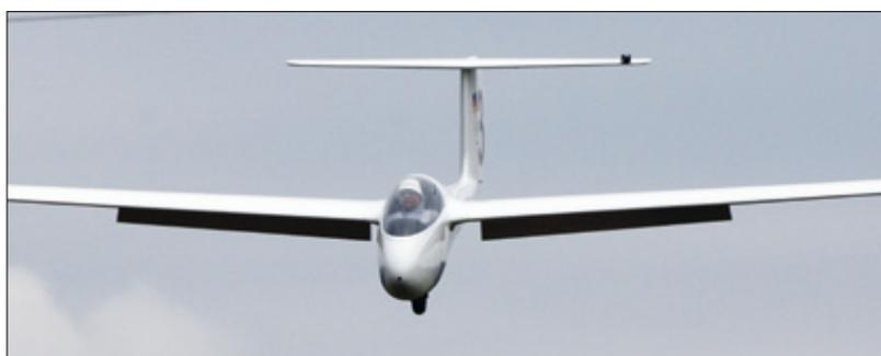
Die FS-24 Phönix T ist ebenfalls ein kompletter Eigenbau von Knut Becker. Interessant sind die Bremsklappen, die mittig unter den Flächen ausfahren. Das Original war laut Aussage des Modell-Eigners das erste serienmäßig gebaute GFK-Segelflugzeug. Es wurde von der Akaflieg Stuttgart ab 1957 bis 1961 gebaut. Die letzte Version hatte, wie das Modell, ein Einziehfahrwerk, statt Kufe. Spannweite 7.110 mm, Länge 3.040 mm, Gewicht 24,4 kg
