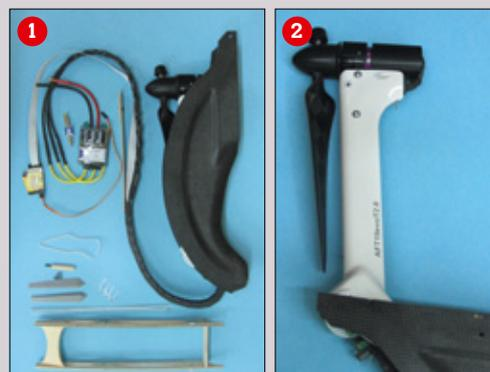
Florian Schambeck lieferte das Triebwerk, den passenden Regler und den Einbausatz. Ergänzt wird dies noch durch eine Sicherung, die im Falle eines Falles den Antriebsakku vom restlichen Antrieb trennt. Das AFT 19evo im ausgefahrenen Zustand (1). Die neue evo-Serie bietet schnellere Ausfahrzeiten und einen Schub- sowie Lärm-optimierten Propeller. Die Propellergrundstellung wird nun nicht mehr über eine Mechanik, sondern direkt über den Motorsteller realisiert (2)
