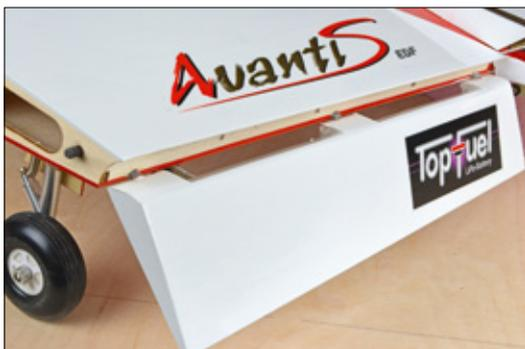
Die breiten Aussparungen in den Landeklappen sorgen für eine verbesserte Umströmung im ausgefahrenen Zustand
