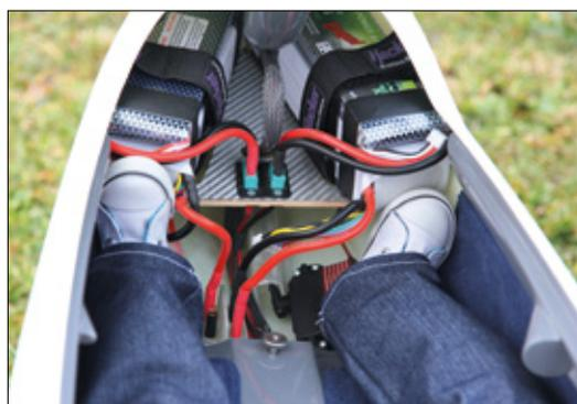
Sowohl die Antriebs- als auch die Empfängerakkus sitzen ganz vorne in der Rumpfschnauze, werden per Klettband in Position gehalten und sind somit sehr einfach herausnehmbar
