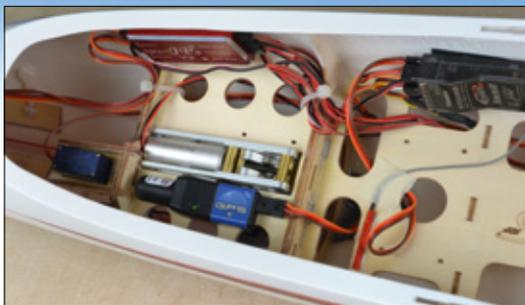
Doorsequencer, Lenkservo, Bugrad, GPS-Sensor und S-Bus-Empfänger sind im Bug platziert
