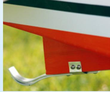
Der Sporn wurde von uns aus zwei Aluminiumstreifen angebracht und ist ein kleines Scale-Detail
