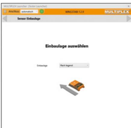
Mit Hilfe der Wingstabi-Software lassen sich alle erforderlichen Parameter festlegen, hier die korrekte Einbaulage
