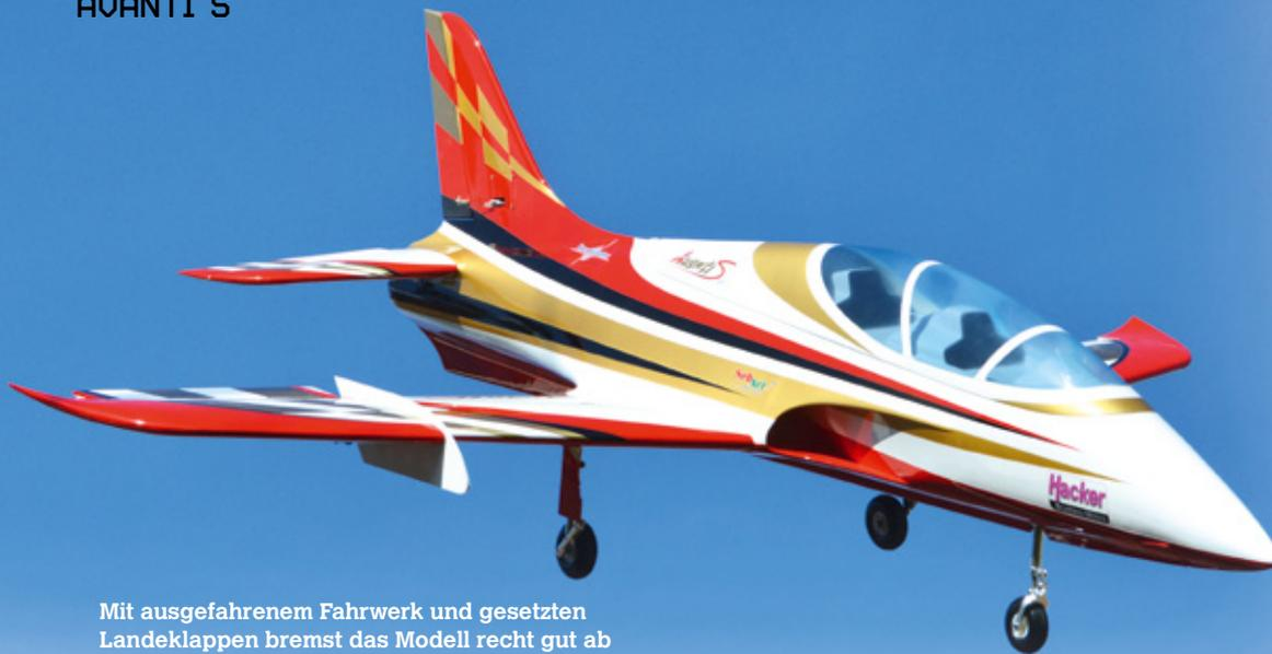
Mit ausgefahrenem Fahrwerk und gesetzten Landeklappen bremsst das Modell recht gut ab
