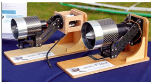
Moses-Modellbau hatte seine Jet-Flex Klappimpeller nach Schwabmünchen mitgebracht. Die Triebwerke machen einen sehr robusten Eindruck. Die Höhe ist dank Spindeltrieb stufenlos einstellbar
