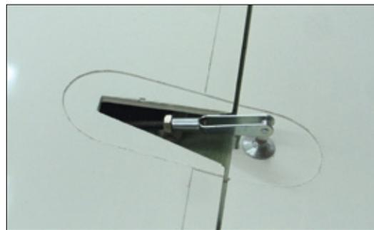
Hier die Anlenkungsgestänge, bevor die GFK-Hutzen montiert werden
