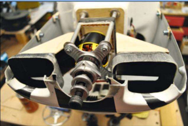
Die schon vorhandenen Kühlluftführungen des Boxers wurden erweitert und die Luft wird mittels Kästen aus Balsa auf den Scorpion geleitet.
