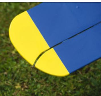
Die Auflage des Höhenleitwerks mit der Verzapfung, sodass nichts schief aufgeklebt werden kann
