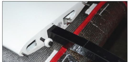
Der rund 600 Gramm schwere, massive CFK-Vierkant-Stab wurde in Metallformen laminiert und gepresst sowie an jeweils eine Seite der Flügelsteckung spielfrei angepasst. Auf der Stirnseite gedruckte „R“ und „L“ verhindern ein Verwechseln
