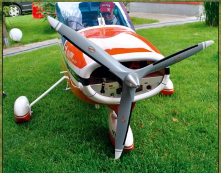
Der Falcon-Propeller wurde nach dem erfolgreichen Test lackiert. Er liefert Kraft zum Schlepp von Seglern mit über 6.000 Millimeter Spannweite
