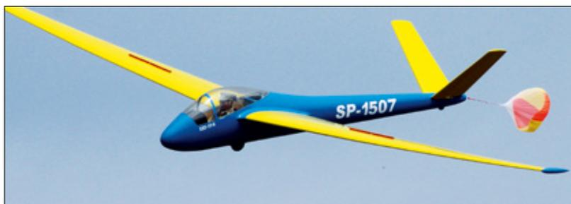
Ein weiterer gelungener Eigenbau von Herman Fading aus Wächtersbach ist Uli Richters SZD-17-X, ein Nachbau des optisch interessanten polnischen Segelflugzeugs von 1960 im Maßstab 1:2,5. Eine Besonderheit im Segelflug ist der Bremsfallschirm, der hier beim Modell per Fernsteuerung ausgelöst wird. Spannweite 6.800 mm, Länge 2.900 mm, Gewicht 14,5 kg
