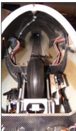
Die Fahrwerksklappen sind fertig montiert und können mittels herausziehbarer Drehachse demontiert werden. Der Rumpf ist im Bereich von Fahrwerksaufnahme und Steckung bis in das Dach hinein mit CFK-Rovings beziehungsweise CFK-Gewebe verstärkt.
