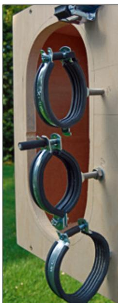
Mit Hilfe von M8-Gewindestangen können die vorderen Rumpfhalter exakt justiert werden
