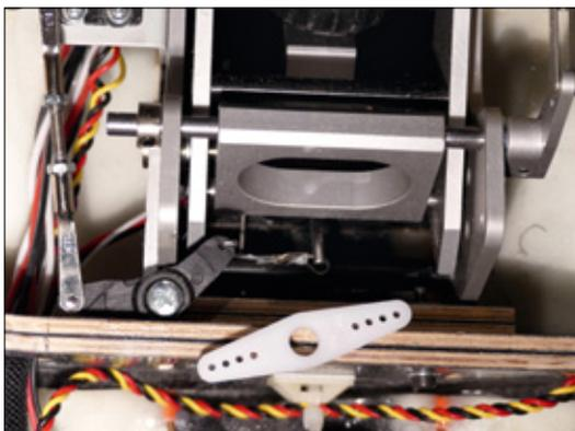
Das FEMA-Fahrwerk lässt sich im Nachhinein mit einer Bremse ausrüsten. Um dem im Brems-Kit enthaltenen (weißen) Umlenkhebel für den Seilzug der Bremse genügend Bewegungsraum zu geben, wurde ein passender Umlenkhebel aus einer Servo-Scheibe angefertigt
