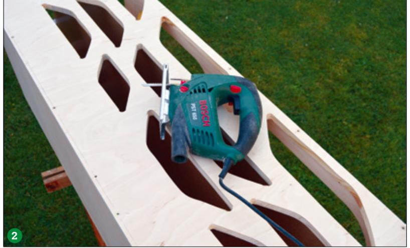
Die Längsnuten werden mit einer Oberfräse, die an der Richtlatte entlang geführt wird, eingebracht (1). Mit einer Stichsäge werden die Platten „erleichtert“ (2). Zum Schluss wird der vordere Abschlussdeckel angeschraubt (3). Die Kiefernleiste hält die Einlegeböden in Position (4)
