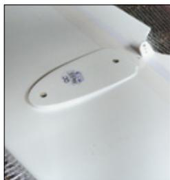
Bei den aktuell lieferbaren CARF-DGs läuft die Auflagefläche des Höhenleitwerks nach hinten keilförmig aus. Dadurch wurde eine Verringerung der EWD um 0,7 Grad erreicht, die zugleich rund 400 Gramm Ballast in der Rumpfnase erspart
