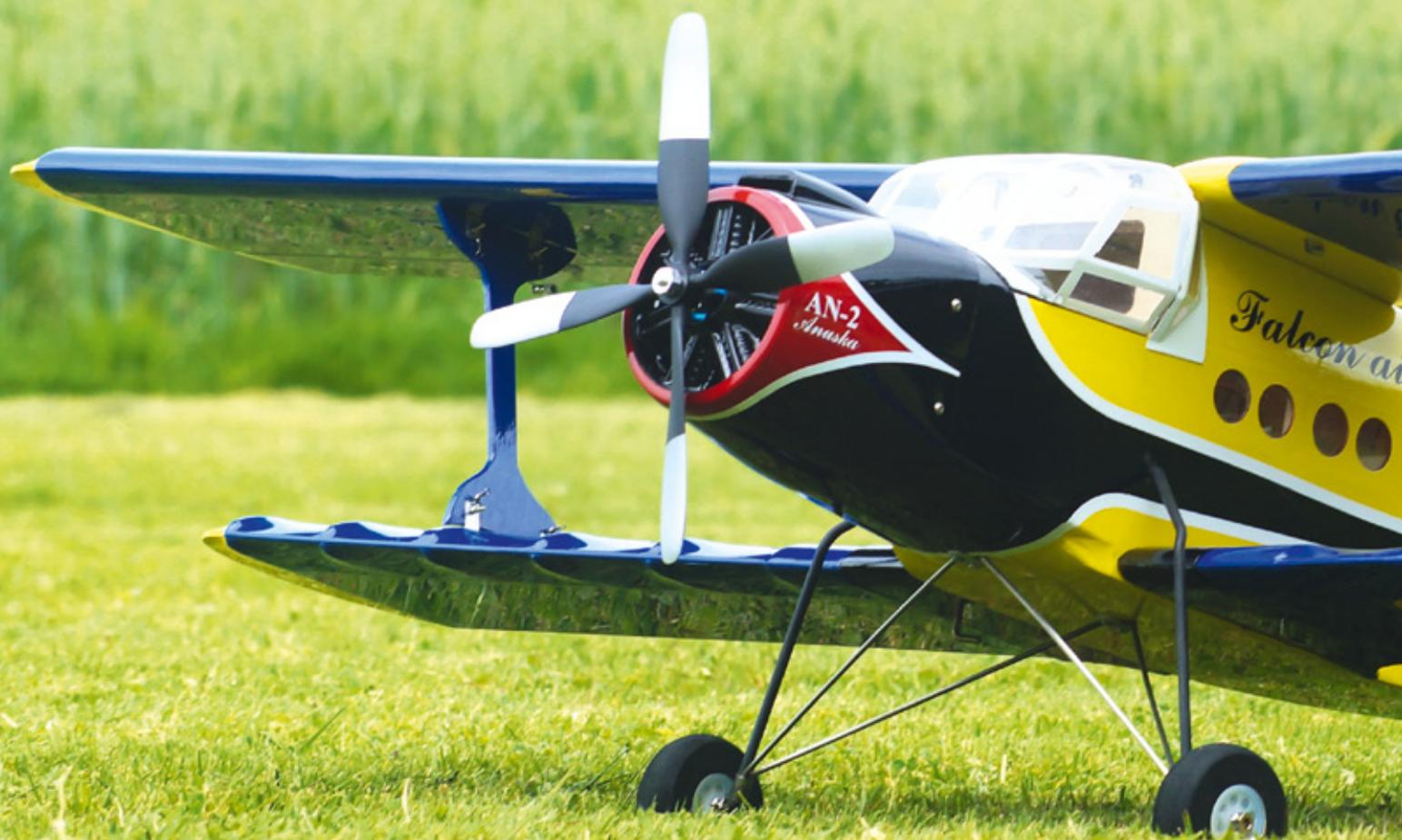
Rund 1.600 Millimeter (mm) Spannweite klingen viel, gerade bei einem Doppeldecker, aber bei der AN-2 ist das gerade mal ein Maßstab von 1:11 und nicht 1:3,5 wie bei einer Pitts – die dann ohnehin voluminöser ausfallen würde. Dementsprechend fallen Rumpf und Flächen recht schlank aus und viel Leistung braucht unsere Anushka auch nicht, denn Kunstflug verbietet sich bei einem solchen Modell einfach.
