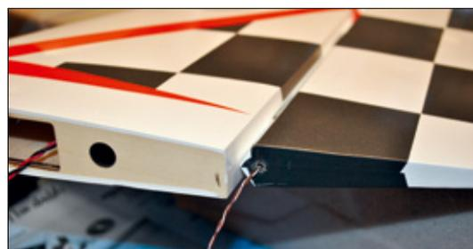
Das Kabel für die Seitenrunderbeleuchtung wurde unten herausgeführt und verläuft im Rumpf nach vorne
