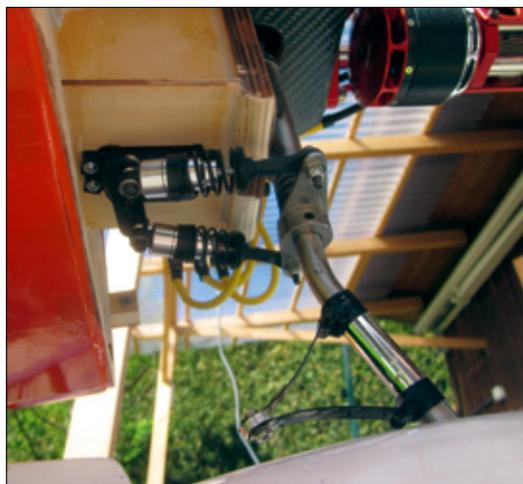
Die Anlenkung des Bugrads wurde von uns nachträglich mit zwei Stoßdämpfern aus dem RC-Car-Bereich versehen, damit die harten Schläge nicht direkt auf das Servo geleitet werden
