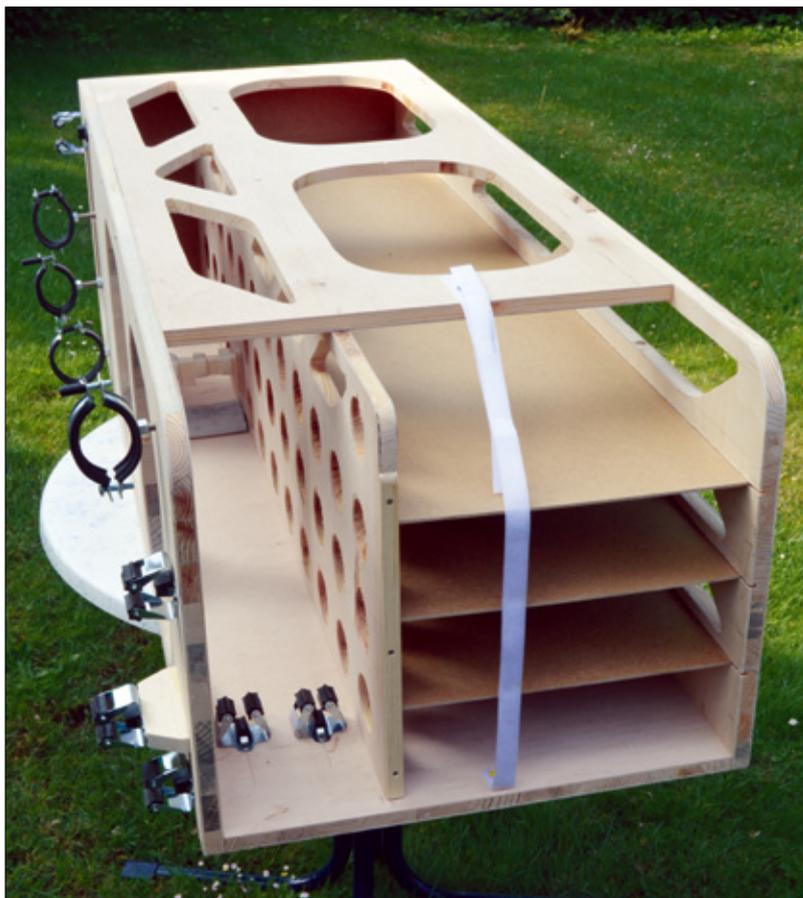
Fertig zum Verladen. Das weiße Klettband verhindert ein Herausrutschen der Tragflächen nach hinten
