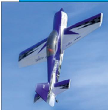
Mit 1.120 Millimeter Spannweite gehört die aus dem Hartschaum Z-Foam erstellte Sukhoi Su-29MM Gen.2 zu den handlichen Aerobatik-Modellen. Ausgerüstet mit einem 3s-LiPo wiegt sie 1.150 Gramm. Zum Lieferumfang des 259,99 Euro kostenden BNF-Modells gehören ein Brushless-Antrieb, installierte Servos und ein AS3X-Empfänger mit implementierter Kreiseltechnologie. [www.horizonhobby.de](http://www.horizonhobby.de)
