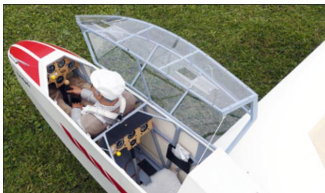
Ein Scale-Segler von Gerhard Schmolh in Spitzenausführung ist das Modell der Mü 13 Bergfalke II von 1955. Der Rumpf ist, wie beim Original, in Gittertechnik aufgebaut. Ein Blick in das Cockpit ist eine wahre Freude! Selbst das Lammfell auf dem hinteren Sitz und die Karte in der Seitentasche sind vorhanden
