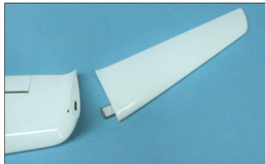
Die Winglets werden in eine Tasche am Außenflügel geschoben und dort mit einer kleinen Madenschraube geklemmt
