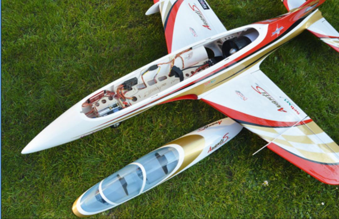
Durch die große Kabinenhaube kommt man an sämtliche Komponenten, inklusive Triebwerk, hervorragend ran
