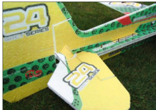
Die Höhenrunderklappe wird durch ein Carbon-Profil gegen Torsion zusätzlich ausgesteift, das Ruderhorn ist im direkten Anschluss daran verklebt
