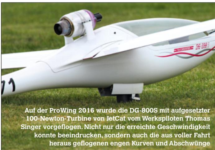
Auf der ProWing 2016 wurde die DG-800S mit aufgesetzter 100-Newton-Turbine von JetCat vom Werkspiloten Thomas Singer vorgefliegen. Nicht nur die erreichte Geschwindigkeit konnte beeindruckend, sondern auch die aus voller Fahrt heraus geflogenen engen Kurven und Abschwünge
