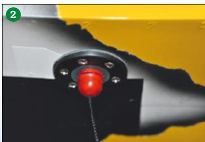
Der Roxxy-Regler, die aktuellen Versionen werden über Multiplex im Fachhandel vertrieben, kann mit einem eigenen Kühlventilator aufwarten (1). Der Sicherheitsschalter von Emcotec sitzt an der Stelle, an der vorher der Tankverschluss seinen Platz hatte (2)
