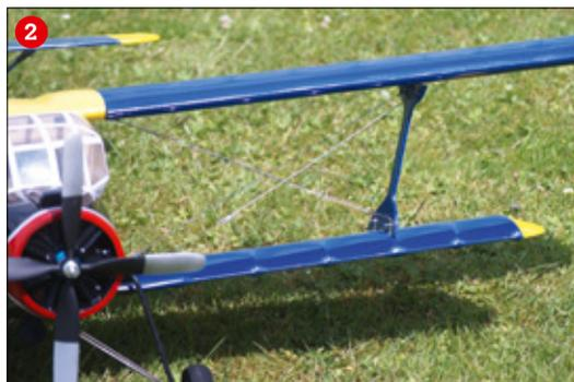
Damit die Flächenhälften beim Transport nicht leiden, liefert der Hersteller sogar Abstandshalter aus Sperrholz mit (1). Es geht auch ohne sie, aber die Verspannung mit Stahldraht erhöht den Scale-Charakter des Modells (2)
