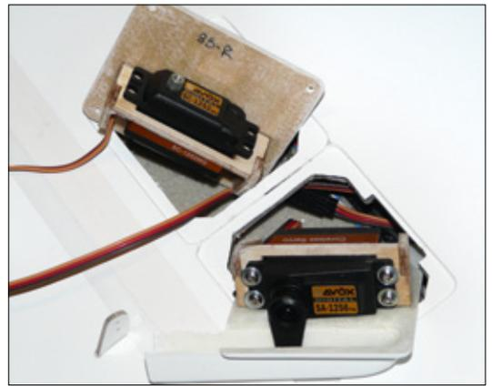
Die Standard-Servos von Wölbklappen und Störklappen werden direkt mit den Deckeln verschraubt. Hierfür sind auf deren Innenseiten Servohalter aus Sperrholz verklebt. Der Übergang zum jeweiligen Deckel ist mit GFK-Gewebe verstärkt
