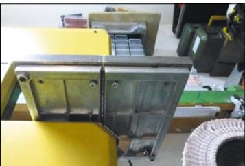
Schrauben fixieren die Platte. Die Maßnahme reduziert die Geräuscentwicklung
