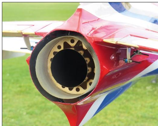
Die Halterung des Schubrohrs besteht aus einem GFK-Tubus sowie CNC-gefrästen Sperrholzlamellen und gehört ebenfalls zur Bausatzausstattung
