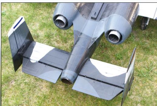
Der tatsächliche Turbinenstrahl tritt aus dem sonst verschlossenen Rumpfbürzel der A-10 aus
