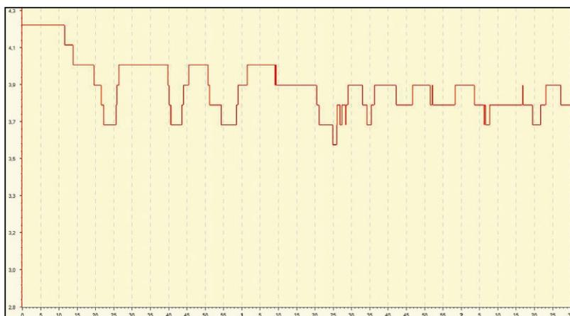
Steckt man einen leeren Akku an, zeigt der Sender direkt 5% Tank an und schlägt Alarm. Kurz danach wird die niedrigste Einzelzellenspannung angezeigt, in diesem Fall 3,5 Volt
