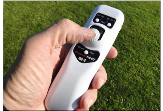
Der mz-4 HoTT-Einhandsender verfügt über zehn Modellspeicher und eine Telemetriefunktion
