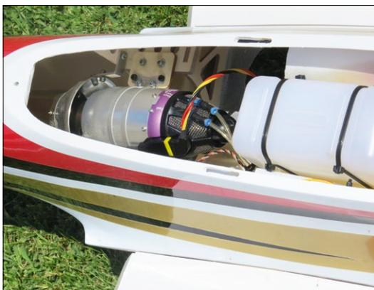
Turbine und V2A-Schubrohr sind hinter dem Tank eingebaut. Alle Befestigungselemente sind im Bausatz enthalten
