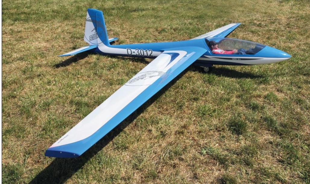
Immer wieder sehr schön sind die überaus aufwändig designten Kunstflugsegler. Hier der große Swift mit 5.000 Millimeter Spannweite von DG Flugmodellbautechnik
