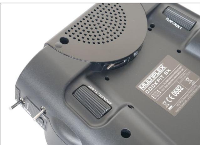
Rückwärtig integriert befinden sich zwei Drehgeber und der Lautsprecher für die Sprachausgabe. Die Antenne ist im Gehäuse eingelassen
