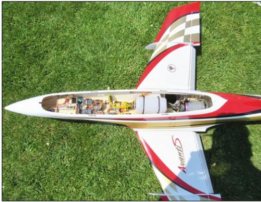
Im Rumpf der Mini Avanti ist viel Platz für Empfänger, Kreisel, Turbinen Control Unit, Kerosinpumpe, Tank und die JetCat P20-SX Turbine
