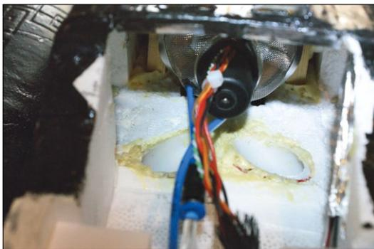
Verbindungsrohre zu den eigentlichen Triebwerksgondeln dienen der Luftzufuhr, bringen aber durchs Ansaugen auch die Schaufelattrappen zum Drehen
