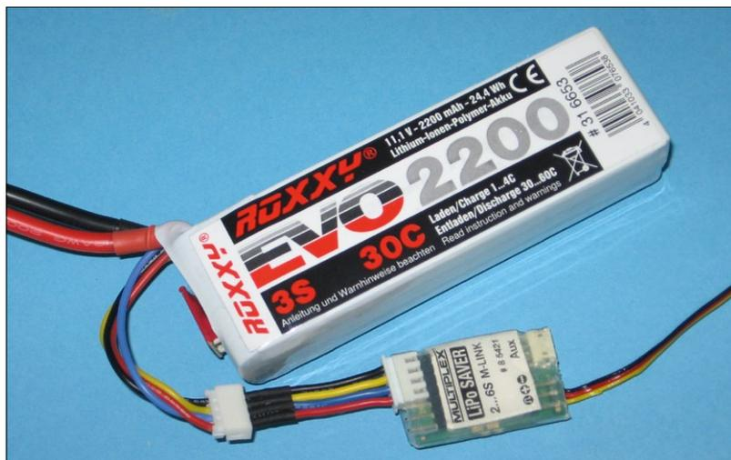
Der LiPo-Saver wird über den Balancer-Anschluss an 2- bis 6-zellige LiFe-, LiPo- oder LiIon-Akkus angeschlossen
