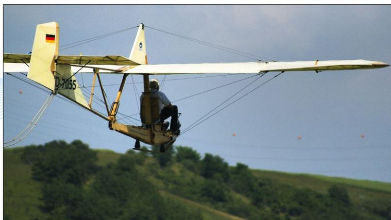
Begonnen wurde im letzten Beitrag mit der Kufe als einfachstes Fahrwerk. Da Kufen üblicherweise im gesamten vorderen Bereich des Rumpfs angebracht sind, ist ihre Positionierung am unkritischsten. Sie reicht von der Rumpfnase beziehungsweise dem Punkt des Rumpfs, der erwartungsgemäß den Boden berühren kann, bis unter die Tragfläche – vorzugsweise sollte sie in der Höhe der Endleiste enden. Hierbei gibt es also nicht viel zu beachten; siehe Abbildung 1.
