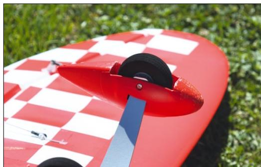
Das federnde Fahrwerk passt sehr gut zum Modell, einzig die Radpuschen aus Hartschaum lassen dauerhaften Gebrauch sichtbar werden
