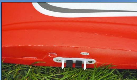
Sehr komfortabel sind die fest integrierten Buchsen und Stecker für die Flächenservos. Sie sorgen auch für eine sichere Verbindung
