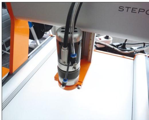
Bedingt durch den WZW-Aufsatz ragt die fertige Einheit noch etwas höher über das Portal hinaus. Dies sollte man beim Eigenbau von Umhausungen auf jeden Fall mit einplanen
