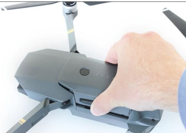
Angetrieben wird der Mavic von einem 3s-LiPo. Die Leistung reicht für eine Flugzeit von rund 25 Minuten
