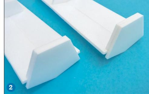
Der Spant, der mit seiner Stufe den vorderen zum hinteren Bereich abtrennt, wird aufgedoppelt. Alle Verklebungen erfolgen mit UHU por, und zwar besonders sorgfältig, damit alles hinterher wasserdicht wird. (2)
