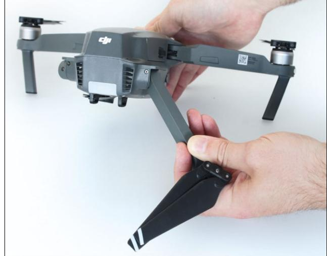
Einfach die Ausleger entfalten und schon ist der Mavic startbereit: Der Clou, die Props braucht man nicht lösen
