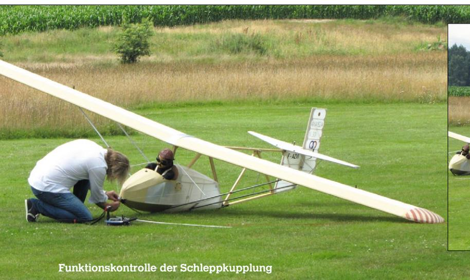
Funktionskontrolle der Schleppkupplung
