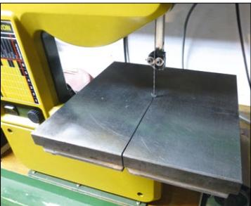
Die 20 Millimeter dicke Stahlplatte liegt auf der vorhandenen Alu-Platte auf
