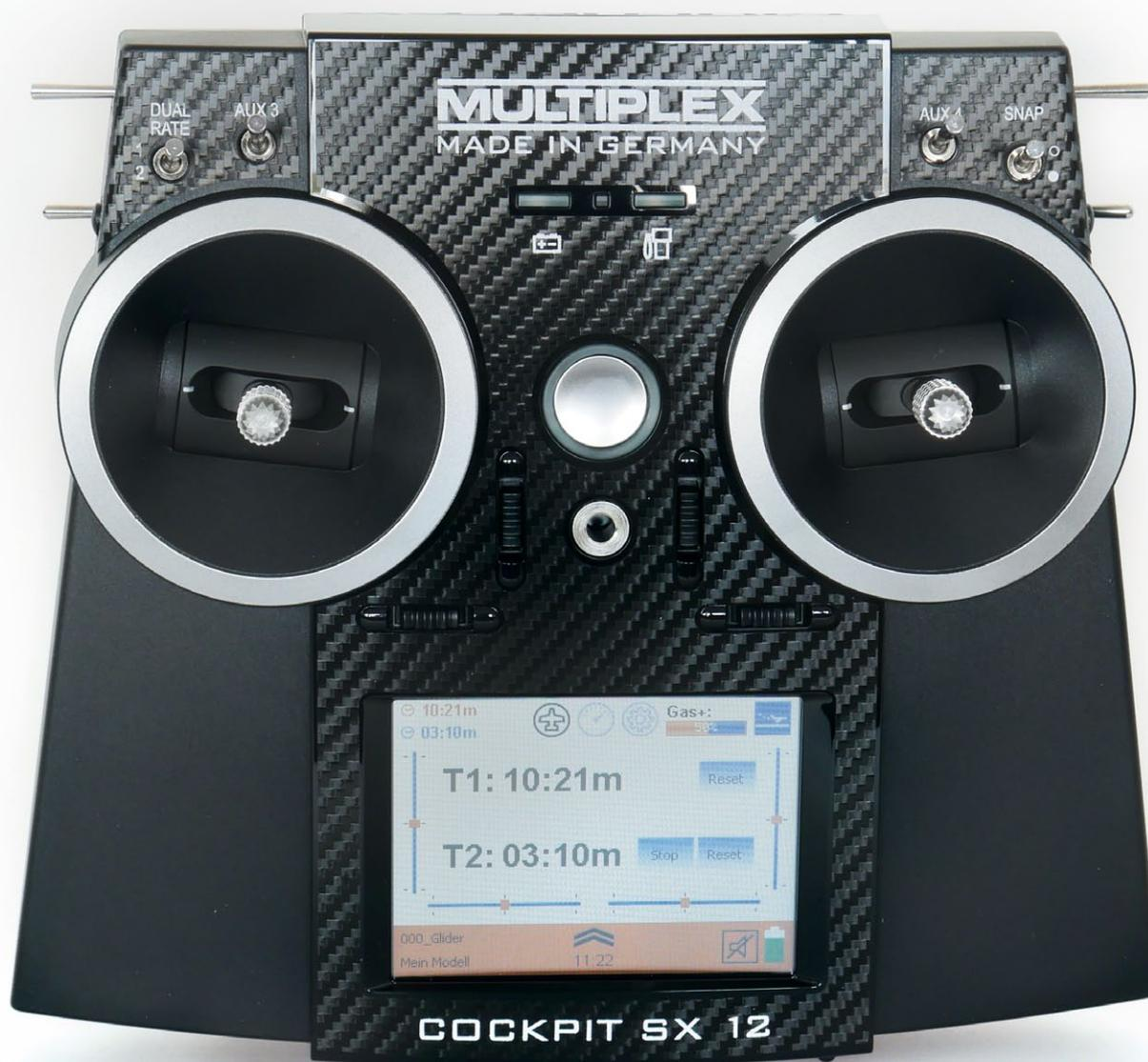
Auf dem Markt haben sich die modernen Multiplex-Handsender Cockpit SX7 und SX9 längst etabliert. Mehr als neun Kanäle und damit Steueroptionen lassen sich diesen aber nicht entlocken. Gewünscht und gesucht war der gleiche RC-Typ mit mehr Steueroptionen – dem trägt die neue Cockpit SX12 Rechnung.
