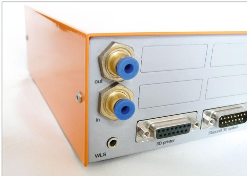
Die Rückseite der fertig aufgebauten Umschaltbox beherbergt auch die Anschlüsse für das Pneumatik-Ventil zum Ansteuern des WZW. Der Anschluss für den optional ebenfalls anschließbaren Werkzeuglängensensor komplettiert die praktische Box
