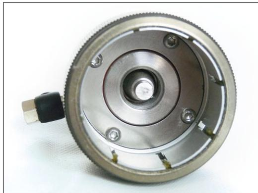
Die Montage der WZW-Einheit erfolgt rasch am Außengewinde der HF-Spindel, wobei die Kraftübertragung über einen Morsekegel erfolgt, welcher spielfrei in sein Gegenstück der HF-Spindel gleitet
