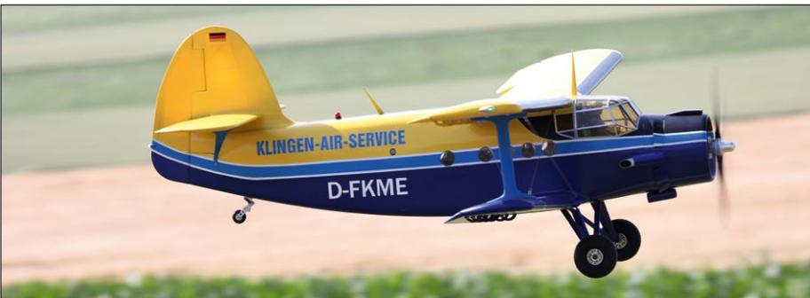
Die einzige Einmotorige unter den Airlinern war die Antonow AN2 von Clemens Klingen aus Dormagen. Der 3.800 mm spannende, 1.620 mm lange und 8.500 g wiegende Doppeldecker wird von einem E-Motor Hacker A60 absolut ausreichend angetrieben
