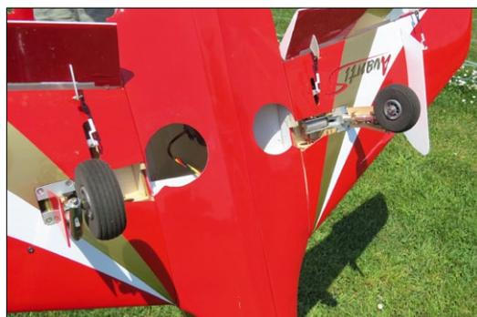
Das elektrische Alu-Hauptfahrwerk und die Räder sind bereits herstellerseitig im Flügel montiert. Die im Bausatz enthaltenen GFK-Ruderhörner samt Rudergestänge übertragen den Servoausschlag präzise auf die Ruderflächen
