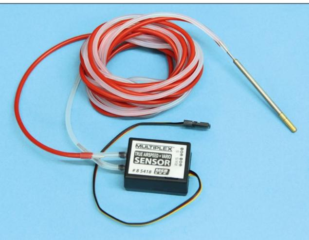
Der Speedsensor besteht aus der eigentlichen Auswerteelektronik, der Prandtl-Sonde und den jeweils 2,5 Meter langen Verbindungsschläuchen
