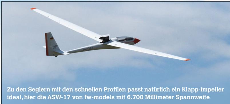
Zu den Seglern mit den schnellen Profilen passt natürlich ein Klapp-Impeller ideal, hier die ASW-17 von fw-models mit 6.700 Millimeter Spannweite
