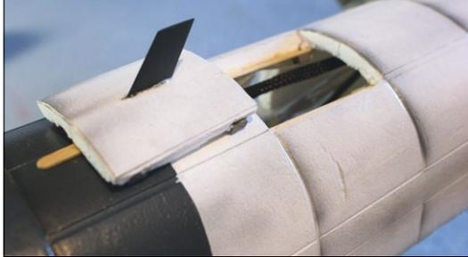
Zum Erkennen des Füllstands des Tanks dient eine Wartungs-klappe im Rumpf
