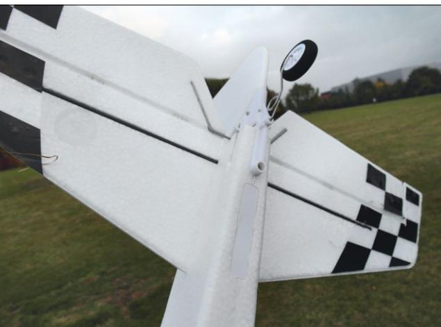
Die Kombination von Schaumstoff, Hartkunststoff und Kohlefaser funktioniert gut. Vor dem Heckrad gibt es eine Ballastkammer, die aber nicht benötigt wurde
