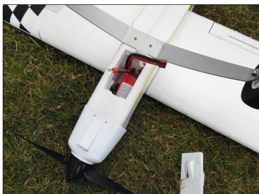
Der Akku wird durch eine gut zugängliche Klappe im Rumpfboden gewechselt
