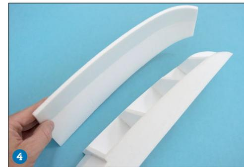
Da die Schwimmer eine Kielung besitzen, was das Anwassern etwas dämpft und die Spurstabilität erhöht, haben alle unteren Beplankungsteile eine rechte und linke Seite. Vorne muss vorgewölbt werden. (3)
