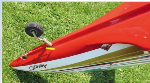
Hauptfahrwerk und lenkbares Bugfahrwerk fährt der mitgelieferte Doorsequenzer zuverlässig ein und aus. Es wird nur ein einziger Empfängerkanal benötigt
