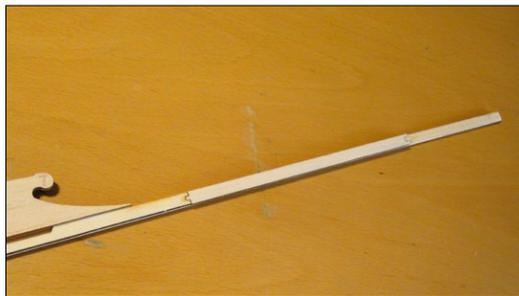
An die Rumpffeule klebt man die Außenseite des Leitwerksträgers an und setzt dann das Innenteil aus Balsa ein
