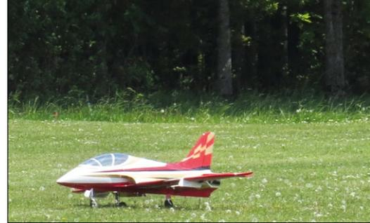
Das verwendete Flügelprofil macht die Landung zum Kinderspiel: Landeklappen setzen, durchsacken lassen, Flare out und schon setzt der Mini Avanti butterweich auf
