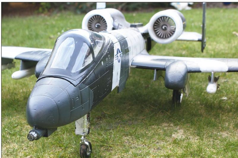
Das Lanxiang-Modell der A-10 flog jahrelang mit Wemotec-Impeller und wurde jetzt auf verdeckten Turbinenantrieb umgerüstet
