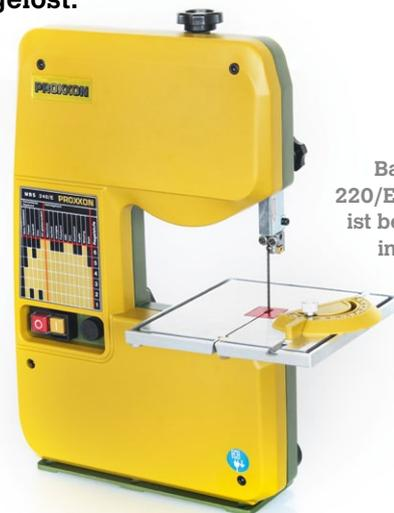
Die für Modellbauer geeignete Bandsäge MBS 220/E von Proxxon ist beispielsweise in Baumärkten erhältlich
