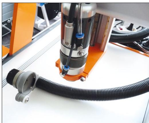
Einige Zusatzgeräte, wie die Staubabsaugung, lassen sich zusammen mit dem WZW nicht mehr unbedingt einsetzen, da die Wechselfunktion dadurch gestört wäre
