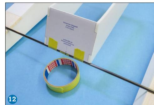
Markieren Sie an beiden Schwimmerstreben exakt die Mitte. Nun wird das Schwimmer-Hilfsgestell aufgesetzt und mit Klebeband fixiert. Wenn Sie stets halbwegs exakt gearbeitet haben, sollte das Gestell genau passen. (12)
