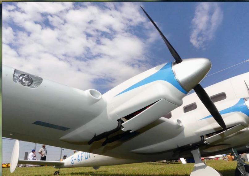
Die Lufteinlässe des Modells sind wie beim Original aufgebaut und dienen dem Elektroantrieb als Kühlung. Diese Freiformkanäle sind im CAD-Programm konstruiert und mittels eigenem 3D Drucker hergestellt worden
