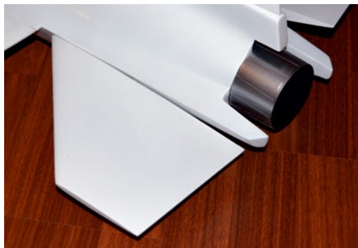
Gesteuert wird der Mako XS alleine über die Tailerons. Sie liegen perfekt am Rumpf an
