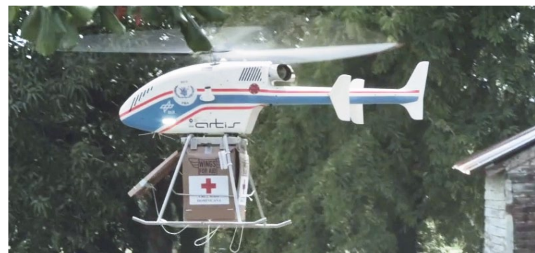
Der Koaxialhelikopter superARTIS dient zum Transport von Hilfsgütern in beispielsweise Katastrophengebieten
