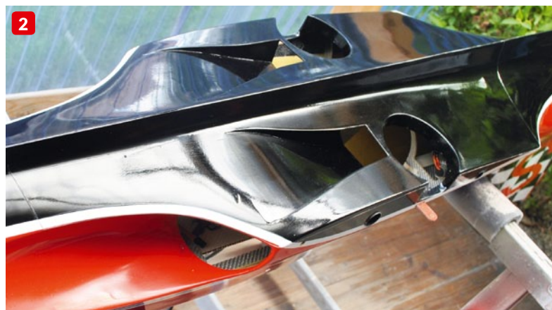
Ein Open-Duct-Impeller-System lebt von der zugeführten Luft. Zu diesem Zweck wurde der Rumpf auf Höhe der beiden Hauptfahrwerkslöcher aufgeschnitten und um zwei NACA-Luftzuführungen erweitert. Das gelingt mit etwas Sorgfalt sehr einfach (1 und 2)
