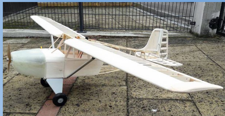
Der Aufbau der SF-23 im Maßstab 1:5 erfolgte in klassischer Balsa-Sperrholz-Bauweise
