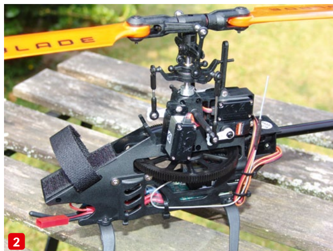
Ansicht von rechts: Das Chassis ist klar strukturiert und bietet viel Platz. Der Flugakku ist vorne mit Klettband befestigt. Man beachte die Rippen als Anschlag für Freigängigkeit des Nickservo-Hebels (1). Die Kabel sind ab Werk sauber verlegt und können nicht in den Antrieb geraten (2)
