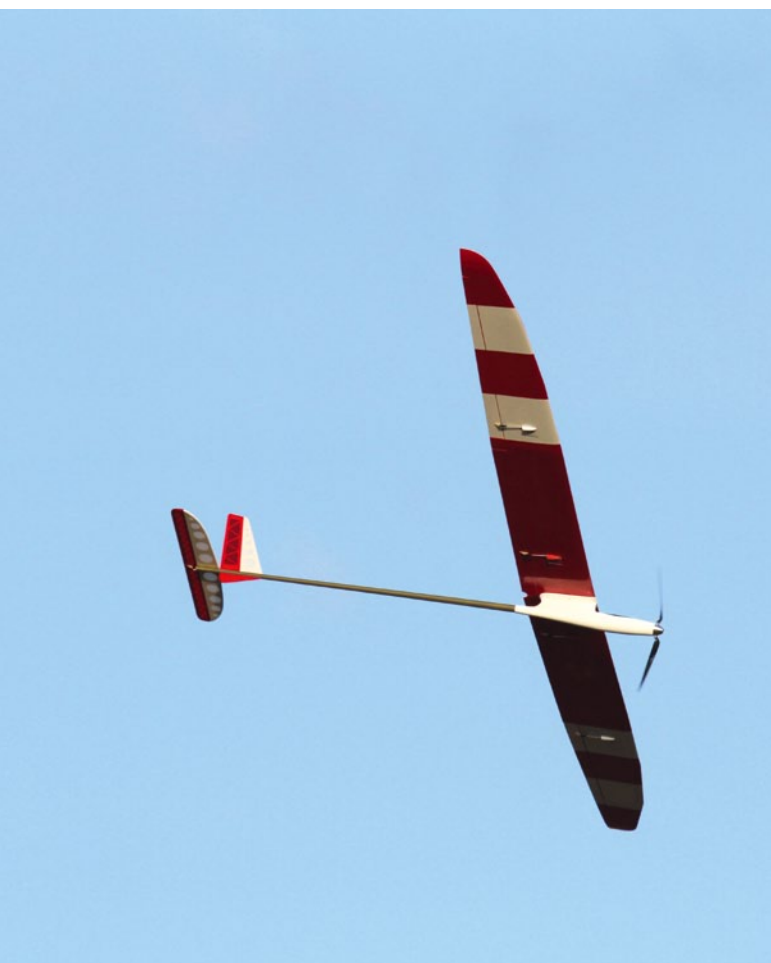
Abbildung 14: Ein Pylon als Tragflächenträger sieht wenig elegant aus, reduziert aber die Tragflächen-Rumpf-Interferenz weitgehend
