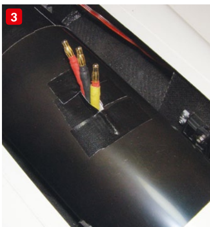
Mittig das Akkubrett, links der Empfänger, rechts die Fahrwerkssteuerung, vorne das Bugradservo (1). Zum Herausführen der Motor-Kabel aus dem Schubrohr sind die drei mit einem stabilen Formteil ummantelt, der der Wirbelbildung vorbeugt und wenig Schubenergie vernichtet (2+3)
