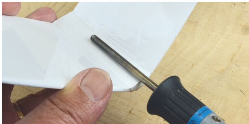
Das schmale Mittelteil lässt sich gut mit einem einstellbaren Feinlötkolben bei dem die Lötspitze entfernt wurde „bügeln“
