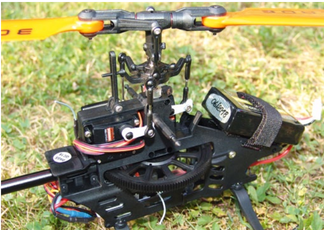
Das Hauptzahnrad wurde bei der V2 stabiler ausgeführt. Die Antennenenden sind räumlich weit voneinander getrennt und im 90° Winkel ausgerichtet.
