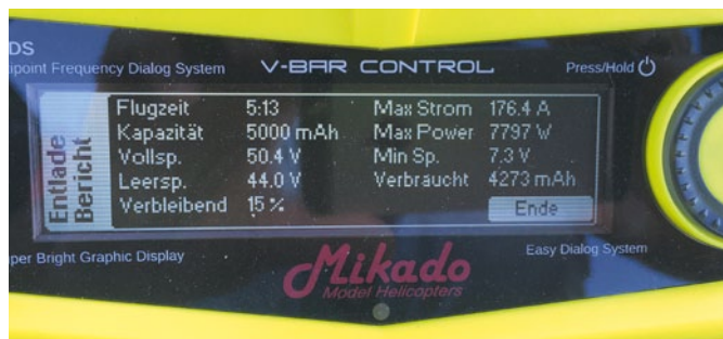
Wie sich zeigt, haben die Maniax-LiPos auch nach dem 4.000-mAh-Alarm noch richtig Druck
