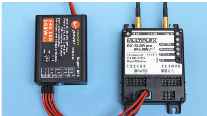
Die vier Anschlusskabel werden passend zum Empfänger konfektioniert, in diesem Fall erfolgt die Stromversorgung des Empfängers über einen grünen MPX-Hochstromstecker
