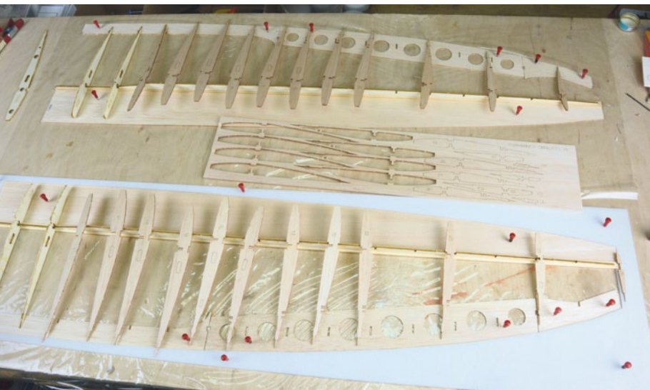
Liegen sämtliche Rippen bereit, kann mit dem Verkleben begonnen werden
