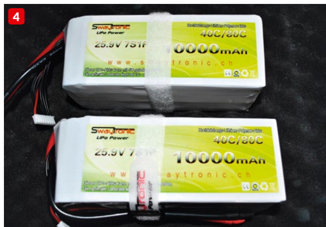
Da sich der Impeller offen im Rumpf befindet, saugt er auch alles an. Dementsprechend sind im Rumpf alle – wirklich alle – Teile absolut sicher zu befestigen (3). Mit 10.000 Milliamperestunden haben die 2 x 7s-LiPos von Swaytronic nicht nur eine hohe Kapazität, sondern bieten bei 40C/80C auch eine sehr hohe Entladerate (4)
