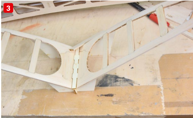
Die Rumpfteile werden verklebt. Dabei ist darauf zu achten, dass sie exakt gleich ausgerichtet sind (1). Die stabile Mittelkonstruktion des Rumpfs passt genau (2). In der Helling werden die Leitwerke verklebt (3). Mit Feile und Schleifpapier werden die „Brennkanten“ versäubert (4)
