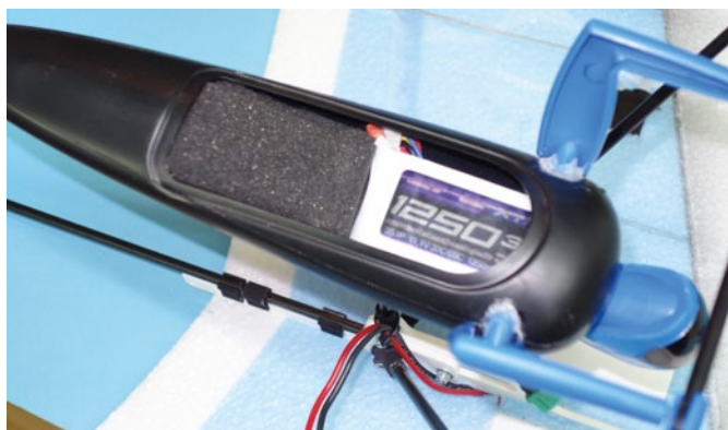
Im Rumpf des Piloten hat der Antriebsakku Platz genommen. Später wurde der Akku innerhalb des Piloten noch etwas nach hinten verlegt
