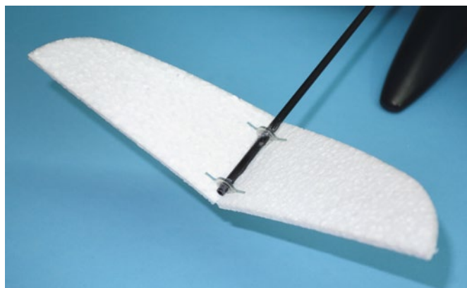
Aus einer Handvoll Einzelteilen entsteht das abnehmbare, starre Leitwerk
