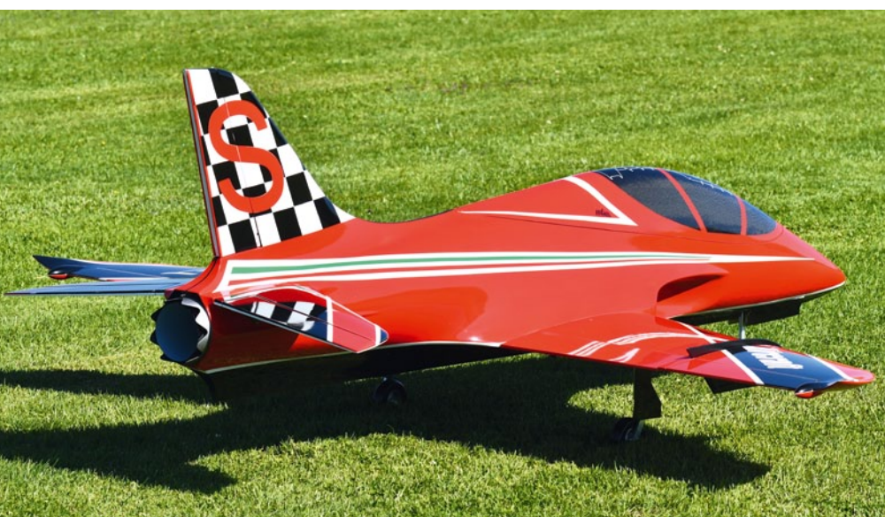
Bei laufender Turbine würde normalerweise im Bild das klassische Hitzeblimmern zu sehen sein, das entfällt beim E-Impeller. Das ist aber nicht der einzige Unterschied. Vorteilhaft ist beispielsweise auch die moderate Geräuschemission
