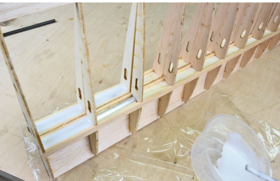
Mit angedicktem Epoxy werden die Aluröhrchen der Flächensteckung vergossen
