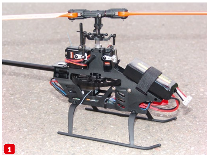
Ansicht von rechts: Das Chassis ist klar strukturiert und bietet viel Platz. Der Flugakku ist vorne mit Klettband befestigt. Man beachte die Rippen als Anschlag für Freigängigkeit des Nickservo-Hebels (1). Die Kabel sind ab Werk sauber verlegt und können nicht in den Antrieb geraten (2)
