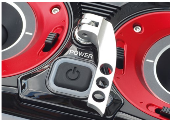
Der Power-Knopf kann jetzt durch den LED-Ring visualisieren, ob der Sender eingeschaltet ist oder der Ladevorgang noch läuft
