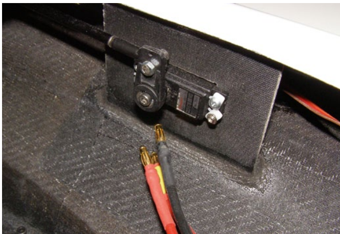
Mit dem DES 678 BB MG von Graupner ist ein absolut stellgenaues, kräftiges Servo zur Steuerung im Einsatz
