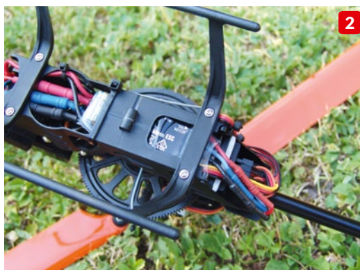
Als Taumelscheibensensor kommt die spezielle Heli-Version H3050 von Spektrum zum Einsatz (1). Der Dual Drehzahl Controller des 230S V2 steuert in einem Gerät Haupt- und Heckrotor mit einer überarbeiteten Software an (2)
