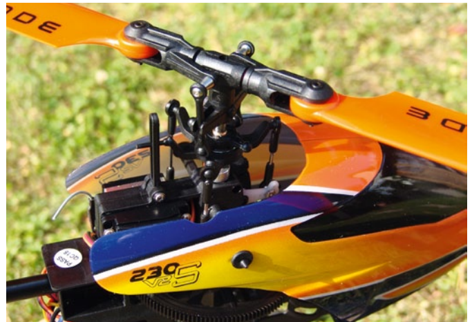
Der Rotorkopf besitzt eine durchgehende Blattlagerwelle aus Stahl. Die Anlenkung der Blattgriffe ist naheilend, deshalb senkt sich die Taumelscheibe beim Steigen
