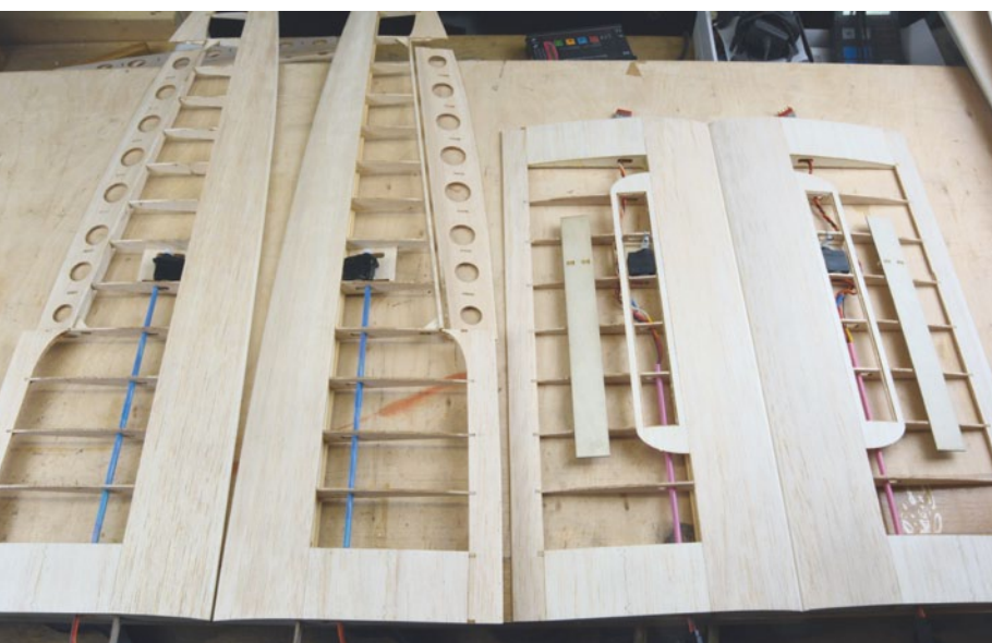
Der Flächensatz der Thermik-Version mit fertig verdrahteten Servos. Die Kabel laufen in einfachen Trinkhalmen
