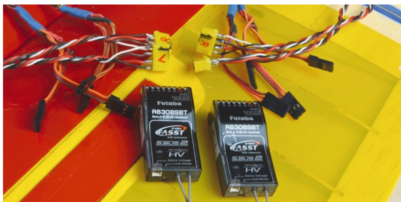
Werden zwei gleiche Empfänger im Motor- und Seglerrumpf verwendet, ist es egal, welche Fläche wo angesteckt wird
