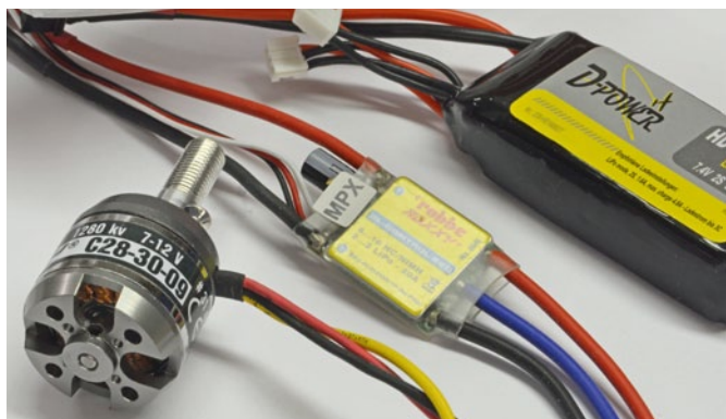
Antriebsset für den Motorrumpf. Zum Einsatz kommt ein roxy-Außenläufer mit 20-Ampere-Regler und 2s-LiPo. Für die Triple-Segler eine ideale Kombi
