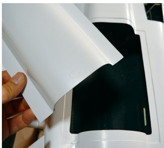
Exakt passend ist der Service-Deckel für den Zugang zum Impeller gemacht
