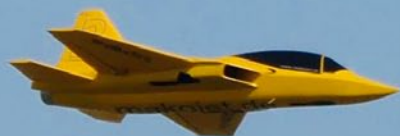
Weitere Variante eines Mako XS, hier eine mit einem Jetfan von Ejets ausgestattete Impeller-Version
