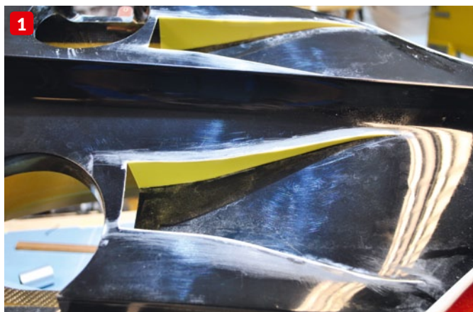
Ein Open-Duct-Impeller-System lebt von der zugeführten Luft. Zu diesem Zweck wurde der Rumpf auf Höhe der beiden Hauptfahrwerkslöcher aufgeschnitten und um zwei NACA-Luftzuführungen erweitert. Das gelingt mit etwas Sorgfalt sehr einfach (1 und 2)
