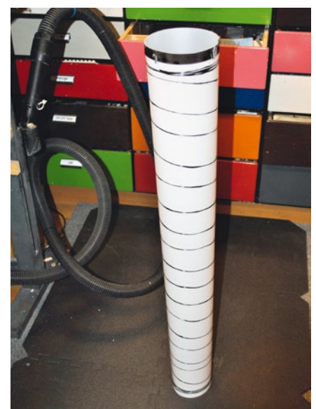
Vom gut 900 Millimeter langen Schubrohr, das Fantastic-Jets stellte, sind immerhin 800 Millimeter erforderlich
