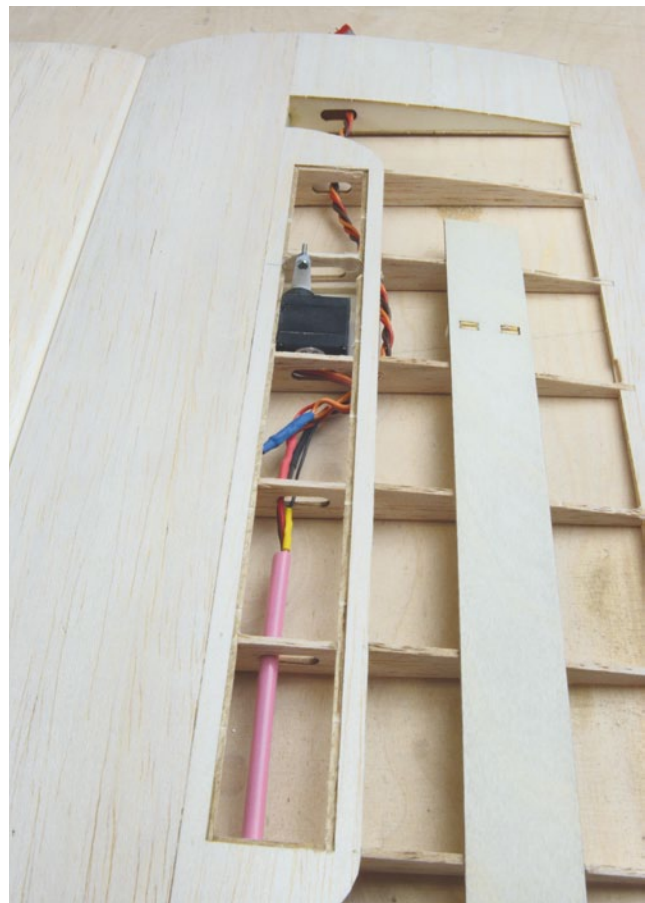
Der Abzweig zum Querruderservo ist verlötet – das spart Steckverbindungen
