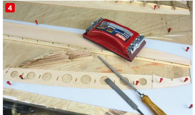
Die Rumpfteile werden verklebt. Dabei ist darauf zu achten, dass sie exakt gleich ausgerichtet sind (1). Die stabile Mittelkonstruktion des Rumpfs passt genau (2). In der Helling werden die Leitwerke verklebt (3). Mit Feile und Schleifpapier werden die „Brennkanten“ versäubert (4)
