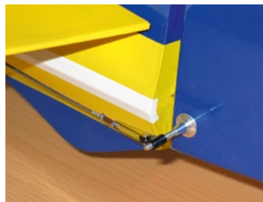
Die Anlenkungen sind aus stabilen Aludrehteilen erstellt
