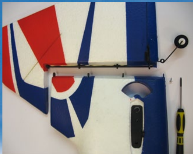
Das Seitenruder ist noch anzuschlagen. Die stabile Scharniertechnik ist hier gut erkennbar
