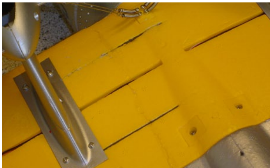
Im oberen Flügelteil wurde ein 1-Millimeter-CFK-Stab unterhalb der Flügeloberfläche eingeschoben und mit Styro-Sekundenkleber fixiert. Im unteren Flächenteil wurde die Fläche eingeschlitzt, der 1,5-Millimeter-Stab eingedrückt und anschließend mit Sekundenkleber beträufelt. Die Flächenteile selbst sind mit Zweikomponentenkleber zusammengesetzt
