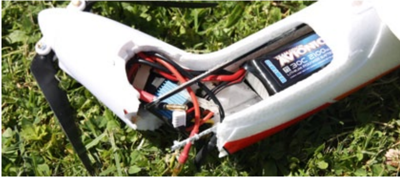
Ein kapitaler Schaden, aber kein Grund zum Wegwerfen des Modells. Sowohl der Motor, die Luftschraube, der Regler und der Akku haben den Absturz schadlos überlebt – Glück gehabt
