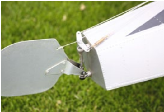
Die steuerbaren Wasserruder müssen beim Start angehoben werden
