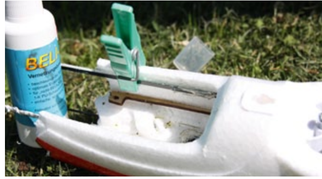
Die beiden CFK-Stäbe waren bereits im Modell eingelassen und wurden mit reichlich Belizell nachgeklebt. Eine Wäscheklammer hilft beim Fixieren
