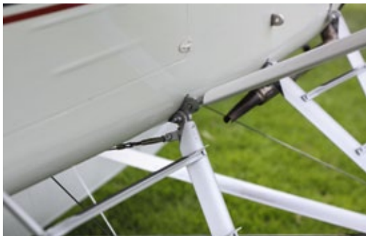
Die Anschlüsse für Streben, Stützen und Abspannungen sind weitgehend originalgetreu
