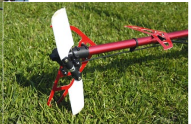
Auch die Heckrotormechanik besteht aus Kunststoff
