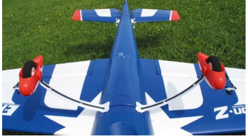
Das Fahrwerk sitzt stramm in der Halterung und wird von der Fahrwerksverkleidung ausreichend fixiert
