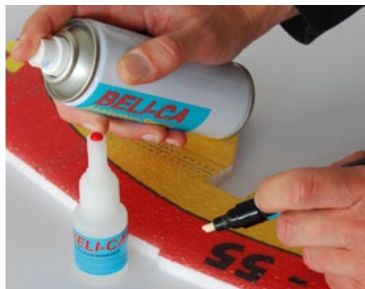
Sekundenkleber ist ideal, wenn kleine Reparaturen, mal eben auf die Schnelle erfolgen sollen. Aktivator als Spray oder im Stift beschleunigt das Aushärten
