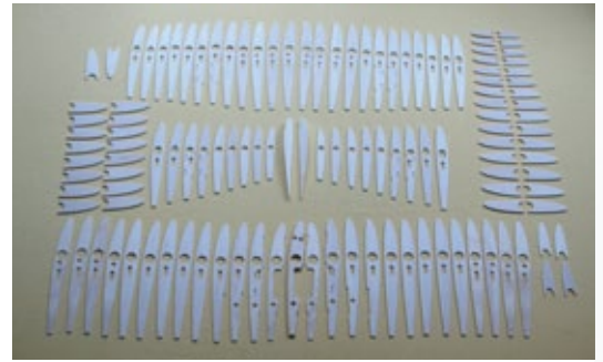
CNC-gefräster Rippensatz in Perfektion. Diese sind lediglich auf den Holm aufzufädeln, zu fixieren und zu verkleben – das gelingt recht flott
