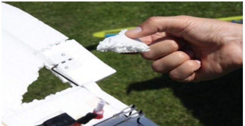
Die gebrochene Fläche wird nur noch durch den Holm an Ort und Stelle gehalten. Sogar die Anlenkung und das Scharnier für die Klappe sind ab. Das alles ist reparabel
