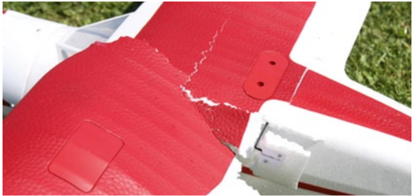
Die gebrochene Fläche wird nur noch durch den Holm an Ort und Stelle gehalten. Sogar die Anlenkung und das Scharnier für die Klappe sind ab. Das alles ist reparabel
