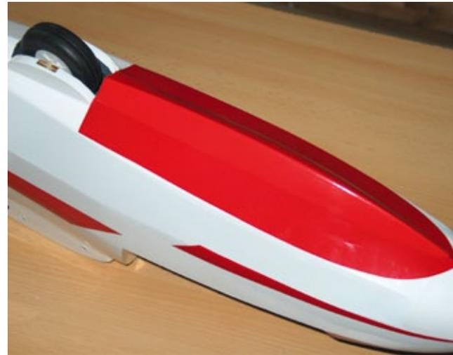
**Die Landekufe ist mit Silikon am Rumpf verklebt. Dahinter ruht das Bugrad in einem geschlossenen Radkasten**
