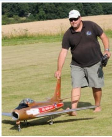
**Die Original VFW 614 war das erste nach dem Zweiten Weltkrieg in Deutschland gebaute und im Linienverkehr eingesetzte Düsenflugzeug. Das Modell von Gerd Biller hat eine Spannweite von 2.150 Millimeter und wiegt 11,7 Kilogramm. Zwei DSD-51-DIA HST und 10s-LiPos sorgen für einen Standschub von 7 kp**
