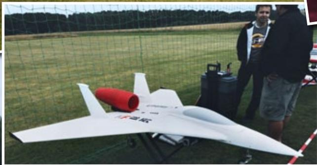
*Jörg Rehm zeigte seine Eigenentwicklung in Voll-GFK-Schalenbauweise, den KF Pro-Jet. Die Spannweite sowie Länge beträgt 1.700 Millimeter. Impeller und Motor sind ebenfalls eine Eigenentwicklung. Der maximale Strom von 320 Ampere und eine Eingangsleistung von 17 Kilowatt werden von einem MGM compro 400-A-Regler gebändigt. Der Zehnblatt-Impeller mit einem Durchmesser von 144 Millimeter soll Anfang 2013 in einer kleinen Serie gefertigt werden*
