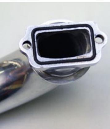
**Professionell: Als Dichtung dient ein temperaturfester O-Rohling, der in einem Nut im Krümmerflansch eingelassen ist**
