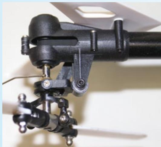
**Auf der Gleitfläche zwischen Pitchhülse und Heckrotorwelle sorgt ein Tropfen Öl für die notwendige Leichtgängigkeit**
