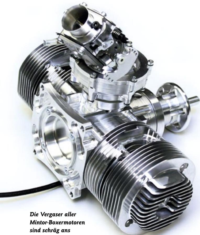
**Die Vergaser aller Mintor-Boxermotoren sind schräg ans Kurbelgehäuse angeflanscht. So schmiegen sie sich der Krümmerkantur an und es müssen keine hässlichen Löcher in die Motorhaube gefräst werden**
