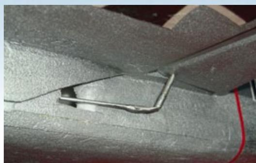
**Die Querruderanlenkung besteht aus einem im Depronruder verklebten Holzspieß und als Scharnier dient Schrumpfschlauch**
