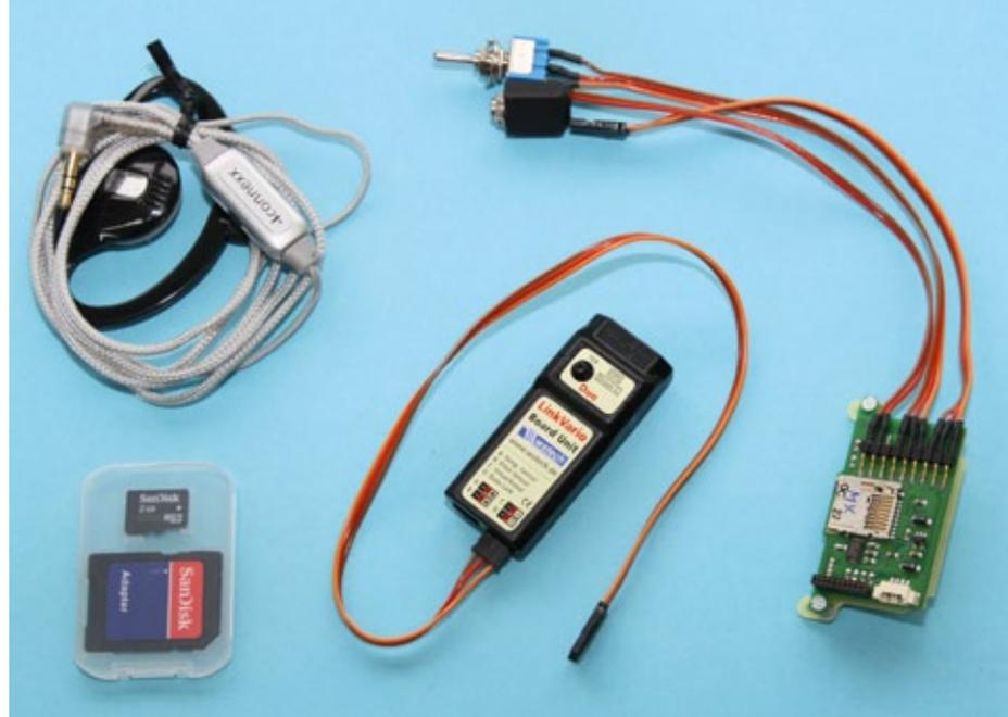
Speed-Sensor. Je nachdem, was gemessen werden soll, wird ein Sensor angesteckt oder eben nicht. So bleibt das System flexibel und auch der Platzbedarf hält sich in Grenzen. Bis auf den hauseigenen GPS-Sensor II ist das LinkVario zum Anschluss an die Sensoren von SM-Modellbau ausgelegt, das heißt alle dort erhältlichen Stromspannungs-, Temperatur- und der Speedsensor lassen sich mit dem LinkVario betreiben.
