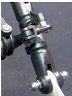
Der Heckrotor des Blade 300 X ist weitestgehend identisch aufgebaut wie der des Blade 450 X. Er hat nur, bis auf die Blatthalter, etwas kleinere Abmessungen
