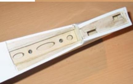
Die Aufnahmen des Höhen- und des Seitenleitwerks wurden bereits vom Hersteller ausgeführt
