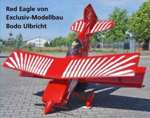
**Exklusiv-Modellbau Bodo Ulbricht** Die Red Eagle ist ein Modell mit einer Spannweite von 2.200 und einer Länge von 2.250 Millimeter. Das Abfluggewicht liegt bei etwa ab 13,2 Kilogramm. Der Bausatz umfasst CNC-gefräste Holzteile, GFK-Teile sowie weiteres Zubehör wie Räder und Verspannungsseile nebst aller benötigten Kleinteile. Die Red Eagle ist eine abgewandelte Version ohne Randbögen der Christen Eagle. Der Preis: 929,- Euro.
