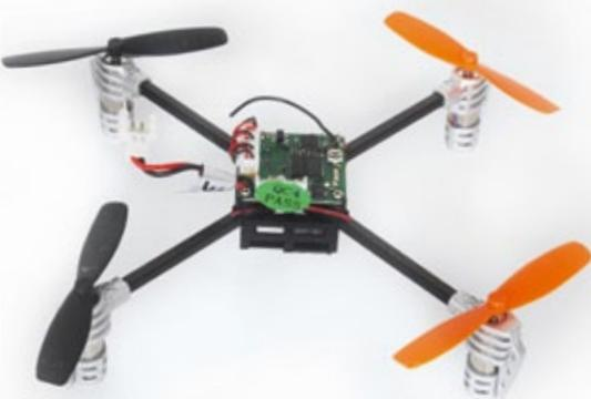
Die vier Rotorgondeln sind an je einen Carbonstab gesteckt. Im Mittelteil des Rahmens befindet sich geschützt die Flugelektronik
