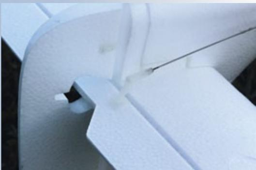
**Beim Einhängen des Höhenruder-Anlenkungsdrahts ist das äußere Loch am Ruderhorn zu wählen, um den richtigen Ausschlag zu erhalten**
