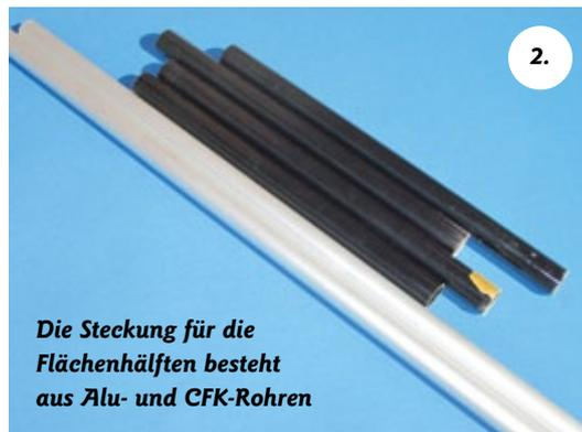
*Die Steckung für die Flächenhälften besteht aus Alu- und CFK-Rohren*
