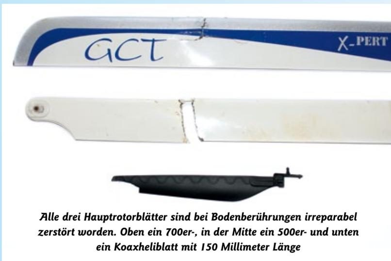
**Alle drei Hauptrotorblätter sind bei Bodenberührungen irreparabel zerstört worden. Oben ein 700er-, in der Mitte ein 500er- und unten ein Koaxheliblatt mit 150 Millimeter Länge**
