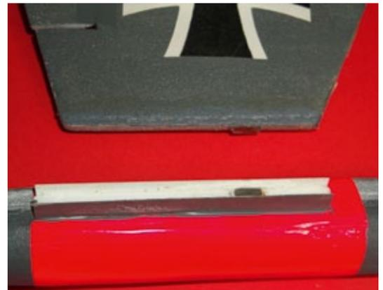
**Hier sieht man gut die Befestigungstechnik für die Flügeltanks mittels Magnet und Cuttermesser-Klinge. Auch die ABS-Führungsschienen im Tank zu sehen.**
