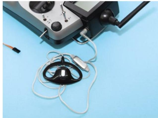
**Die Kopfhörerbuchse wurde seitlich am vorderen Gehäuse angebracht**
