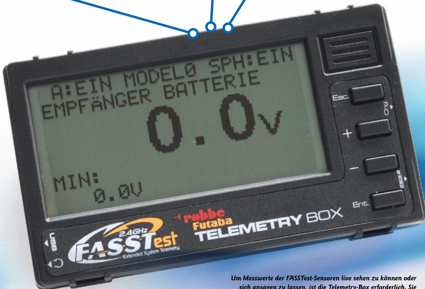
Um Messwerte der FASSTest-Sensoren live sehen zu können oder sich ansagen zu lassen, ist die Telemetry-Box erforderlich. Sie kann die Daten der Receiver R630SBT oder R7008SB empfangen
