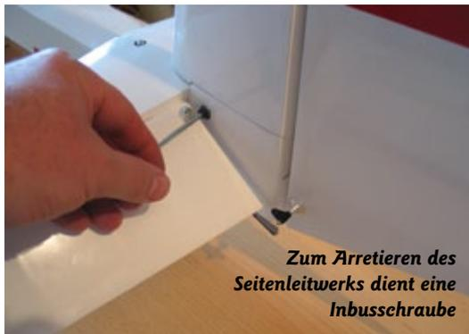
**Zum Arretieren des Seitenleitwerks dient eine Inbusschraube**
