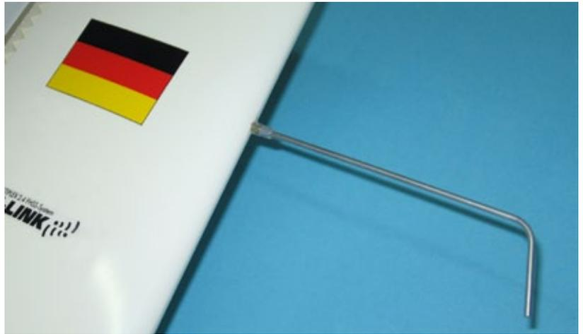
Die TEK-Düse kann, wie im manntragenden Segelflugzeug, in der Seitenleitwerksflosse untergebracht werden. Es gibt aber auch eine Version zum Einbau in den Rumpfrücken
