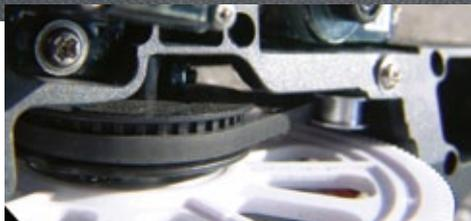
Über dem Hauptzahnrad ist das Zahnriemenrad des Heckabtriebs zu sehen. Der Riemen wird vor dem Eintauchen ins Heckrohr von Alu-Umlenkrollen geführt
