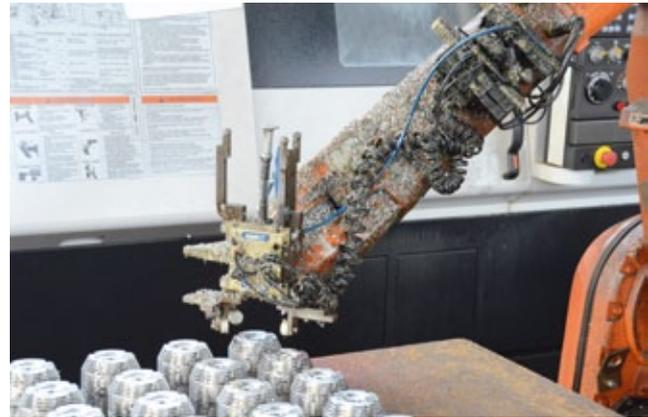
**So entsteht ein Mintor-Zylinderkopf. Der orange Roboterarm greift den Aluminiumrohling und spannt ihn in eine große CNC-Fräsmaschine ein. Auf dem rechten Tisch sind die Rohlinge und auf dem linken die fertig bearbeiteten Zylinderköpfe**
