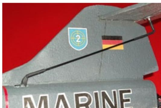
**Die Anlenkung des Höhenruders erfolgt über ein Carbonrohr. Das Servo ist liegend in der Rumpfoberseite eingelassen**
