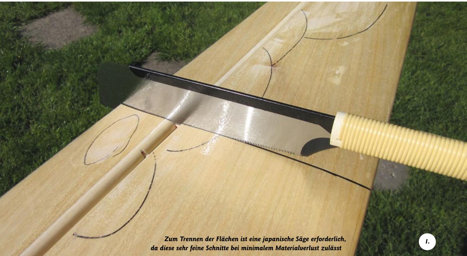
*Zum Trennen der Flächen ist eine japanische Säge erforderlich, da diese sehr feine Schnitte bei minimalem Materialverlust zulässt*
