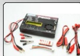
200 Watt Leistung Bis zu 10 Ampere Ladestrom: Größere Akkus schneller laden und entladen
