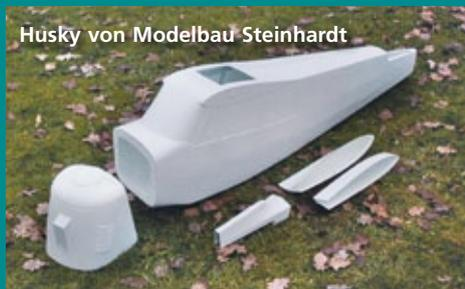
**Modellbau Steinhardt** Modellbau Steinhardt bietet eine Reihe GFK-Rumpfsätze an. Der Ger mit einer Länge von 1.360 Millimeter ist dem historische Wanitschek-F3B-Modell nachempfunden. Der Preis: 124,- Euro. Der Husky ähnelt einem Piper-Schleppmodell und ist 1.530 Millimeter lang. Der Preis: 242,- Euro. Die Pikant ist ein Nurflügler-Seglerumpf mit einer Länge von 1.030 Millimeter. Der Preis: 114,30 Euro.
