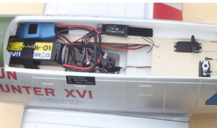
**Der LiPo ist mit Klettband sicher fixiert und in der Position verschiebbar, um den Schwerpunkt einzustellen**
