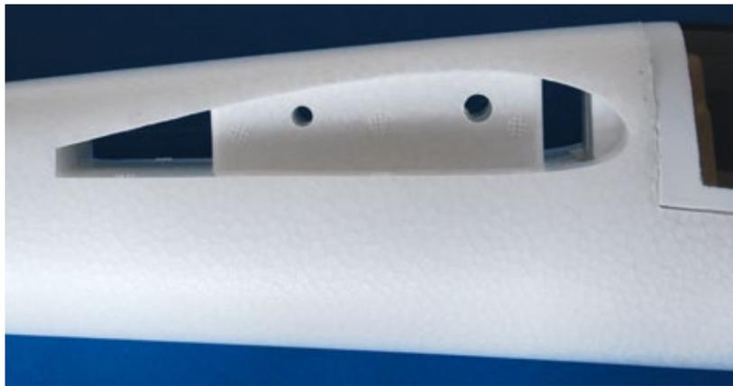
**Zwei Steckungen sorgen für eine hohe Stabilität und Verdrehsicherung der Flächen**
