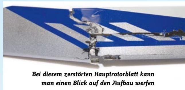
**Bei diesem zerstörten Hauptrotorblatt kann man einen Blick auf den Aufbau werfen**
