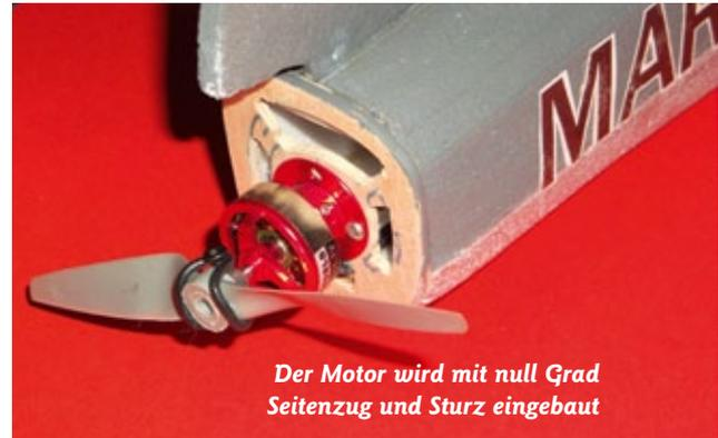
*Der Motor wird mit null Grad Seitenzug und Sturz eingebaut*
