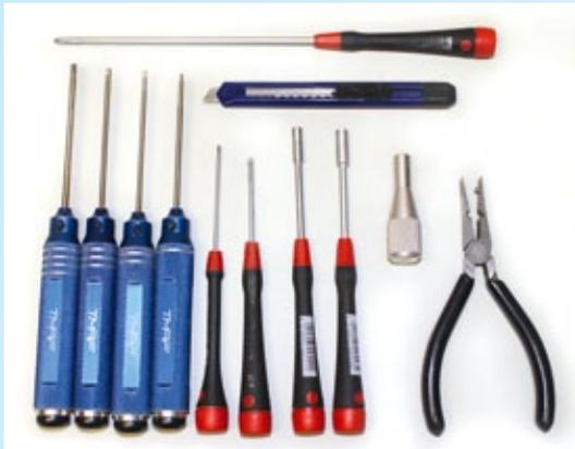
**Eine kleine Auswahl der wichtigsten, nach Möglichkeit hochwertigen Werkzeuge wie Schlitz- und Kreuzschlitzschraubendreher, Steckschlüssel, Inbuschlüssel, scharfes Messer mit Abbrechklingen, Kugelpfannenaufdreher und die sehr wichtige Spezialzange zum Auf- und Abklipsen der Kugelpfannen**
