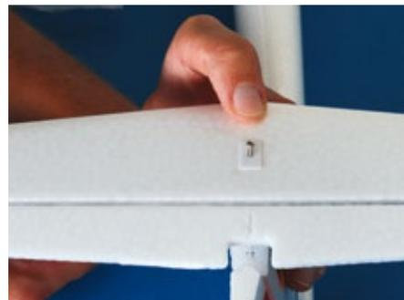
... und dann das Höhenleitwerk auf dem Seitenleitwerk zu fixieren. Hier zu sehen ist die LS8-18, der B4 spendierte man eine zweite Schraubverbindung
