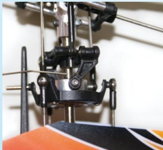
**Das Aufbringen von wenigen Tropfen Öl auf die Hauptrotorwelle und die Kugel der Taumelscheibe sorgt auch in diesem Bereich für die erforderliche Leichtgängigkeit**
