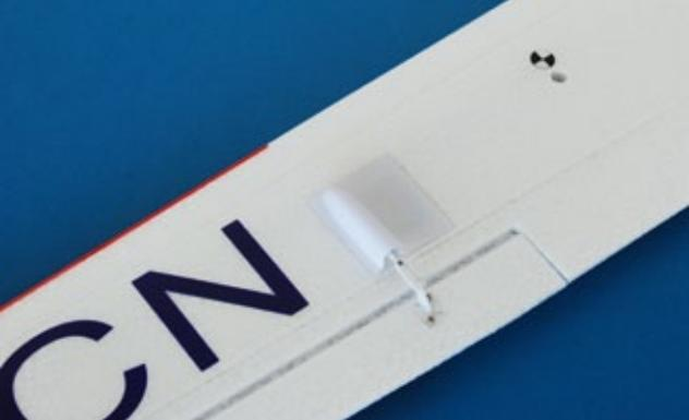
**Komplett fertiggestellt: Die Querruderservos sind bereits eingebaut und mit dem Anlenkungsdraht konfektioniert**
