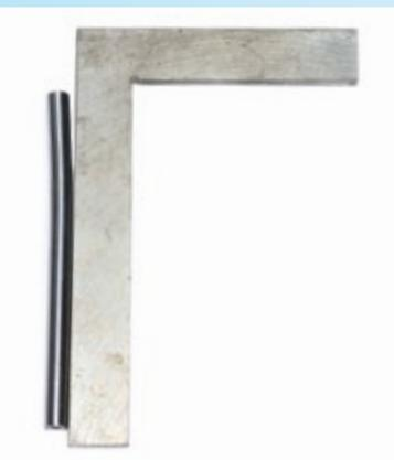
**Diese Blattlagerwelle gehört eindeutig in den Müll, da sie im oberen Bereich unübersehbar verbogen ist**
