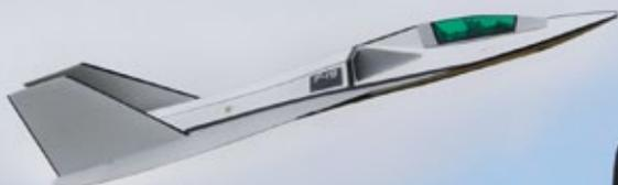
**Die F-19 Aurora von Heiko Gosewitsch zählt zu den Highlights in Effeln. Das Modell mit GFK-Rumpf und Balsa-bepunkteter Styrofläche hat eine Länge von 2.000 Millimeter und wiegt 8.600 Gramm. Der Ramtec 127-Impeller verleiht dem Jet knapp 7 kp Schub**
