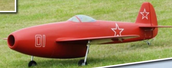
**Die Yak-15 von Oliver Wennmacher – Inhaber der Firma WeMoTec – ist eine Holzkonstruktion des Herstellers RBC-Kits. Vorgefliegen wurde sie von Chris Abeln. Bei einer Spannweite von 1.400 Millimeter wiegt das Modell 2.700 Gramm und wird von einem WeMoTec Midi Fan pro angetrieben**
