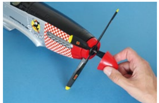
Der Mustang-Prop ruht auf der Spinnerplatte, die an der Motorglocke arretiert ist
