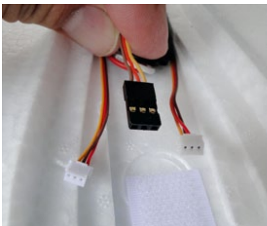
Die Servos haben Mikro-Stecker; der Regler hat einen Standardstecker, der über einen Adapter mit dem Empfänger verbunden wird
