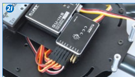
21 Der Anschluss der sechs Regler-Kabel erfolgt am Hexa- und Octo-Adapter
