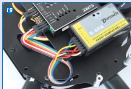
19 Über den mitgelieferten Kabelbaum wird die Flight-Control mit dem Receiver verbunden
