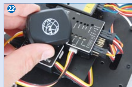
22 Das GPS-Modul wird an der Flight-Control angesteckt und später auf der Haube befestigt
