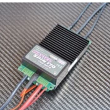
Hackers Regler Master Spin 170 ist den maximal 160 Ampere Motorstrom gewachsen
