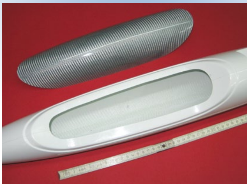
Der über 300 Millimeter lange Haubenauschnitt sorgt dafür, dass der RC-Einbau sehr einfach realisiert werden kann
