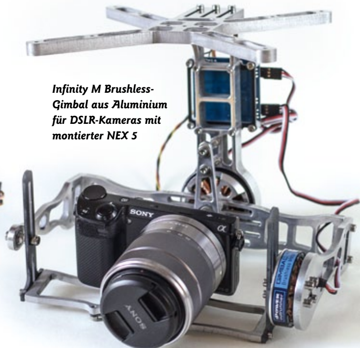
Spezieller Gimbal-Motor. Deutlich zu sehen sind die vielen Windungen mit feinem Kupferlackdraht
