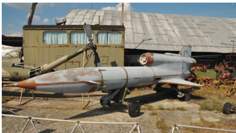
Eine russische Drohne aus den 1980ern, die VR-3 Reis hieß. 8 Meter lang, 2,2 Meter Spannweite, 1,4 Tonnen schwer und angeblich 900 Stundenkilometer schnell
