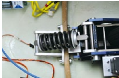
Das Fahrwerk ist sehr schnell eingebaut, außen müssen noch zwei M6-Schrauben gesetzt werden
