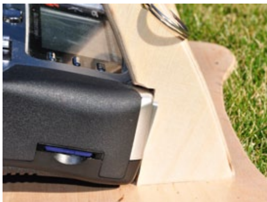
Detail-Anschlag der Trägereile am Senderboden
