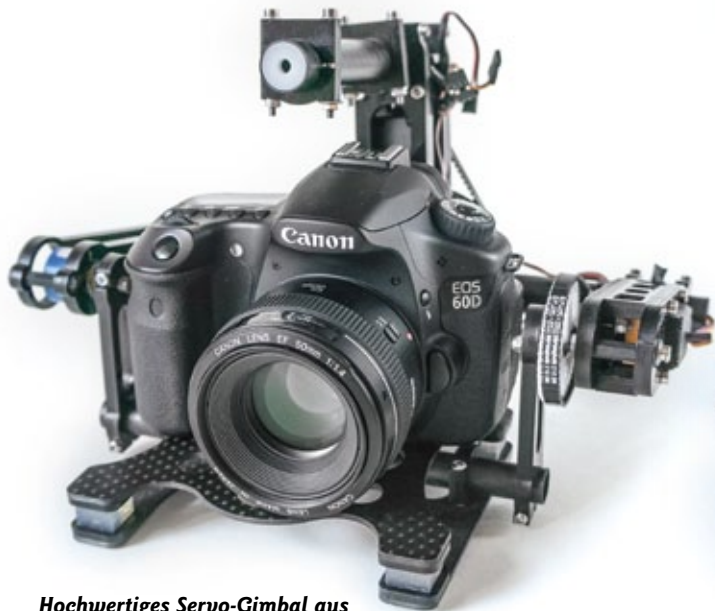
Hochwertiges Servo-Gimbal aus Kohlefaser für große DSLR-Kameras
