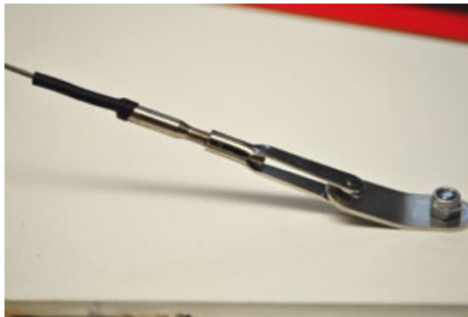
Da das komplette Leitwerk demontierbar ist, lässt sich die Verspannung leicht lösen
