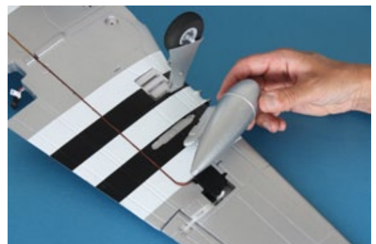
An der Corsair sind alle Attrappen anzukleben. Ihre Bremswirkung im Flugbetrieb ist spürbar
