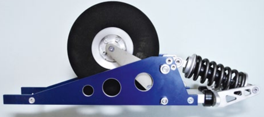
Seitenansicht des Fahrwerks mit der neuen Federung. Auslage ungefähr 55 Millimeter vor dem Spant
