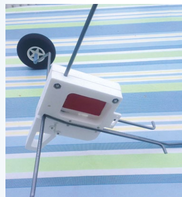
Verschraubter Grundkörper mit Einbuchtung für Empfänger
