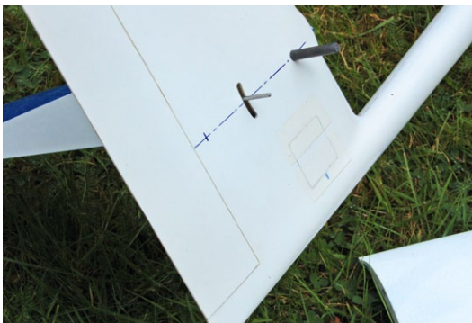
Herkömmliche Pendelrudernanlenkung. Darunter der Zugang zum Umlenkhebel
