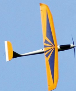
Abbildung 5: Der Bandit von FVK – ein typisches Hangflugmodell mit einer gut konstruierten Auftriebsverteilung an der Tragfläche
