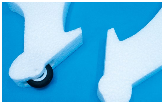
Die Fahrwerksbeine erhielten in Eigenarbeit eingebaute Räder, die den Start vom befestigten Boden aus deutlich vereinfachen
