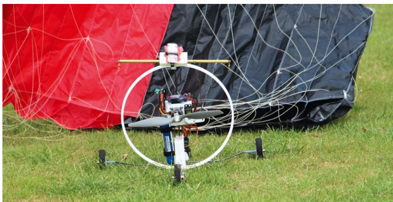
Trike mit Verspannung am Schirm: Links ist die Öse mit dem Haken für den Anschluss an die Anlenkstange am Schirm zu erkennen
