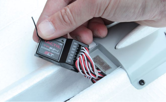
Der Empfänger des Typs Tactic TR624 wird gemäß Anleitung verkabelt
