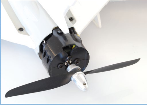
Der Brushlessmotor mit einer spezifischen Drehzahl von 2.200 kv ist schwenkbar gelagert
