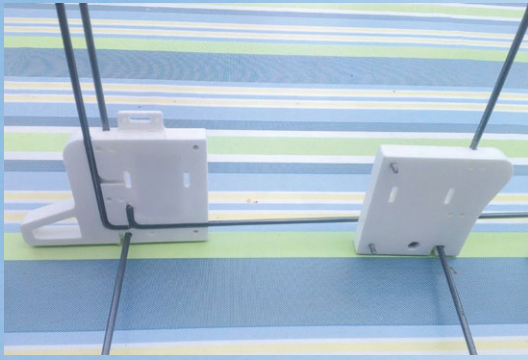
Montage des Grundkörpers; Die Festigkeit wird durch pfiffiges Verkeilen und Schrauben erreicht. Alle Schlitz für die Drähte sind exakt gefräst
