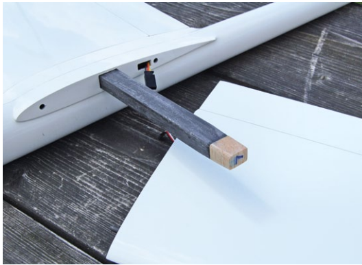
Balsastücke an den Enden der Steckung sorgen für die richtige Einschublänge
