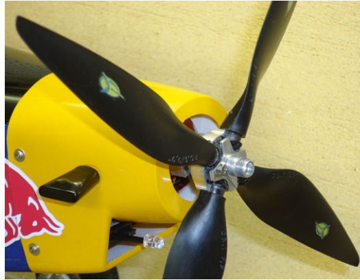
Ohne das Nabenvorderteil sind der bewegliche Pitchgeber und die Verstellerschraube gut zu erkennen. Auf der zentralen Nabenhülse befindet sich ein Feingewinde
