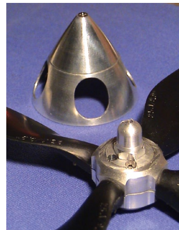
Um den eleganten Spinner zu montieren, muss die gesamte Nabe noch einmal zerlegt werden
