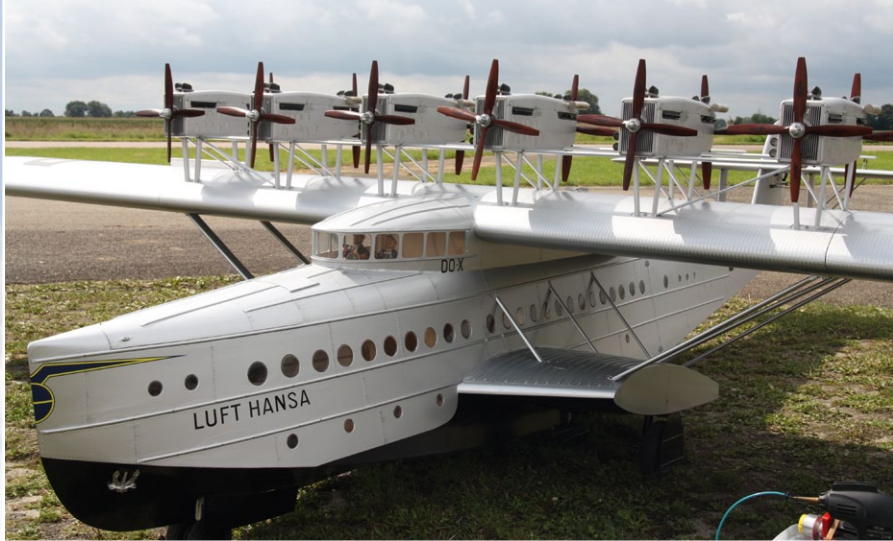
Fantastisch gebaute und beeindruckende Dornier Do-X von Michael Bräuer. Alle zwölf Viertaktmotoren sind perfekt abgestimmt und laufen synchron
