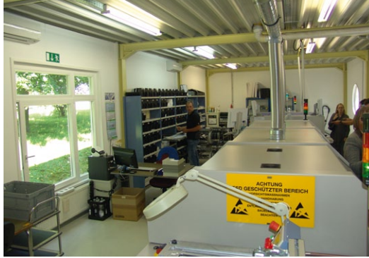
Die Bestückungsanlage. Links im Hintergrund der Lagerbereich mit den SMD-Bauteilen
