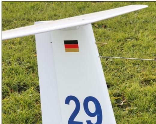
Das Seitenleitwerk wurde vorbildgetreu mit funktionsfähigem Pitot-Rohr und TEK-Düse ausgestattet
