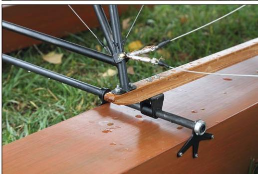
Oben ist der hintere Bereich mit dem Gummilager und unten der vordere, drehbar gelagerte Bereich zu sehen
