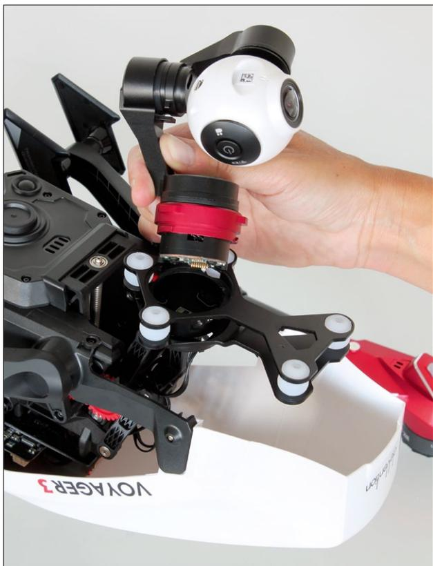
Über einen Bajonettverschluss ist das völlig kabellose Dreiachs-Brushless-Gimbal samt Full-HD-Kamera mit der Halteplatte zu befestigen. Stiftkontakte sichern die Stromversorgung und Übertragung der Bilddaten
