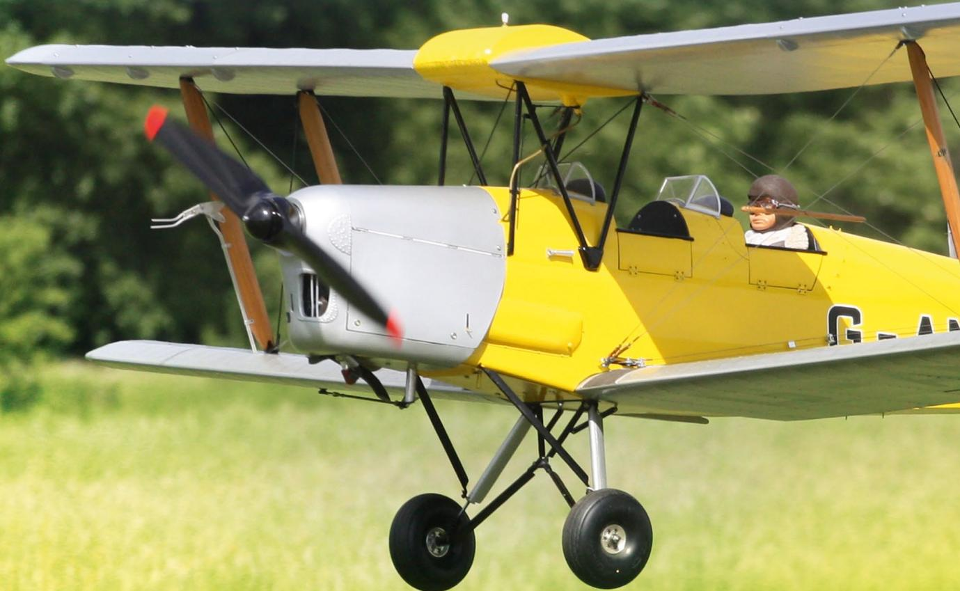
Ganz wie beim Original sitzt der Pilot hinten (1). Außen geführte Anlenkung des Seitenruders und vorbildgetreue Verspannung (2)
