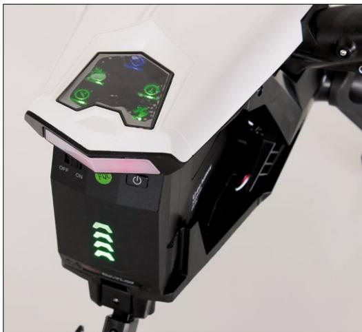
Vier im Akku integrierte LED geben Auskunft über den Füllstand des Energieträgers. Hinter der eckigen Milchglasscheibe ist die große, weithin sichtbare Betriebsanzeige des Kopters zu sehen und darüber die Funktionsanzeige
