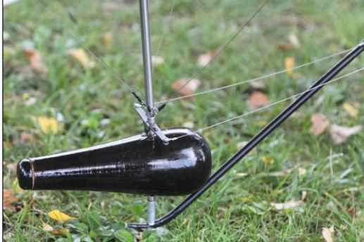
Der hydro- und aerodynamisch geformte Auftriebskörper am Sporn der FF8
