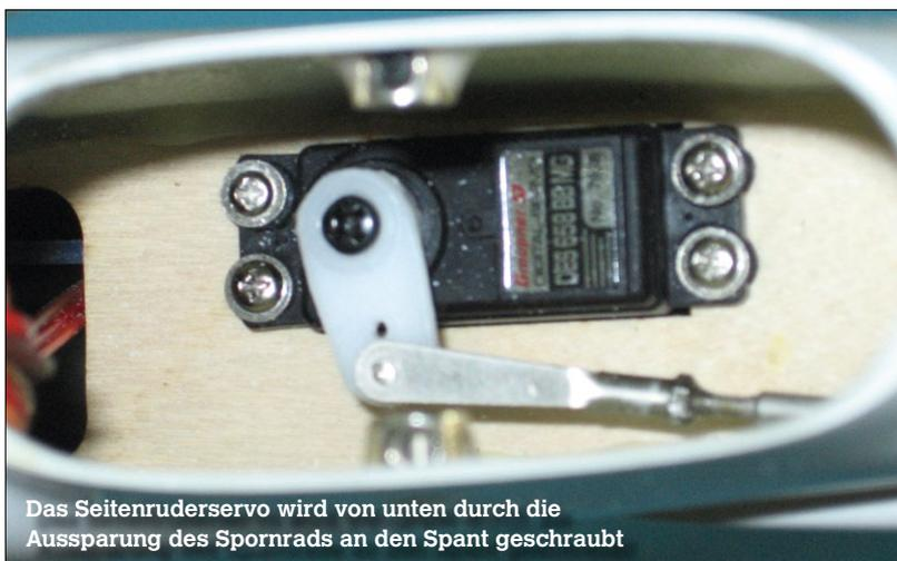
Das Seitenruderservo wird von unten durch die Aussparung des Spornrads an den Spant geschraubt
