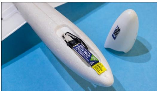
An der Unterseite klettert sich der 1S-LiPo in seine Mulde und wird von einer Plastikcappe umschlossen
