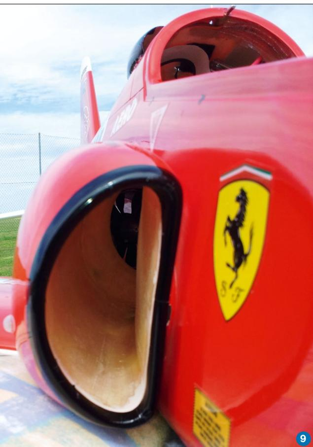
Abbildung 9: Runde Lippen und glatter Verlauf verbessern die Schubleistung
