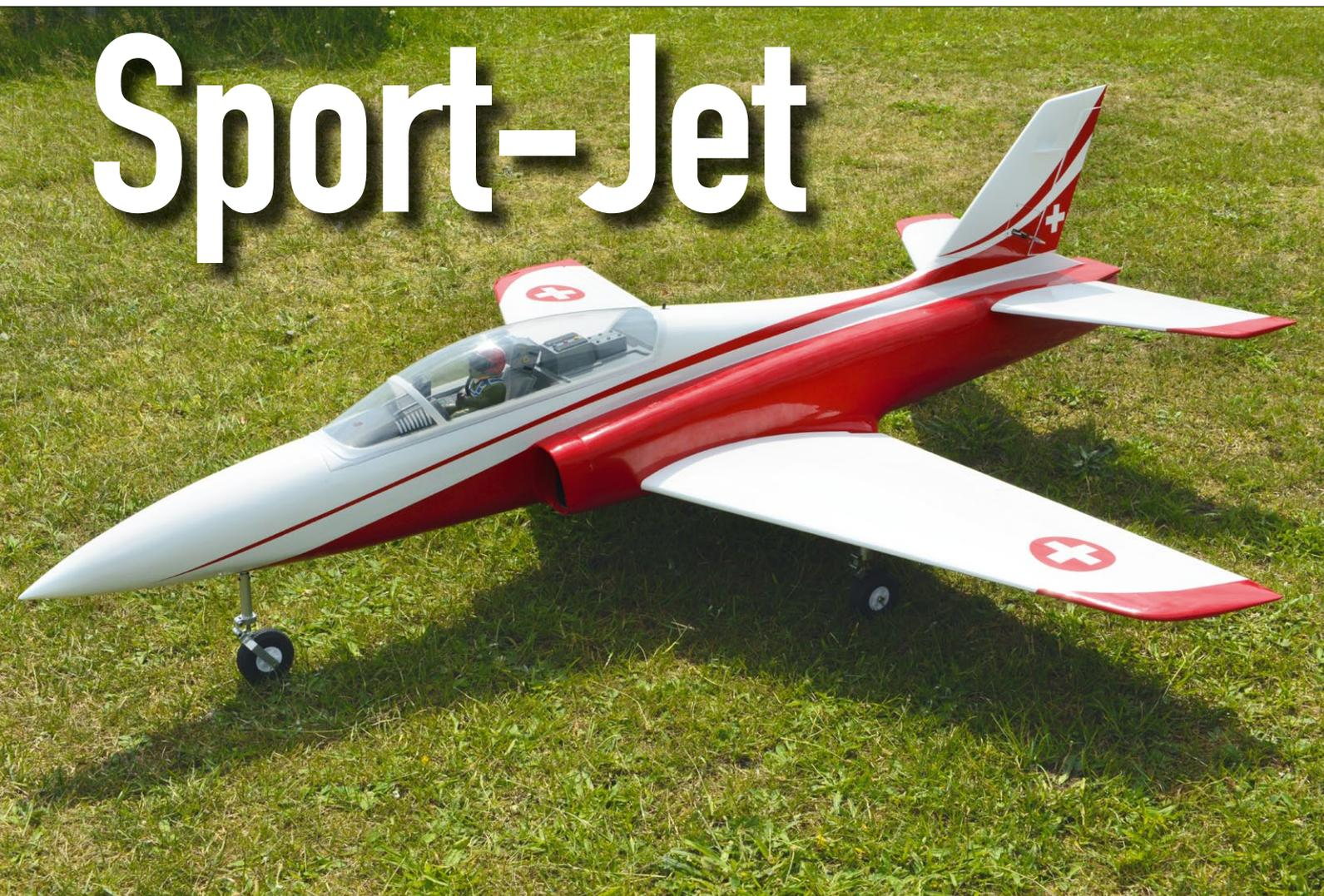
**Der Sport-Jet Preceptor, der seit Kurzem erhältlich ist, wurde für 90-Millimeter-Impeller konstruiert und hat eine Flügelspannweite von 1.400 Millimeter, ist also schon ein stattliches Modell. Erstellt in Holzbauweise und mit Bügelfolienbespannung, macht er auch optisch einiges her. Wir haben uns den E-Jet von Phoenix Model, der in Deutschland über D-Power Modellbau vertrieben wird, genauer angeschaut.**
