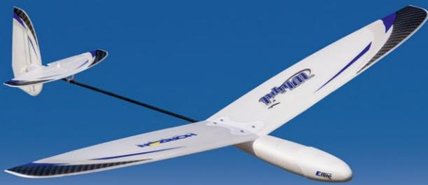
Kurz nach dem Loslassen beim Start geht der Whipit erst mal senkrecht und muss kurz darauf durch beherzten Tiefenruderausschlag in Fluglage gebracht werden
