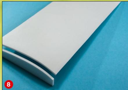
Jetzt kommt ein Spezialtrick: Mit punktueller Hilfe von Doppelklebeband zwingen wir die Unterteile leicht verdreht auf zwei unterschiedliche Dreiecks-Stützen. Dadurch entsteht die Schränkung (7). Die Flügel-Oberseiten werden zuerst als Rechteck vorgewölbt, genau nach Schablone. Damit das Material dabei nicht einreißt, schleift man die Oberfläche vorher beidseitig fein an (8).
