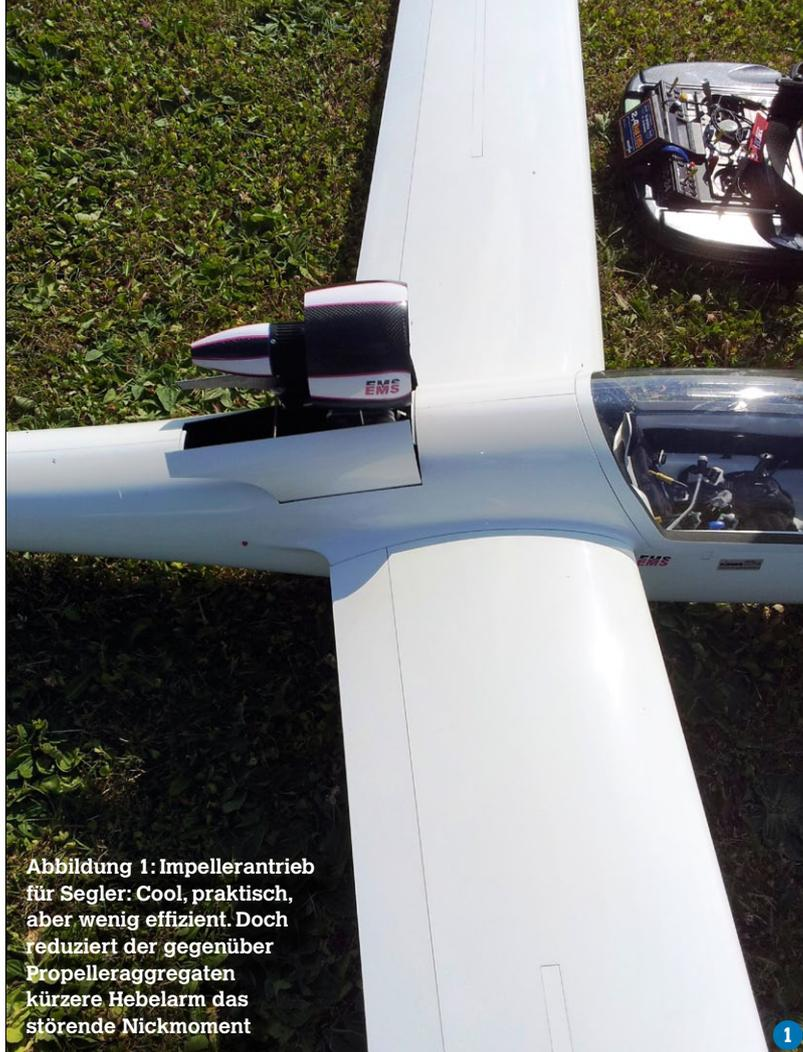
Abbildung 1: Impellerantrieb für Segler: Cool, praktisch, aber wenig effizient. Doch reduziert der gegenüber Propelleraggregaten kürzere Hebelarm das störende Nickmoment
