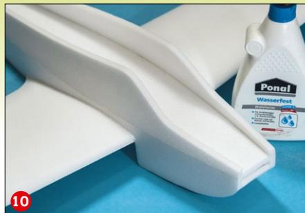
Nach dem präzisen und verzugsfreien (!) Wölben trennen wir die äußere Kontur ab, schon lässt sich die Oberbeplankung passgenau und sorgfältig auf die Unterbeplankung aufkleben (9). Der Flügel bleibt also einteilig und wird nun symmetrisch ausgerichtet unter den Tragflächenausschnitt des Rumpfs geleimt. Der offene Bereich wird später mit einer Klappe verschlossen (10).
