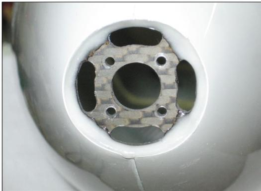
Der von Schambeck mitgelieferte CFK-Motorspant wird mit eingedicktem Langzeitharz in die Rumpfschnauze eingeklebt
