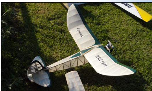
Vor den Cox-Motoren waren Dieselmotoren für Flugmodelle beliebt, wie hier in einer Coronet, die schon eher in die Kategorie der Antikmodelle gehört
