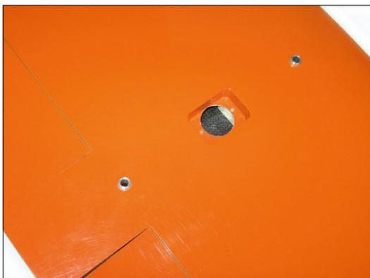
Die Schrauben zur Befestigung der Tragfläche werden in Alu-Hülsen geführt. Zudem gibt es eine Aussparung für den Sub-D-Stecker der Flächenervos
