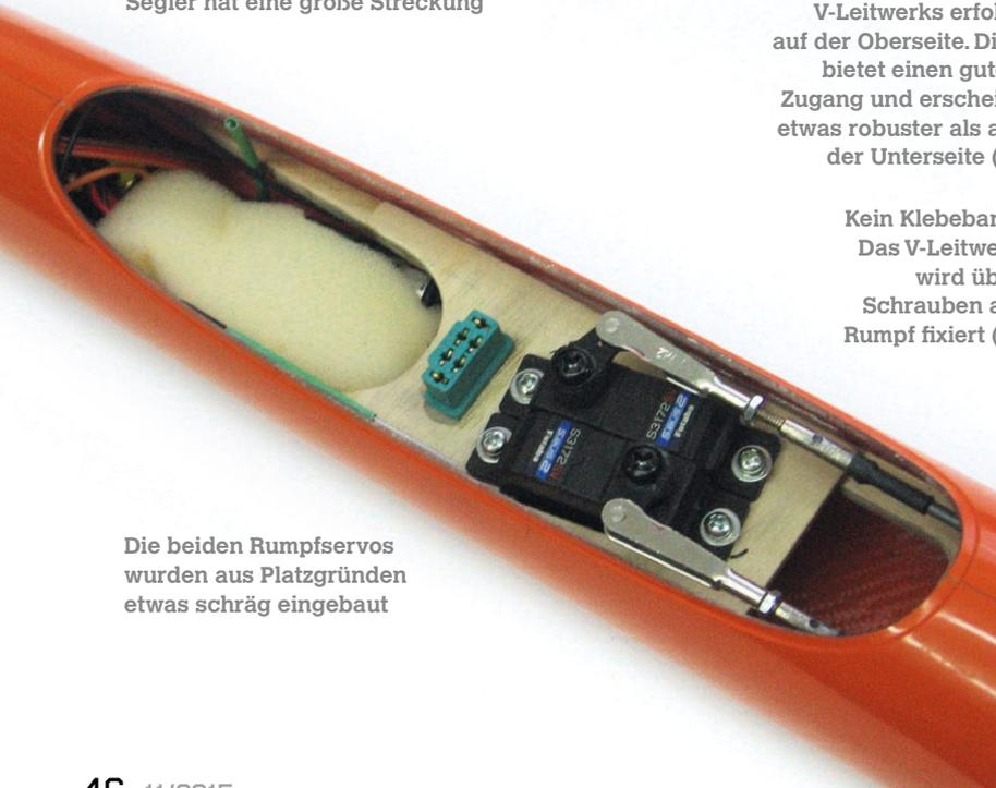
Die beiden Rumpfservos wurden aus Platzgründen etwas schräg eingebaut
