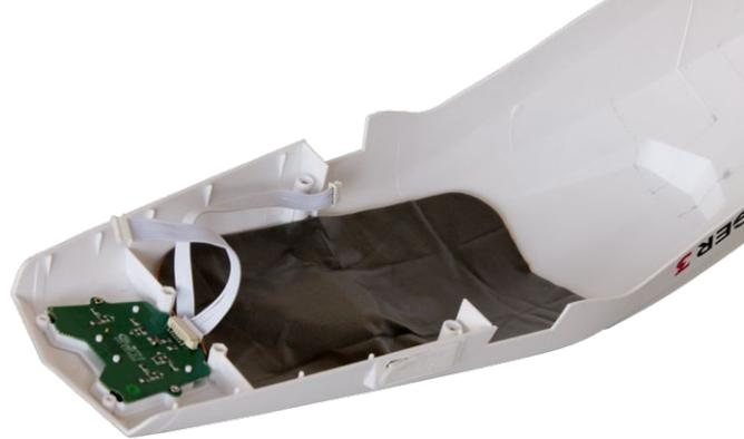
Unter der großen Plastikhaube ist – gut abgeschirmt – der GPS-Empfänger angebracht
