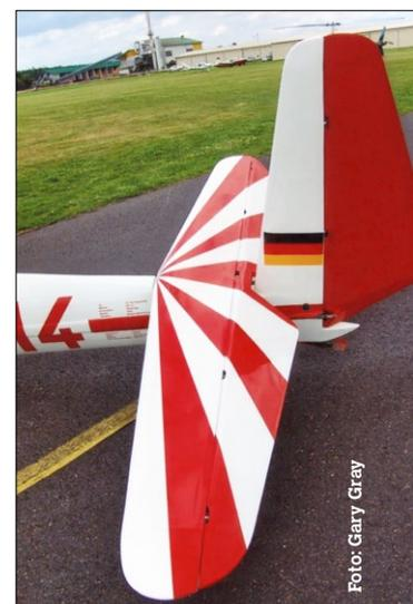
Das herkömmliche Leitwerk der Lo-100 ist vollständig mit Sperrholz beplankt
