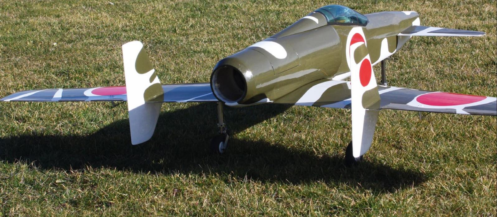
**Da sich Modellflug bis heute im Unterschall- (Subsonic-) Bereich abspielt, ist ein Propellerantrieb eigentlich immer erste Wahl. Doch rein optisch passt er halt nicht zu jedem Flugzeugtyp. Und weil Propeller eben nur beim Rotieren unsichtbar sind, erfand man den Impeller.**
