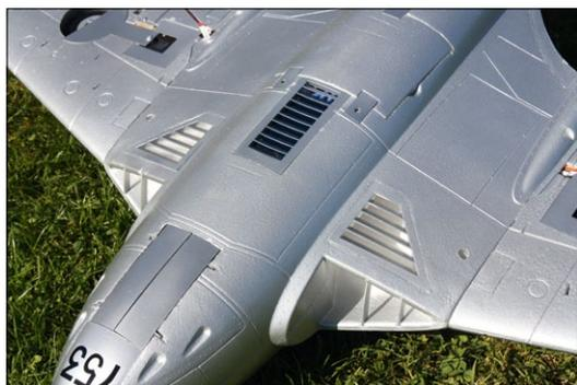
Stabile Plastikeinsätze und große Öffnungen kennzeichnen den Ansaugkanal. Die mittige Öffnung kühlt direkt den Regler
