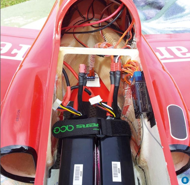
Abbildung 8: Alles richtig gemacht beim Hosenrohr: Keine engen Kurven und genügend Abstand zwischen „Schritt“ und Impellereingang
