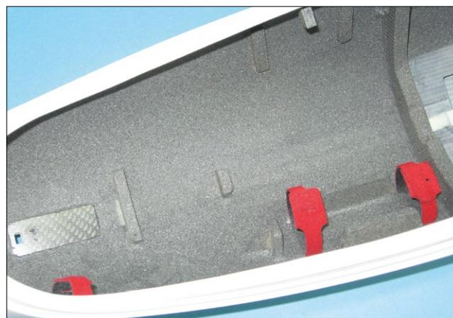
Lackiert man den fertig ausgebauten Rumpf mit etwas grauer Farbe, ergibt sich später mit den Einbauten ein sehr schöner Rumpfausbau
