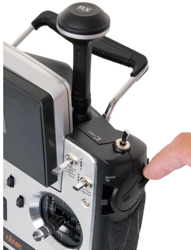
Über den Schieber steuert man das Gimbal und damit den Blickwinkel der Kamera. Diese kann sich anschlaglos unendlich oft um 360 Grad drehen und um etwa 120 Grad vertikal neigen
