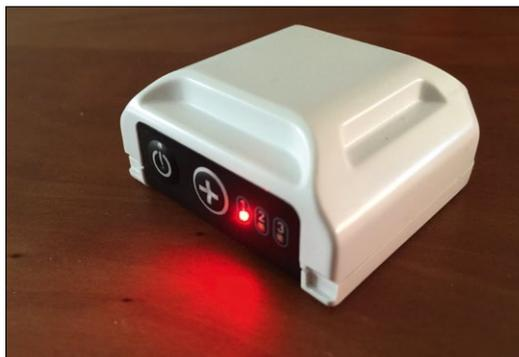
Der kleine Sender (TAG) ist stoßfest sowie wasserdicht umschlossen und bringt zirka 60 Gramm auf die Waage
