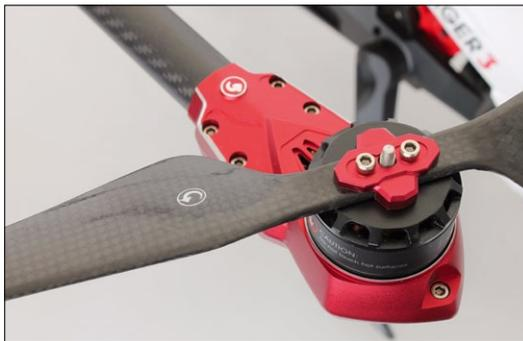
Auf den Antrieb zugeschnittene Blatthalter fixieren den CFK-Prop über zwei Inbusschrauben. Die Montagemethode ist praxistauglich und sicher
