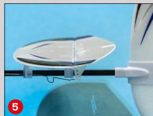
Einmal in den Kleber tunken und dann in die Löcher einsetzen. Pattex 100% Repair Gel besitzt alle Eigenschaften, die wir hier benötigen. Er ist elastisch, zähflüssig, spaltfüllend, greift Styropor nicht an und besitzt eine hohe Klebkraft auf beiden Materialien (4).
