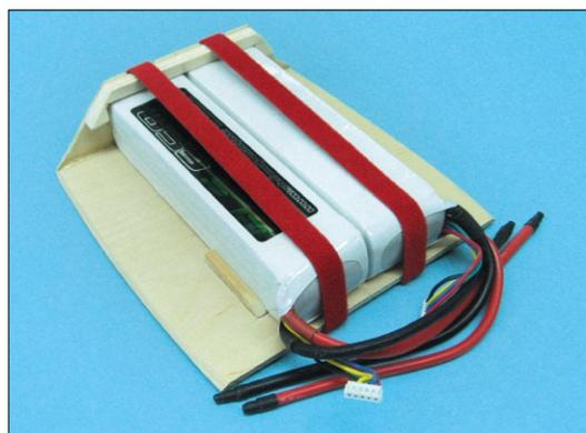
Hier das zum Einbau vorbereitete Sperrholzbrett für die Aufnahme der Antriebsakkus direkt über der Flächensteckung
