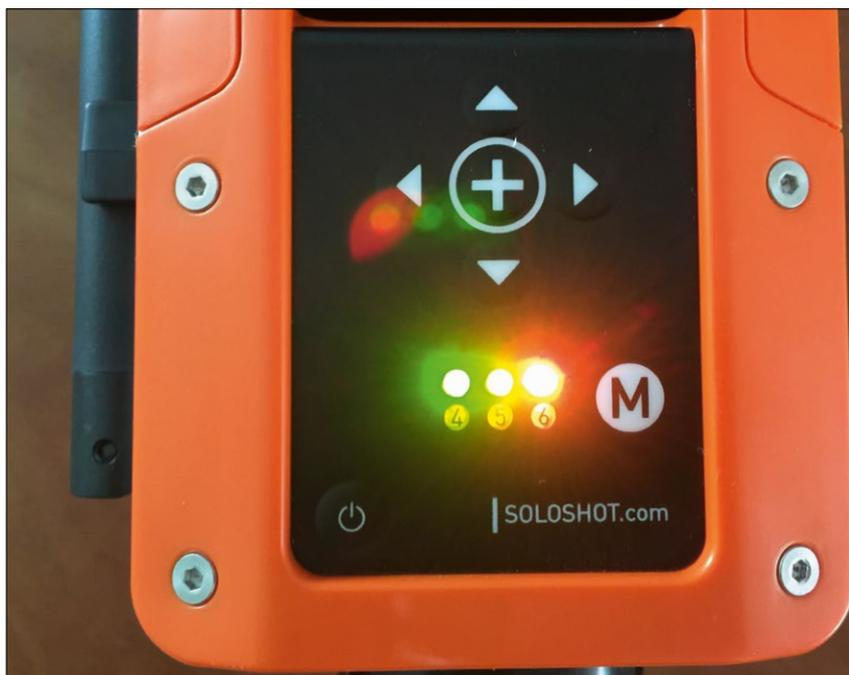
Die Steuerungseinheit (Base) mit montiertem Kamerakontroller. Zum Laden des TAG-Akkus wird die Einheit an der Base angebracht. So verfährt man auch bei der Installation des Firmware-Updates
