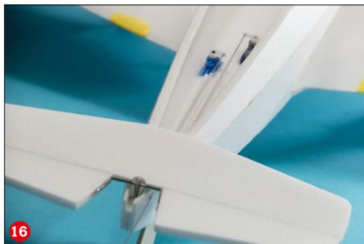
Erst jetzt, ganz zum Schluss, geht's ans Eingemachte. Querruder abtrennen, 6-Gramm-Servos unter dem Flügel versenken, Ruder anscharnieren und anlenken (15). Höhen- und Seitenruder erhalten ebenfalls je ein 6-Gramm-Servo. Der Anlenkungsdraht des Seitenruders wird passend durch den Rumpf gepiekt, während die HLW-Anlenkung innenliegend erfolgt (16).
