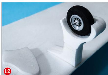
In der Flügel-Unterschale befindet sich eine passende Ausnehmung für den 1,5-Millimeter-Fahrwerksdraht, der nun mit „Pattex 100% Repair Gel“ dauerelastisch und fest verklebt wird (11). Um den Draht ordnen wir streng nach Bauplan die mehrschichtige Depron-Verkleidung an und verkleben auch diese mit Repair Gel unter dem Flügel (12).
