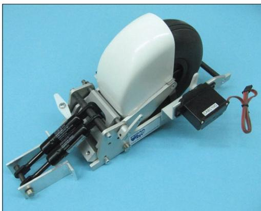
Der hintere Fahrwerksspannt musste selbst erstellt werden. Zuerst wurde mit Hilfe von Lötzinn die Form abgenommen, dann eine Pappschablone erstellt und schlussendlich dann der Spant aus stabilem Sperrholz ausgesägt. Das eingebaute Fahrwerk der Firma FEMA besitzt eine Radabdeckung, Federung und sogar eine Radbremse. Dort bietet man auch ein speziell für das Modell zusammengestelltes Komplettpaket an
