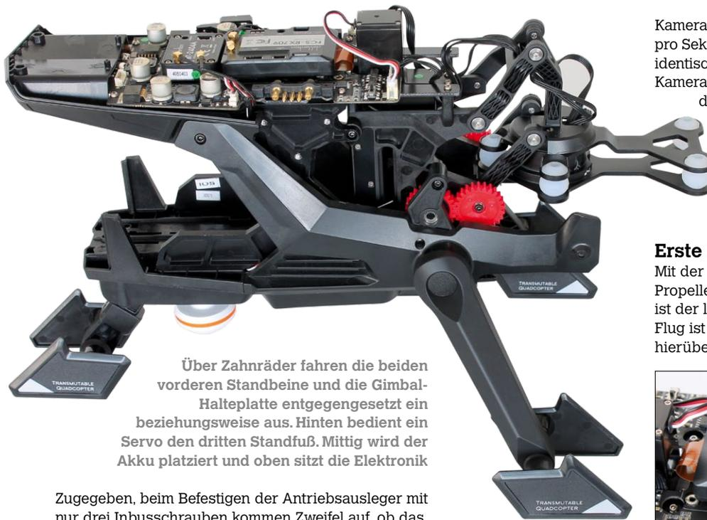
Über Zahnräder fahren die beiden vorderen Standbeine und die Gimbal-Halteplatte entgegengesetzt ein beziehungsweise aus. Hinten bedient ein Servo den dritten Standfuß. Mittig wird der Akku platziert und oben sitzt die Elektronik
