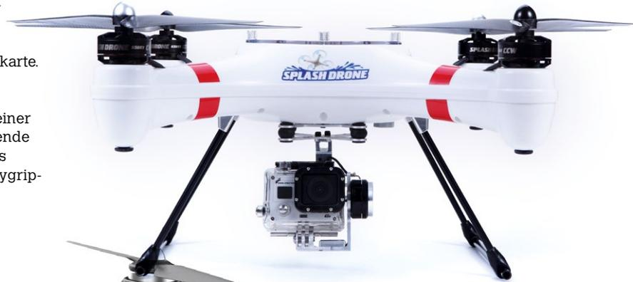
Wasserdichter RTF-Quadrocopter von Splash-Drone
