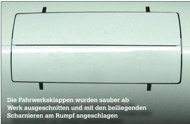
Die Fahrwerksklappen wurden sauber ab Werk ausgeschnitten und mit den beiliegenden Scharnieren am Rumpf angeschlagen
