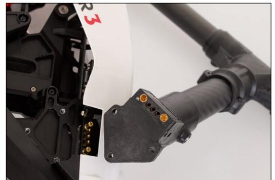
Sichere Stift- und Kontakt-Verbindungen garantieren absolute Betriebssicherheit. Befestigt werden die Ausleger allein über drei Inbusschrauben, was absolut ausreicht
