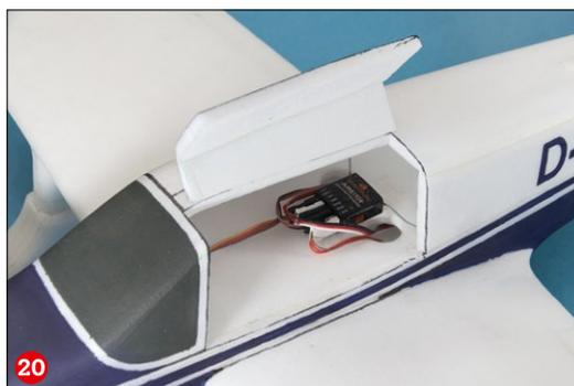
Die Rumpfbodenklappe kann hinten anscharniert und vorn mit kräftigen 3 × 5-Millimeter-Rundmagneten gehalten werden. Hier befindet sich der Zugang zum Akku, der vor den Flügel eingeschoben wird (19). Falls man nachträglich noch an den Empfänger herankommen möchte, kann man auch die Kabinentür aufschneiden und klappbar gestalten (20)
