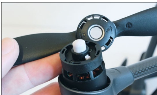
Die Propeller werden beim Typhoon H nicht aufgeschraubt, sondern einfach gesteckt und auf diese Weise arretiert
