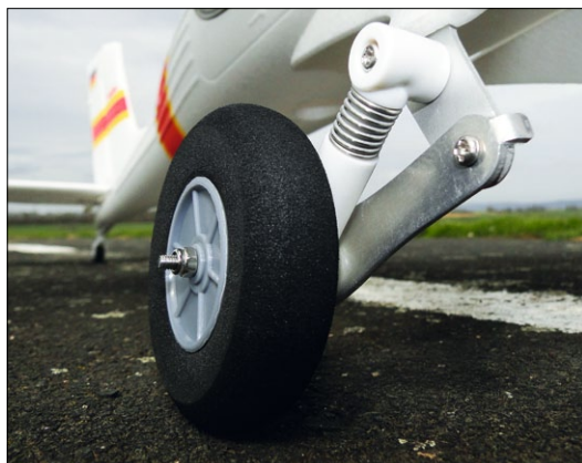
Technischer Leckerbissen: Die Schwingenfederung ist an das große Vorbild angelehnt
