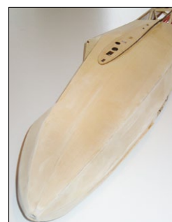
Das sauber verschliffene Rumpfbauwerk ist für die Bespannung vorbereitet
