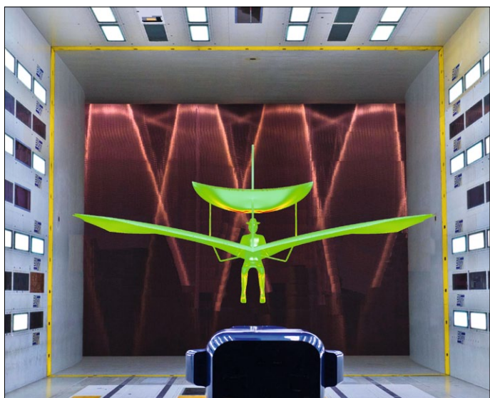
Simulation von Lilienthals Flug im Windkanal (Foto: DLR)
