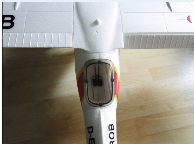
So klapp't's nicht: Beim Einsatz des vorgesehenen V-Kabels lässt sich nur eine Landeklappe fahren
