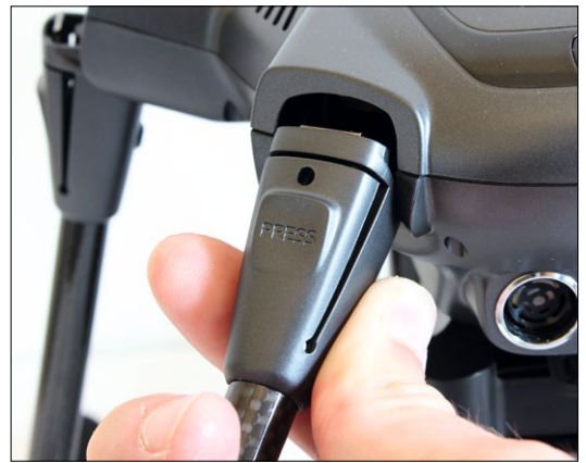
Einfach hochklappen und schon rasten die Ausleger ein
