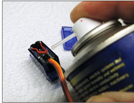
Das Servo fürs Wasserruder schützt man mit Wet-Protect vor Wasserschäden
