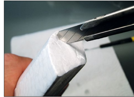
Mit einem scharfen Cutter-Messer bringen wir Einschnitte ins Heck des Schwimmers
