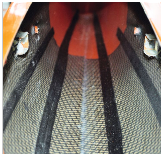
Der Rumpf ist im Bereich der Haube vom Hersteller mit CFK-Kevar-Gewebe verstärkt
