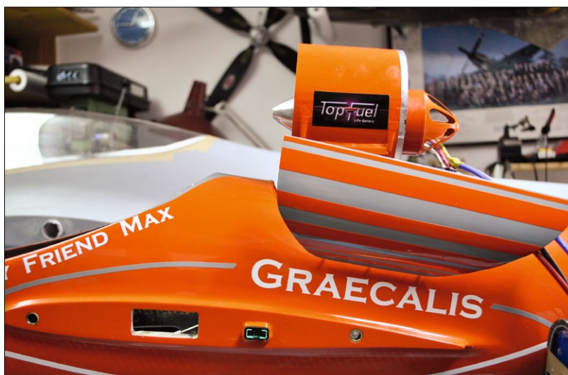
Der Anstellwinkel des Impellers sollte leicht nach hinten unten zeigen, so werden die Ruder gut angeströmt und das Modell fliegt ohne erkennbare Veränderung weiter geradeaus, wenn er läuft
