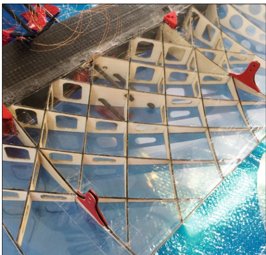
Der Hydra-Flügel von unten. Die roten Elemente zur Befestigung von Fahrwerk und Leitwerksträger stammen aus dem 3D-Drucker. Motor und Batterie sind an drei CFK-Röhren befestigt, die im Profil stecken. Die Servos sind mit lackierten Kupferdrähten angeschlossen
