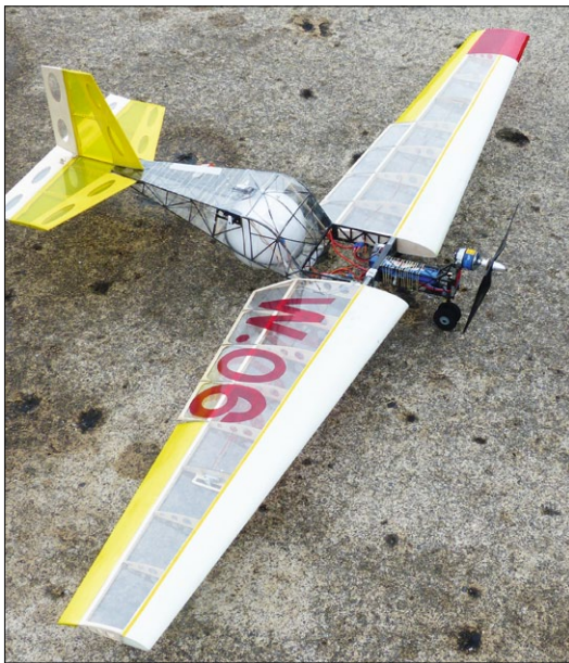
Modell mit 650 Gramm aus chinesischer Feinarbeit bei dem Wölbklappen das Hochauftriebs-Profil ersetzen. Fürs Fliegen wird das Mittelstück zwischen den Flügeln mit einer Haube verkleidet, die bis zu vier Kilogramm Wasser fasst
