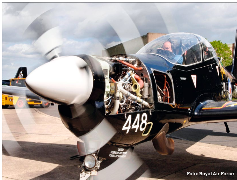
Triebwerks-Testlauf mit abgenommener Triebwerksverkleidung der Pratt & Whitney Propellerturbine
