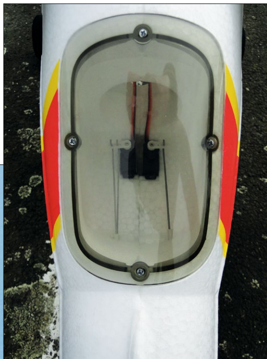
Unter der Heckscheibe sind die Servos für Höhenruder, Seitenruder und Spornrad sichtbar
