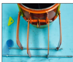
Die Arme der Impellermechanik werden kugelgelagert und am Impellerring mit 24-Stunden-Epoxy verklebt
