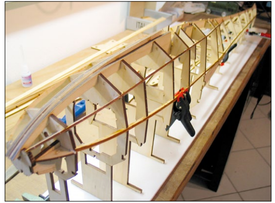
Der Rohbau des Rumpfs entsteht über Kopf auf einer Depronhelling
