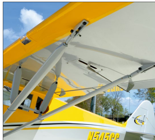
Die sehr gut aussehenden und zu justierenden steifen Verstrebungen sorgen für eine bretharte Tragfläche
