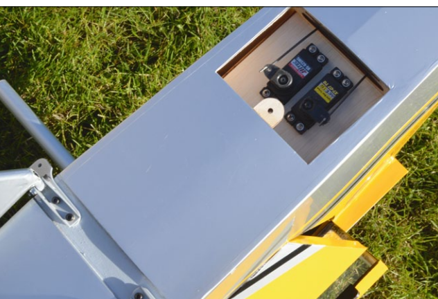
Die beiden Servos für Höhe und Seite sind von unten zugänglich, der Schacht wird mit einem Deckel verschlossen
