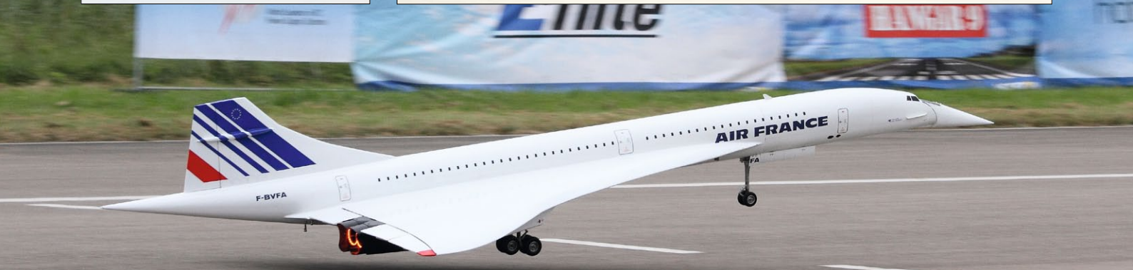
Concorde von Norbert Hesse mit 4.400 Millimeter Länge und absenkbarer Nase
