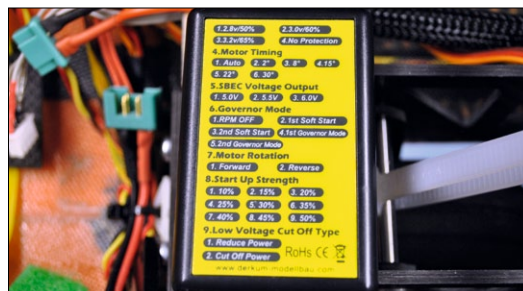
Mit dem Steuergerät für den neuen Regler von DerKum kann man alle Parameter einstellen
