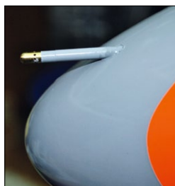
Der Sensor für die Geschwindigkeit ist strömungsgünstig in der Nase untergebracht
