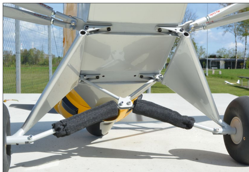
Unter den schwarzen Stoffverkleidungen verbirgt sich die robuste Federung des Fahrwerks
