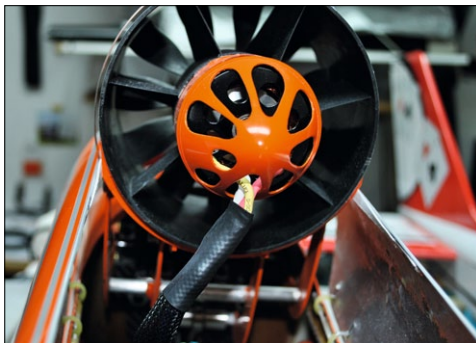
Der Antriebsmotor wurde am Heck noch strömungsgünstig verkleidet, natürlich mit den nötigen Kühllöffnungen
