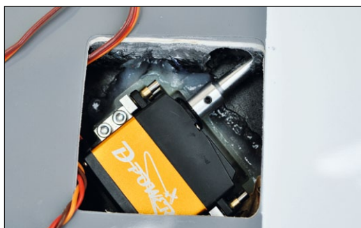
Die Servos müssen für den RDS-Antrieb leicht schräg eingeklebt werden, damit die Winkel der Endstücke in 90 Grad zum Ruder stehen
