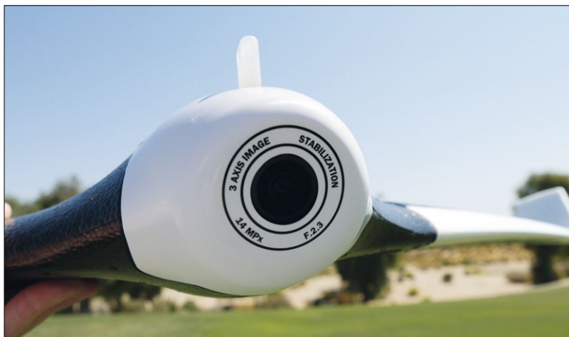
Die Kamera in der Rumpfnase der Disco kennt man von der Bebop Drone 2. Sie verfügt über 14 Megapixel und nimmt in Full-HD auf
