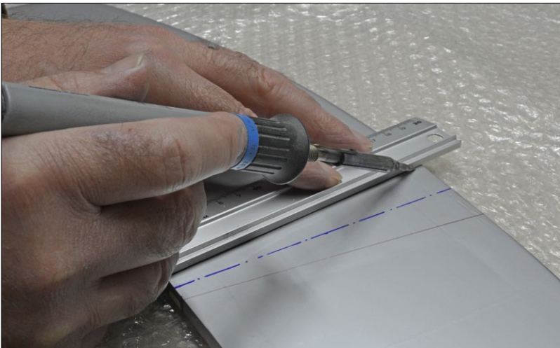
Von der exakten Mittellinie ausgehend wird die Folie für die Leitwerk-Rumpfverklebung mit einem Lötkolben getrennt
