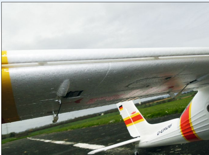
Auftriebshilfe: Die Vorflügel tragen zu den gutmütigen Flugeigenschaften bei
