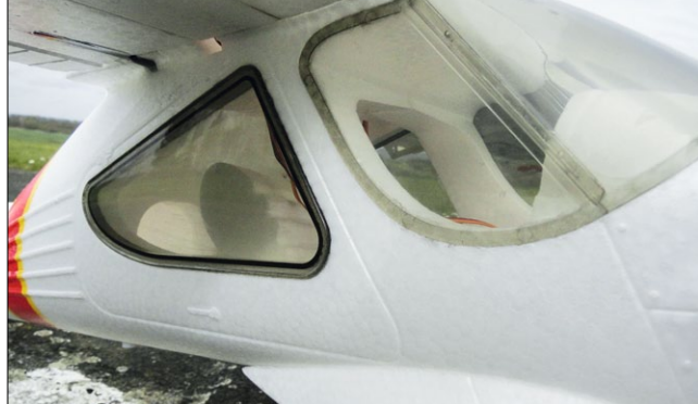
Durchblick: Die Kabinenverglasung aus rauchfarbenem Hartplastik ist bündig eingesetzt
