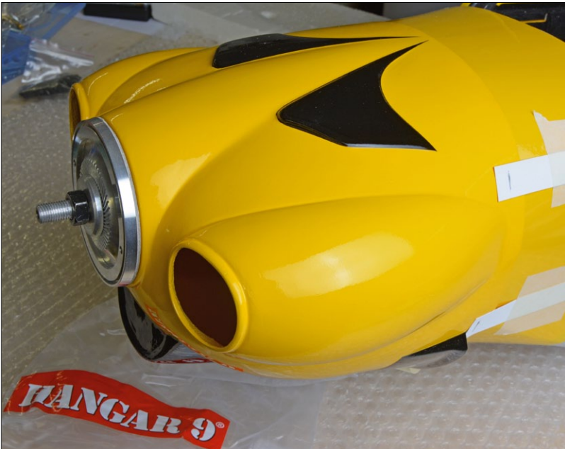
Schraubt man die Spinnergrundplatte am Motor fest, hinterlegt einen zirka 1,5 mm dicken Kartonring und richtet danach die Motorhaube aus, ergibt das hinterher einen exakten Übergang mit dem notwendigen Abstand
