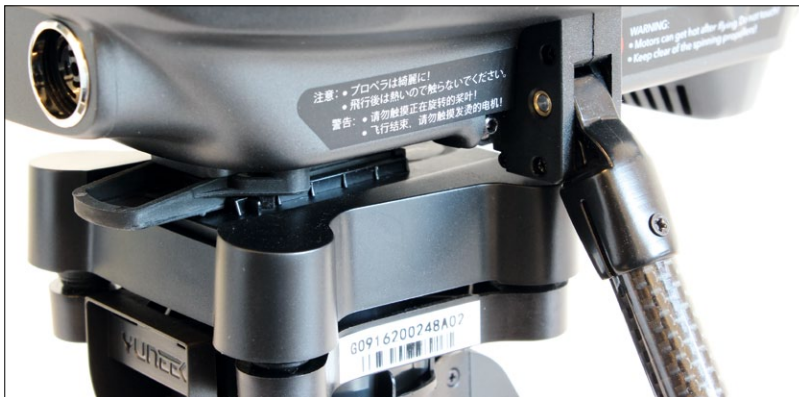
Das Landegestell ist klappbar ausgeführt und kann über den Sender herauf- und heruntergefahren werden. Das Herzstück, die Kamera CGO3+ lässt sich als komplette Einheit vom Kopter lösen
