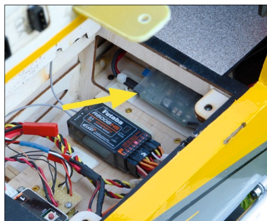
Hier sitzt der Jeti Spannungsregler
