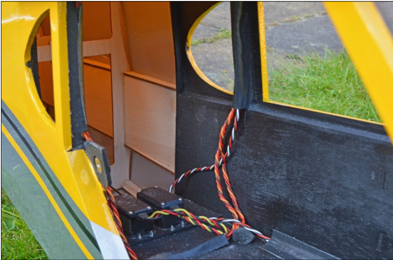
Die längs eingezogenen Brettchen nach hinten sorgen für eine gute Torsionssteifigkeit des Rumpfes, ohne das Bild der Bespannung zu stören
