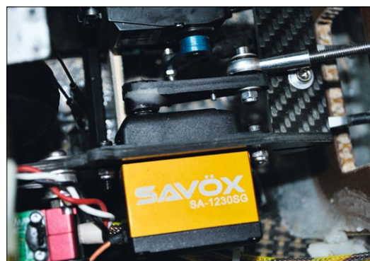
Mindestens ein 20-Kilogramm-Servo sollte es schon sein, das den Impeller nach oben drückt
