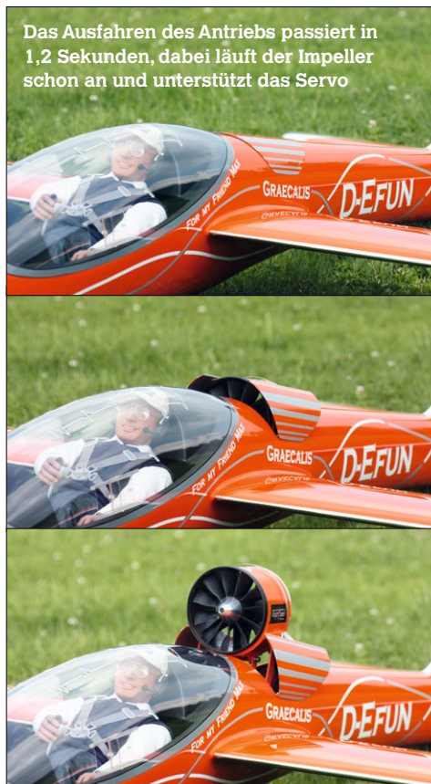
Der Antriebsmotor wurde am Heck noch strömungsgünstig verkleidet, natürlich mit den nötigen Kühllöffnungen
