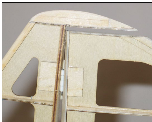
Das Seitenleitwerk wurde im oberen Bereich verstärkt
