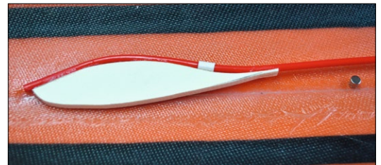
Die Führung für den Haubenverschluss wird mittels einer Holzplatte in Form gehalten, damit kein Knick entsteht
