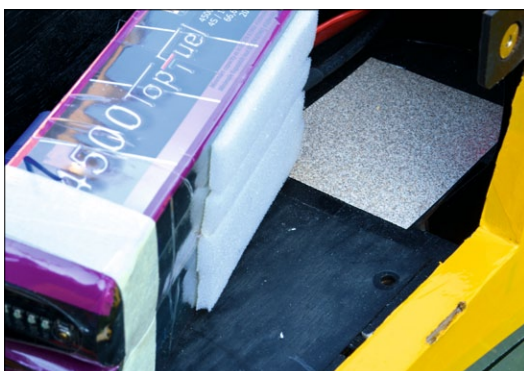
Ergibt eine rutschsichere Verbindung: Fensterdichtung auf Schleifpapier
