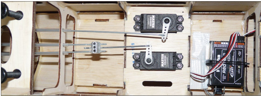
Für Höhen- und Seitenrunder werden die beiden Servos DS4020 in den vorbereiteten Aussparungen im Rumpf verschraubt
