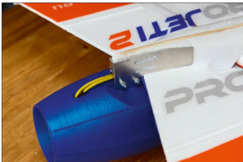
Die Kiefernleiste erfüllt gleich mehrere Funktionen. Wie schon bei der Pusher-Variante trägt ein Alu-Teil den Antrieb
