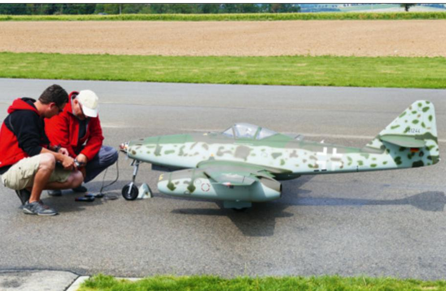
Die Messerschmitt Me-262 von Airworld Modellbau mit einer Spannweite von 3.210 Millimeter, angetrieben von zwei JetCat P100-RX, pilotierte Hacker Team-Mitglied Roy Puchtinger
