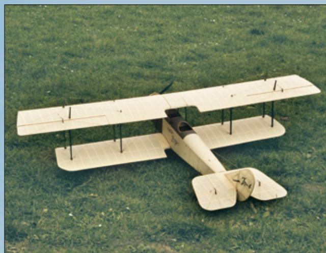
Abbildung 4: Die Curtiss Jenny – sie ist leicht und hat einen großen Flächeninhalt – fliegt Schrittgeschwindigkeit
