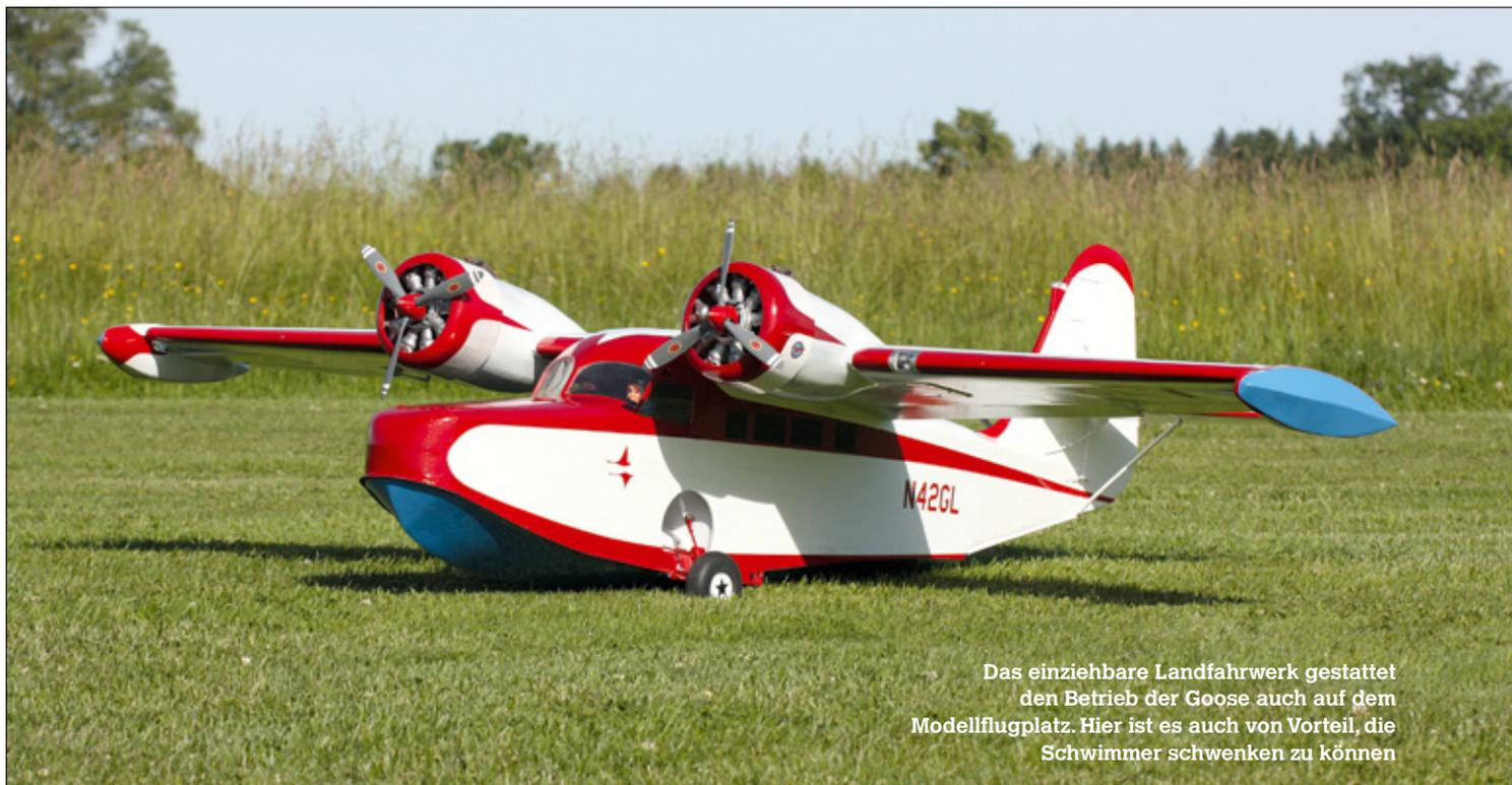
Das einziehbare Landfahrwerk gestattet den Betrieb der Goose auch auf dem Modellflugplatz. Hier ist es auch von Vorteil, die Schwimmer schwenken zu können
