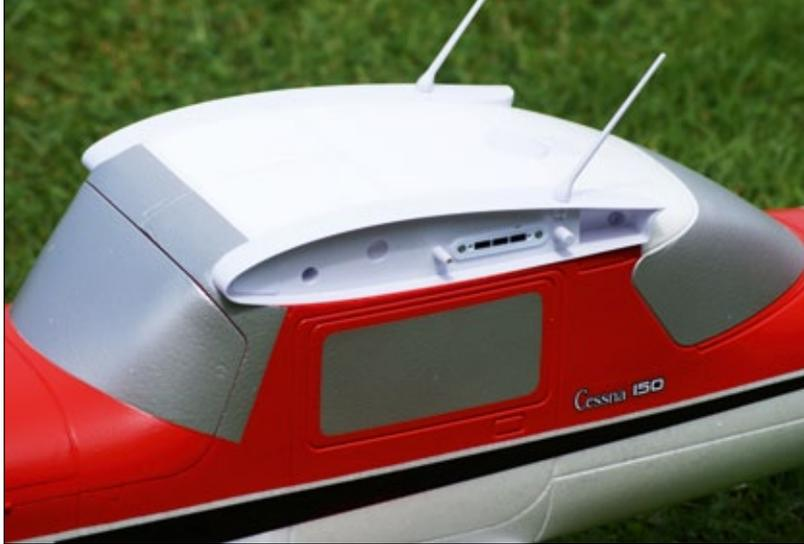
Der rumpfseitige Flächenanschluss mit der Aufnahme für das Steckungsrohr und den automatisch verbindenden Steckern für Querruder, Landeklappen und Beleuchtung
