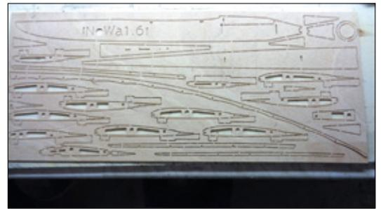
Ein Brett mit fertig gefrästen Teilen für den Bau von Rumpf und Flächen. Vor dem Raustrennen sind die Teile zu markieren
