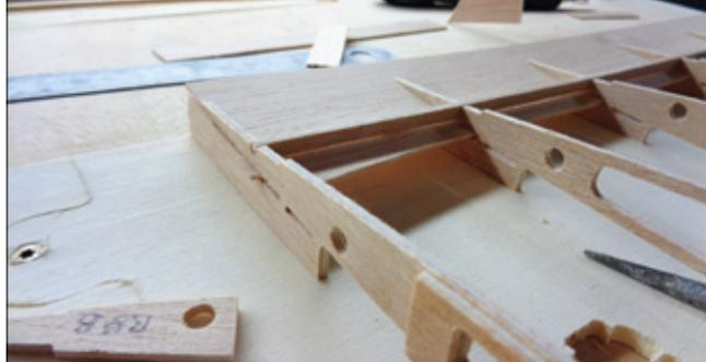
Hier wird die untere Beplankung eingeschoben
