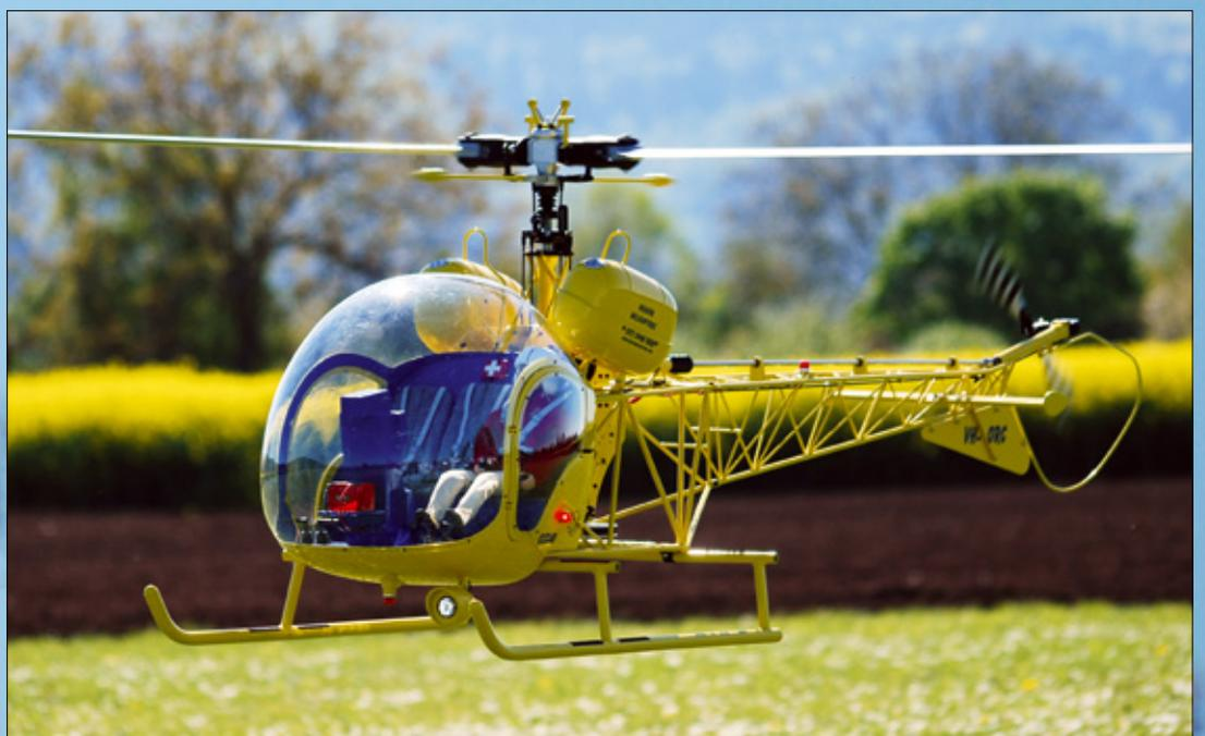
Neun Minuten Flugzeit sind mit dem verwendeten 12s-LiPo-Setup möglich
