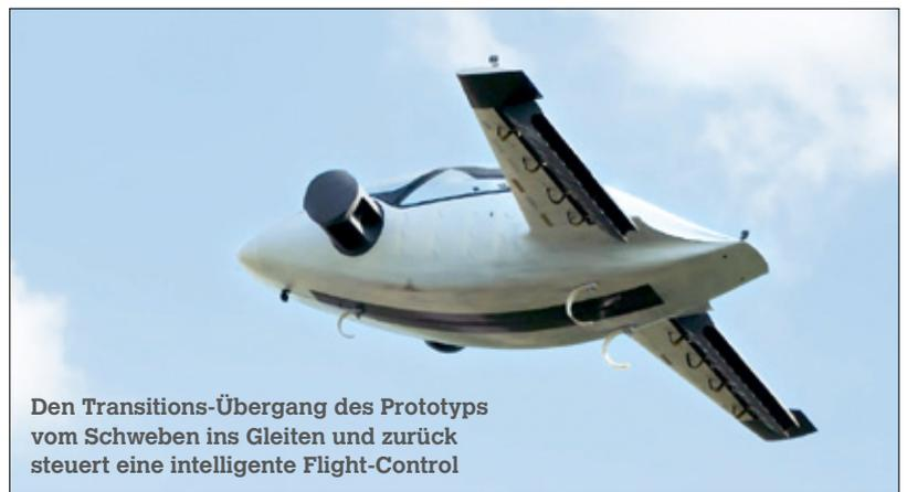
Den Transitions-Übergang des Prototyps vom Schweben ins Gleiten und zurück steuert eine intelligente Flight-Control
