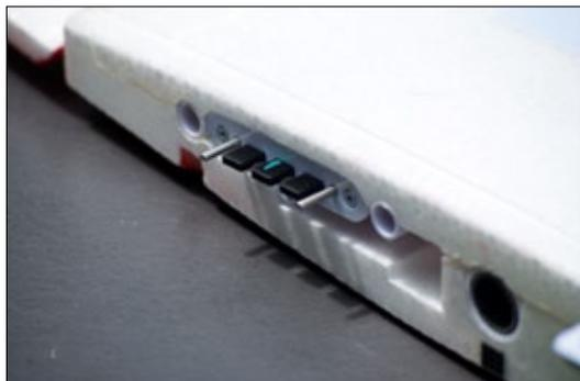
Die Wurzelrippen mit allen elektrischen Anschlüssen – ein Vertauschen von Kontakten ist ausgeschlossen
