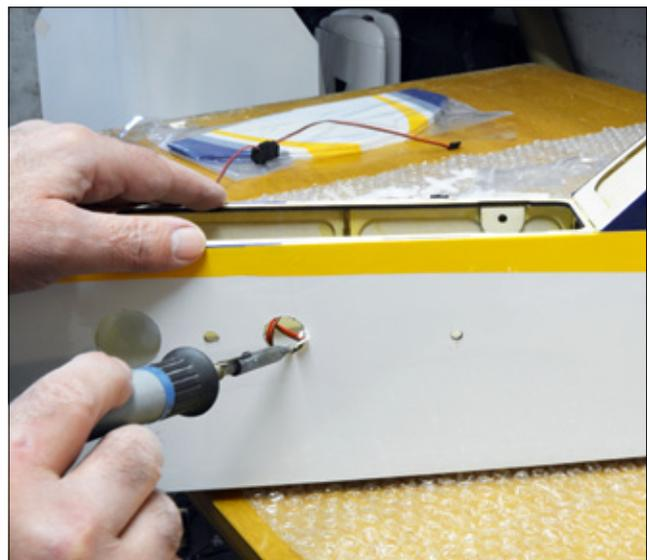
Da, wo notwendig, wird die Folie mit dem heißen LötKolben entfernt und nicht mit dem Skalpell
