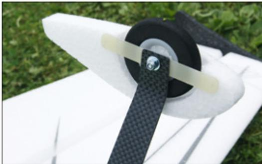
Die mitgelieferten Leichtträger werden durch Radschuhe aus EPP verkleidet
