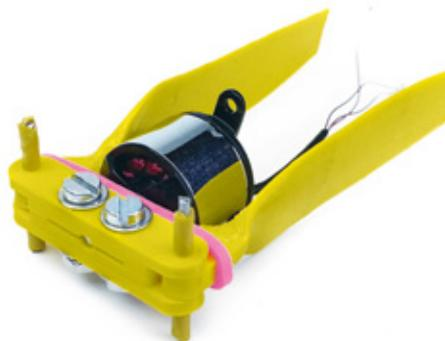
3D-gedruckte Klappluftschaube mit 5-Gramm-Brushlessmotor
