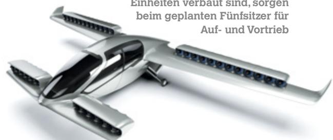
36 Triebwerke, die in zwölf Einheiten verbaut sind, sorgen beim geplanten Fünfsitzer für Auf- und Vortrieb
