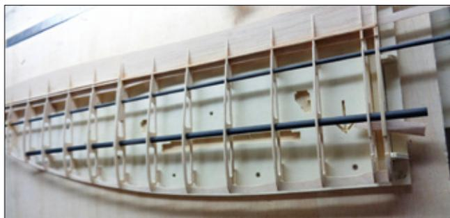
In diesem Baustadium kann der komplette Flügel mit Sekundkleber geklebt werden
