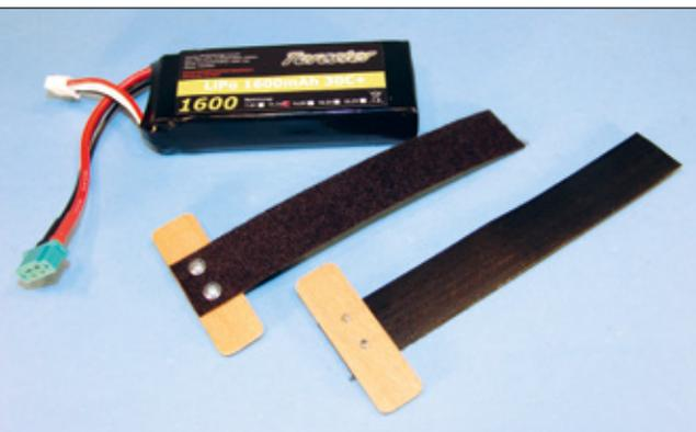
Die Befestigung des Flugakkus erfolgt über eine Klettbandschleife, die an einem Stück Holz befestigt ist
