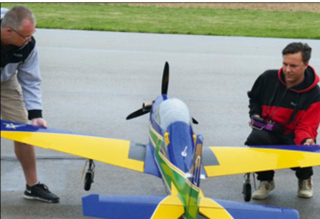
Robin Trumpp (rechts) aus dem Hacker-Team, bekannt und erfolgreich in der F3A-Szene, hier mit seiner Turboprop T-27 Tucano aus dem Hause CARF Models. Im Maßstab 1:4 erzielt das Modell ein Fluggewicht von 18,5 Kilogramm bei 2.800 Millimeter Spannweite
