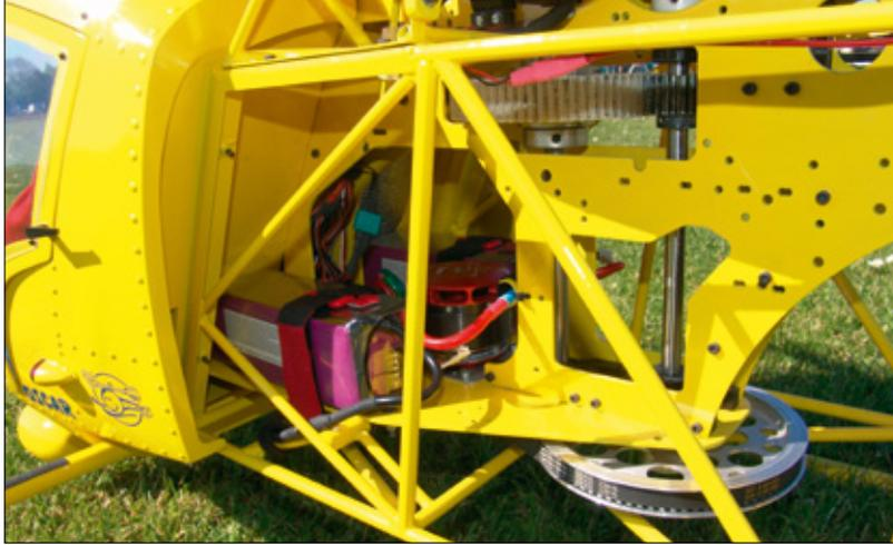
Das Getriebe der „elektrifizierten“ Benzin-Mechanik ist zweistufig ausgelegt. In der ersten arbeitet ein Zahnriemen (ganz unten), von wo aus über eine lange Ritzelwelle die zweite Stufe (Zahnradgetriebe) angetrieben wird
