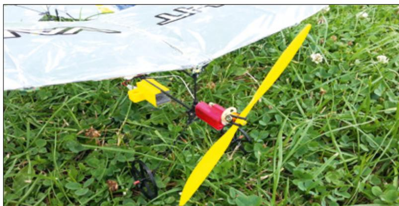
Night Vapor mit 3D-gedruckter Luftschraube und gedrucktem Tuning-Antrieb
