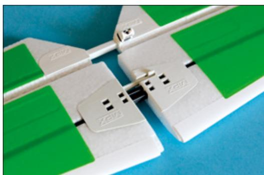
Das ist der Lieferumfang der RR-Version: Das Höhenleitwerk ist zweiteilig und als Klappenruder ausgeführt. Eine Verriegelung stellt sicher, dass das Leitwerk an Ort und Stelle verbleibt
