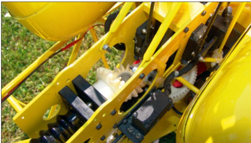
Blick auf das robuste Kegelradgetriebe des Heckrotor-Abtriebs. Zu erkennen ist auch das kopfstehende, am Seitenteil verschraubte Heckservo
