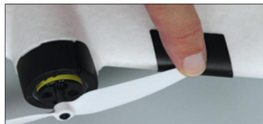
Die Armierung der Fläche mit einem Plastikschutz verhindert wirkungsvoll Schäden am Schaummaterial
