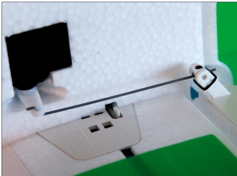
Das Höhenruderservo steuert das Ruder auf direktem Weg an. Der überstehende „Knubbel“ am Höhenleitwerk ist dessen Verriegelung
