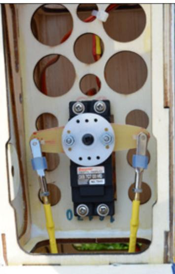
Das Seitenruder wird über Stahlseile spielfrei angelekt. Die hierfür selbst gefertigte Servoarmverlängerung besteht aus einer 2 Millimeter starken GFK-Platte
