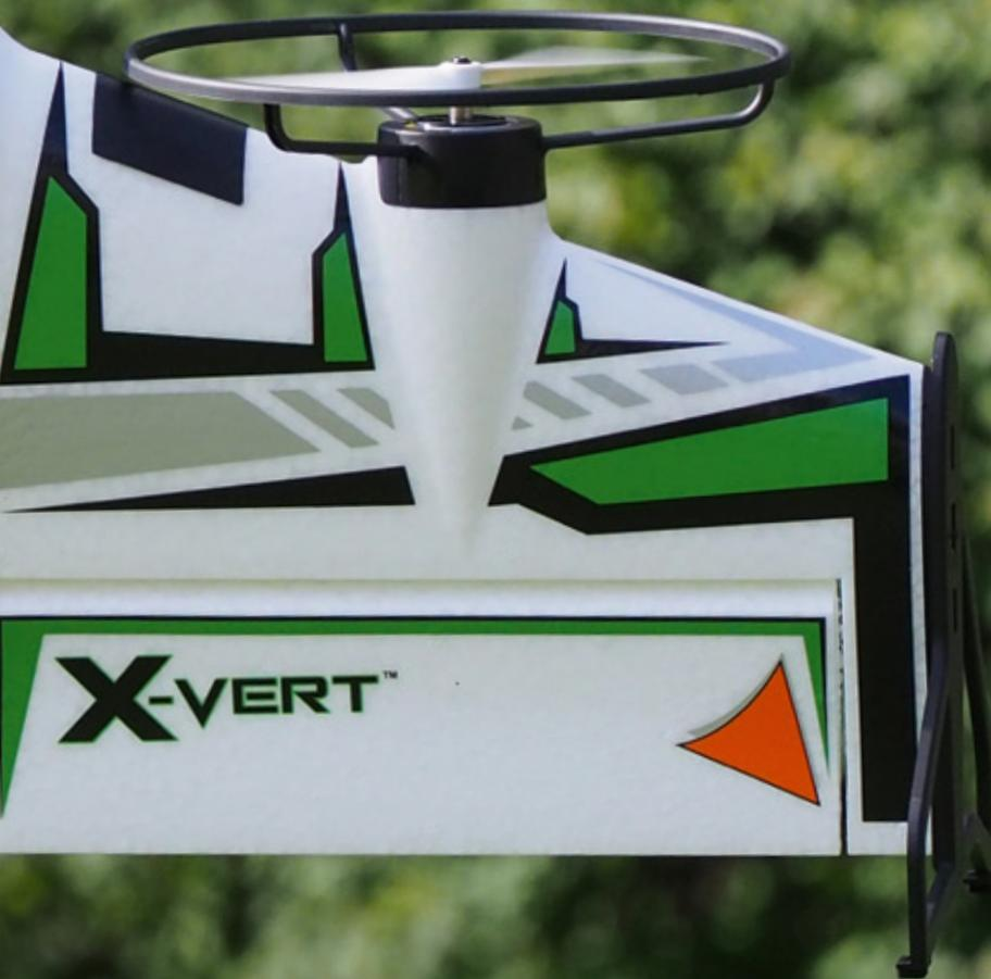
tronik vor, die ein Modell wie das X-Vert im Griff hat. Die dazu erforderliche Sensorik und Elektronik ist auf einem relativ kleinen, kompakten, zentral im Modell platzierten Baustein zusammengefasst. In diesem implementiert sind die Regler für die beiden Brushless-Motoren, der Spektrum-Empfänger und die Flight-Control. Zwei Mikro-Servos der 4-g-Klasse und zwei Außenläufer der 10-g-Klasse runden das Technikpaket ab.
