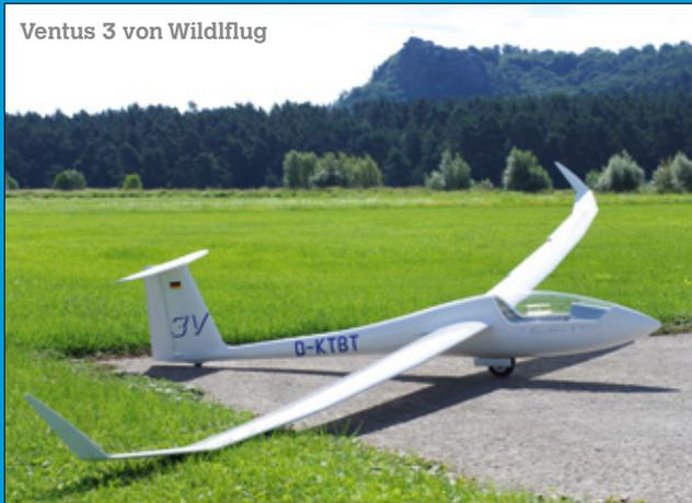
Einen Nachbau des Ventus 3 im Maßstab 1:3,75 hat Wildflug jetzt auf den Markt gebracht. Der Segler hat eine Spannweite von 4.800 Millimeter und ist 1.810 Millimeter lang. Den Flächeninhalt gibt der Anbieter mit 78,6 Quadratdezimeter an. Beim Profil fiel die Wahl auf ein HQ 2,5/14 mod. Das Gewicht ist mit 6.400 Gramm angegeben. Erhältlich ist die Ventus 3 in einer Voll-GFK- bis Dreifach-Hartschalen-Version. [www.wildflug.de](http://www.wildflug.de)
