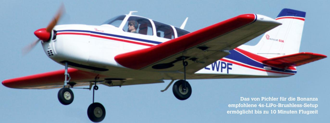
Das von Pichler für die Bonanza empfohlene 4s-LiPo-Brushless-Setup ermöglicht bis zu 10 Minuten Flugzeit
