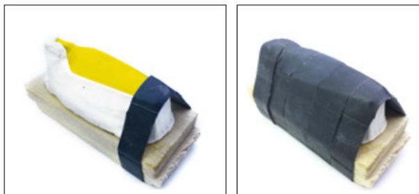
Streifen von Fahrradschlauch dienen als hitzebeständige Gummiringe zur endgültigen Formgebung
