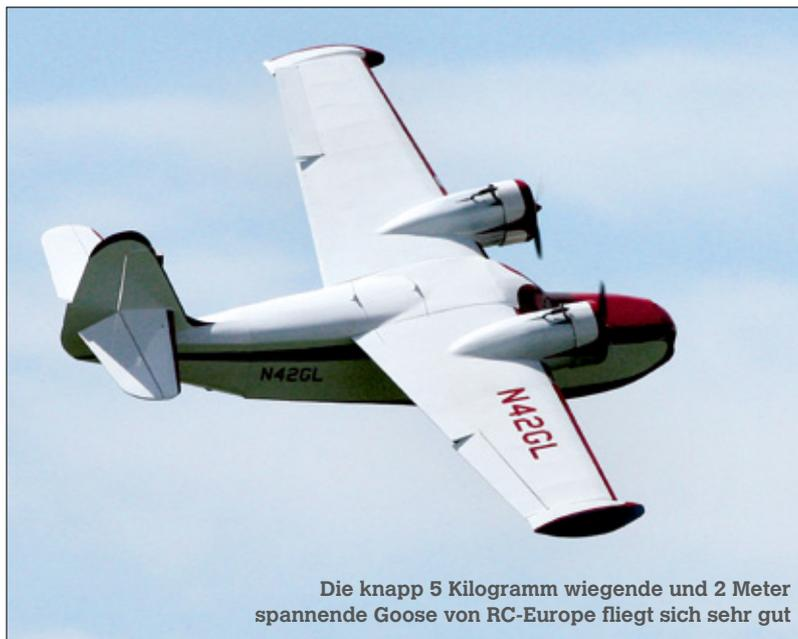
Die knapp 5 Kilogramm wiegende und 2 Meter spannende Goose von RC-Europe fliegt sich sehr gut
