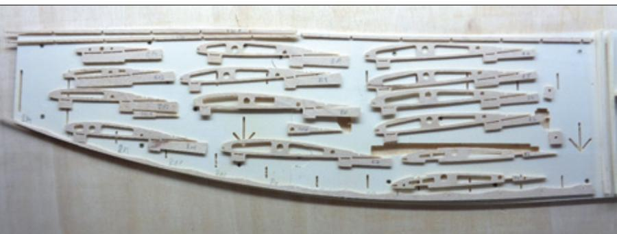
Die passenden Frästeile zuordnen. Die Füßchen sind individuell passend, sodass keine Verwechslung droht
