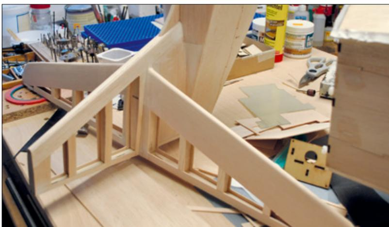
Eine Besonderheit des Grumman Goose-Bausatzes ist die Zweiteilung des Rumpfs. Man muss nur achtgeben, für einen deckungsgleichen Bau zu sorgen
