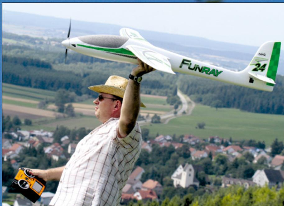
Das Modell lässt sich gut unterhalb der Tragfläche greifen und dadurch mit ordentlichem Schwung über die Hangkante befördern
