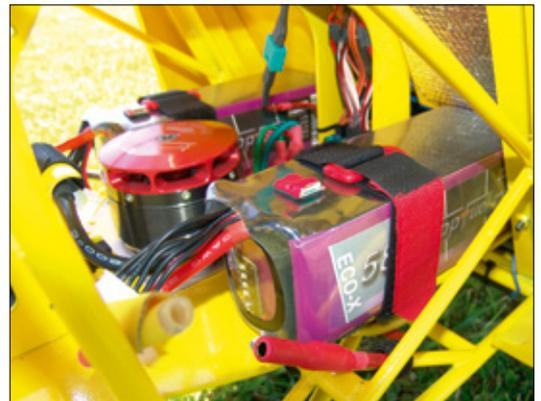
Der Pyro ist auf der Chassis-Bodenplatte montiert, die beiden in Serie geschalteten 6s-LiPos von Hacker flankieren ihn beidseitig
