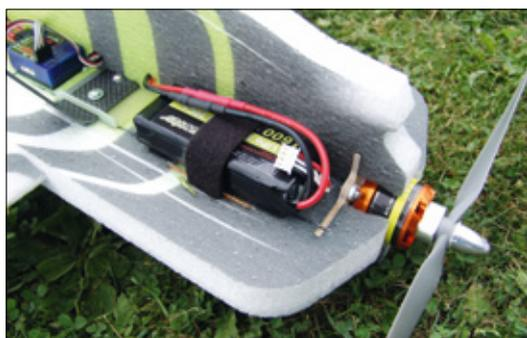
Die ursprüngliche Position des Schwerpunkts laut Anleitung sah den Antriebsakku möglichst weit vorne. Nach dem Einfiegen wurden die Komponenten neu platziert
