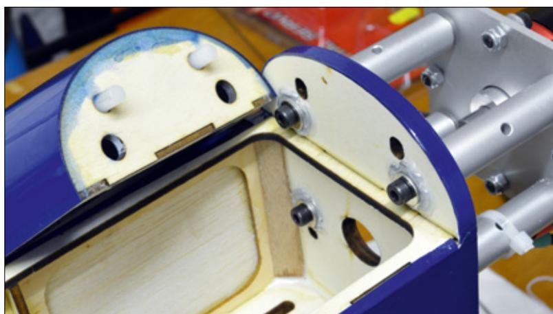
Die gekonterte Motorträgerhalterung. Die Inbusschrauben sind in den Einschlagmuttern verschraubt. Die Alu-Abstandsbolzen wiederum werden fest auf die Inbusschrauben gedreht
