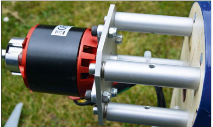
Mit Unterlegscheiben wird der Seitenzug des Quantum II 55 eingestellt
