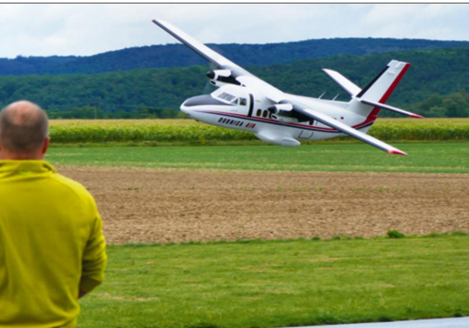
Die Let L-410 UVP Turbolet ist die tschechische Konstruktion eines regionalen Kurzstreckenflugzeugs von 1969. Das Modell hat 3.255 Millimeter Spannweite wiegt 13 Kilogramm und wird von zwei AXI 4130/20 angetrieben. Gebaut von Zdeněk Raška Senior fliegt es aber meist sein Sohn Zdeněk Raška Junior
