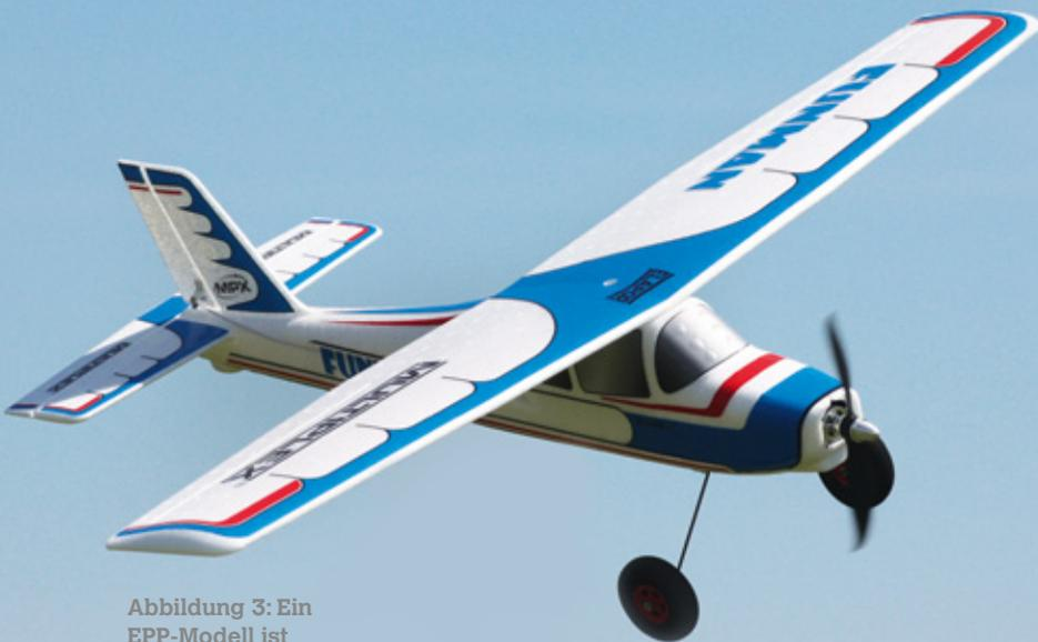
Abbildung 3: Ein EPP-Modell ist nicht jedermanns Geschmack, für Einsteiger hingegen hat es wegen der geringeren Masse und dennoch hohen Festigkeit deutliche Vorteile
