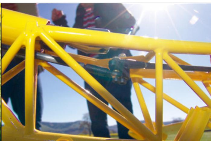
Der Vario-Heckrotor wird über eine Kohlefaser-Schubstange angelenkt, die zur Überbrückung an der Heck-Abwinkelung mit einem Hebel versehen ist
