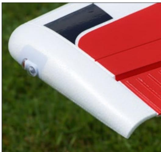
Die Beleuchtungseinheit im Randbogen mit Positionslampe und Stroboskopblitzer
