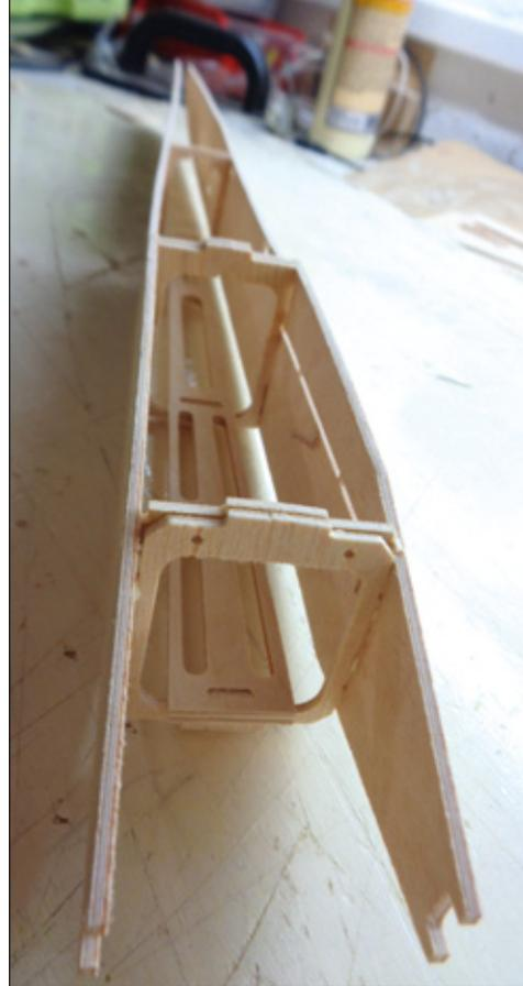
Die Rumpfseitenteile sind befestigt, jetzt kommen Deckel, Finne und Motorverkleidung
