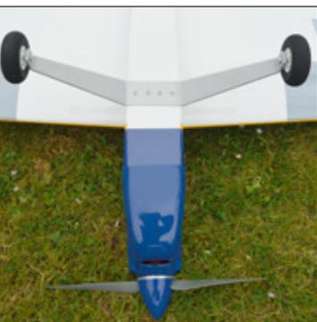
Das einfache Hauptfahrwerk ist ausreichend stabil am Rumpf befestigt
