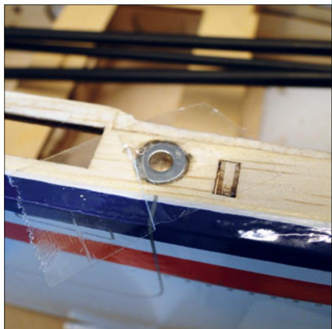
Der Kabinenhaubenverschluss wurde modifiziert. In den Rahmen wurden Magnete eingelassen. Tesa verhindert das Verkleben der Magnete beim Ausrichten
