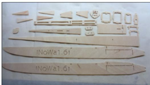
Die zum Bau des Rumpfs erforderlichen Holzteile sind vor der Montage einmal geschliffen worden
