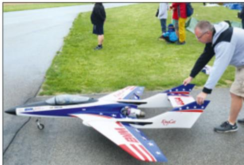
Ewald Trumpp flog diese KingCat von BVM Jets. Das Fluggewicht von 15 Kilogramm verteilt sich auf 2.000 Millimeter Spannweite
