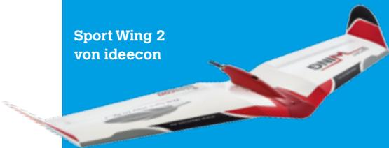
Der Sport Wing 2 von Ideecon mit einer Spannweite von 1.240 Millimeter und neuem Design ist aus einem neuen EPO-Leichtschäum gefertigt, der das Modell 20 Prozent leichter machen soll als sein Vorgänger. Die Seglerversion erreicht dadurch ein Abfluggewicht von zirka 315 Gramm, die Elektroverson hingegen ab 430 Gramm. Durch den CNC-gefrästen Doppel-Hauptholm verfügt die Zelle über eine hohe Festigkeit. Ideecon bietet den Sport Wing 2 ab 89,- Euro an. [www.ideecon.eu](http://www.ideecon.eu)
