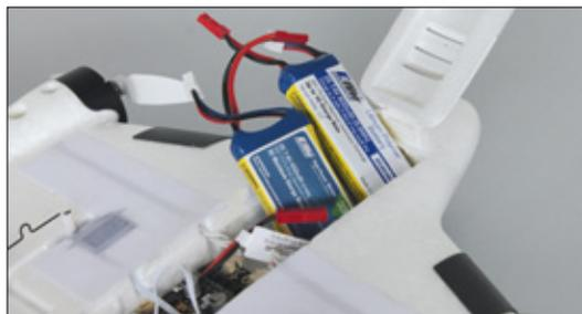
Vom 450er- bis 800er-Akku in 2s-Konfiguration finden im Akkuschacht Platz. Wichtig ist ausreichend Klettband zur sicheren Fixierung
