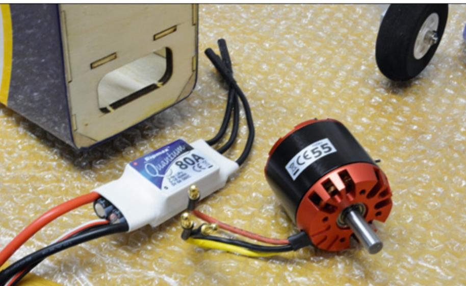
Das empfohlene und verwendete Antriebsset bestehend aus Quantum-Regler und -Motor
