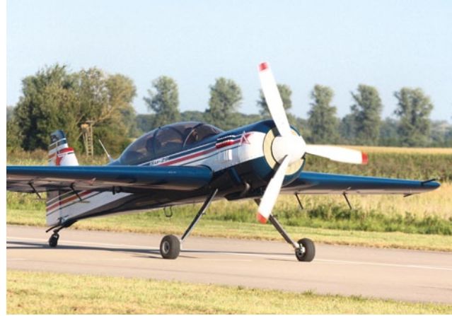
Abbildung 5: Mannttragende Kunstflug-Muster verzichten auf hoch gebaute Rümpfe, was an der zweisitzigen Su-29 mit runden Rumpf besonders offensichtlich wird
