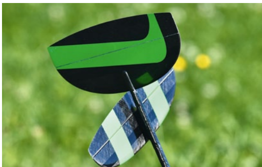
Das Seitenleitwerk ist ab Werk bereits am Rumpf befestigt. Das Höhenleitwerk ist auf einem Pylon festzuschrauben
