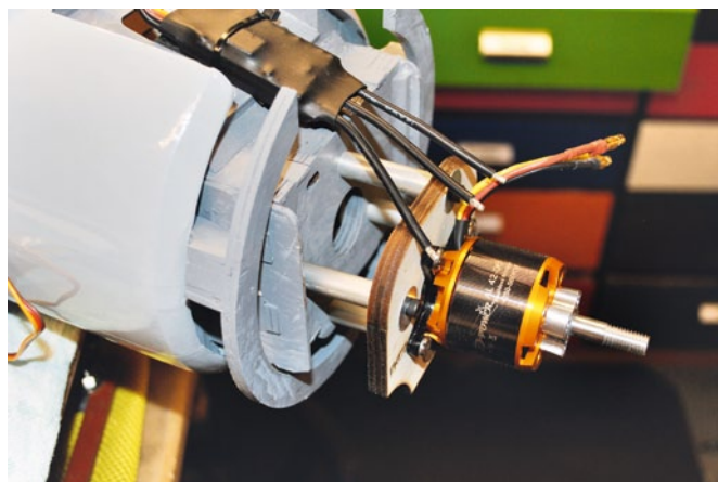
Klassisch ausgeführte Montage mit Distanzhülsen und Motorbefestigungsspannt zur Rückwandmontage. Sturz und Zug lassen sich so perfekt einstellen
