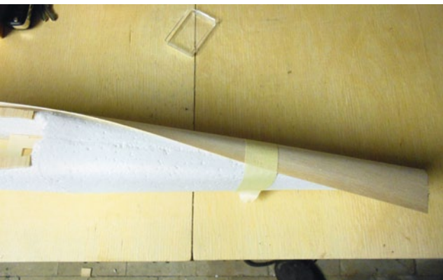
Festigkeit erhalten Styroporsteile durch Beplanken mit Holz oder beispielsweise GFK-Auflage. Auf jeden Fall werden somit klasse Modelle möglich
