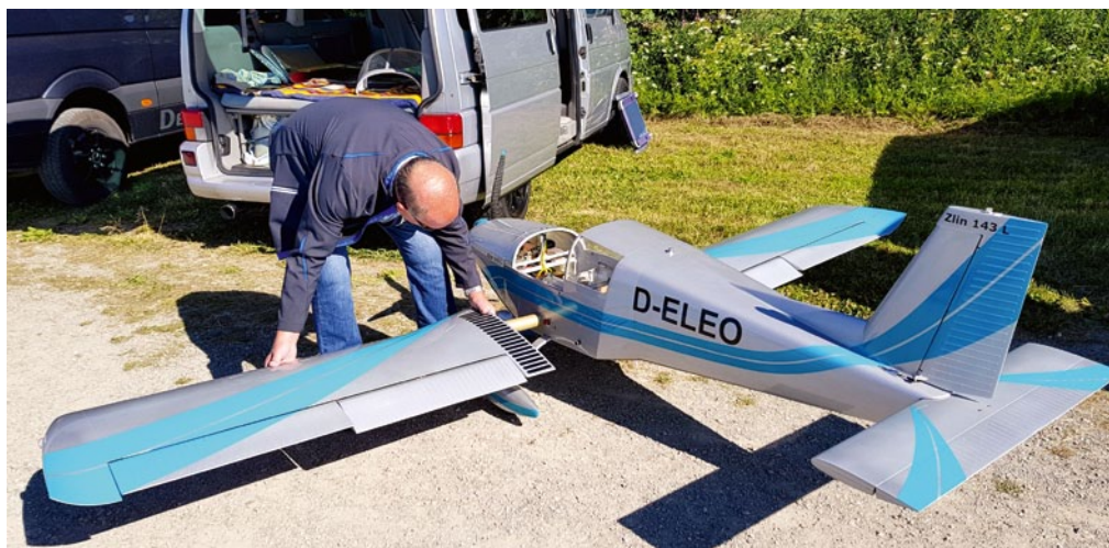
Leo Diekmannshelmke beim Aufbau der neuen Voll-GFK-Version der Delro Zlin 143L. In der Modell-Oberfläche sind alle Sicken, Nieten und Blechstöße entsprechend dem Original eingearbeitet. Die für die Abformung nötigen Positive hatte Fritz Eickhoff für Delro angefertigt
