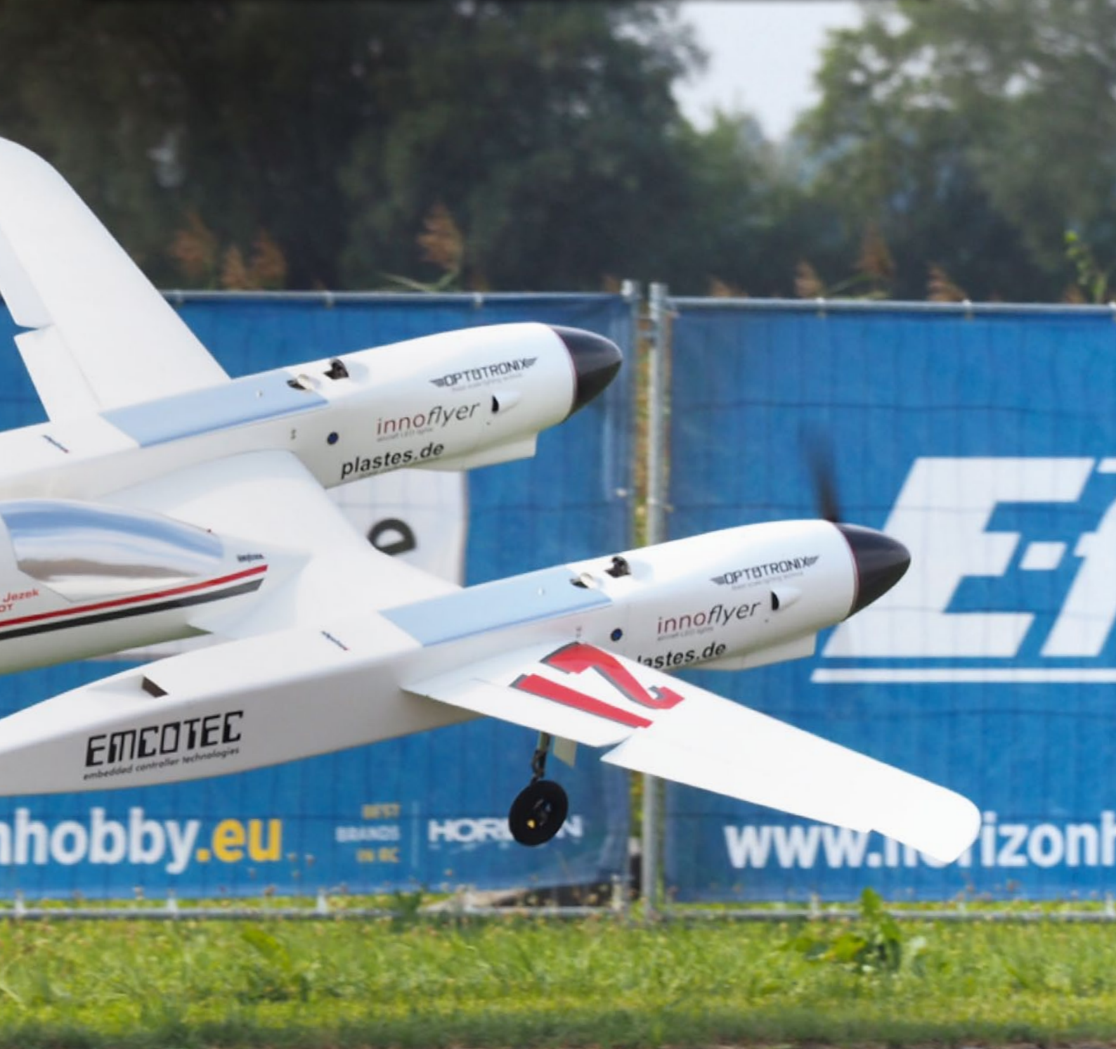
Der Holz-Eigenbau ist erstklassig umgesetzt, was optisch durch den perfekten Übergang von Spinner zu Träger getoppt wird (1). Ungewöhnliche Auslegung für ein Flugzeug, unterstrichen von den V-förmigen Seitenfinnen (2). Der mittig platzierte, schnittige Rumpf ist ein Charaktermerkmal des Pond Racer (3)
