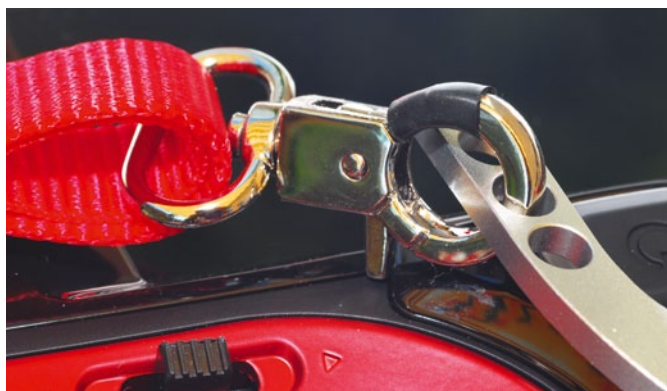
Mittels eines kurzen Stücks Schrumpfschlauch wird der Haken vor unbeabsichtigtem Öffnen gesichert
