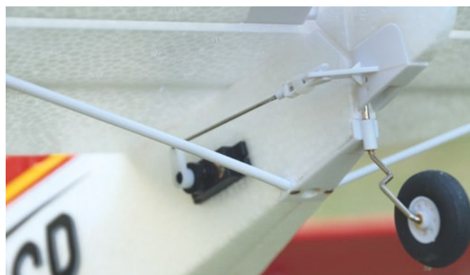
Ab Werk sind bereits alle Servos eingebaut und betriebsbereit. Beim Seitenruder wird zugleich der Sporn mitgenommen
