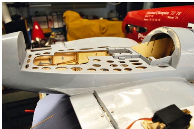
Eine der beiden Motorgondeln. Über den unten platzierten Deckel hat man Zugang zum Fahrwerk sowie zum Antrieb. Eine Herausforderung ist die Verbindung beider Landeklappen
