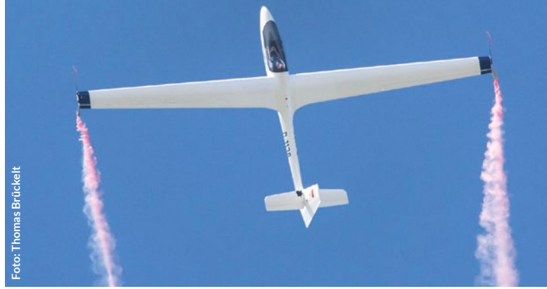
Um die geflogenen Kunstflugfiguren für die Zuschauer besser zu verdeutlichen, hat diese SZD-59 Acro Rauchpatronen an den Flächenspitzen
