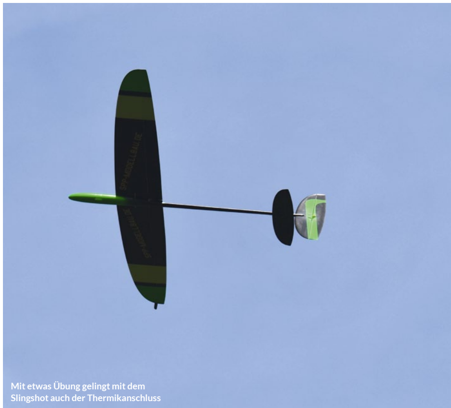
Das Seitenleitwerk ist ab Werk bereits am Rumpf befestigt. Das Höhenleitwerk ist auf einem Pylon festzuschrauben
