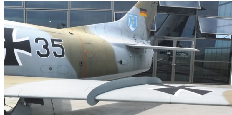
Abbildung 3: Ein Grenzschichtzaun kann helfen, Querströmungen zu unterdrücken
