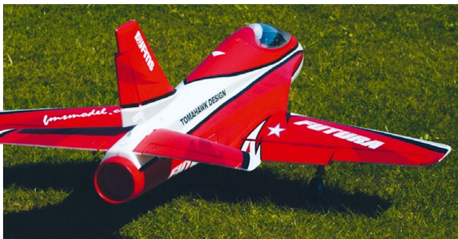
Das Fahrwerk ist absolut Rasenplatz-tauglich und der Impeller so kräftig, um das Modell sicher zu starten
