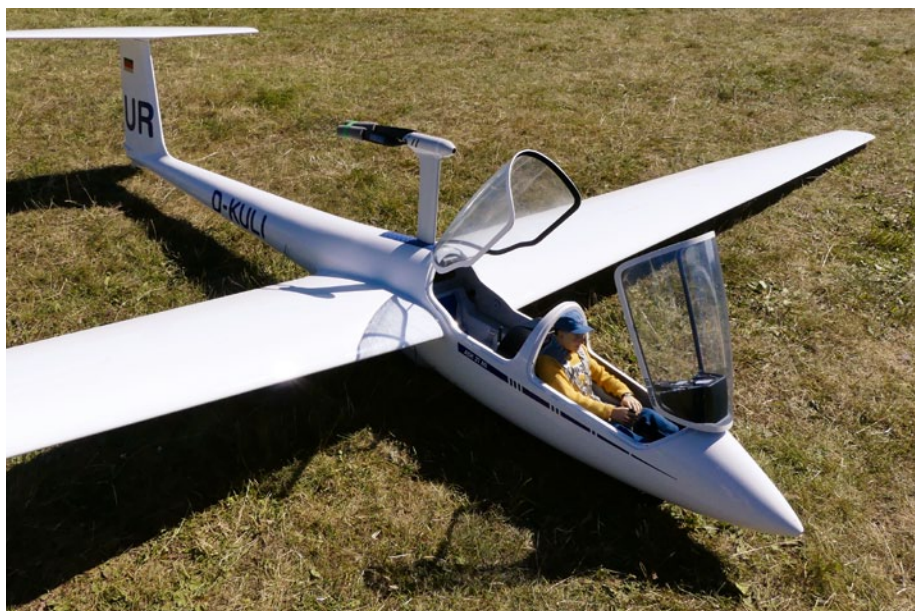
Uli Richter ist eine bekannte Größe an den Hängen rund um die „Kuppe“. Hier seine ASK-21 im Maßstab 1:3 von KD-Modellbau mit vorbildnaher Cockpitgestaltung. Der 5.650 Millimeter spannende und 14 Kilogramm wiegende Segler ist mit einem steckbaren Elektromotorausatz AIRlift von Airworld ausgerüstet. Der Antrieb ist ein Hacker B50, versorgt aus einem 11s-LiPo
