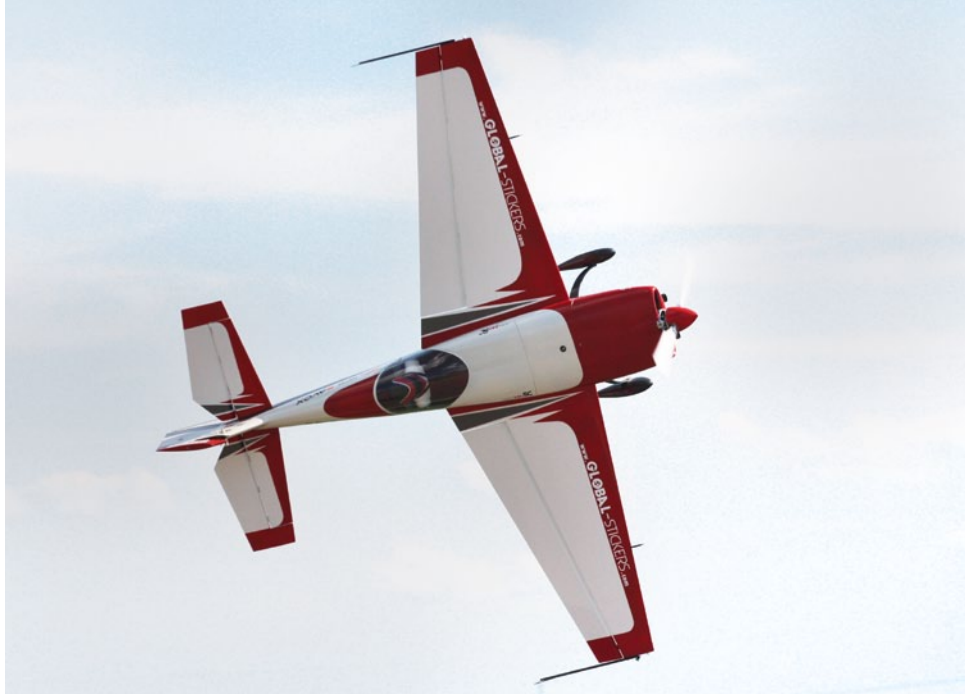
Ein Kunstflugmodell aus der Drei-Meter-Klasse. Das Besondere an dieser Extra 330SC ist die Ausstattung mit einer Vektor- und Pitchsteuerung
