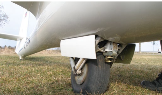
Das Rad des Einziehfahrwerks hat die Größe 350 × 135 Millimeter
