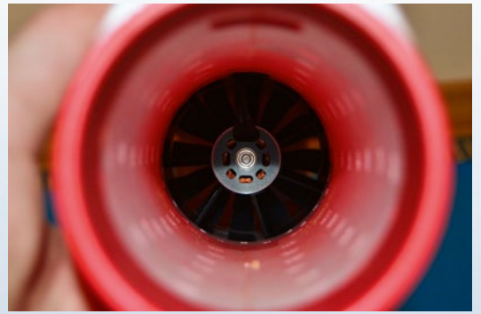
Ein Brushless-Innenläufer mit 2.000 kv sorgt im 80-Millimeter-Impeller für gewünschten Schub
