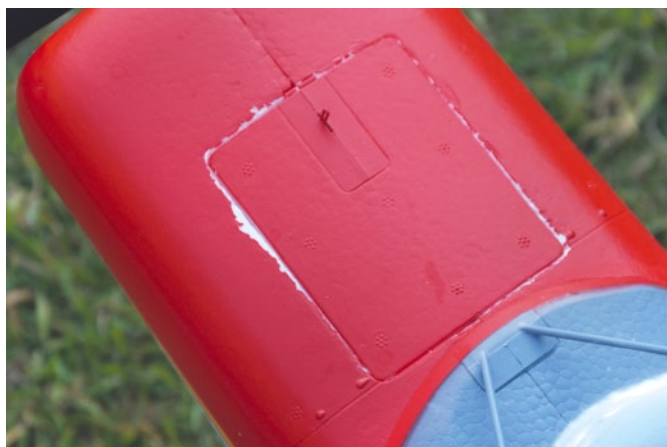
Leider ist rund um den Akkuschacht schon etwas Farbe abgeplatzt. Das muss man nach so vielen Einsätzen aber in Kauf nehmen
