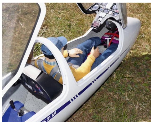
Uli Richter ist eine bekannte Größe an den Hängen rund um die „Kuppe“. Hier seine ASK-21 im Maßstab 1:3 von KD-Modellbau mit vorbildnaher Cockpitgestaltung. Der 5.650 Millimeter spannende und 14 Kilogramm wiegende Segler ist mit einem steckbaren Elektromotorausatz AIRlift von Airworld ausgerüstet. Der Antrieb ist ein Hacker B50, versorgt aus einem 11s-LiPo
