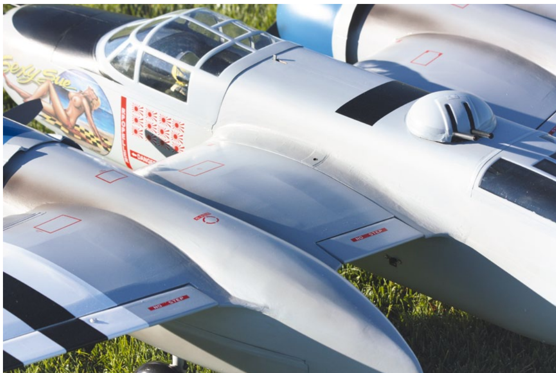
Der ferngesteuert drehbare MG-Turm ist ein Show für sich. Die Verbindung beider Landeklappen über einen Draht erfordert Geduld
