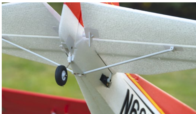
Die Heckpartie von unten mit der sehr direkten Anlenkung und dem abgestrebten Höhenleitwerk
