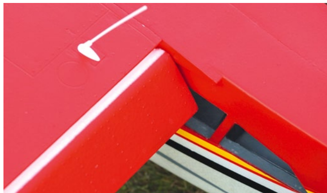
Bei vollem Klappenausschlag sieht man, dass die Vorderkante der spaltfreien Landeklappen nicht mit lackiert wurde
