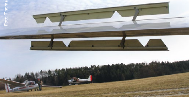
Die Bremsklappen nach dem System Schempp-Hirth sind ausgefahren. Bei neueren Maschinen sind die Störklappen nur noch an der Flügeloberseite angebracht
