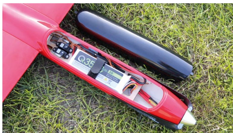
Mit einem 3s-LiPo der 3.500er-Klasse und etwa 300 Gramm Gewicht konnte der Schwerpunkt ohne Trimmblei eingestellt werden
