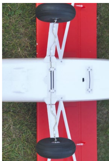
Rechts befindet sich die Aufnahme für das Schwimmerfahrwerk und links ist das sehr solide Räderfahrwerk eingesteckt
