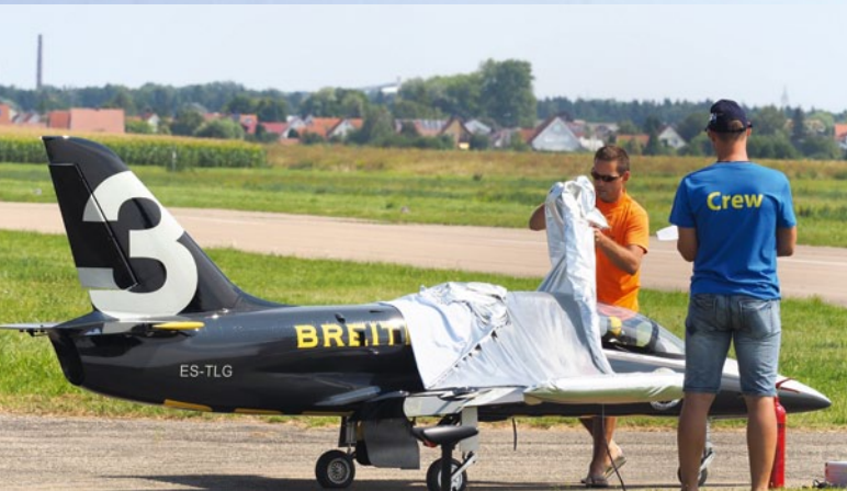
Was Christian Glaser hier auspackte, gehörte zur Spitze des Gezeigten beim Airmeet. 80 Kilogramm bringt seine L-39 auf die Waage. Das von Tomahawk Aviation vertriebene Modell ist 4.500 Millimeter lang und mit einer JetCat P550 Pro ausgestattet
