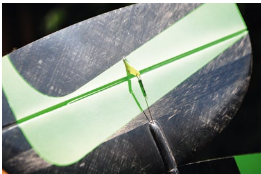
Ruderhebel und Seilbefestigung für das Seitenruder sind ab Werk bereits erledigt
