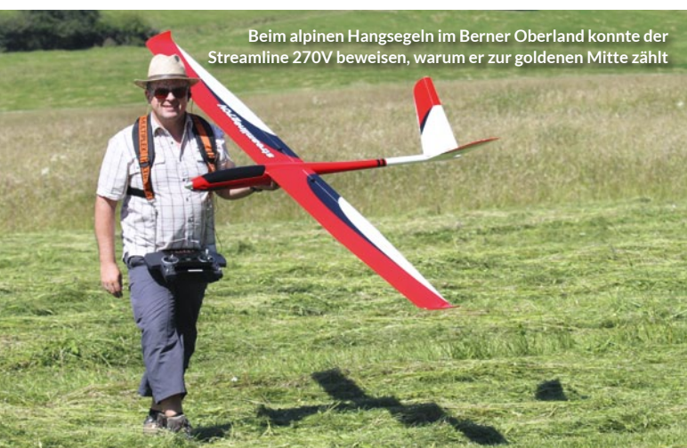
Mit einem 3s-LiPo der 3.500er-Klasse und etwa 300 Gramm Gewicht konnte der Schwerpunkt ohne Trimmblei eingestellt werden
