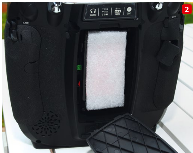
Zum Lieferumfang gehört ein HV-LiPo, was in der Sendersoftware hinterlegt werden muss (1). Eine nachträglich eingebrachte, kleine Schaumstoffeinlage fixiert den leicht klappernden Akkudeckel (2). Die beiliegende Anleitung geht auf knappen 50 Seiten nur auf einige Grundlagen ein. Detailinfos sind über die im Sender integrierte Hilfefunktion abrufbar (3)
