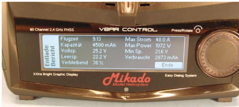
Telemetriedaten des Kolibri geben in Echtzeit und für die Nachanalyse, wie hier, Aufschluss über die Antriebsbelastung
