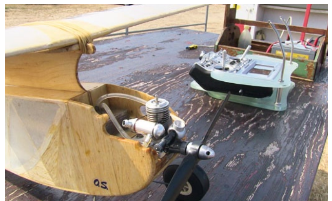
Dieser Nachbau einer US-amerikanischen Entwicklung aus dem Jahre 1942 wird von einem Glühkerzenmotor angetrieben
