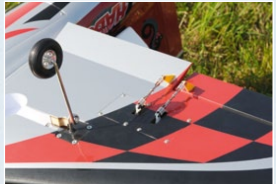
Verwindungssteife Anlenkungen aus Metall sorgen für eine sehr direkte Steuerung
