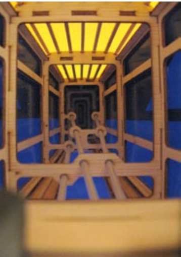
Der Rumpf ist stabil aufgebaut und alle Teile sauber verklebt
