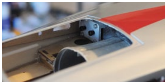
Ein Alublock mit zwei Befestigungsschrauben nimmt die Flächensteckung auf. Man sieht hier auch das Ende des Hosenrohrs, in den später der Impeller eingeschoben wird
