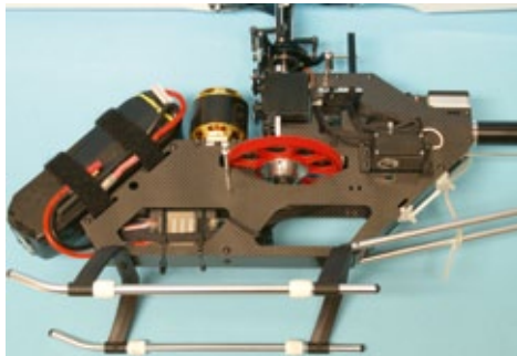
Die übersichtliche Anordnung der Elektronikkomponenten. Gut zu erkennen ist der recht knapp bemessene Platz für die Unterbringung des Antriebsakkus
