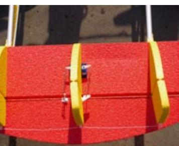
Seiten- und Höhenruderservo sind direkt im Leitwerk platziert
