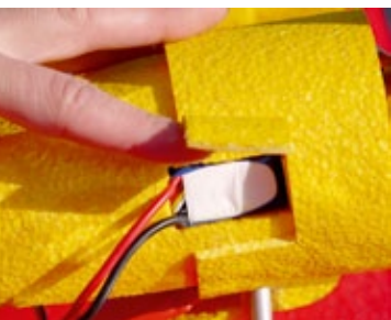
Je Antrieb steckt ein 3s-LiPo in der Gondel
