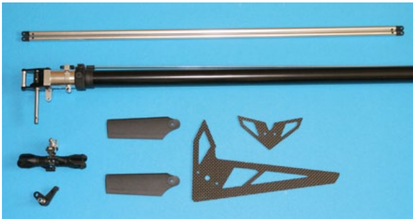
Aus dieser ebenfalls sehr übersichtlichen Anzahl von Bauteilen werden der Heckausleger und der Heckrotor zusammengeschraubt
