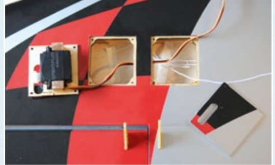
Die Servos für Querruder und Landeklappen werden auf den Servoabdeckungen über anzuklebende Holzklötzchen montiert
