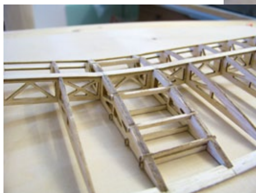
Die Flächenhälften können komplett zusammengesteckt und dann mit Sekundenkleber fixiert werden. Die Sache wird durch die guten Passungen sicher gerade
