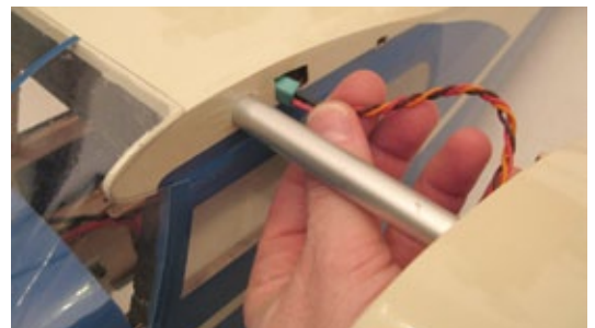
Die Flächenhälften werden seitlich gesteckt. Das Servokabel muss man durch die Flächenaufnahme fädeln
