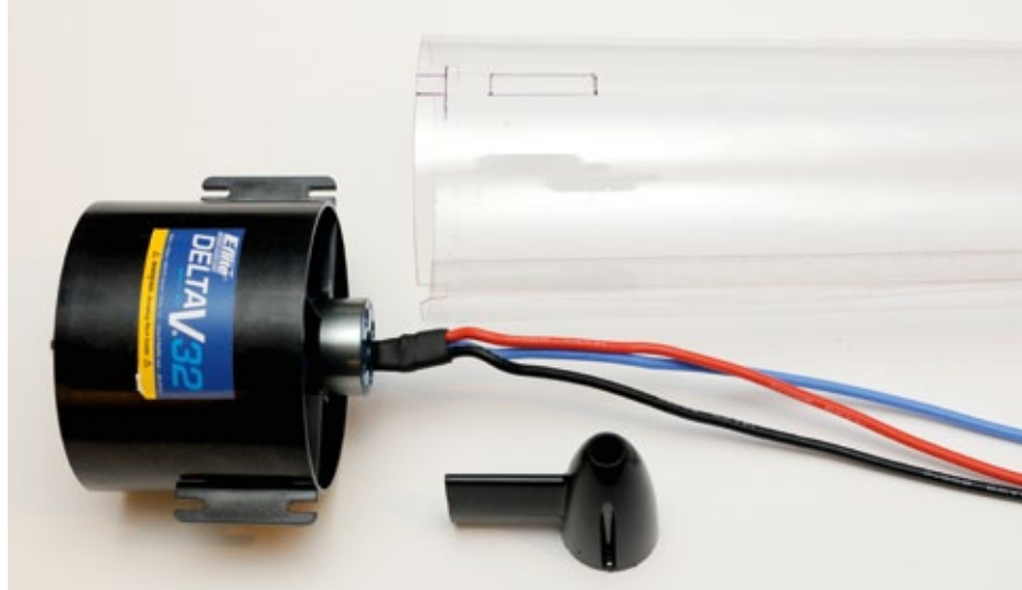
Der Antrieb wird komplettiert mit der Düse, die später auf den montierten Impeller geschoben wird. Hier ist auch schon der noch durchzuführende Ausschnitt für die Kabeldurchführung angezeichnet, die man am besten mit einer kleinen Nagelschere ausschneidet
