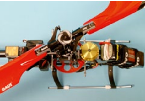
Die übersichtliche Anordnung der Elektronikkomponenten. Gut zu erkennen ist der recht knapp bemessene Platz für die Unterbringung des Antriebsakkus
