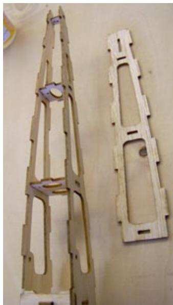
Durch die vielen Verzäpfungen muss der Rumpf gerade werden. Baufehler lassen sich hier nur mutwillig begehen
