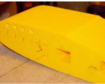
Die Fenster werden mit dem „EPP-Bohrer“ vorgebohrt und einzeln auf Form geschnitten
