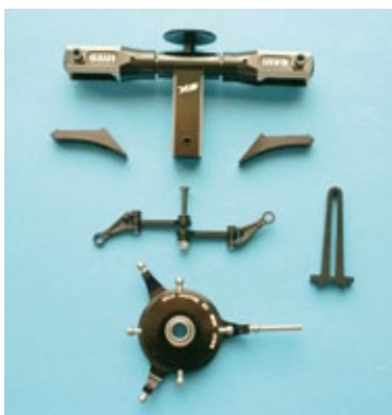
Die wenigen Baugruppen zur Endmontage des paddellosen Hauptrotorkopfs
