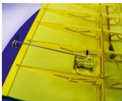
Die Anlenkung aller Ruder erfolgt über einfach gekrüpfte Drähte, die mit Schrumpfschlauch gesichert werden. Der Servohebel schaut durch einen Schlitz in der Bespannung
