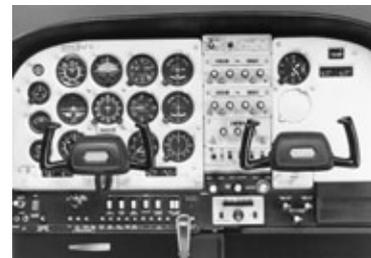
**Die Standard-Instrumentierung einer Cessna 185**
