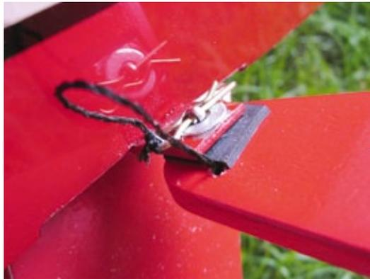
**Ein Splint sichert die Flächenstrebe – damit dieser nach dem Demontieren nicht verloren geht, ist er selbst gesichert**
