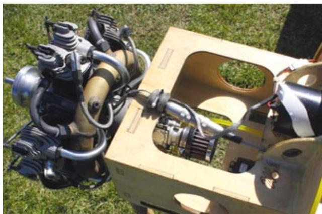
*Perfekt passen Turbulator und Luftfilter in den langen Motorträger – es fallen keine zusätzlichen Fräsarbeiten an. Auch der wirkungsvolle Moki-Ringschalldämpfer ist deutlich zu sehen*
