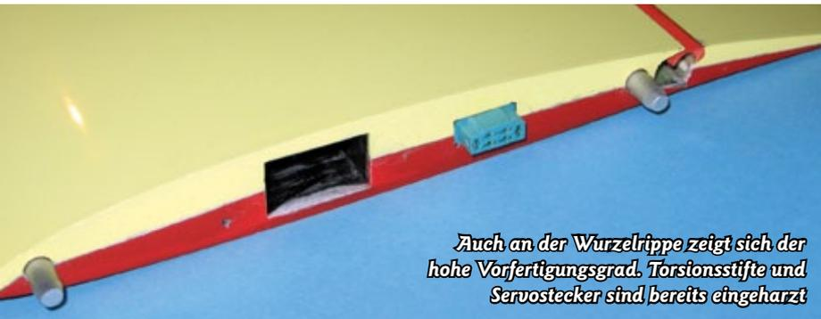
*Auch an der Wurzelrippe zeigt sich der hohe Vorfertigungsgrad. Torsionsstifte und Servostecker sind bereits eingearbeitet*
