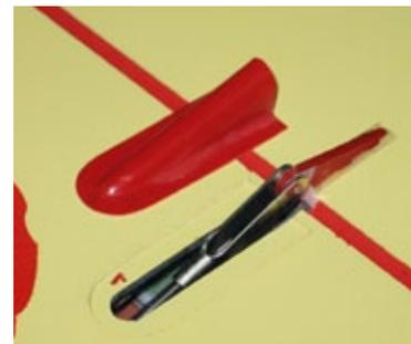
**Sorgen für eine gute Aerodynamik: Die Durchbrüche für die Flächenrunder werden mit GFK-Abdeckungen verkleidet**
