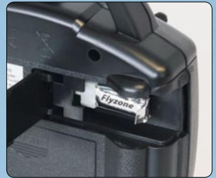
Geladen wird der 1s-LiPo über eine im Sender integrierte Buchse
