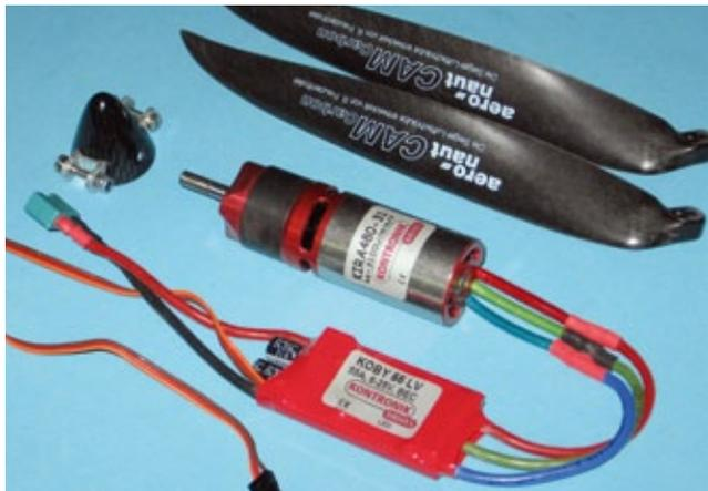
**Ein Kira 480-31-Motor mit 5,2:1-Getriebe und einem Koby 55 LV-Regler sowie einer 16 x 8-Zoll-Luftschaube von aero-naut sorgen für Vortrieb**
