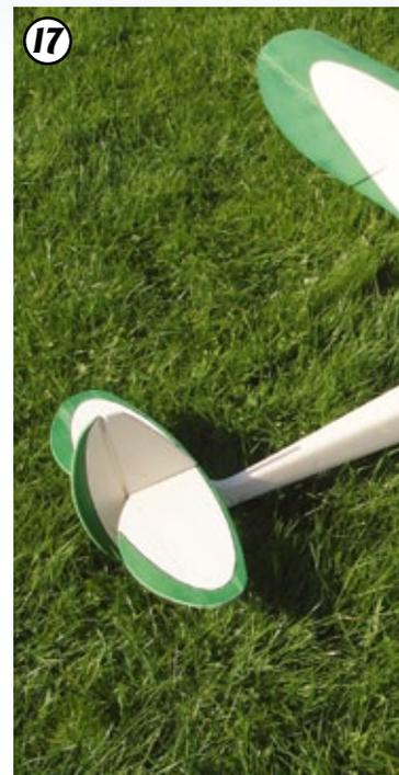
Für die schicke Lackierung im Antik-Stil hält der Bauplan die passenden Schablonen sowie alle Farbangaben bereit. Sehr schön zu verarbeiten sind Acryl-Streichfarben auf Wasserbasis aus dem Baumarkt, die sich mit einer Schaumstoffrolle oder der Lackierpistole (2- bis 3-mm-Düse) deckungsstark und gestankfrei aufbringen lassen.
