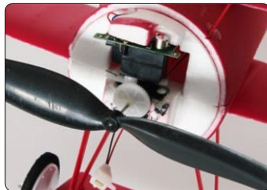
Unter der weißen Cowling und der Motorattrappe ist die Motor-Getriebeeinheit verbaut. Ebenfalls zu sehen, die Servos zur Ansteuerung von Höhen- und Seitenruder
