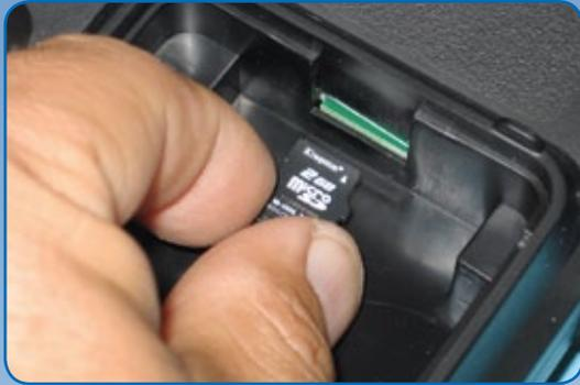
**Die von den Telemetriesensoren gesendeten Daten werden im Sender auf einer SD-Karte gespeichert**
