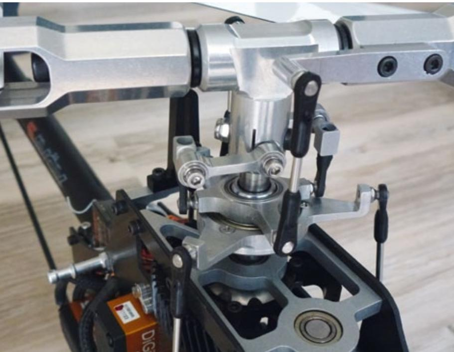
**Der Ganzmetall-Hauptrotorkopf ist konsequent als Flybarless-Version konstruiert und hält Drehzahlen bis 2.000 Umdrehungen in der Minute stand. Die kugelgelagerten Mitnehmerarme sind am Alu-Zentralstück verschraubt**
