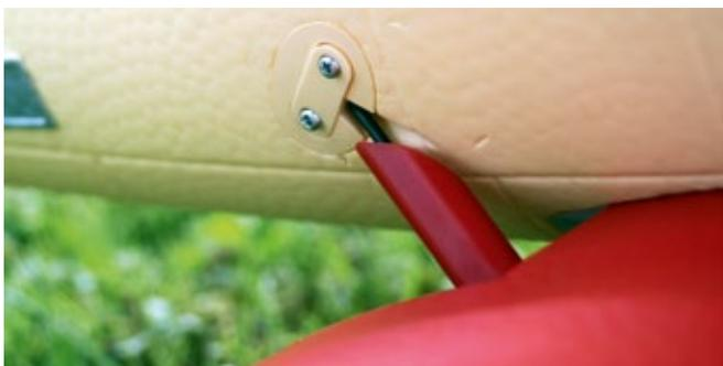
Der abgewinkelte Stahldraht des Fahrwerks greift im Rumpf in eine spezielle Halterung und wird von zwei Schrauben in seiner Position gehalten
