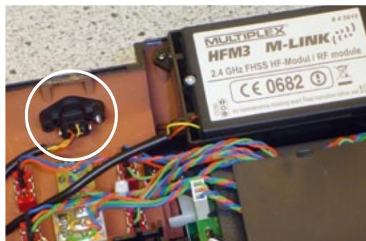
Im MC-3030-Sender wurde die PS/2-Steckverbindung vor den Schalterplätzen in der Senderfront montiert
