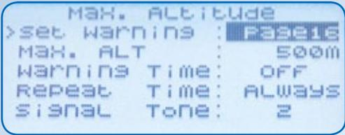
Auch die Variofunktionen lassen sich bequem per Sender konfigurieren, hier wird gerade der Höhenalarm beim Erreichen von einer Flughöhe von 500 Meter aktiviert
