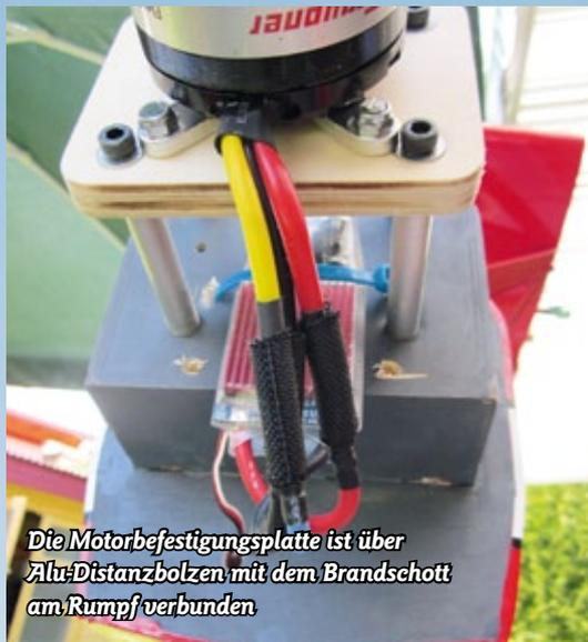
*Die Motorbefestigungsplatte ist über Alu-Distanzbolzen mit dem Brandschott am Rumpf verbunden*
