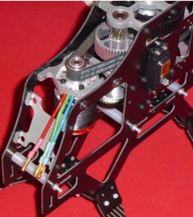
**Die Zahnriemenräder der ersten Getriebestufe bestehen aus Aluminium. Der Alu-Motorträger besitzt serienmäßig die korrekten Befestigungsbohrungen für alle gängigen Antriebsmotoren**
