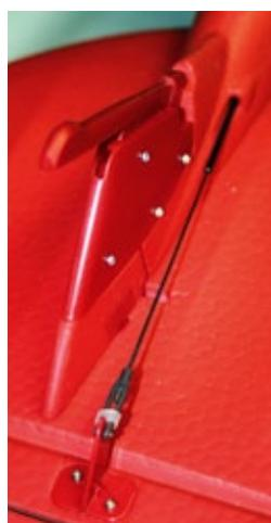
**Statt eines lenkbaren Heckrads kann der Scale-Charakter durch den Schleifsporn unterstrichen werden**
