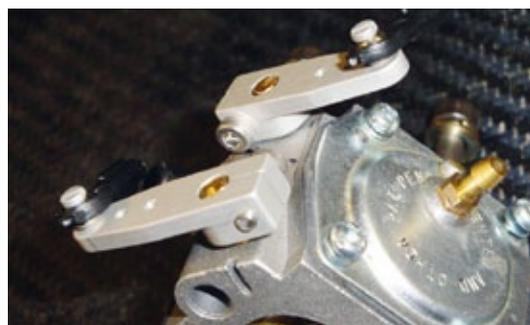
**CNC-gefräste Alu-Anlenkhebel für Vergaser und Choke hat der Hersteller des Turbulators ebenfalls im Programm – dadurch wird die Servoanlenkung zum Kinderspiel**
