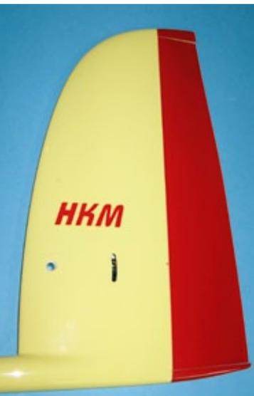
Höhenruder selbstverständlich ebenso. Beim zweiteiligen Höhenleitwerk sind die Lager- und Anlenkröhrchen bereits fertig eingebracht. Mit 63 g bei 728 mm Spannweite ist es relativ leicht.
