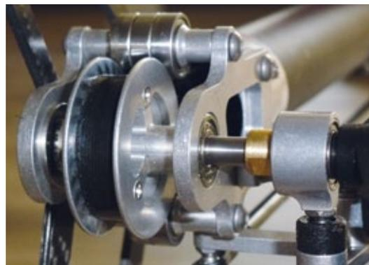
Markant am Ganzmetall-Heckrotor ist das große Riemenrad, das in Verbindung mit der zusätzlichen Andruckrolle, bestehend aus drei Kugellagern, stets für perfekten Grip des Zahnriemens sorgt
