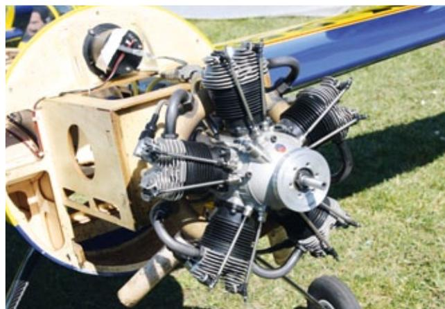
*Der Moki Fünfzylinder-Sternmotor passt mit seinen 250 Kubikzentimeter Hubraum samt Ringschalldämpfer spielend auf den Motorspant und unter die runde Cowling. Dahinter ist die Zündanlage auf die Firewall geschraubt*
