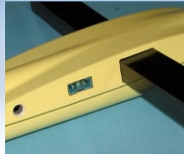
***Die Übergangstecker für die Flächenservos wurden bereits eingeklebt, die Durchbrüche für die Torsionsstifte und den Vierkantsteckverbinder sind fertig erstellt***
