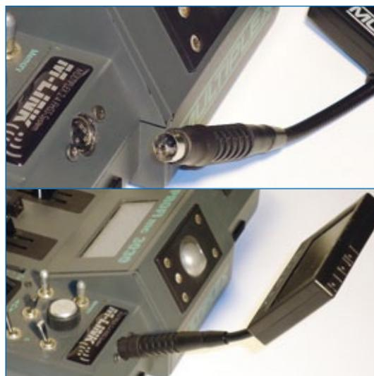
Das Telemetry-Display lässt sich einfach aufstecken und wieder demontieren
