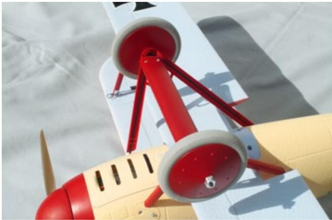
Das Hauptfahrwerk ist montiert, die Stahldrähte sind durch die Kunststoffverkleidung gut verdeckt und fast unsichtbar
