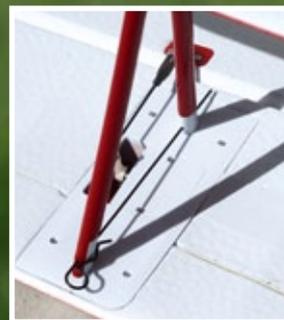
*Ein langer Stahldraht sichert die Flächenstiele am Flügel – eine sichere und unkomplizierte Lösung*
