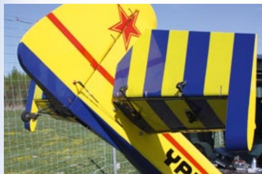
**An jedem Höhenruderblatt werkeln zwei Spektrum-Servos S6030, fürs Seitenruder sind drei weitere Rudermaschinen desselben Typs im Rumpf parallel gekoppelt. Die Anlenkung des Spornrads erfolgt über zwei Federn**
