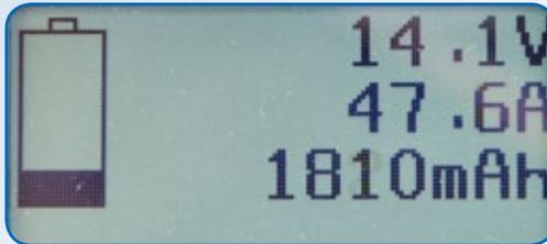
Ein Blick aufs Display während des Steigflugs, die Spannung des Antriebsakkus beträgt 14,1 Volt, der Strom 47,6 Ampere und es wurden bereits 1.810 Milliampere aus dem Akku entnommen
