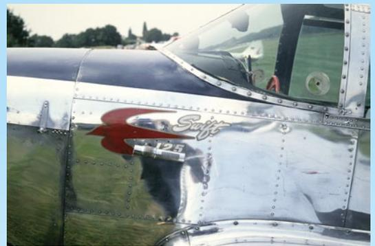
**Das Swift-Firmenlogo, davor ein Venturi-Rohr zur Unterdruck-Erzeugung für ein Fluginstrument**
