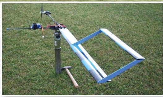
*Vielleicht das verrückteste Objekt: Die „Charybdis“ von Stephan Brehm. Ein einblättriger Helikopter, an dem alle Teile in Rotation sind. Kann zurzeit nur über Drehzahl gesteuert werden, aber Stephan arbeitet an einer Steuerung über alle drei Achsen*
