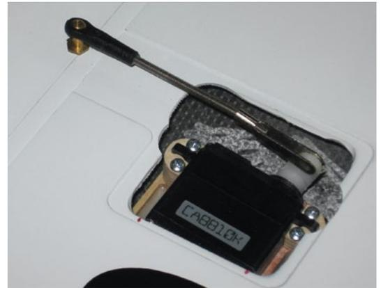
**Die Querruderanlenkung erfolgt nach bekanntem Standard mittels Kugelkopf**
