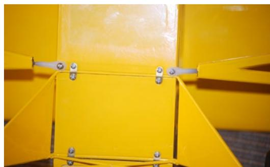
**Mittels kleiner Messingschellen ist das Fahrwerk an der Rumpfunterseite festgeschraubt**
