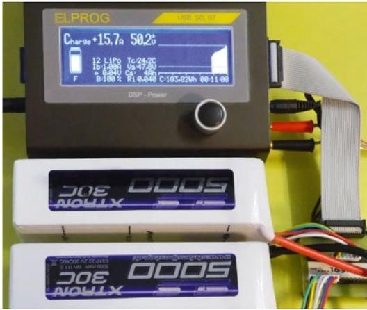
**Demonstration eines Ladevorgangs an 2 x 6s-LiPos mit 5.000 mAh und 4C Laderate (20 Ampere). Die Fast-Ladung war nach gut 13 Minuten beendet und der LiPo vollgeladen**
