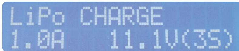
Im Untermenü erfolgt die Auswahl des Ladeprogrammes über die DEC/INC-Taste und seine Bestätigung über die START-Taste. Dann kann über die DEC/INC-Taste der Ladestrom eingestellt und wiederum über die Taste START bestätigt werden. Auf dieselbe Weise stellt man die Zellenzahl ein
