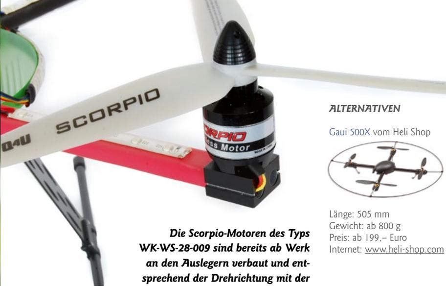
**Die Scorpio-Motoren des Typs WK-WS-28-009 sind bereits ab Werk an den Auslegern verbaut und entsprechend der Drehrichtung mit der Controller-Platine verbunden**
