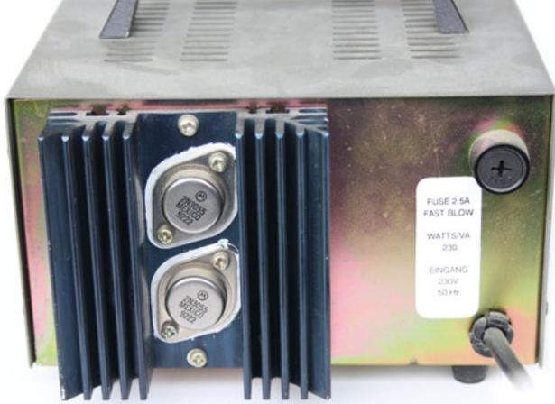
**Meist verrät der große Kühlkörper auf der Geräterückseite, dass es sich um ein analoges Netzteil handelt. Diese Geräte sind nicht empfehlenswert, denn sie haben wenige Leistung, einen miserablen Wirkungsgrad, entwickeln viel Wärme und sind schwer wie Blei**
