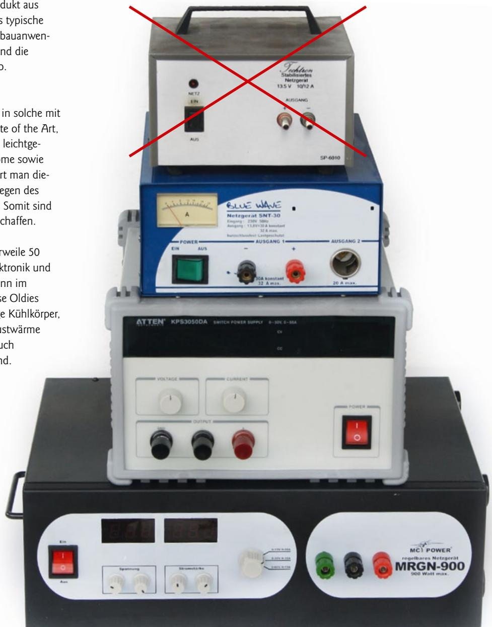
**Von oben nach unten: Fechtron Analognetzteil mit Linearregler (120 Watt), Blue Wave Festspannungs-Schaltnetzteil (400 Watt), regelbares Schaltnetzteil KPS3050 (1500 Watt) und regelbares Schaltnetzteil MRGN-900 (900 Watt) mit drei Spannungsbereichen. Achtung: Finger weg von analogen Netzgeräten mit Linearregler aus der Dinozeit der Elektronik**
