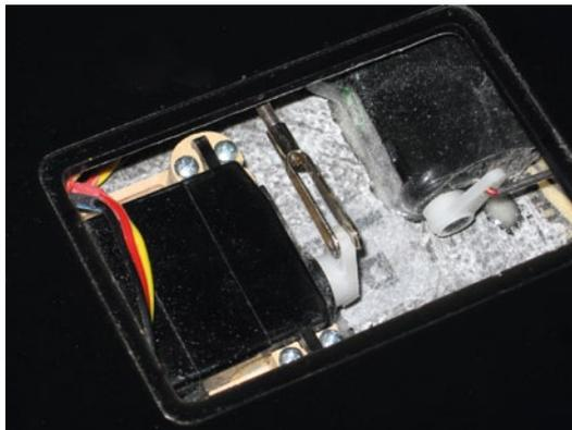
**Das Störklappenservo wird aus Platzgründen mit Schrumpfschlauch eingehüllt und mit der Flügelshale verklebt.**
