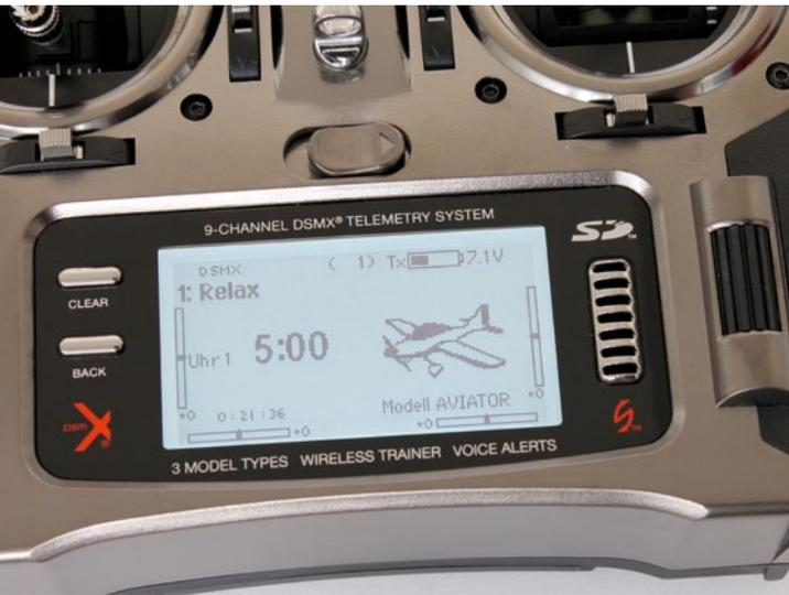
**Zwei Taster und ein Rolldrucktaster (rechts) dienen zum Navigieren durchs Menü**
