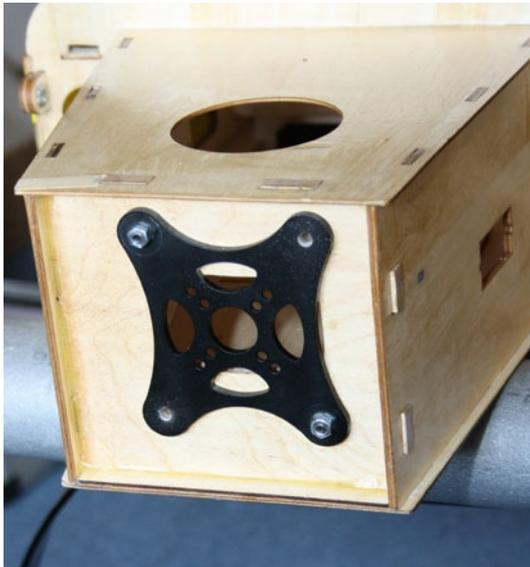
**Elektroantrieb: Damit die Abstandsbolzen exakt fluchten, empfiehlt sich der mitgelieferte Motorträger AXI-5345 als Bohrschablone**
