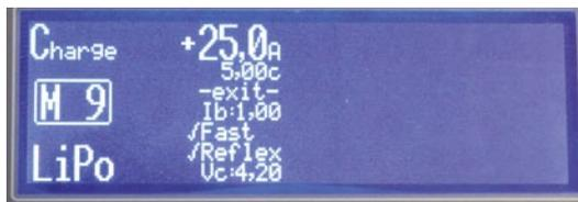
**Mode & Akku: Der Akkutyp, der Prozess, die maximale Höhe der Balancerströme, Fast, Reflex und die maximale Zellenspannung lassen sich konfigurieren**
