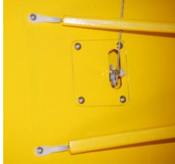
Die Tragflächenstreben lassen sich mit Augenschrauben aus Kunststoff und kleinen Holzschrauben befestigen
