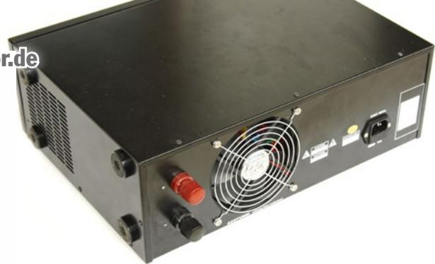
**Auch das MRGN-900 von Hepf ist ein professionelles Schaltnetzteil mit einem riesigen Spannungsbereich bis zu 60 Volt – es ist für 19-Zoll-Racks ausgelegt. Wir haben die seitlichen Befestigungsbleche abmontiert und stattdessen Füße auf einer Seite angebracht. So kann das Gerät platzsparend auch hochkant aufgestellt werden**
