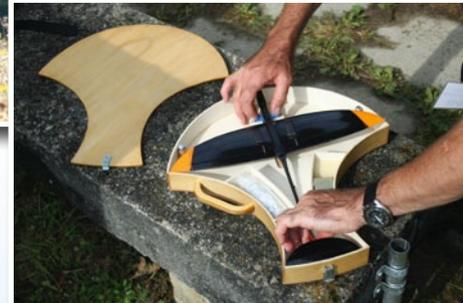
*Klein und edel: Die „Mea Culpa“ des Schweizers Andreas Locher. Ein Micro-Pylonracer mit knapp 50 Gramm Gewicht. Aus Holz und Kohlefaser gebaut, von einem Innenläufer angetrieben und irrwitzig schnell unterwegs. Der Anfang einer neuen Pylon- Klasse?*
