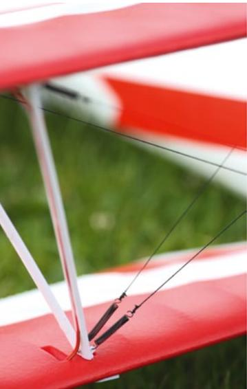
des Leitwerks durch Drahtseile. Dieses Feature lässt Hersteller Staufenbiel seinem Modell auch angedeihen. Das Strippenziehen gerät dabei zur abendfüllenden Aufgabe mit leicht meditativem Touch.
