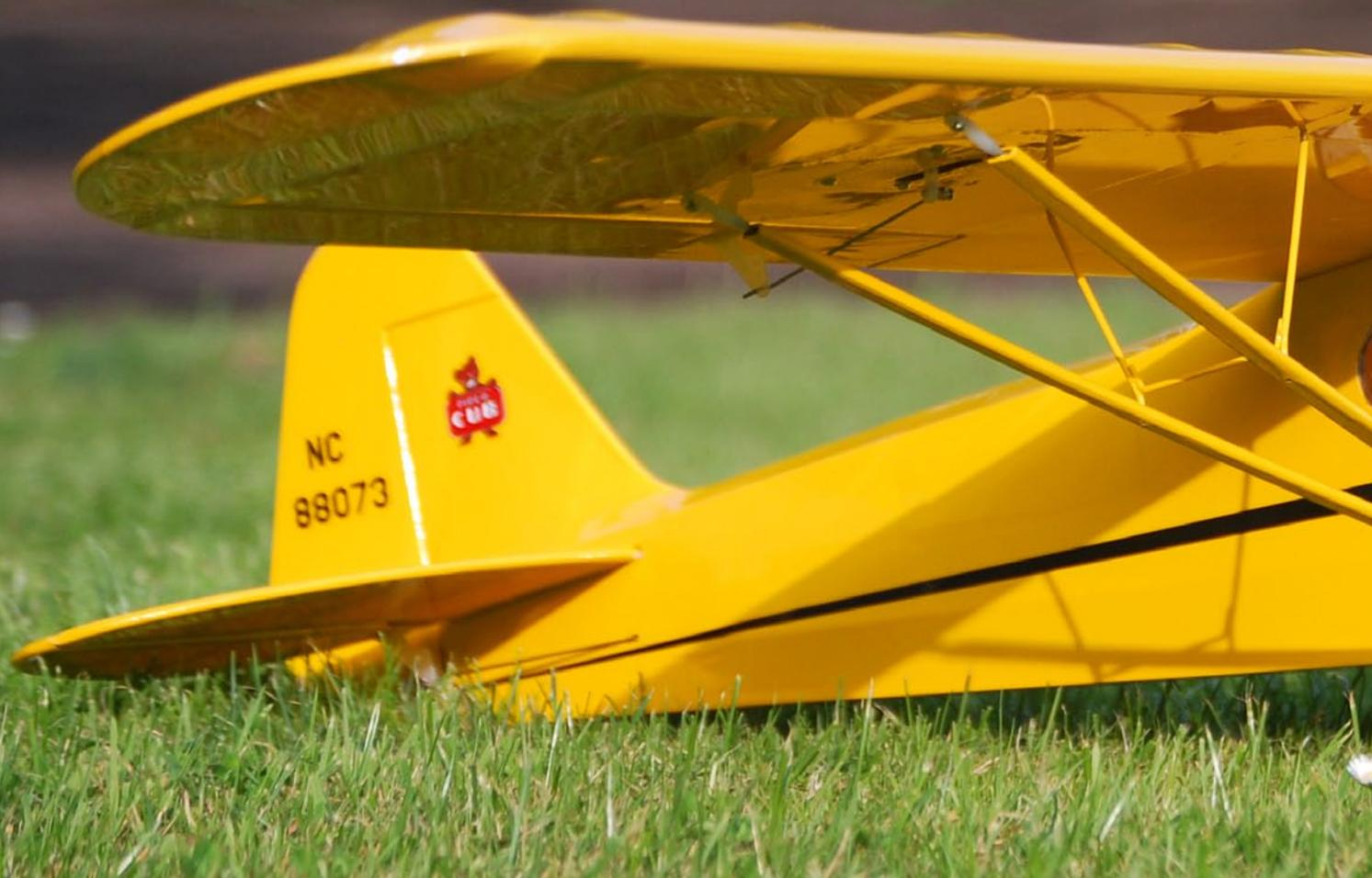
und Seitenruder. Beide passen saugend in die Ausschnitte, Bohrungen für die Schrauben sind bereits vorhanden.
