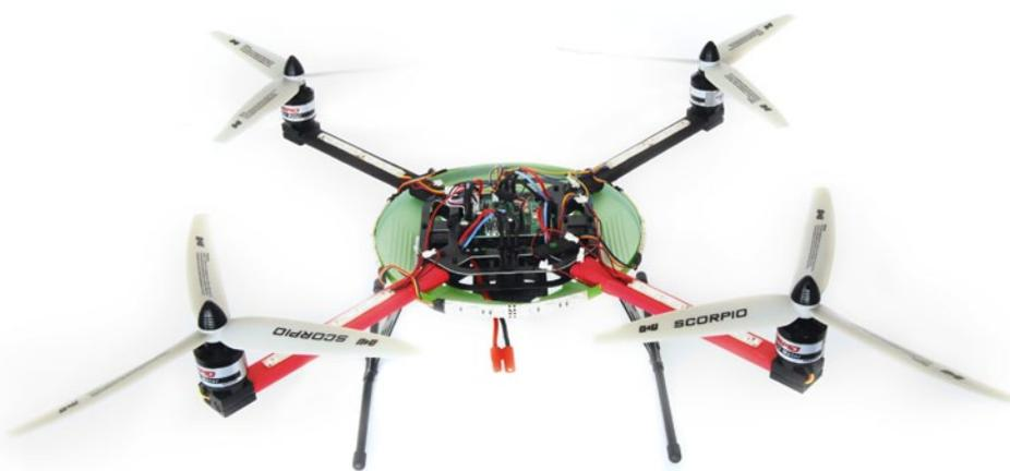
**Der Aufbau des Scorpio Q4U beschränkt sich auf die Montage des Landgestells und die Platzierung der Luftschrauben. Zur besseren Lage-Erkennung sind die vorderen Ausleger in Rot gehalten**
