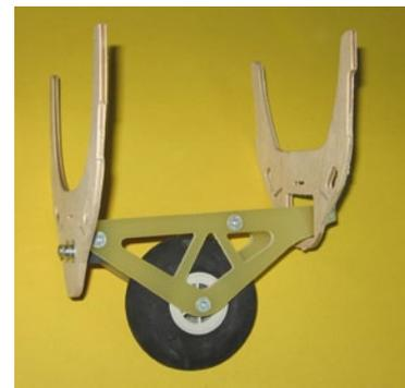
**Das Fahrwerk wird aus mehreren Einzelteilen zusammengesetzt und dann durch die beiden Sperrholzspanten im Rumpf befestigt**
