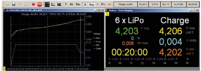
**Die Software ist auch ein Analyse-Tool. Hier am Beispiel einer 6s-20-A-Fast-Reflex-Ladung (4C). Links das Ladediagramm mit Anzeige der Einzelspannungen und (unten) den Ladestrom, rechts das Info-Display (umschaltbar) mit der Einstellung zur Einzelspannungsanzeige in Volt, Ah und Ri. Die Ladung war nach 20 Minuten beendet und eingeladen**
