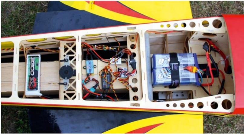
Auf dem Resotunnel sind 12s-Antriebsakku, Fernsteuerkomponenten und LiPo-Empfängerstromversorgung befestigt
