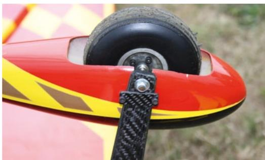
**Um keine Löcher in den CFK-Bügel bohren zu müssen, haben wir die Fahrwerkschuhe mit einer kleinen CFK-Platte befestigt**
