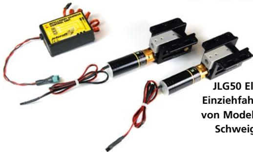
**JLG50 Elektro-Einziehfahrwerk von Modellsport Schweighofer**
