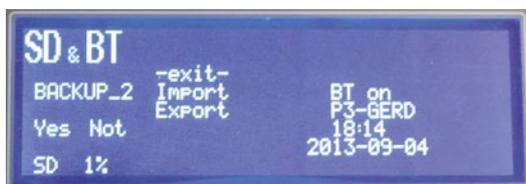
**SD-BT-RTC: Sicherungen erstellen oder Wiederherstellungen, sowie Bluetooth, persönlicher Name, Uhrzeit und Datum sind konfigurierbar**
