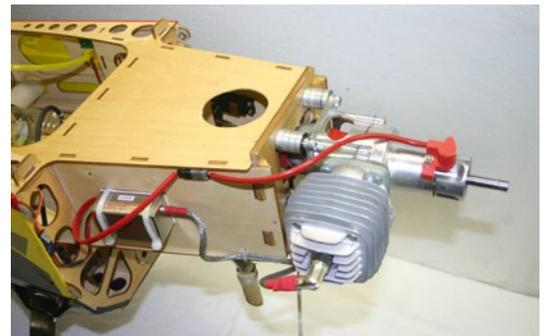
Mit den im Bausatz enthaltenen Alu-Distanzscheiben ist der DA-60-Verbrennermotor schnell auf die Firewall geschraubt
