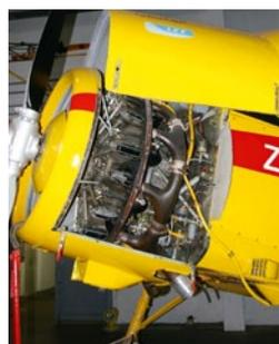
**Geöffnete Cowling eines Agrarflugzeugs vom Typ Zlin Z-37**
