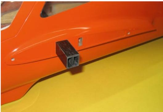
**Die großzügig dimensionierte CFK-Flächensteckung ist stabil ausgeführt, gleich dahinter befindet sich die Aussparung für den Servostecker zur Tragfläche**
