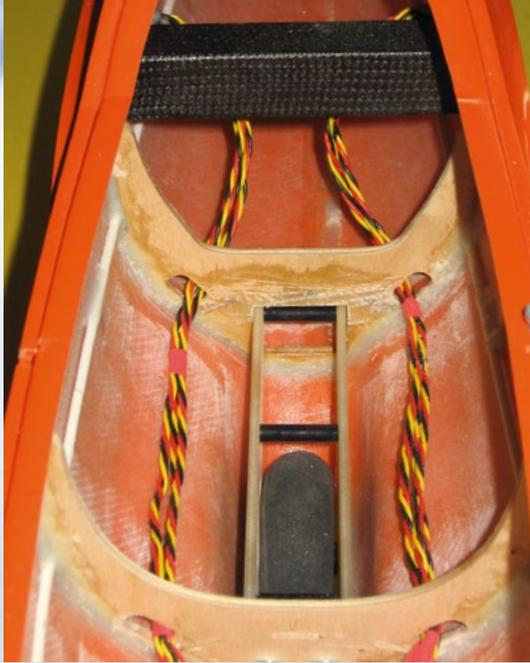
**Und so sieht der Rumpf im fertig ausgebauten Zustand aus**
