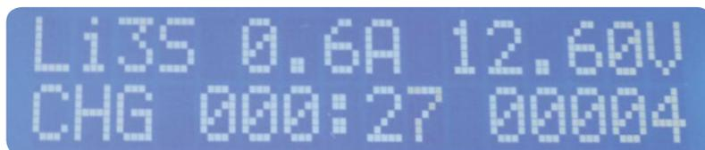
Während des Ladens werden Akkutyp und Zellenzahl, Ladestrom, Akkuspannung, Ladeprogramm, bisher verstrichene Ladezeit und Lademenge angezeigt. Wird der Balancer-Anschluss verwendet, lassen sich über die INC-Taste die einzelnen Zellenspannungen anzeigen
