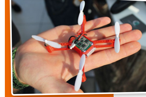
Auch das geht schon: ein Multikopter aus dem 3D-Drucker. Motoren und Elektronik sind jedoch noch herkömmliche Komponenten
