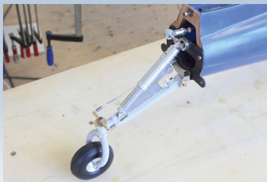
Ein delikates Stück Technik: Das Spornrad ist gefedert und seilgeführt über eine Umlenkrolle angelenkt
