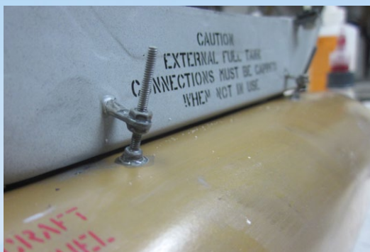
Für die Zusatztanks unter den Flächen wurden zur Fixierung Scale-Halterungen angebracht
