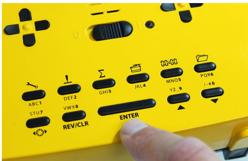
Die obere Taster-Reihe führt direkt in das jeweilige Hauptmenü. Unten links ist die Übernahme-Taste für den 3D-Digi-Einsteller platziert
