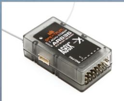
Spektrum AR636 6-Kanal Empfänger mit AS3X-System.
