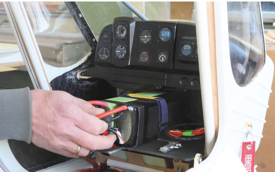
Ganz vorne im Cockpit sind die Flugakkus platziert und damit optimal im Schwerpunkt
