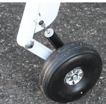
Typisch für die Wilga ist das stabile, vollgedederte und nach hinten abgewinkelte Fahrwerk
