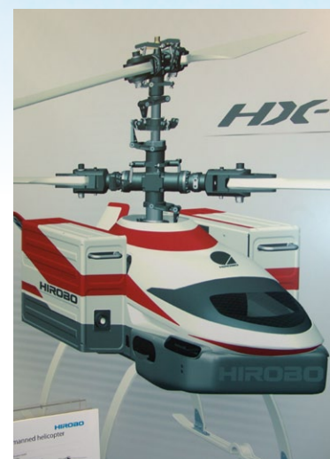
GPS-gesteuerter und elektrisch angetriebener Großhubschrauber HX-1 mit Koaxial-Hauptrotorsystem (siehe Text)
