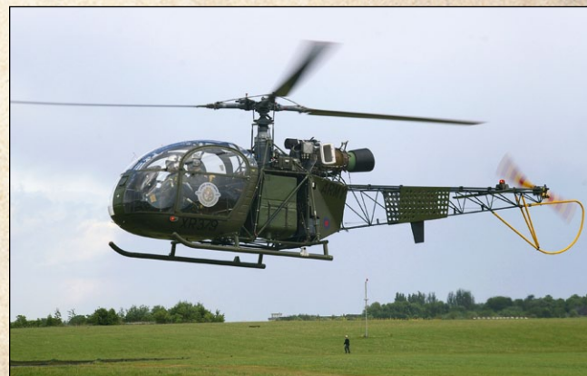
Die französische Alouette II war ab 1955 der erste in Serie gebaute Turbinenhubschrauber und entstand mit Unterstützung des deutschen Hubschrauberpioniers Heinrich Focke
