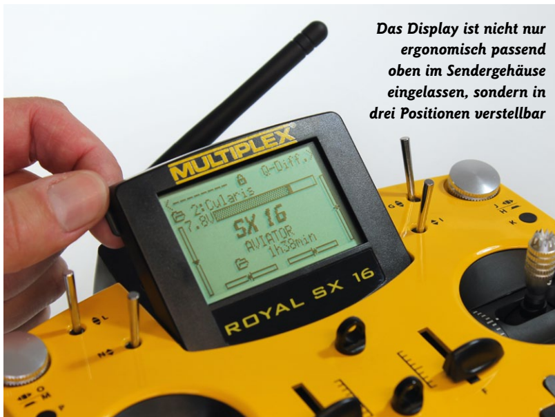
Im Betrieb kann man sich mit dem 3D-Digi-Einsteller an den gewünschten Einstellwert herantasten, was heftige Ruderreaktionen zu vermeiden hilft
