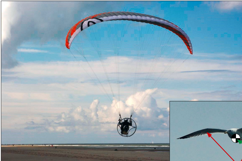
Abbildung 9: Ein Gleitschirm hat heruntergezogene Flächenenden
