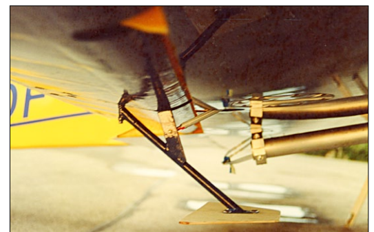
Die sogenannten Spades an der Querruderunterseite verringern die Querruderkräfte
