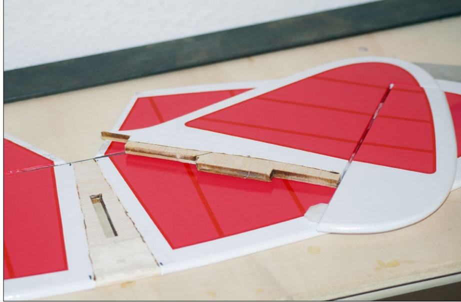
Die Leitwerke kommen fertig bespannt aus dem Bausatz. An den Klebeflächen zum Rumpf ist die Folie zu entfernen
