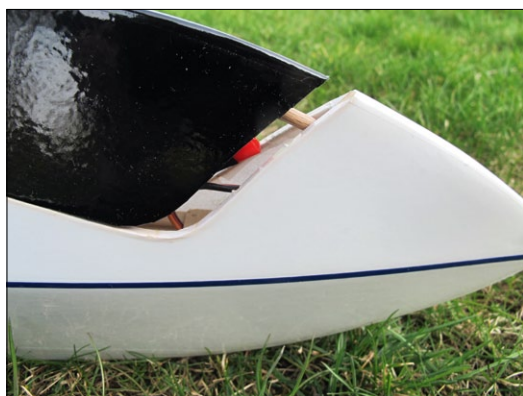
Haubenverriegelung mit Federstahldraht und Kieferndübel
