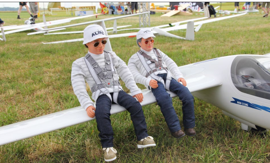
Hier sitzen gerade zwei Piloten in unterschiedlichen Maßstäben auf der Tragfläche einer ASH-31 Probe. Durch das Drahtgestell lassen sich die Piloten in unterschiedliche Positionen bringen und so dem Cockpit anpassen
