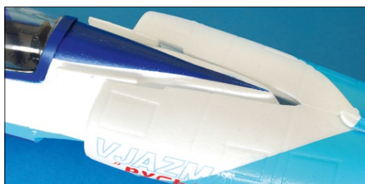
Der Rumpf des Modells ist zweiteilig ausgeführt und muss noch zusammengesetzt werden
