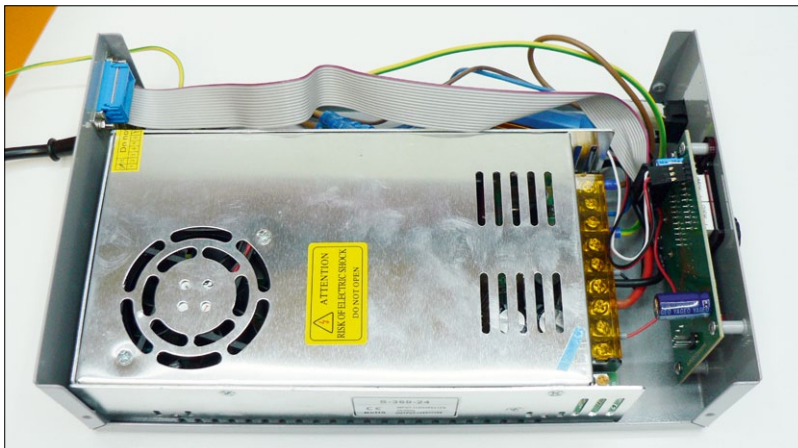
Ein Blick in die Steuerbox lässt eine solide Fertigung erahnen, denn der silbrige Kasten ist ein getaktetes 24-Volt-DC-Netzteil, unterhalb des grauen Flachbandkabels findet sich die leistungsstarke Motorsteuerung für die Spindel
