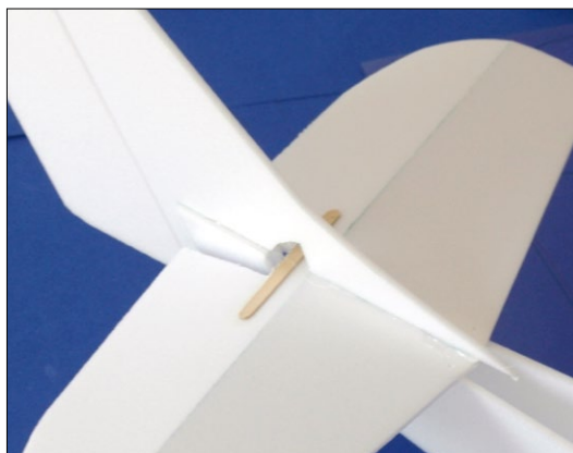
Kaffeeührstäbchen stabilisieren den Höhenrudersteg
