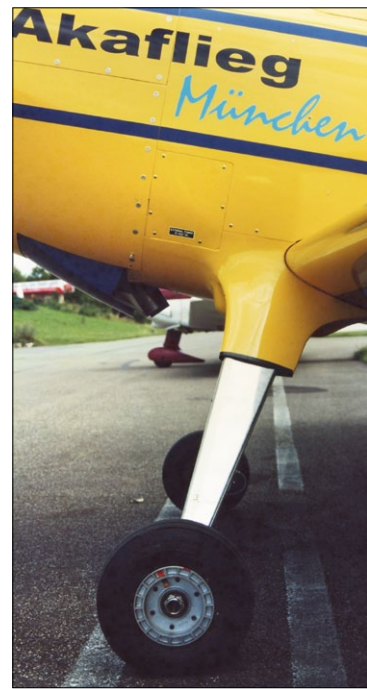
Beim Erstflug waren die Räder noch unverkleidet und der Fahrwerksbügel noch Aluminium natur
