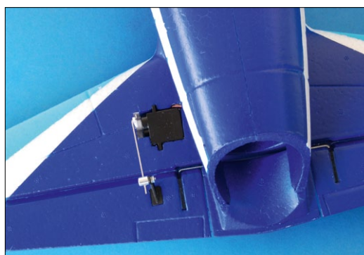
Für die Anlenkung des Höhenruders der Albatros reicht ein Servo aus. Die Ruderrhälften sind über einen Draht verbunden
