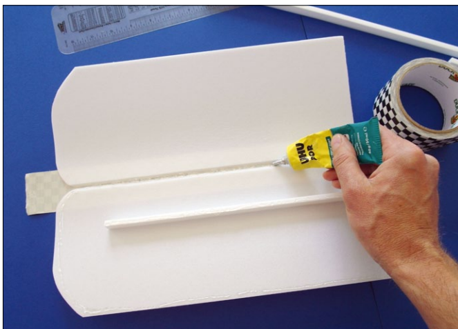
Drucktape verbindet die Halbschalen an der Nasenleiste. Mit Uhu Por entsteht ein leichter und stabiler Flügel
