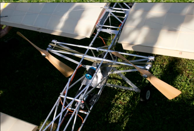
Ein Leckerbissen für Mechanik-Freunde: Die beiden Luftschrauben des Langley-Nachbaus werden über Zahnriemen in Schwung gebracht
