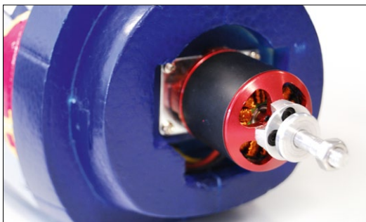
Ein Blick unter die Motorhaube offenbart den Brushless-Motor, der den 12 x 6-Zoll-Scale-Propeller mit gemessenen 480 Watt Eingangsleistung antreibt
