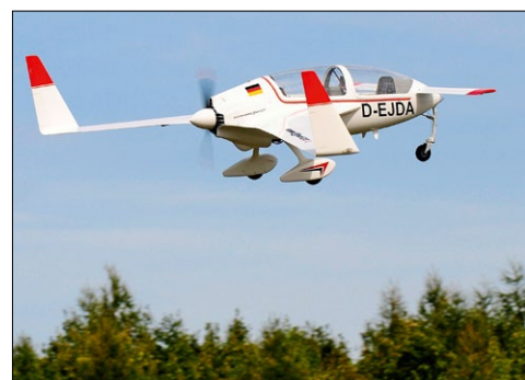
Pusher-getriebene Speed Canard in Nennslingen
