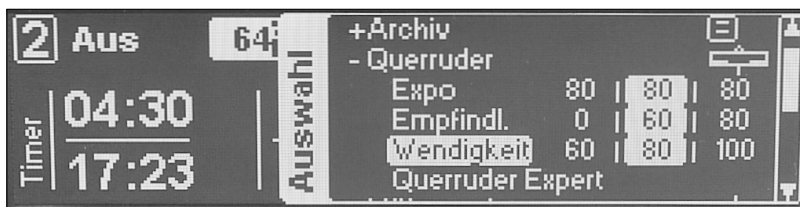
Die Flugeigenschaften der Stabilisierungselektronik bzw. des Modells können pro Bank (Flugphase) bequem per Drehknopf verändert werden
