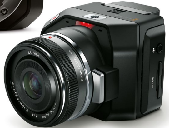
Mit der Blackmagic lassen sich beliebige MFT-Objektive nutzen und per RC-Sender steuern
