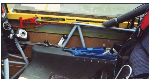
Das Cockpit ist innen unverkleidet, rechts der Betätigungshebel für die Schleppkupplung
