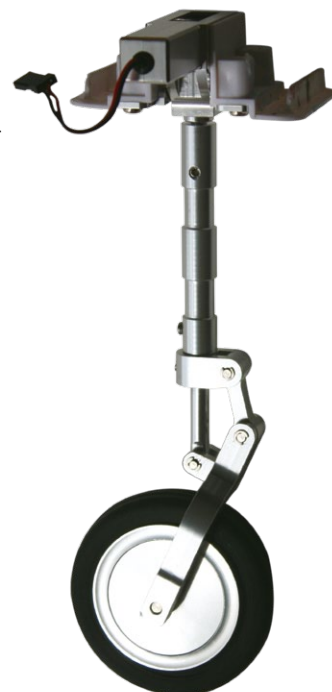
Die schleppend gefederten Fahrwerksbeine werden ihrer Aufgabe gerecht. Nur ihre Befestigung im Schaumstoff ist absolut unzureichend
