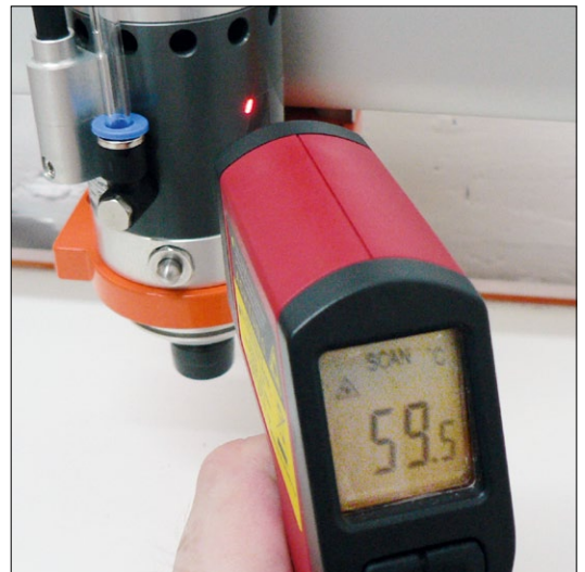
Selbst nach mehrstündigem Fräsen erwärmt sich die HF Spindel nicht über 60 Grad, was dem hohen Wirkungsgrad der bürstenlosen Ansteuerung geschuldet ist. Gut kann man hier auch den durchsichtigen Druckluftschlauch zum Schutz des unteren Lagers vor Schmutz erkennen
