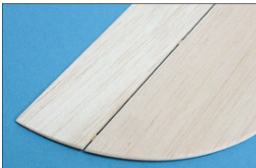
Die Ruder am V-Leitwerk hat der Hersteller mit kleinen Vliesscharnieren bereits angeschlagen
