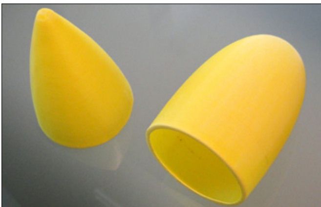
Die Urform des Tanks entstand mit Hilfe eines 3D-Druckers
