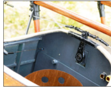
Erst auf dem zweiten Blick ist der geschickt integrierte Querruder-Servohebel erkennbar
