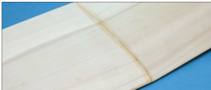
Die Tragflächen werden zunächst stumpf zusammengeklebt, sodass nach dem Trocknen nur eine schmale Klebnaht bleibt, die noch verschliffen wird, bevor das Gewebe aufgelegt wird
