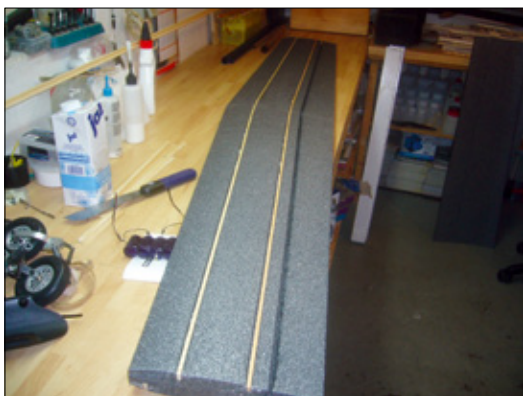
In den Styro-Kern einzuleimende Verstärkungen und die abschließende Bepunktung bewirken eine steife, einteilige Fläche
