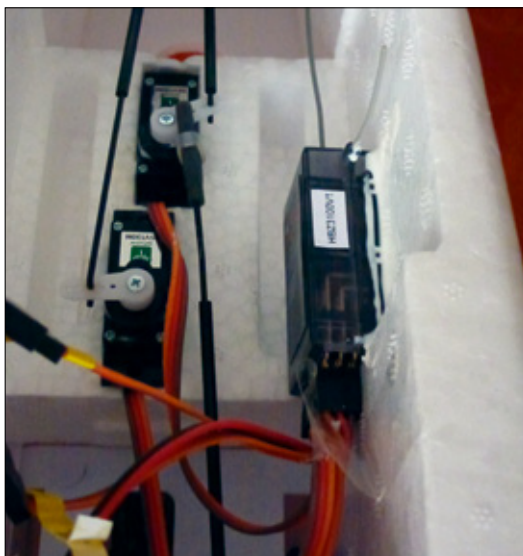
Der Empfänger mit AS3X und SAFE-System ist seitlich an der Rumpfwand befestigt
