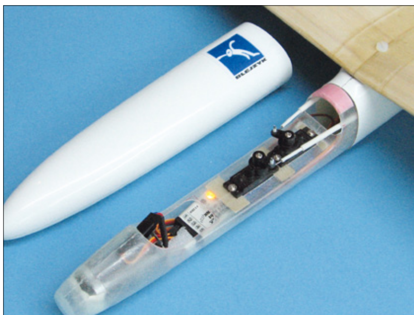
Ganz vorne sitzt der NiMH-Akku mit 900 Milliamperestunden Kapazität, dahinter der Empfänger und dann folgen die beiden Rumpfservos
