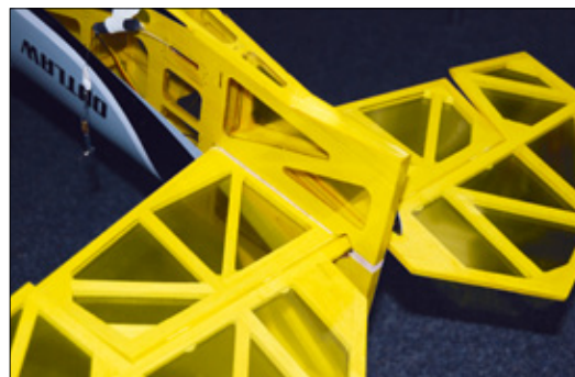
Das Höhenleitwerk ist als einer der wenigen Bauschritte auszurichten und mit dem Rumpf zu verbinden
