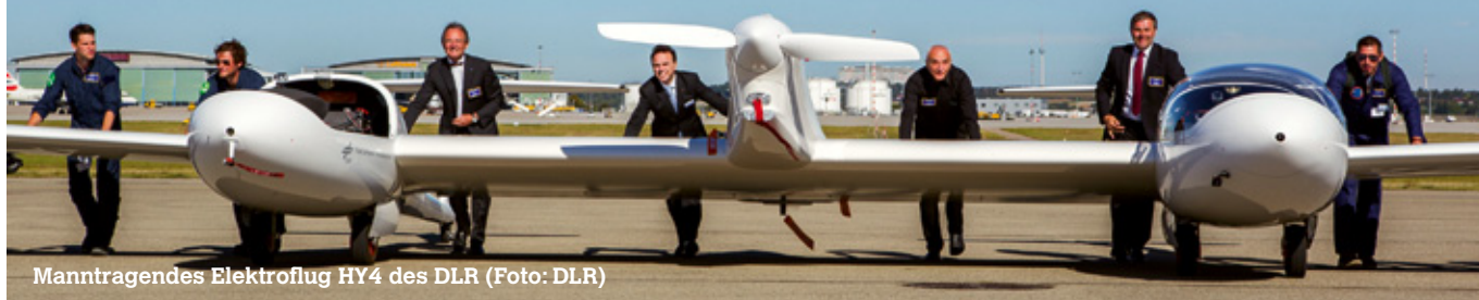
Ein Wasserstoffbrennstoffzellen-Batterie-System ist im HY4 umgesetzt (Foto: DLR)
