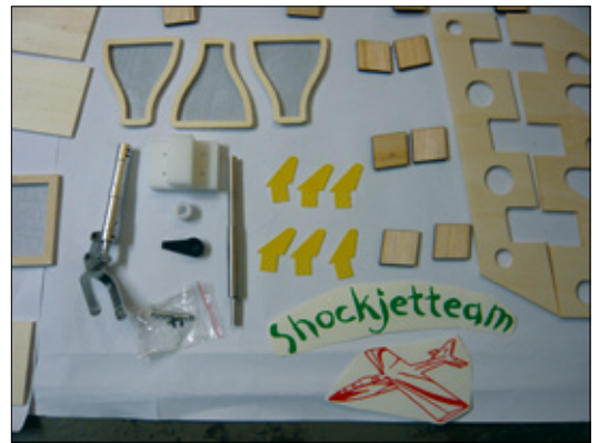
Einige Bausatzteile sind bereits ab Werk vorgearbeitet, wie Fahrwerk und Lüftungsbleche
