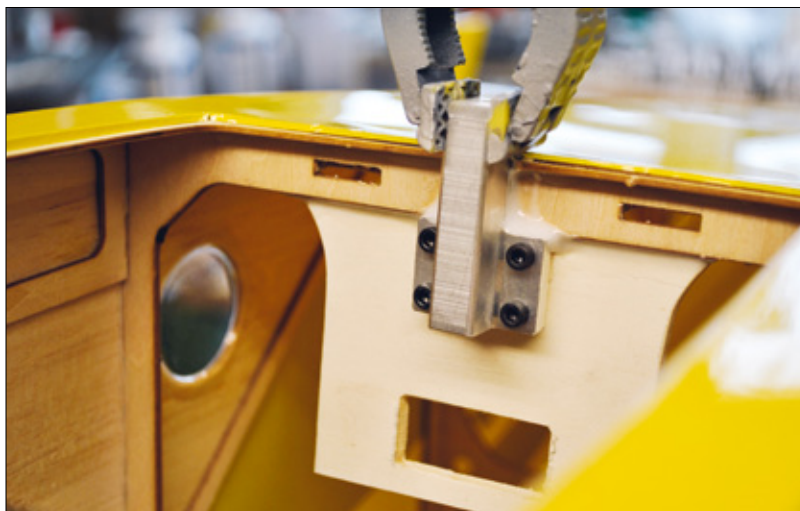
So wird die Schleppkupplung auf dem eingesetzten Spant verklebt, der auch das Servo aufnimmt
