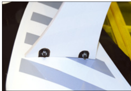
Baldachin und Streben werden mit Schrauben und Stopmmuttern sicher montiert. Das passt hervorragend und hält alle Belastungen aus
