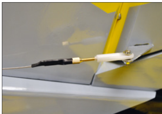
Bei der Seitenrudderanlenkung wird wieder konventionelle Litze verwendet
