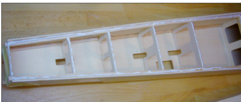
Die Kastenbauweise sorgt für eine solide und den Anforderungen gerechte Konstruktion
