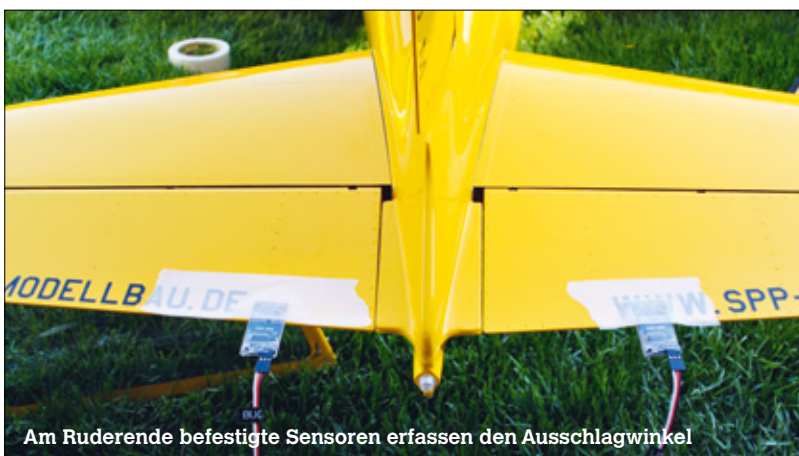
Die Winkelsensoren helfen beim exakten Einstellen der Ruderausschläge
