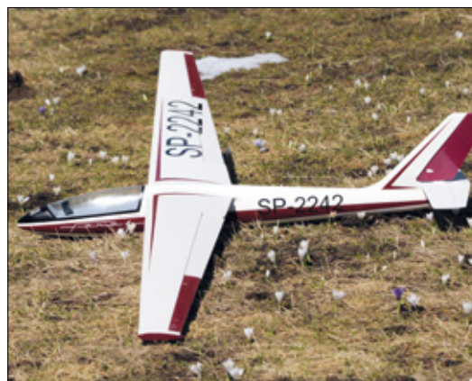
Diese Graupner-Modell hat eine Spannweite von 2.200 Millimeter (Foto: Bertram Radelow)
