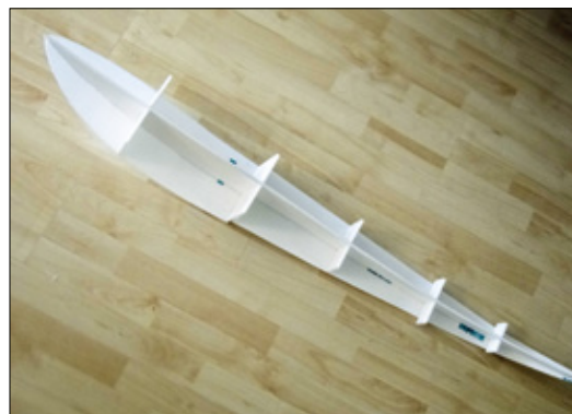
Der Rumpf besteht aus 3-Millimeter-Depron in konventioneller Spantbauweise
