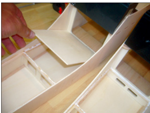
Innere Verkastungen liefern das Gerüst für ein besonders stabiles Modell
