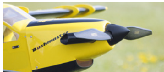
Fertig für den ersten Start: Der Spalt zwischen Spinner und Cowling lässt noch ein wenig Kühlluft zum Motor gelangen
