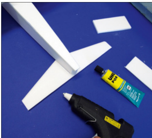
Niedrigtemperatur-Klebepistole und Uhu Por sind ideal für den Bau von Depron-Modellen
