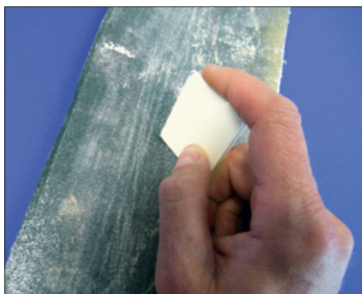
Ecken und Vorderkanten des Holz-Motorspant werden abgerundet
