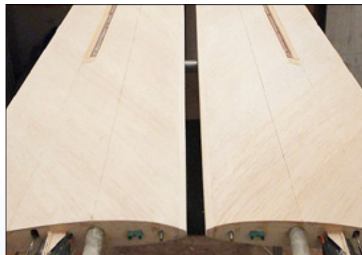
Die Tragfläche in vollbeplankter Holm-Rippenbauweise – die diagonal laufende Beplankung ist noch zu erkennen (Foto: Michael Hantke)
