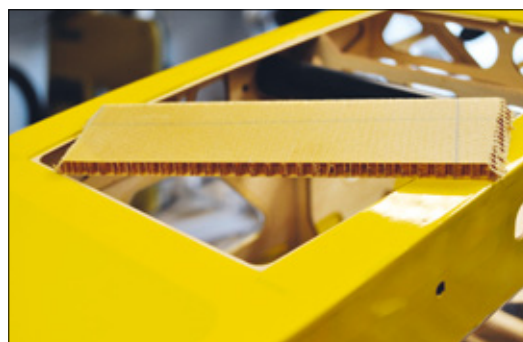
Das Honeycomb-Brett dient als Verstärkung im Bereich der Schleppkupplung
