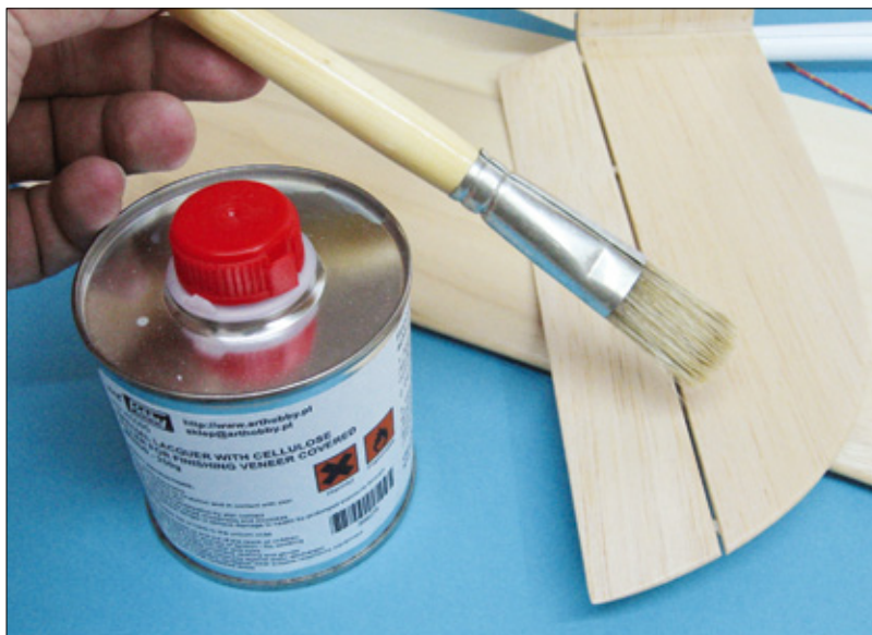
Nach der Fertigstellung sollten alle Holzteile mit einer Lackschicht versehen werden, um so die Poren des Holzes zu schließen. Wer möchte, der kann natürlich auch noch ein paar farbige Akzente setzen
