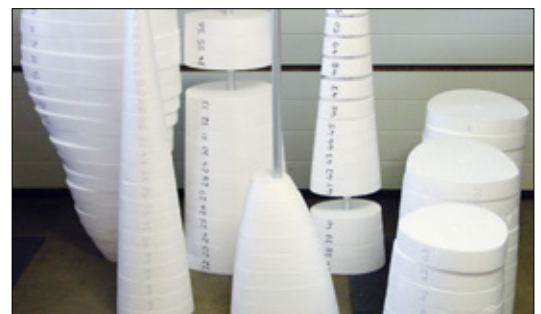
Die Styropor-Rumpfsegmente der großen Foka 4 von Wolfgang Mache (Foto: Wolfgang Mache)
