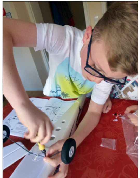
Das lenkbare Bugfahrwerk ist schon vormontiert, das Hauptfahrwerk müssen die Jungs noch anschrauben – und dabei immer schön die Anleitung beachten
