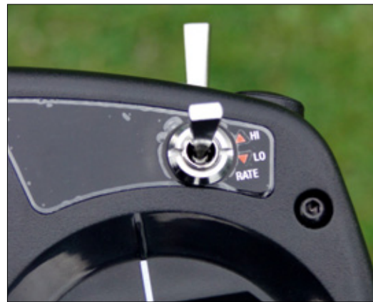
Mit dem Dual-Rate Schalter können die Ruderausschläge zusätzlich begrenzt werden
