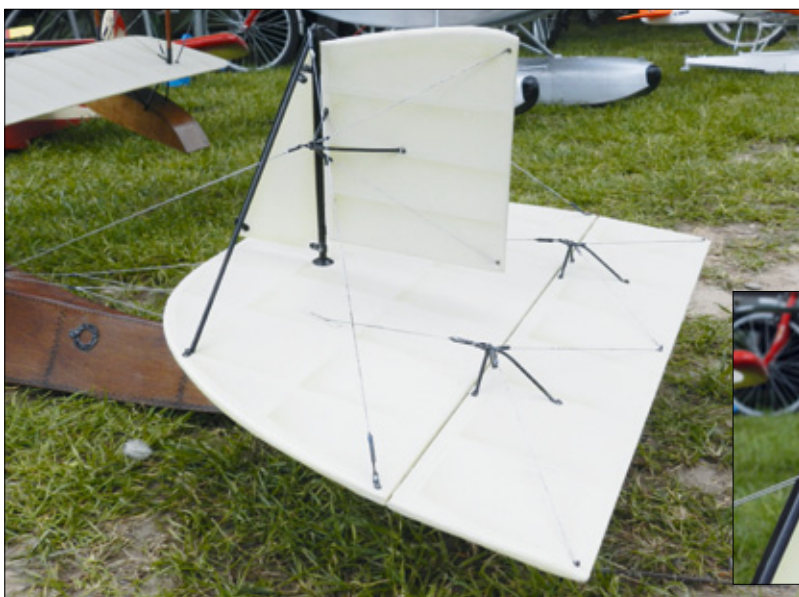
Vorbildgetreu wirkende Verspannungen und Anlenkungen von Seiten- und Höhenruder
