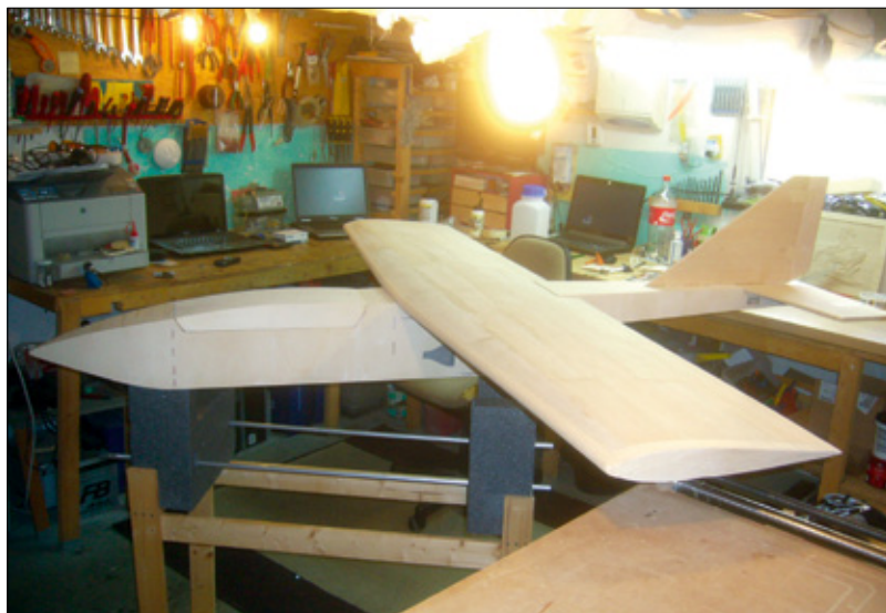
Rohbaufertig und bereit zum Bespannen mit Oracover-Folie sowie für den technischen Ausbau
