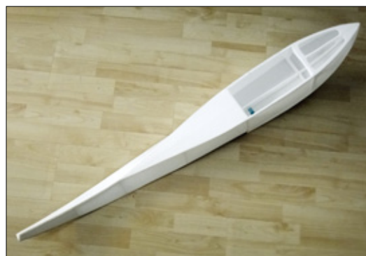
Depronplatten verschließen den Rumpf
