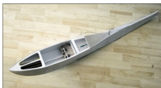
Das fertige Rumpfteil ist mit 0,4-Millimeter-Flugzeugsperrholz furniert
