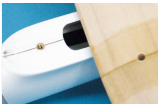
Zur Flügelbefestigungen liegen zwei Messing-Gewindeeinsätze bei, die im Rumpf verklebt werden
