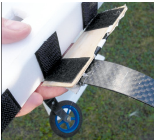
Die Fahrwerksbefestigung erfolgt mit Klettband, das erlaubt eine schnelle (De-)Montage und das Experimentieren mit verschiedenen Positionen
