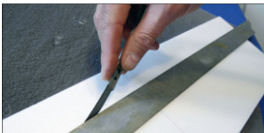
Beim Abtrennen von Höhen- und Querruder wird die Klinge schräg geführt, so können die Ruder ohne Schleifarbeit gedreht montiert werden
