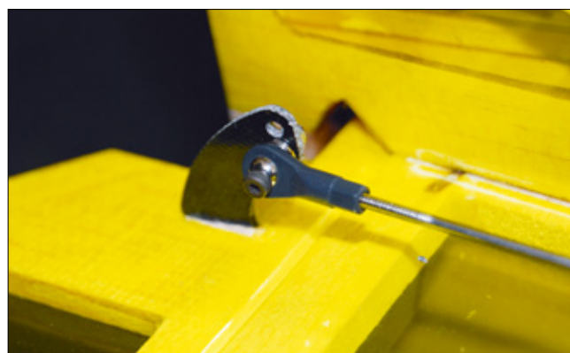
Stabile GFK-Ruderhörner sind in der PNP-Version bereits eingeklebt. Zur Sicherheit sind diese auf feste Verbindung zu prüfen
