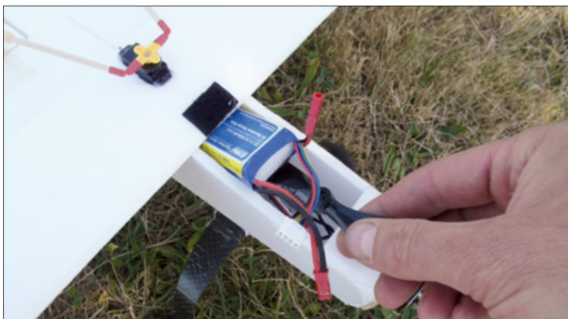
Ein Propeller zum Trennen der Klettverbindungen erleichtert den Akkuwechsel
