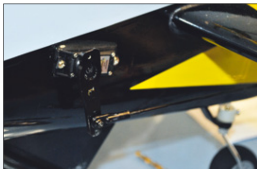
Für die großen Ausschläge der Ruder wird an den Servohebeln eine Verlängerung benötigt
