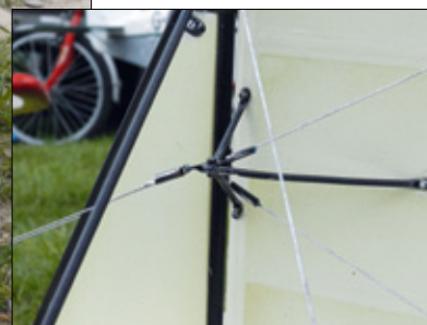
Vorbildgetreu wirkende Verspannungen und Anlenkungen von Seiten- und Höhenruder
